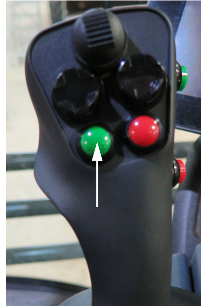
Interrupteur du pulvérisateur principal (situé sur le levier de vitesse de la transmission hydrostatique) - Vue typique
