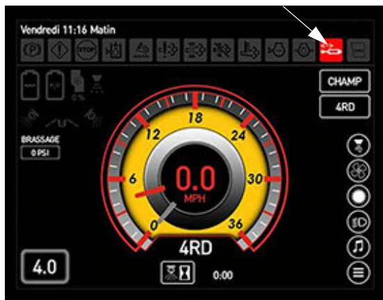
Indicateur de pression dans la rampe (situé en haut de chaque page d'affichage)
