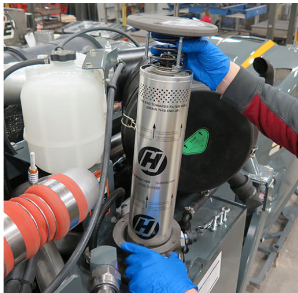
Filtre de retour (situé à l'intérieur du boîtier de filtre à air, sur le dessus du réservoir d'huile hydraulique) - Vue typique
