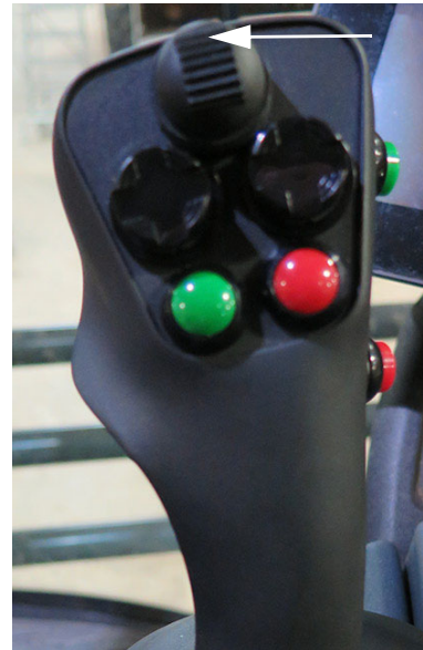
Interrupteur de la traverse - HAUT (situé sur le levier de commande de l'entraînement hydrostatique) - Vue typique
