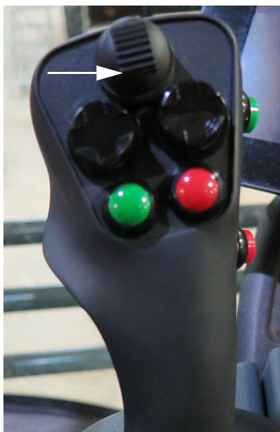
Commutateur de la traverse - BAS (situé sur le levier de vitesse de la transmission hydrostatique) - Vue typique
