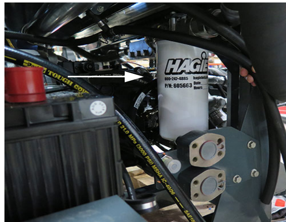
Filtre de retour au carter 1 (situé sur le côté droit de la machine, près de la batterie) - Vue typique
