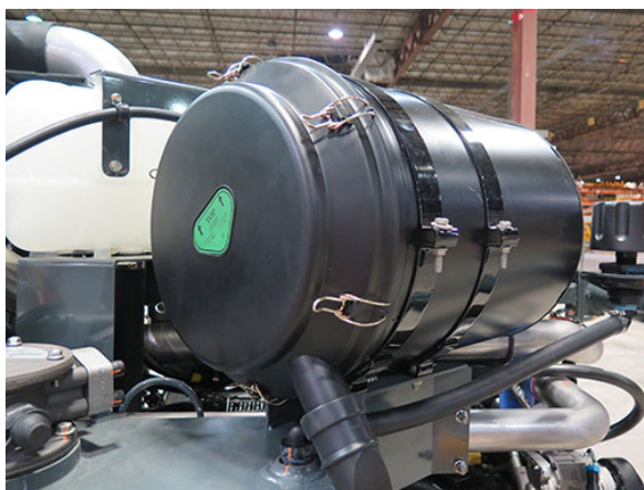
Filtre de l'admission d'air du moteur - STS14/STS16 (situé sur le côté arrière gauche de la machine - ouvrez le capot pour y accéder) - Vue typique
