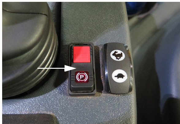
Interrupteur du frein de stationnement (situé près du levier de vitesse de la transmission hydrostatique) - Vue typique
