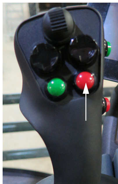
Commutateur de gestion des tournières (situés sur le levier de commande de l'entraînement hydrostatique) - Vue typique
