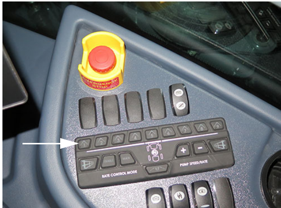
Interrupteurs des vannes de solution de la rampe (situés sur la console latérale) - Vue typique
