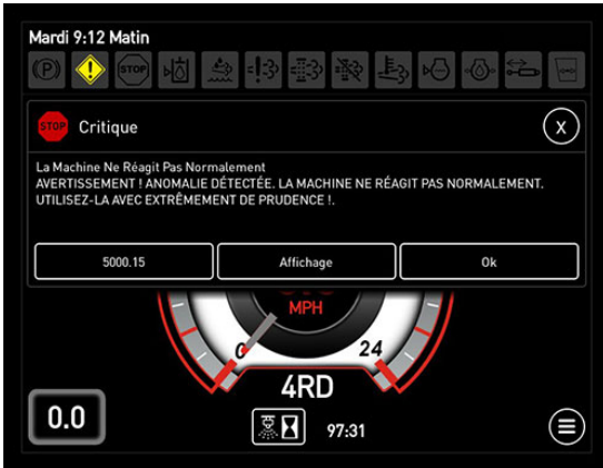
Avertissement de mauvais fonctionnement de la machine
