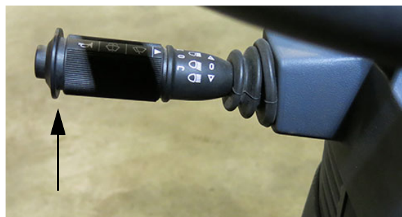
Bouton du liquide lave-glace (situé à l'extrémité du levier des clignotants) - Vue typique
