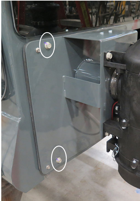
Boulons de fixation (4) (deux situés de chaque côté du panneau d'accès extérieur sur le côté droit de la cabine) - Vue typique
