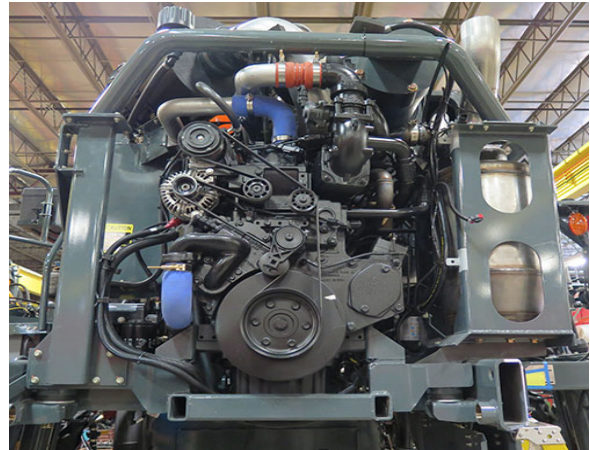
Moteur diesel Final Tier 4 John Deere PSS 9,0 L - STS14/STS16 - Vue typique
