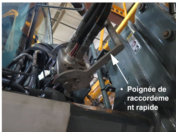
Ensemble multicoupleur hydraulique/électrique - si la machine en est équipée (situé sur le côté avant gauche de la machine) - Vue typique
