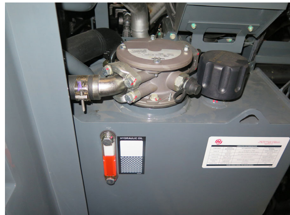
Réservoir d'huile hydraulique (situé sur le côté arrière gauche de la machine - ouvrez le capot pour y accéder) - Vue typique
