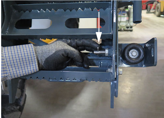
Goupille de sécurité (située sur la partie inférieure droite de l'ensemble de l'échelle repliée) - Vue typique
