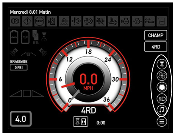
Touches rapides (situées sur la page d'accueil de l'afficheur de la machine - Mode Route et mode Champ)
