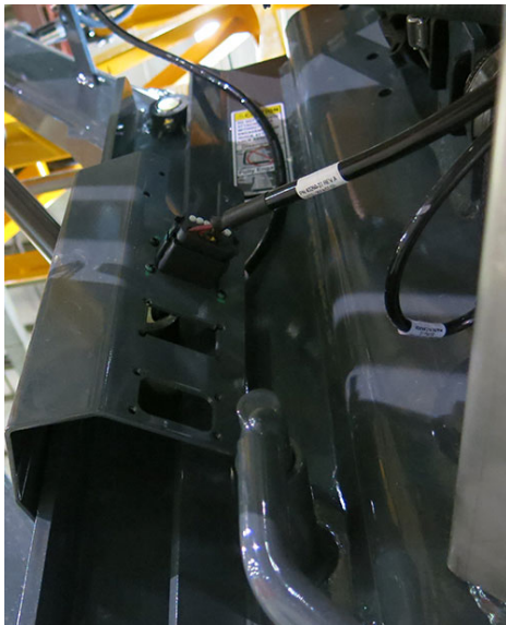
Branchement du système NORAC (situé sur le côté avant droit de la machine) - Vue typique
