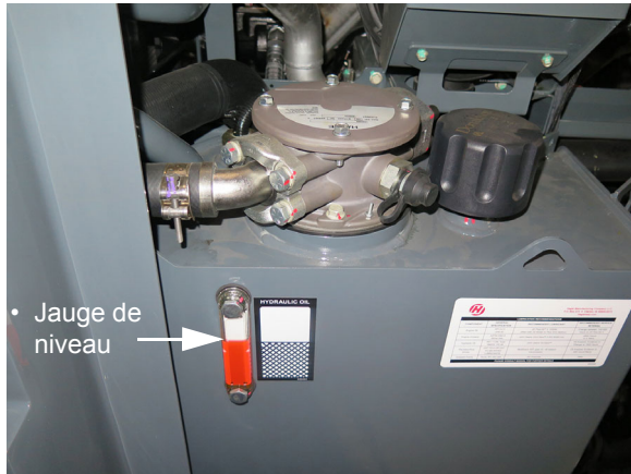
Réservoir d'huile hydraulique (situé sur le côté gauche de la machine - ouvrez le capot pour y accéder) - Vue typique
