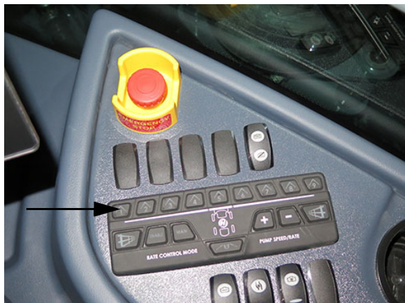
Interrupteurs des vannes de solution de la rampe -
