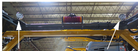
Jauge de pression - Primaire/secondaire (située sur les côtés gauche et gauche de la rampe) - Vue typique
