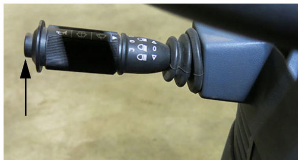
Touche du klaxon (située à l'extrémité du levier des clignotants) - Vue typique
