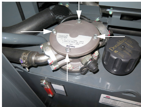
Boîtier du filtre de retour (situé sur le dessus du réservoir d'huile hydraulique) - Vue typique
