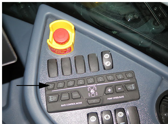
Interrupteurs des vannes de solution de la rampe - Pavé numérique de la section Produit unique, Sections 1 à 9
