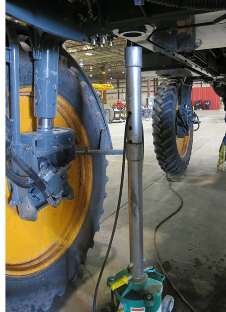
Alignez le cric avec l'anneau de rétention du point de levage - Vue typique
