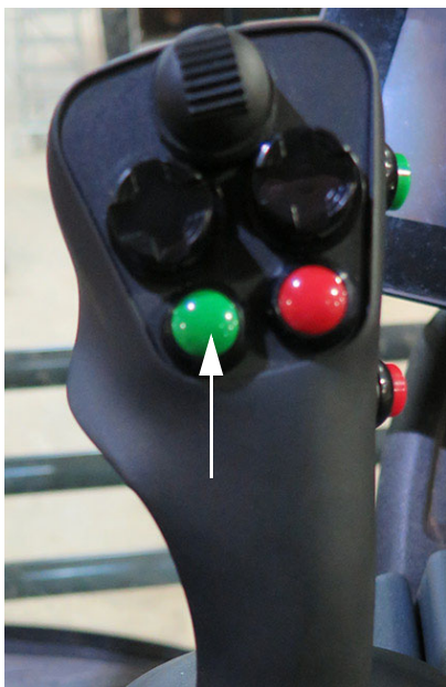
Interrupteur du pulvérisateur principal (situé sur le levier de vitesse de la transmission hydrostatique) - Vue typique
