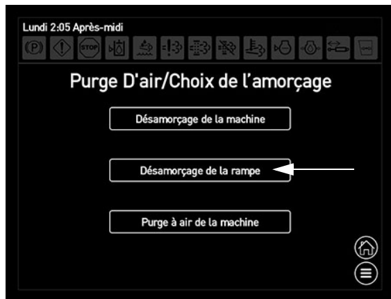
Touche Amorçage de la rampe (située sur l'écran « Sélection Purge par air / amorçage »)
