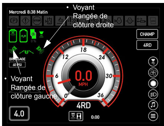
Voyants Rangée de clôture - gauche/droit (situés sur la page d'accueil de l'afficheur de la machine - mode Champ)
