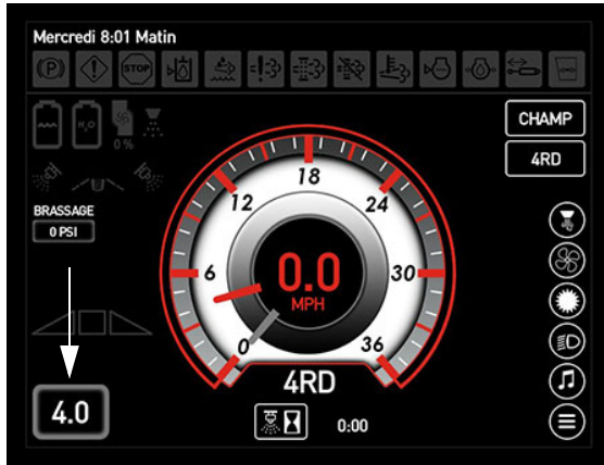
Vitesse cible (située sur la page d'accueil de l'afficheur de la machine - Mode Route et mode Champ)
