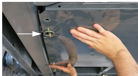
Goupille clip de sécurité (installée sur la goupille percée) - Vue typique
