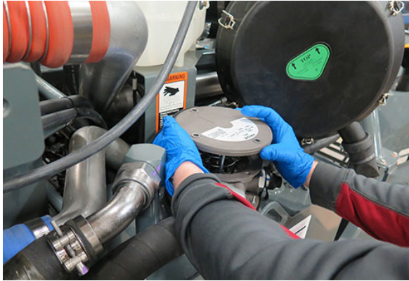
Remplissage du réservoir par le haut du boîtier du filtre de retour hydraulique - Vue typique
