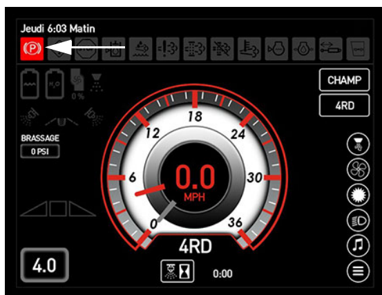
Témoin du frein de stationnement (situé en haut à gauche sur chaque page d'affichage)
