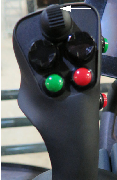
Commutateur de la traverse - HAUT (situé sur le levier de vitesse de la transmission hydrostatique) - Vue typique
