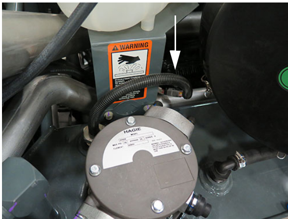
Capteur de niveau / température (situé sur le dessus du réservoir d'huile hydraulique) - Vue typique
