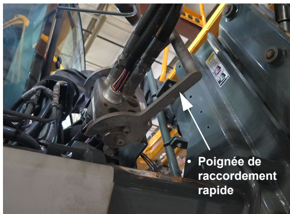
Ensemble multicoupleur hydraulique/électrique - si la machine en est équipée (situé sur le côté avant gauche de la machine) - Vue typique
