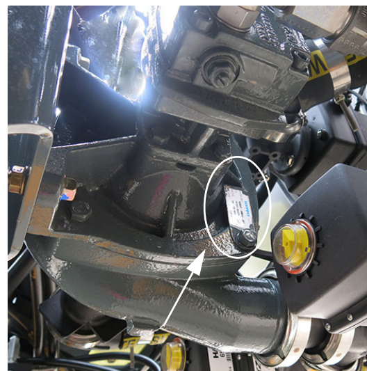
Plaque d'identification de la pompe à solution * Vue de dessous la machine illustrée - Vue typique
