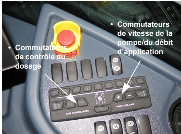
Commutateurs de contrôle du dosage et Commutateurs de vitesse de la pompe/ du débit d'application (situés sur la console latérale) - Vue typique
