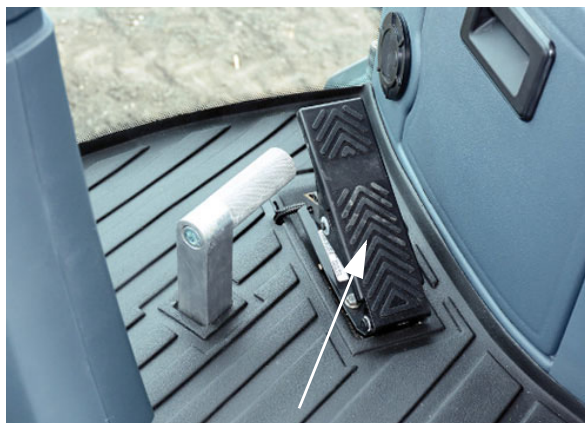
Pédale de décélération (située dans la partie inférieure droite de la colonne de direction) - Vue typique
