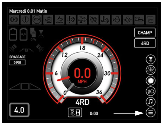
Touche Menu principal (situé sur la page d'accueil de l'afficheur de la machine - Mode Route et mode Champ)
