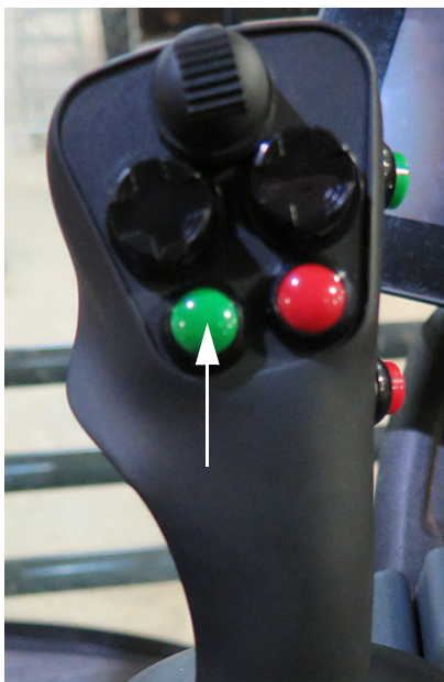
Interrupteur du pulvérisateur principal (situé sur le levier de vitesse de la transmission hydrostatique)
