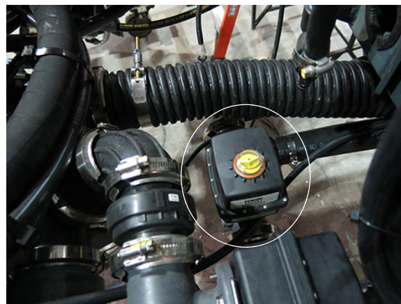
Vanne de brassage (située dans la partie centrale de la machine) - Vue typique
