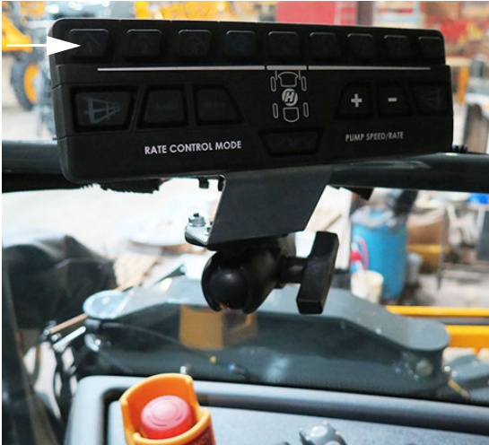
Interrupteurs des vannes de solution de la rampe - Pavé numérique de la section Deux produits
