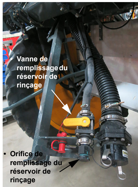
Dispositif de remplissage par l'avant (illustré en position abaissée) - Vue typique
