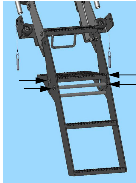
Points de pivotement inférieurs de l'échelle - Plate-forme (4) - Vue typique
