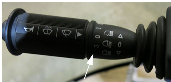
Vitesses des essuie-glaces (situées sur le levier des clignotants) - Vue typique
