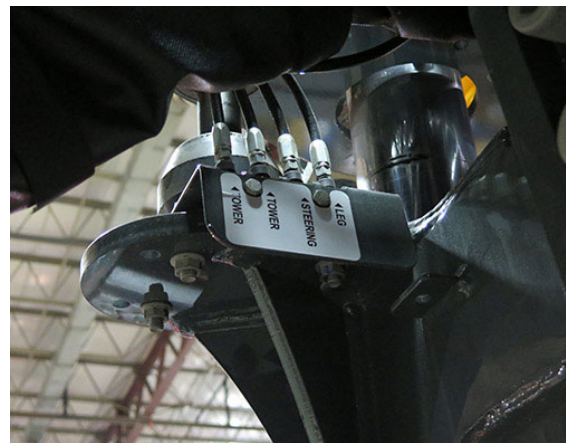
Bloc d'embouts de graissage (4) (situé sur la partie avant de chaque jambe) - Vue typique
