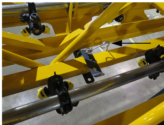
Goupille de verrouillage pour le transport (illustrée en position « Rangée ») - Vue typique
