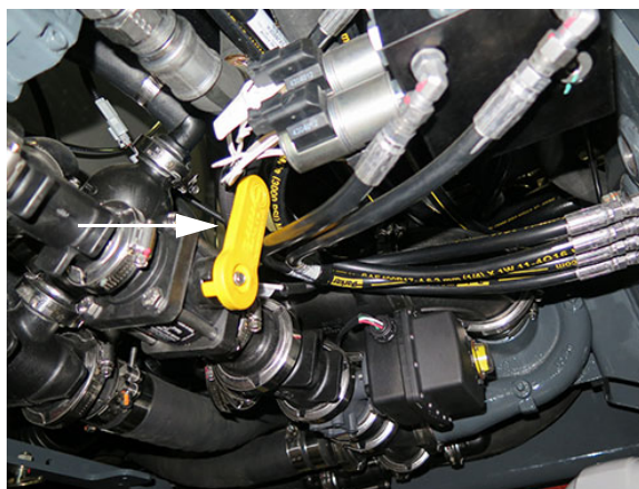
Vanne d'arrêt du brassage (située sous la partie arrière de la machine) - Vue typique
