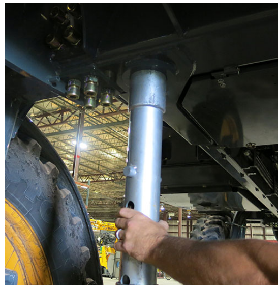
Insérez le cric dans l'anneau de rétention du point de levage - Vue typique
