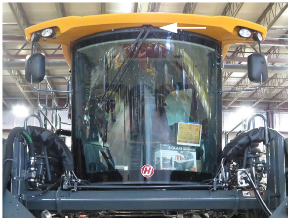
Buse de pulvérisation de liquide lave-glace (située près de la partie supérieure de l'extérieur de la cabine) - Vue typique
