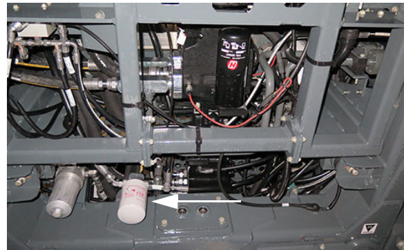
Filtre de retour au carter 2 (situé sur le côté gauche de la machine, à l'avant du châssis du moteur) - Vue typique
