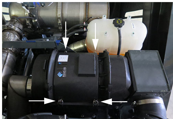
Dispositifs de sécurité (4) - STS10/STS12 (situés de chaque côté du boîtier de filtre) - Vue typique
