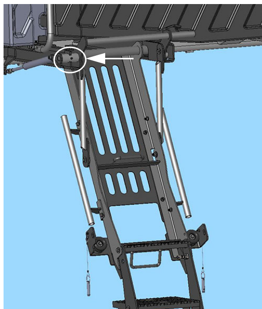
Embout de graissage de la tige du vérin à gaz (située près du côté supérieur gauche de l'échelle) - Vue typique
