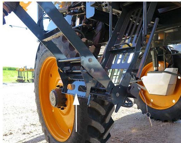
Plate-forme de l'échelle - Vue typique
