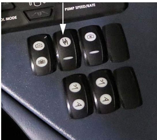
Interrupteur de la pompe à solution - Primaire (situé sur la console latérale) - Vue typique
