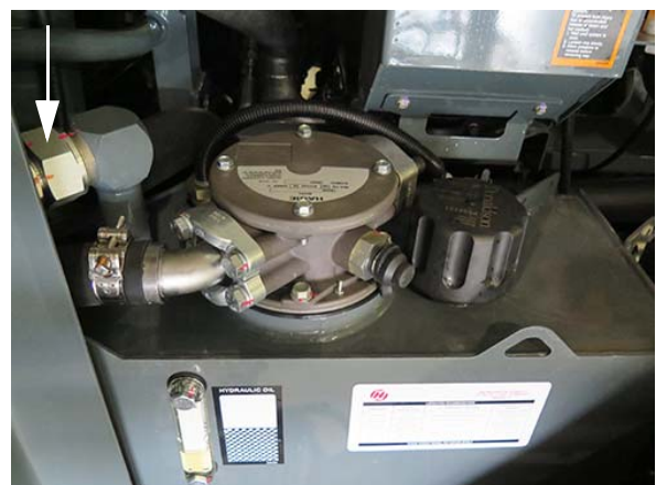
Tuyau de vidange du carter (situé près du haut du réservoir d'huile hydraulique) - Vue typique
