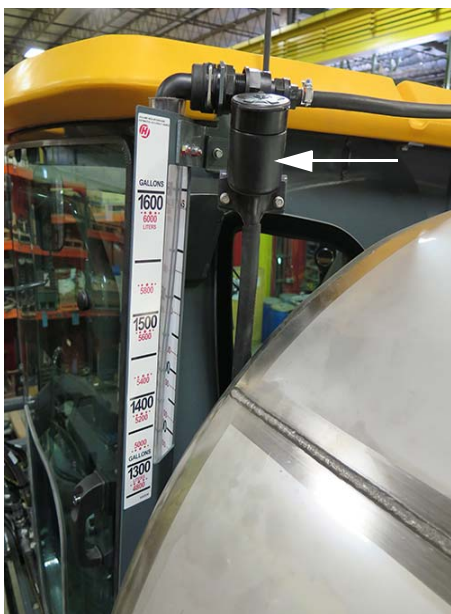
Réservoir de liquide de lave-glace (situé derrière la partie gauche de la cabine) - Vue typique
