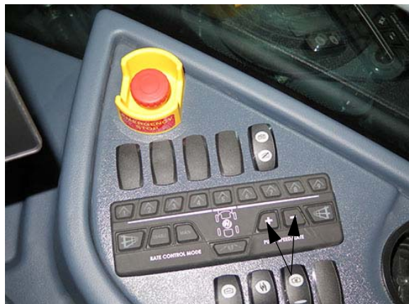
Commutateurs de vitesse de la pompe/du débit d'application (situés sur la console latérale) - Vue typique
