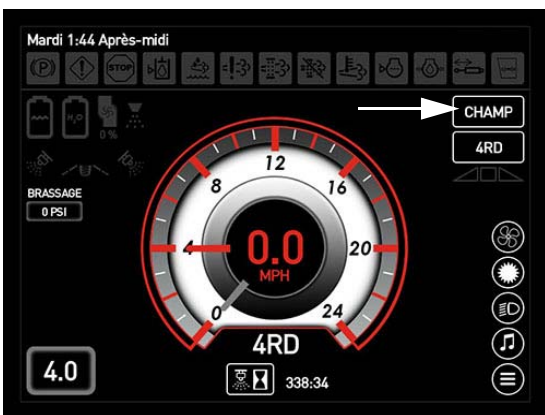
Touche Champ/Route (située sur la page d'accueil de l'afficheur de la machine)
