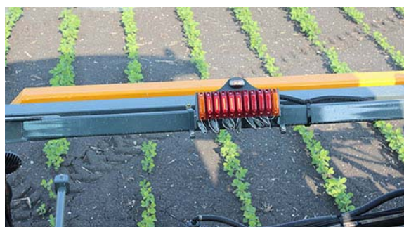
Indicateurs des vannes de solution de la rampe (montés sur la traverse) - Vue typique
