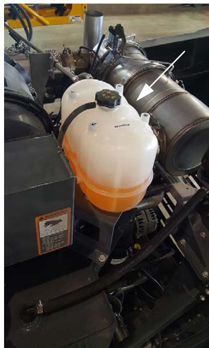
Réservoir d'équilibre - STS10/STS12 (situé vers l'arrière de la machine - ouvrez le capot pour y accéder) - Vue typique
