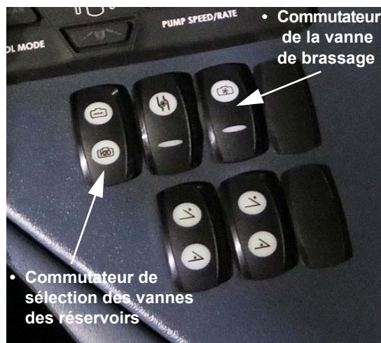
Commutateurs de sélection des vannes des réservoirs et de la vanne de brassage (situés sur la console latérale) - Vue typique
