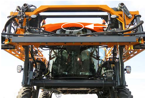
Buse de pulvérisation de liquide lave-glace (située près de la partie supérieure de l'extérieur de la cabine) - Vue typique
