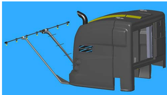
Installation de la rampe arrière - Vue typique
