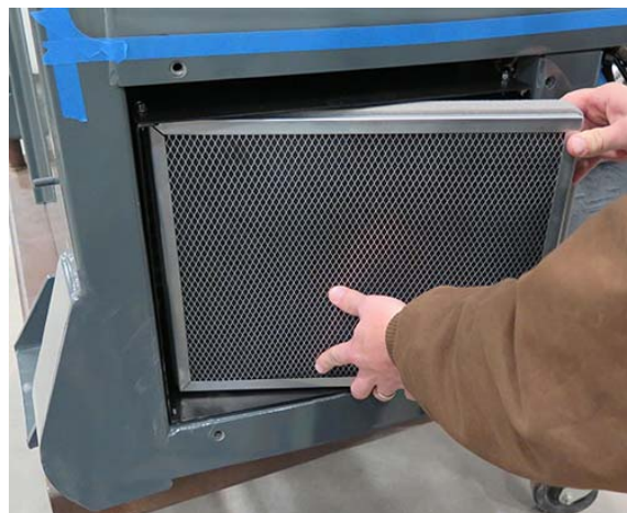
Filtre à charbon actif - Vue typique
