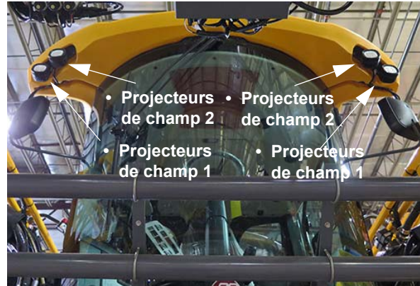
Projecteurs de champ (4) (situés à l'avant de la cabine) - Vue typique
