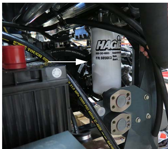
Filtre de retour au carter 1 (situé sur le côté droit de la machine, près de la batterie) - Vue typique
