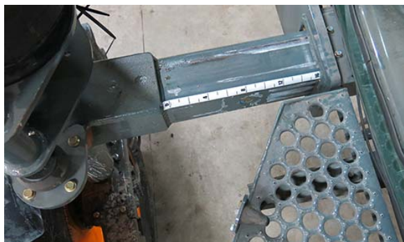
Autocollant de largeur des roues (situé sur chaque jambe de la machine) - Vue typique
