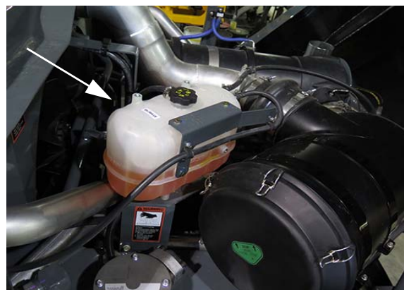
Réservoir d'équilibre - STS14/STS16 (situé vers l'arrière de la machine - ouvrez le capot pour y accéder) - Vue typique
