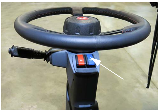
Interrupteur des feux de route (situé sur la colonne de direction) - Vue typique
