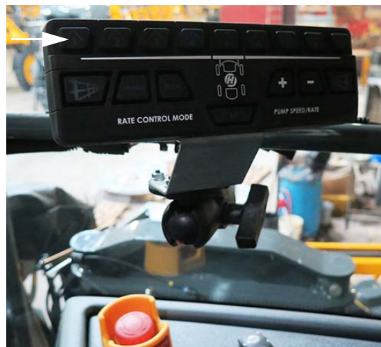
Interrupteurs des vannes de solution de la rampe -
