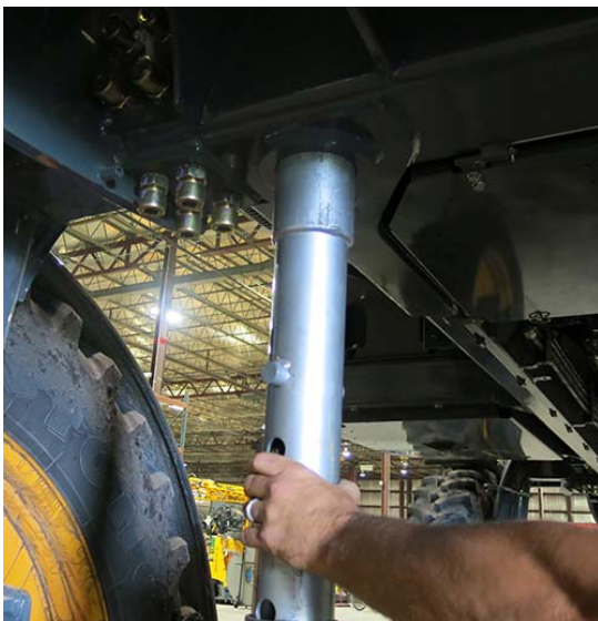
Insérez le cric dans l'anneau de rétention du point de levage - Vue typique
