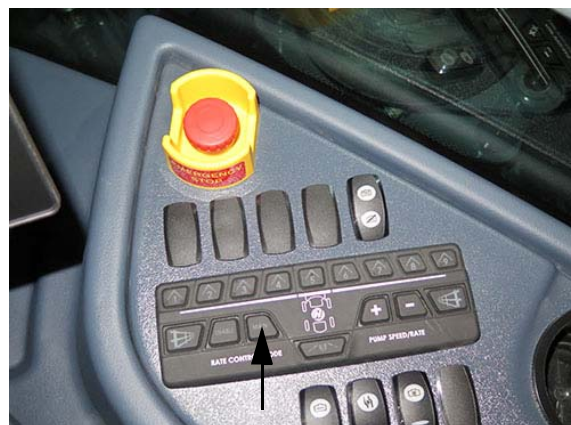
Commutateur de commande manuelle (« MAN ») du dosage (situé sur la console latérale) - Vue typique
