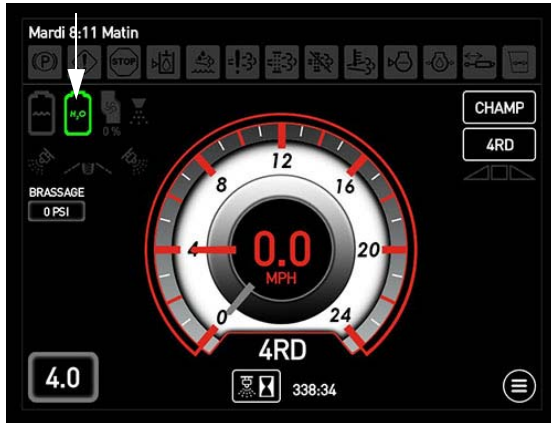
Indicateur du mode Rinçage (situé sur la page d'accueil de l'afficheur de la machine - mode Champ)
