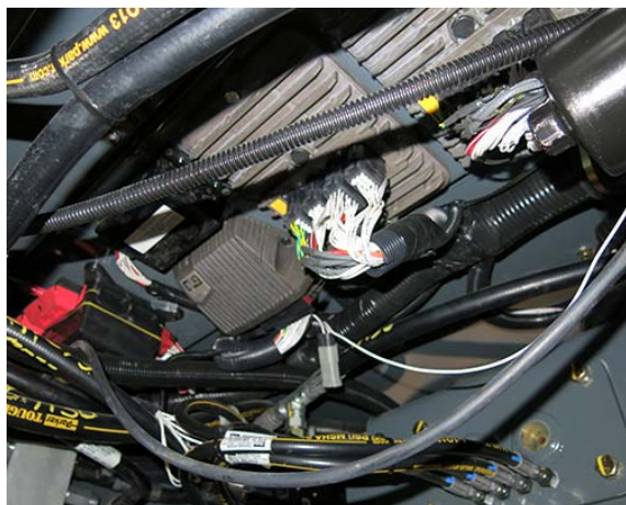
Disjoncteurs / fusibles (extérieurs) (situés en dessous de la cabine - retirez le panneau pour y accéder) - Vue typique
