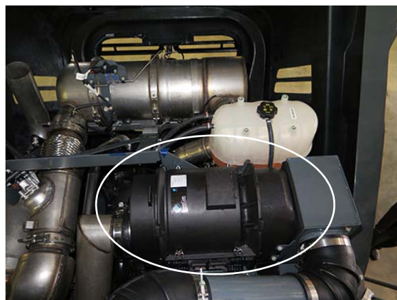
Filtre de l'admission d'air du moteur - STS10/STS12 (situé sur le côté arrière gauche de la machine - ouvrez le capot pour y accéder) - Vue typique
