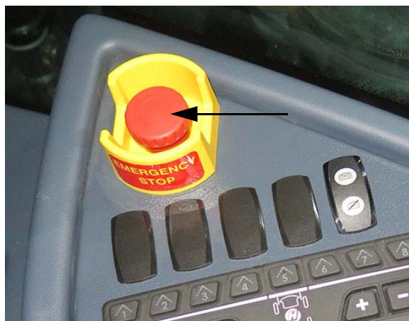
Bouton d'arrêt d'urgence (situé sur la console latérale) - Vue typique
