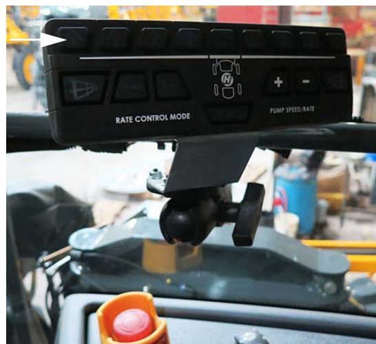
Interrupteurs des vannes de solution de la rampe - Pavé numérique de la section Deux produits (monté près de la console latérale) - Vue typique
