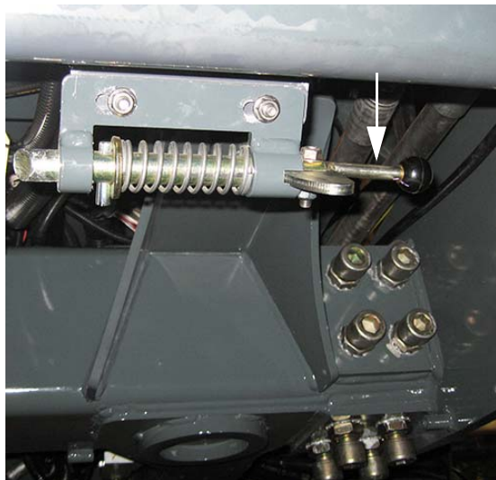
Levier de déblocage pour le remplissage par l'avant (situé sous la partie avant de la machine) - Vue typique
