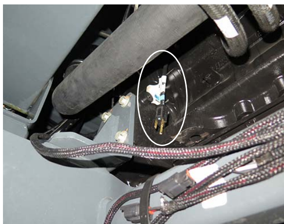
Câble d'alimentation du Réchauffeur du bloc-moteur - STS10/STS12 (située sous le moteur à gauche de la machine) - Vue typique
