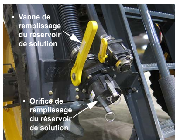
Dispositif de remplissage par l'arrière (situé derrière la roue arrière gauche) - Vue typique
