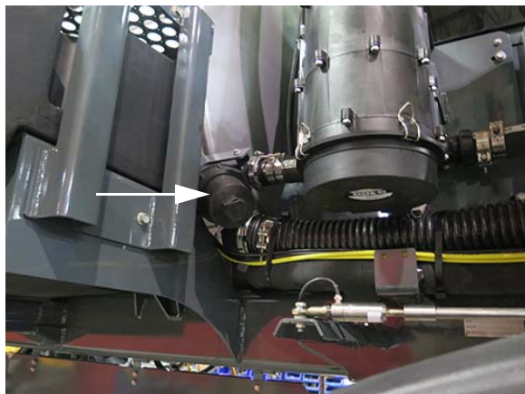
Crépine en ligne de la solution - Secondaire
