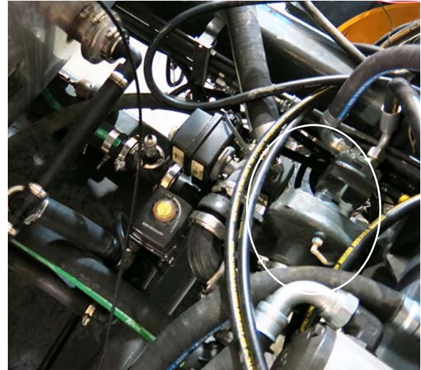
Pompe à solution (située dans la partie centrale de la machine) - Vue typique
