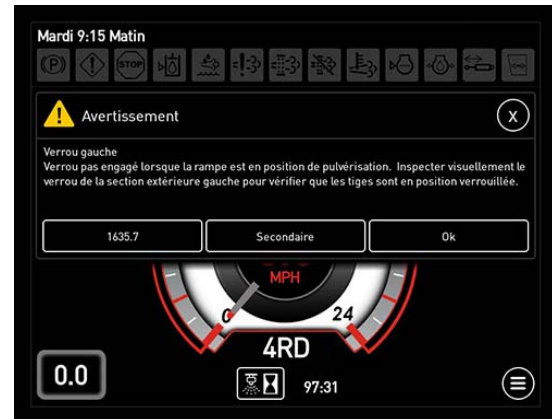
Verrou de section extérieure « mal engagé » Avertissement de problème de fonctionnement
