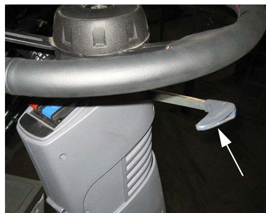
Poignée de réglage de la colonne de direction télescopique (située sur le côté droit de la colonne de direction) - Vue typique
