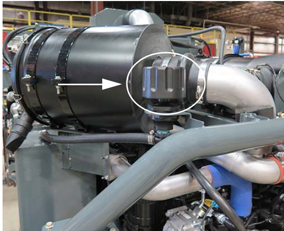
Bouchon de reniflard - STS14/STS16 (situé sur le côté arrière gauche de la machine, derrière le filtre d'admission d'air) - Vue typique
