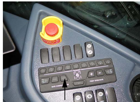
Commutateur de commande manuelle (« MANUEL ») du dosage (situé sur la console latérale) - Vue typique
