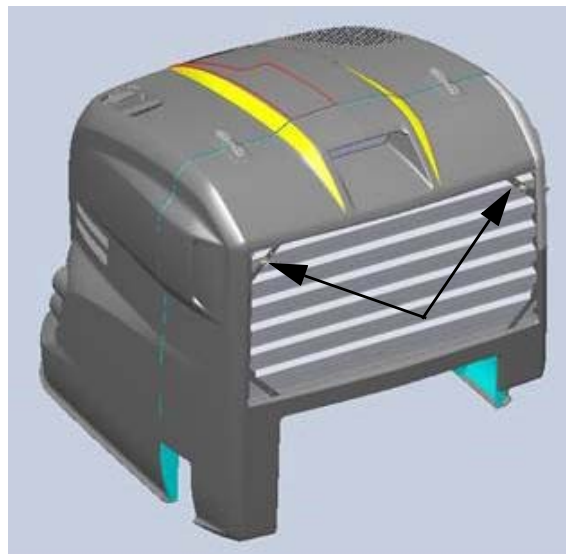
Agrafes à ressort de la grille de calandre (2) (situées sur la partie en haut à gauche et en haut à droite de la grille) - Vue typique
