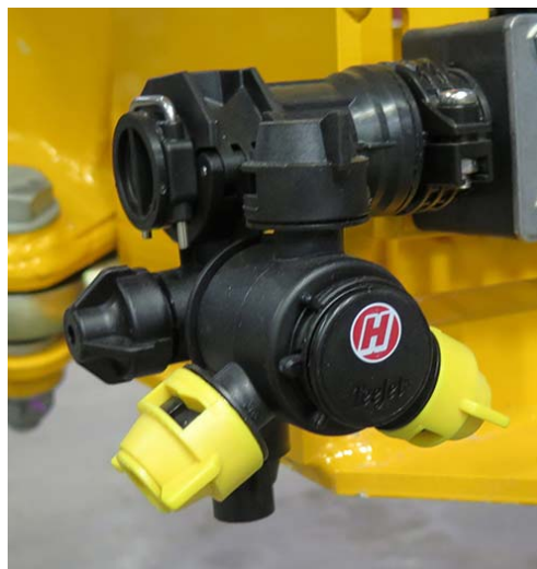
Corps des buses (situés tout le long de la rampe) - Vue typique
