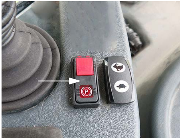
Interrupteur du frein de stationnement (situé près du levier de vitesse de la transmission hydrostatique) - Vue typique
