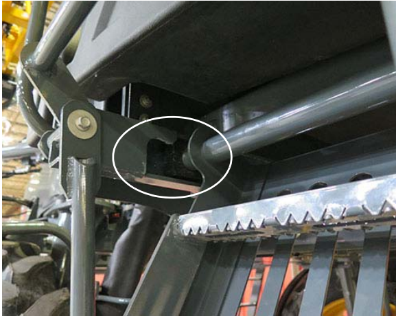
Échelle désengagée des crans des rails (côté gauche de l'échelle illustré) - Vue typique
