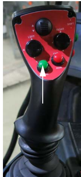
Interrupteur du pulvérisateur principal (situé sur le levier de vitesse de la transmission hydrostatique) - Vue typique
