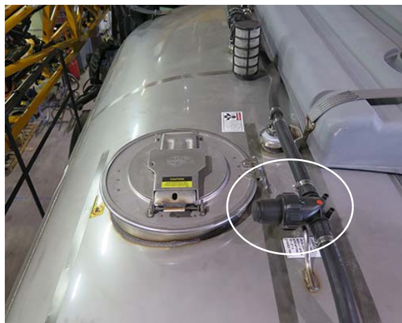
Crépine de rinçage du réservoir - Réservoir en acier inoxydable (située sur le haut du réservoir de solution) - Vue typique
