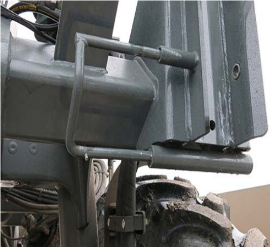
Clavette de sécurité (2) (situées à l'avant gauche et droite de la machine) - Vue typique * Position désengagée illustrée
