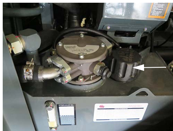
Bouchon de reniflard - STS10/STS12 (situé sur le dessus du réservoir d'huile hydraulique) - Vue typique
