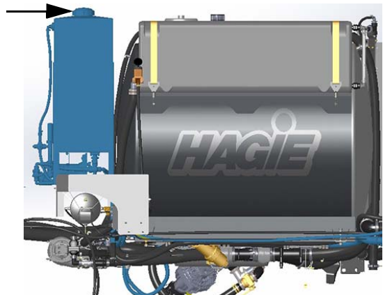
Bouchon de l'orifice de remplissage (situé sur le haut du réservoir de produits chimiques) - Vue typique
