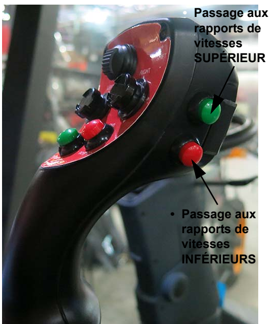
Commutateurs de passage aux rapports de vitesses supérieurs/inférieurs (situés sur le côté du levier de vitesse de la transmission hydrostatique) - Vue typique
