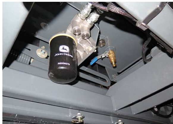
Filtre à huile moteur (situé sur le côté arrière gauche de la machine, en dessous du réservoir d'huile hydraulique) - Vue typique
