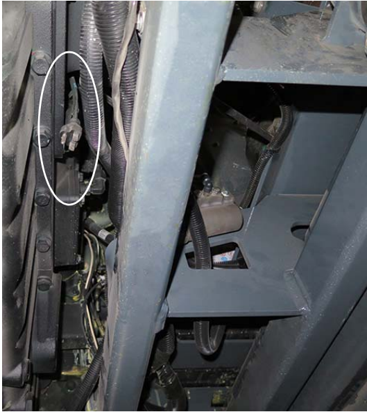
Cordon d'alimentation du chauffe-moteur - STS14/STS16 (situé sous la machine, sur le côté droit du moteur) - Vue typique
