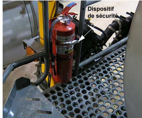
Extincteur d'incendie (situé le long de la plate-forme sur le côté gauche de la machine) - Vue typique
