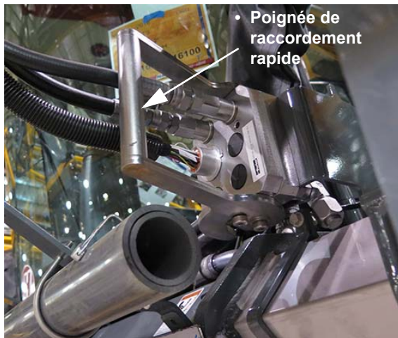
Ensemble multicoupleur hydraulique/électrique (situé sur le côté avant gauche de la machine) - Vue typique
