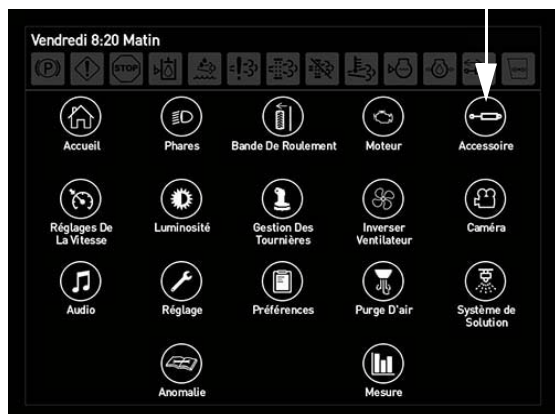
Touche Outil de travail (située sur la page Menu principal de l'afficheur de la machine)
