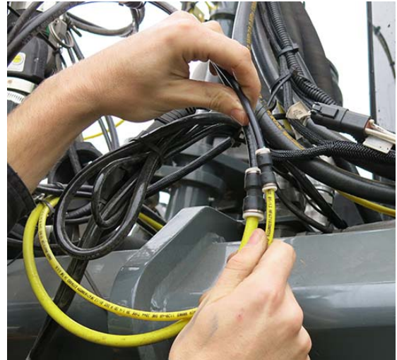
Branchement du marqueur à mousse (situé sur le côté avant droit de la machine) - Vue typique
