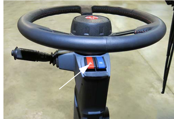
Interrupteur des feux de détresse / feux d'avertissement (situé sur la colonne de direction) - Vue typique
