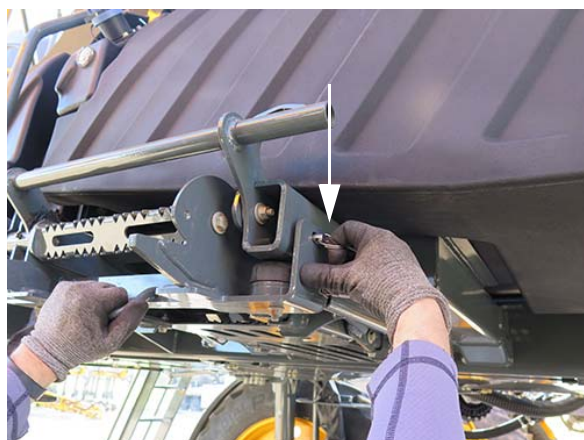
Goupilles de verrouillage (2) (situées de chaque côté de l'ensemble de l'échelle) - Vue typique
