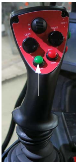
Interrupteur du pulvérisateur principal (situé sur le levier de vitesse de la transmission hydrostatique) - Vue typique
