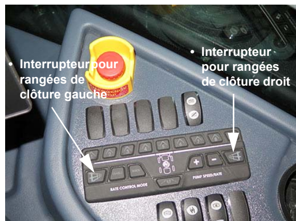
Interrupteurs pour rangées de clôture - gauche et droit (situés sur la console latérale) - Vue typique
