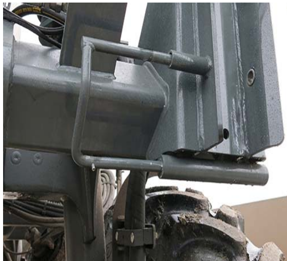
Clavette de sécurité (2) (situées à l'avant gauche et droit de la machine) - Vue typique * Position désengagée illustrée
