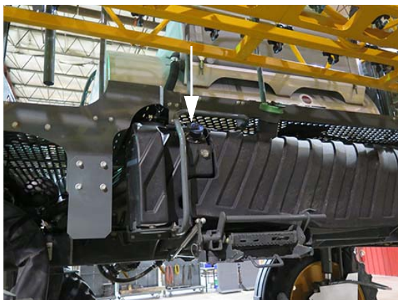
Bouchon de remplissage de l'AUS 32 (située sur la partie avant du réservoir d'AUS 32) - Vue typique
