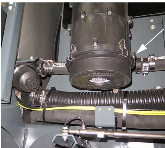
Débitmètre - Secondaire (situé près de l'avant droit de la machine) - Vue typique
