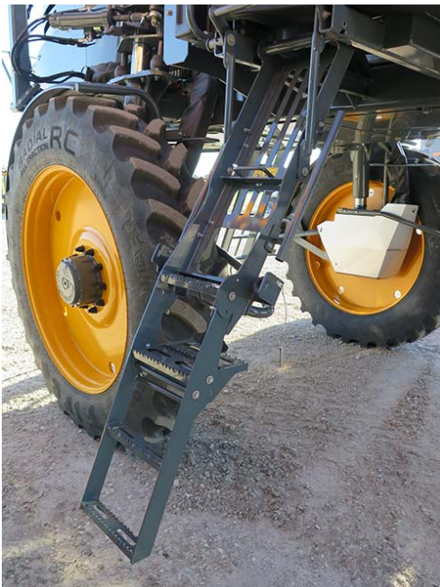
Échelle de remplissage du carburant (illustré en position abaissée) - Vue typique
