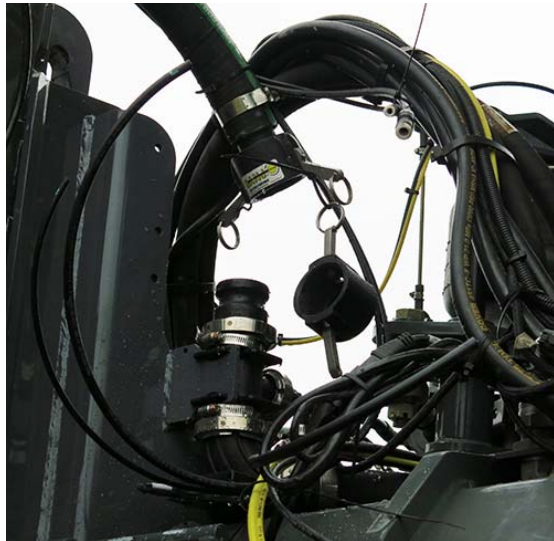
Branchement du système de solution - Standard (situé sur le côté avant droit de la machine) - Vue typique
