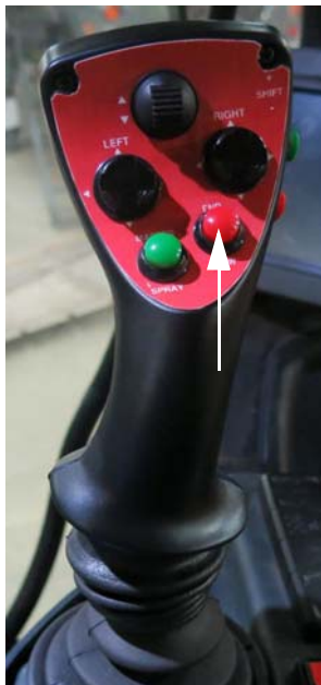
Commutateur de gestion des tournières (situés sur le levier de commande de l'entraînement hydrostatique) - Vue typique
