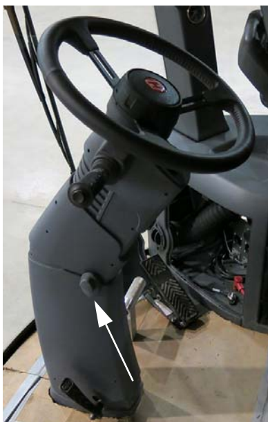
Bouton de réglage de l'inclinaison de la colonne de direction (situé sur le côté gauche de la colonne de direction) - Vue typique
