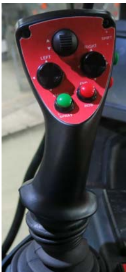
Levier de vitesse de la transmission hydrostatatique - Vue typique
