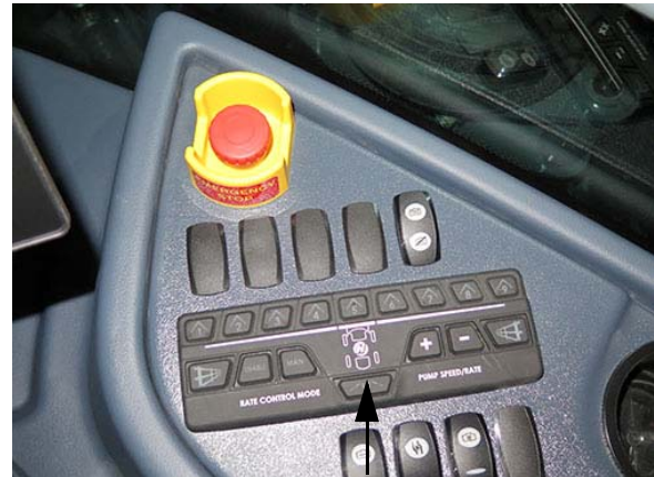
Interrupteur des buses arrière (situé sur la console latérale) - Vue typique
