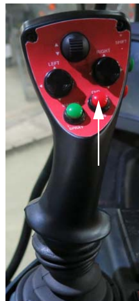
Commutateur de gestion des tournières (situé sur le levier de vitesse de la transmission hydrostatique) - Vue typique
