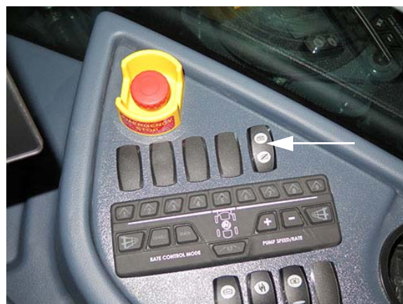
Interrupteur de rinçage du réservoir (situé sur la console latérale) - Vue typique
