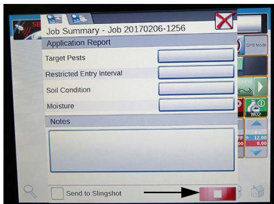
Touche Arrêt (située sur la console du système de pulvérisation) - Vue typique
