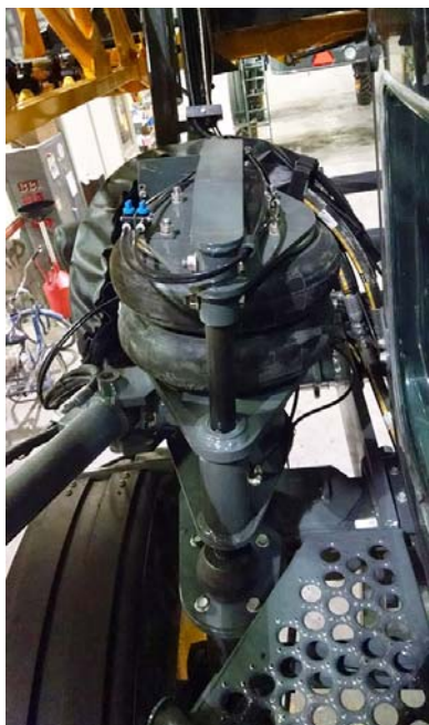
Coussin d'air (situé sur chaque jambe de la machine) - Vue typique
