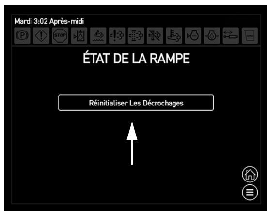
Touche Réinitialiser les décrochages (située sur la page Menu principal de l'afficheur de la machine)
