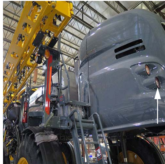
Feux arrière (2) - Vue typique
