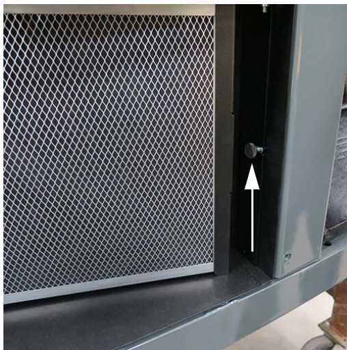
Vis de sécurité (située le long de la paroi intérieure du compartiment du filtre) - Vue typique
