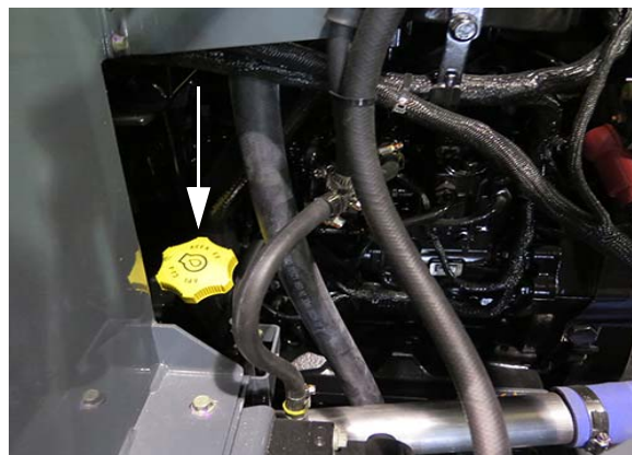
Remplissage d'huile moteur (situé sur le côté gauche du moteur - ouvrez le capot pour y accéder) - Vue typique
