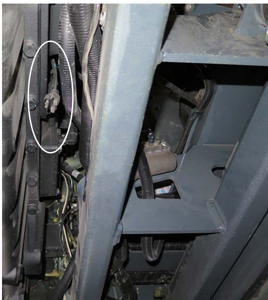
Cordon d'alimentation du chauffe-moteur (situé sous la machine, sur le côté droit du moteur) - Vue typique
