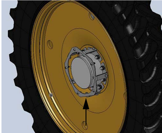
Ensemble soudé d'adaptation du cache-moyeu - Vue typique
