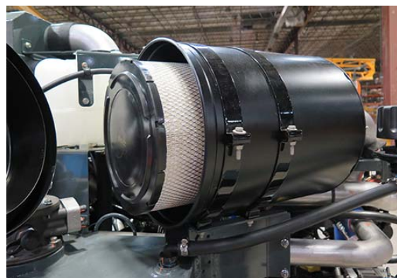
Filtre de l'admission d'air du moteur (illustré avec le couvercle enlevé) - Vue typique
