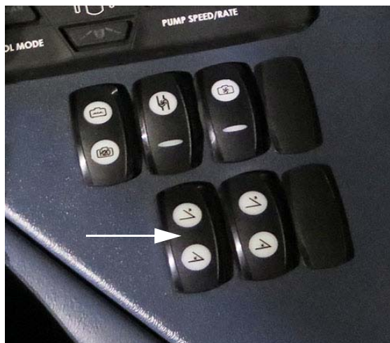
Commutateur des extensions de la rampe * Rampes de pulvérisation de 27 mètres (situé sur la console latérale) - Vue typique
