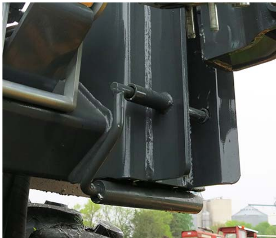
Clavette de sécurité (2) - Vue typique * Position engagée illustrée
