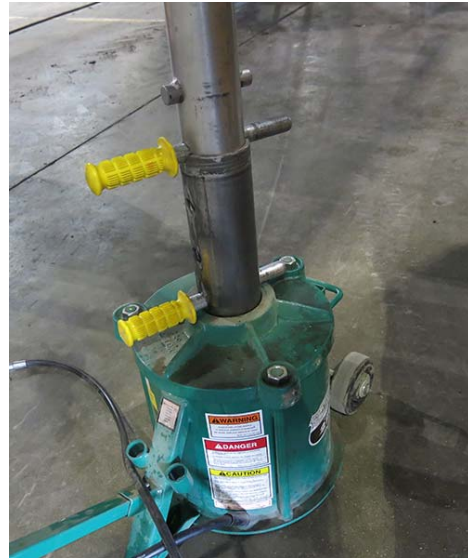
Installation des goupilles de blocage - Vue typique
