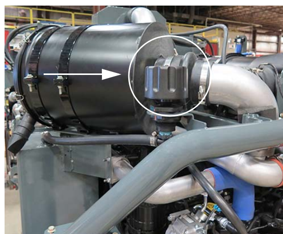
Bouchon de reniflard (situé sur le côté arrière gauche de la machine, derrière le filtre d'admission d'air) - Vue typique
