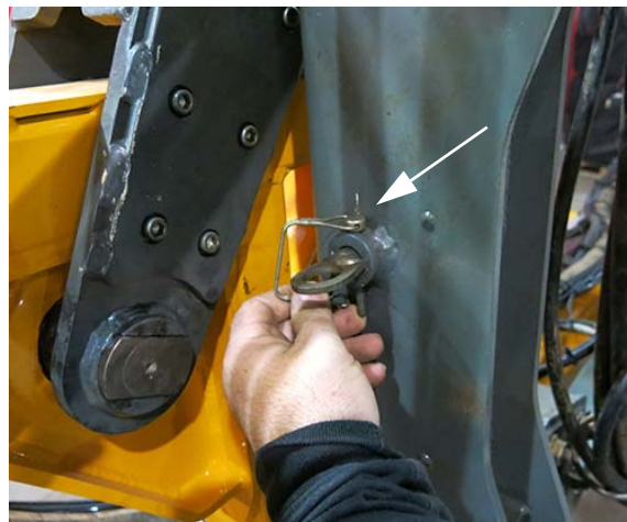
Clavette de sécurité (située sur la partie extérieure du châssis de la traverse) - Vue typique
