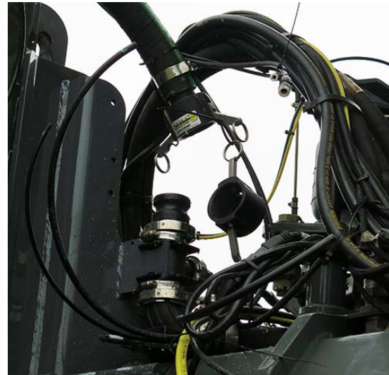
Branchement du système de solution - Standard (situé sur le côté avant droit de la machine) - Vue typique
