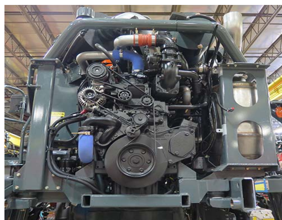
Moteur diesel Final Tier 4 John Deere PSS 9.0L - Vue typique
