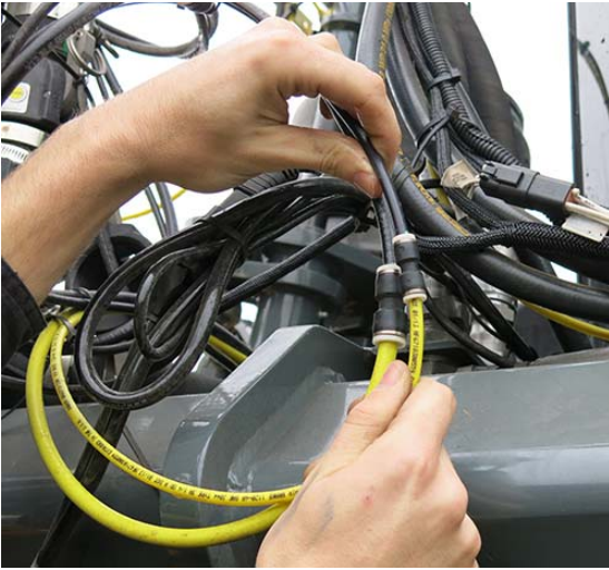
Branchement du marqueur à mousse - Standard (situé sur le côté avant droit de la machine) - Vue typique
