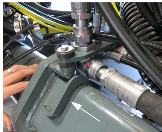
Support de fixation du pare-broussailles (côté droit de la machine illustré) - Vue typique
