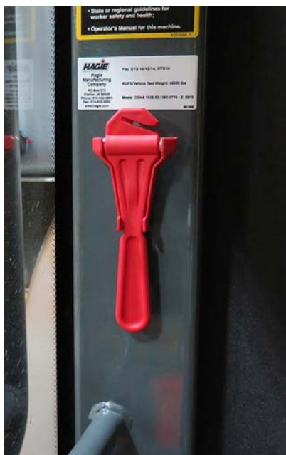
Outil d'évacuation d'urgence (situé le long du côté droit de la cabine) - Vue typique
