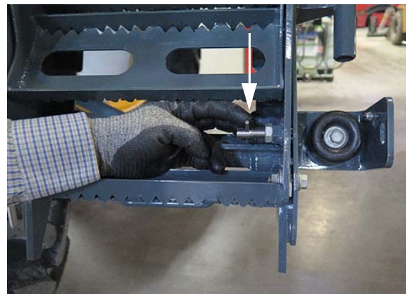
Goupille de sécurité (située sur la partie inférieure droite de l'ensemble de l'échelle repliée) - Vue typique
