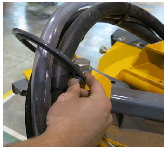
Anneau de maintien des tuyaux de la rampe - Vue typique
