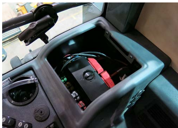
Disjoncteurs / fusibles (intérieurs) (situés à l'arrière de la console latérale - retirer le plateau pour y accéder) - Vue typique
