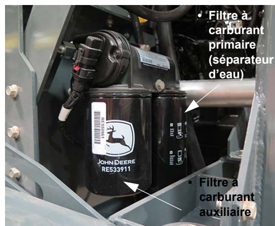
Filtres à carburant principal et auxiliaire (situé sur le côté arrière gauche de la machine, derrière le réservoir d'huile hydraulique) - Vue typique
