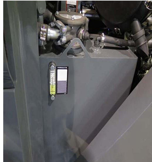
Réservoir d'huile hydraulique (situé sur le côté arrière gauche de la machine - ouvrez le capot pour y accéder) - Vue typique
