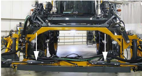
Vérins principaux de pivotement/décrochage - Vue typique
