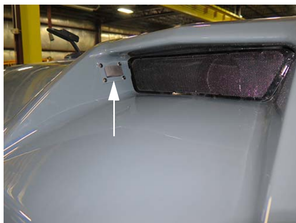
Bouton de l'actionneur du capot (situé dans la partie supérieure avant du capot) - Vue typique
