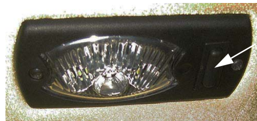
Commutateur des lampes de travail intérieures
