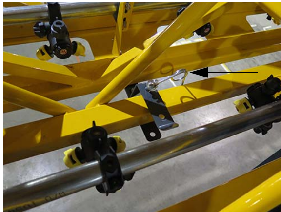
Goupille de verrouillage pour le transport (illustrée en position « Rangée ») - Vue typique
