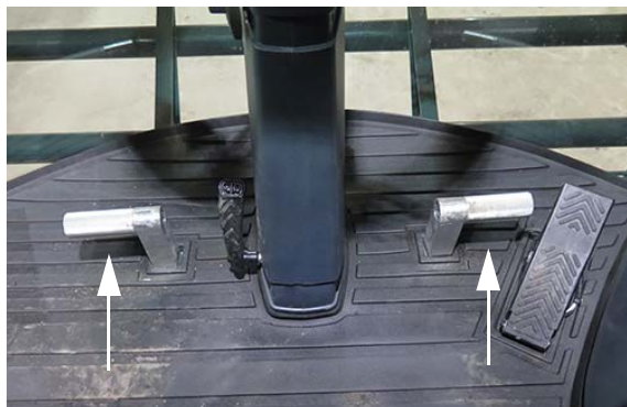
Repose-pieds (situés de chaque côté de la colonne de direction) - Vue typique
