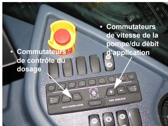
Commutateurs de contrôle du dosage et de vitesse/de débit de la pompe (situés sur la console latérale) - Vue typique
