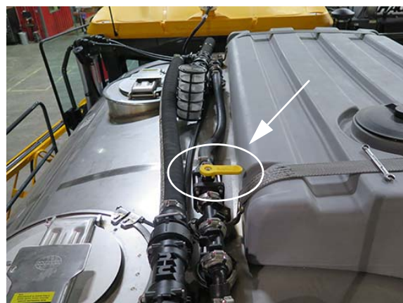
Vanne de rinçage deux produits (située sur le haut du réservoir de solution) - Vue typique
