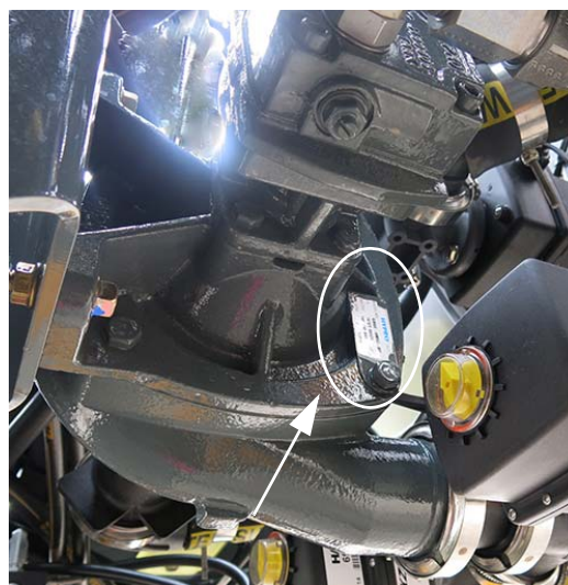
Plaque d'identification de la pompe à solution
