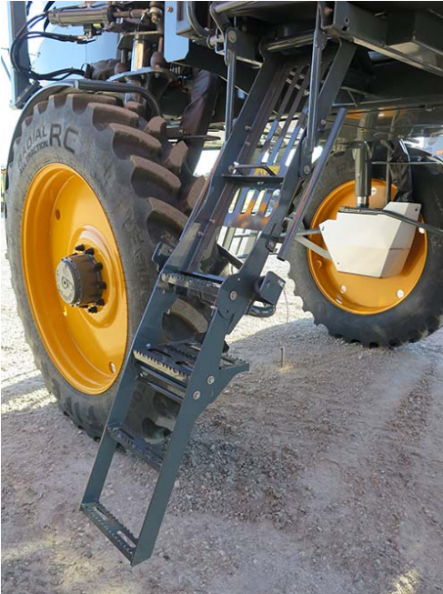
Échelle de remplissage de carburant (illustré en position abaissée) - Vue typique
