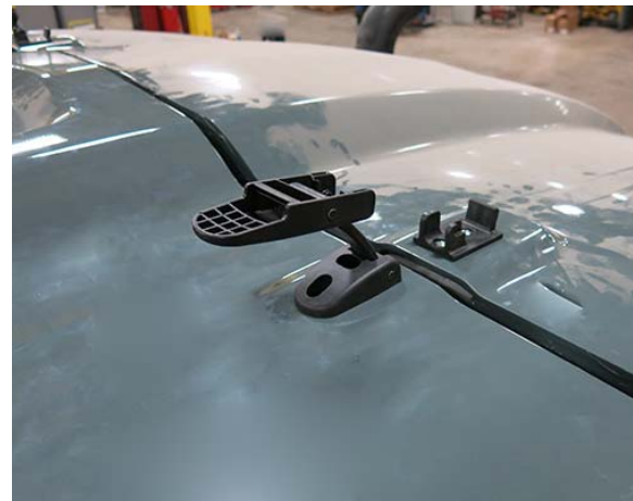
Loquet du capot (2) (situés de chaque côté du capot supérieur) - Vue typique
