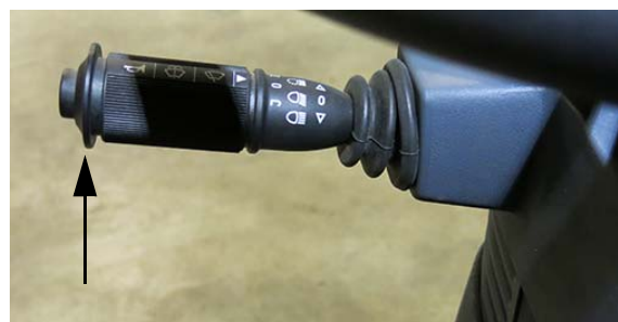
Bouton du liquide lave-glace (situé à l'extrémité du levier des clignotants) - Vue typique
