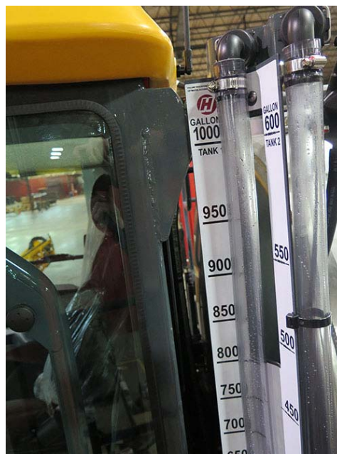
Double jauge de niveau du réservoir de solution (située derrière la partie arrière gauche de la cabine) - Vue typique
