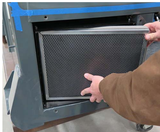
Filtre à charbon actif - Vue typique
