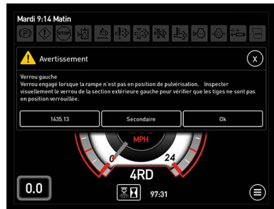
Verrou de section extérieure « engagé » Avertissement de problème de fonctionnement
