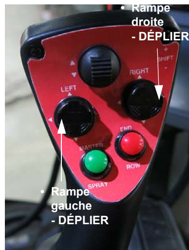
Interrupteurs des rampes gauche et droite (situés sur le levier de vitesse de la transmission hydrostatique) - Vue typique
