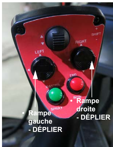
Interrupteurs des rampes gauche et droite (situés sur le levier de vitesse de la transmission hydrostatique) - Vue typique
