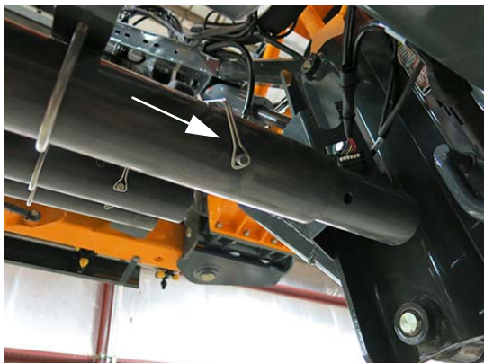
Clips de réglage du pare-broussailles (situés à l'extrémité de chaque tube) - Vue typique
