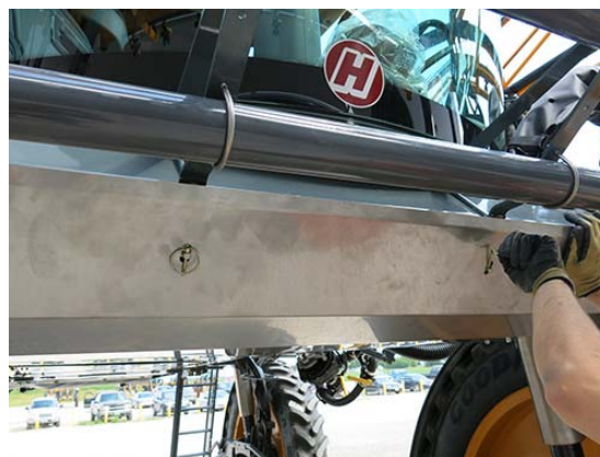
Installation du bouclier avant - Vue typique
