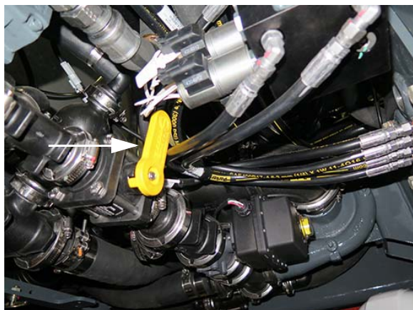
Vanne d'arrêt du brassage (située sous la partie arrière de la machine) - Vue typique
