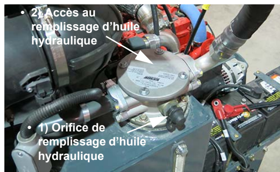
Options de remplissage d'huile hydraulique - Vue typique
