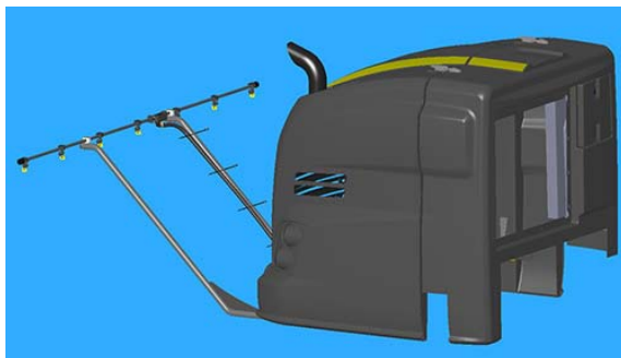
Installation de la rampe arrière - Vue typique
