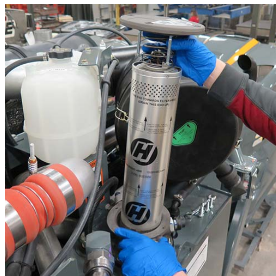
Filtre de retour (situés à l'intérieur du boîtier de filtre à air, sur le dessus du réservoir d'huile hydraulique) - Vue typique
