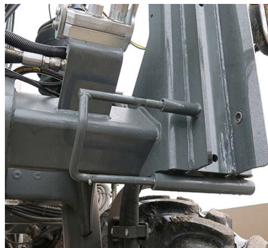
Clavette de sécurité (2) (situées à l'avant gauche et droite de la machine) - Vue typique
