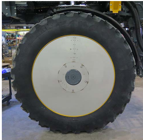
Installation du flasque de roue - Vue typique
