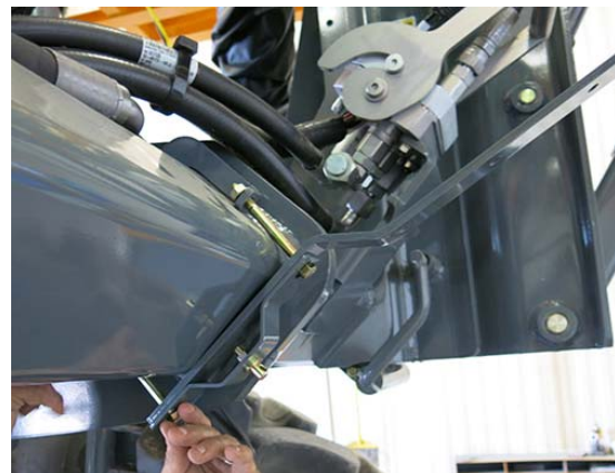
Ensemble du boulon d'ancrage - Vue typique
