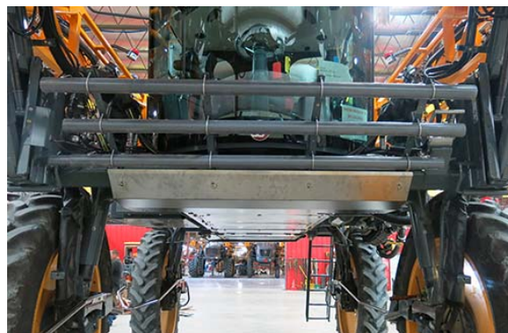
Installation du pare-broussailles - Vue typique
