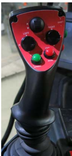
Levier de vitesse de la transmission hydrostatique - Vue typique
