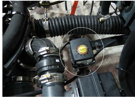
Vanne de brassage (située dans la partie centrale de la machine) - Vue typique
