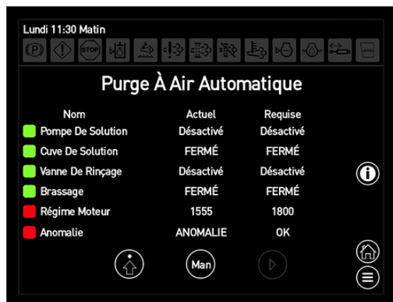
Écran Purge à air automatique
