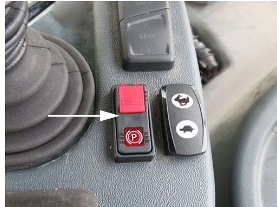
Interrupteur du frein de stationnement (situé près du levier de vitesse de la transmission hydrostatatique) - Vue typique
