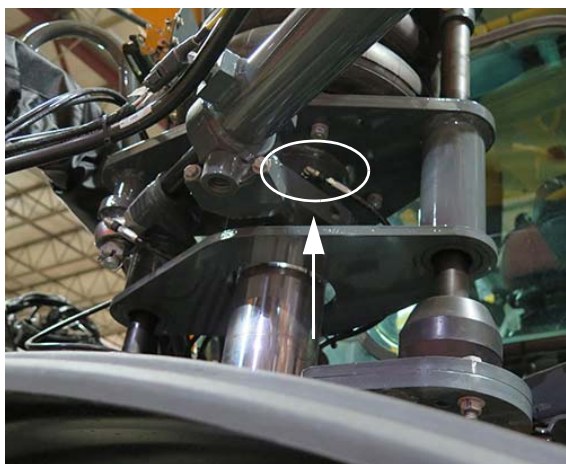
Embout de graissage de la bague (4) (situé en dessous de chaque plaque de montage des coussins d'air) - Vue typique
