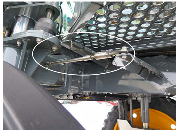
Capteur de réglage de largeur des roues (4) (situé sur chaque jambe de la machine) - Vue typique
