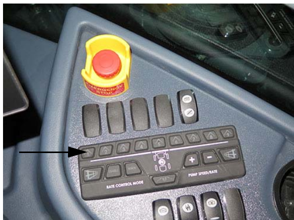
Interrupteurs des vannes de solution de la rampe - Pavé numérique de la section Produit unique (situé sur la console latérale) - Vue typique
