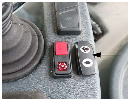
Bouton d'accélération (situé près du levier de vitesse de la transmission hydrostatique) - Vue typique
