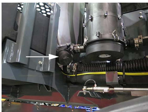
Crépine en ligne de la solution - Secondaire (situé près de l'avant droit de la machine) - Vue typique
