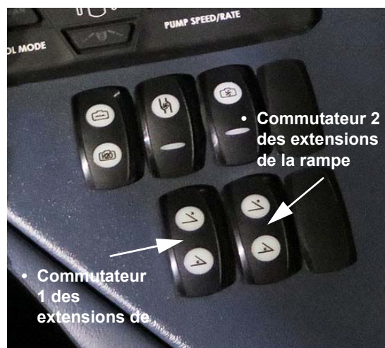
Commutateurs des extensions de la rampe - Gauche/Droit (situés sur la console latérale) - Vue typique
