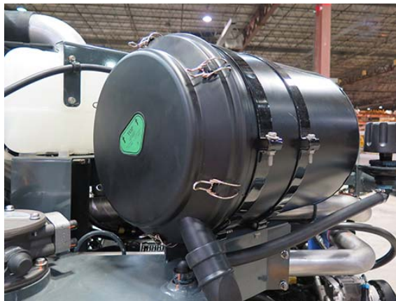
Filtre de l'admission d'air du moteur (situé sur le côté arrière gauche de la machine - ouvrez le capot pour y accéder) - Vue typique
