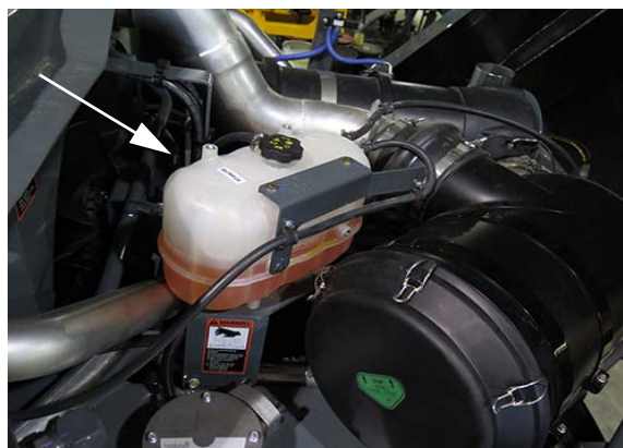
Réservoir d'équilibre (situé vers l'arrière de la machine - ouvrez le capot pour y accéder) - Vue typique
