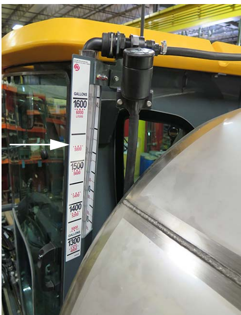
Jauge de niveau du réservoir de solution (située derrière la partie arrière gauche de la cabine) - Vue typique
