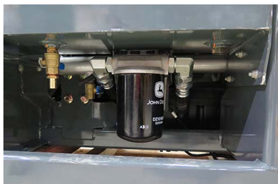
Filtre à huile moteur (situé sur le côté arrière gauche de la machine, en dessous du réservoir d'huile hydraulique) - Vue typique
