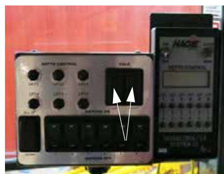
Переключатели левого/правого складывания (расположены на Пульте управления удалением метелок кукурузы) - стандартный вид
