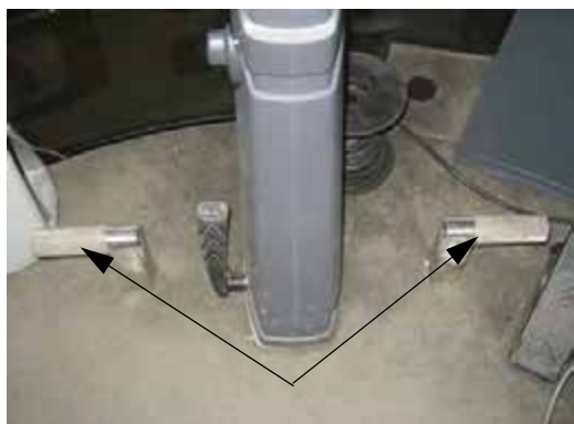
Подставки под ноги оператора (расположены с каждой стороны рулевой колонки) - Стандартный вид
