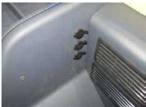
Силовые гнезда (12 В) - стандартная установка гнезд
