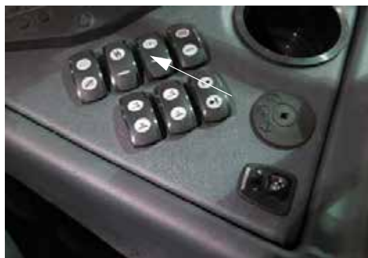
Переключатель клапана перемешивания (расположен на боковой панели) - Стандартный вид
