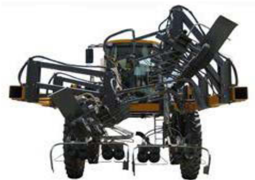
Расположенные ступенчато головки для удаления метелок кукурузы - стандартный вид
