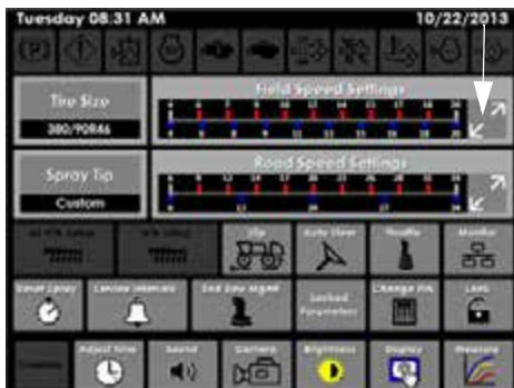
Кнопка регулировки скорости движения по полю (расположен на Странице настроек)
