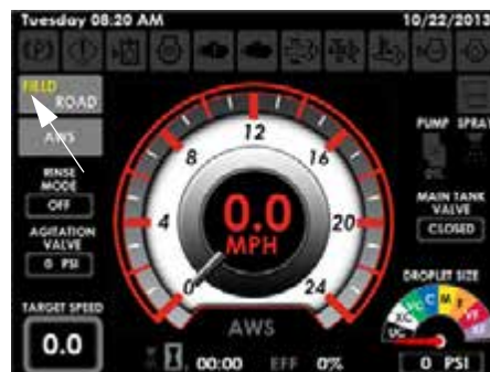
Кнопка Поле/Дорога (в левой стороне домашней страницы (режим дорога/поле)
