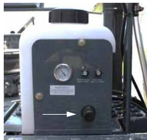
Указатель давления пены (расположен на стороне Бака индикатора пены) - стандартный вид
