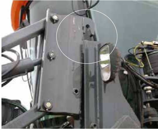
Штифт крепления для высвобождения прицепа - стандартный вид
