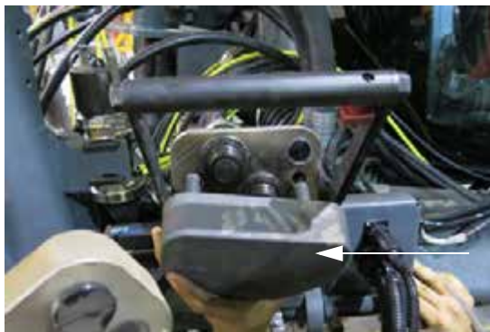
Крышка гидравлического соединения (показана правая сторона машины) - стандартный вид
