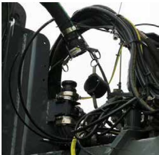
Подключение подачи раствора (на передней правой стороне машины) - стандартный вид
