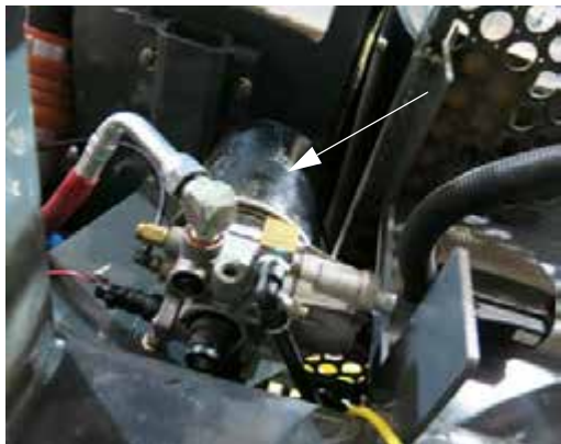
Осушитель воздуха (расположен снизу с правой стороны машины) - стандартный вид
