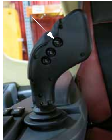
Главный контрольный выключатель (на задней части Рукоятки управления гидростатической передачей) - стандартный вид
