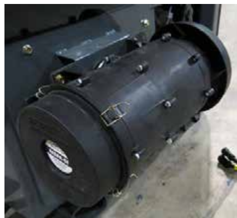
Система фильтрации кабины (расположена на правой стороне наружной поверхности кабины) - Стандартный вид
