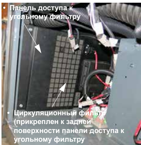
Панель доступа к угольному фильтру (расположен за эксплуатационной панелью наружной обшивки с правой стороны кабины) - Стандартный вид
