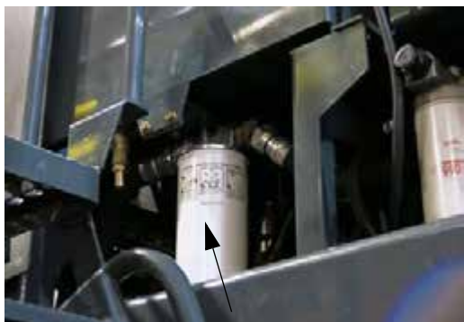
Сливной фильтр картера (расположен с левой стороны машины) - стандартный вид
