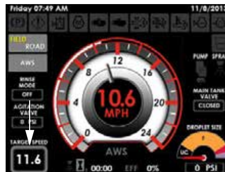
Заданная скорость (расположена в нижнем левом углу главной страницы в дорожном и полевом режимах)
