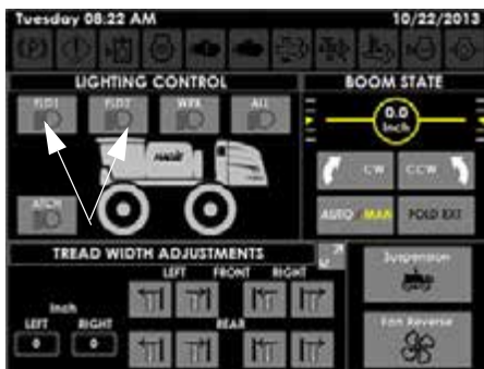
Кнопки полевого освещения (находятся на странице вспомогательных органов управления)
