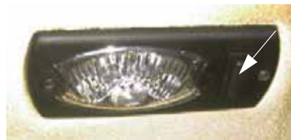
Переключатель освещения кабины - Стандартный вид
