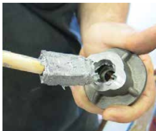
Нанесение противозадирной смазки - стандартный вид
