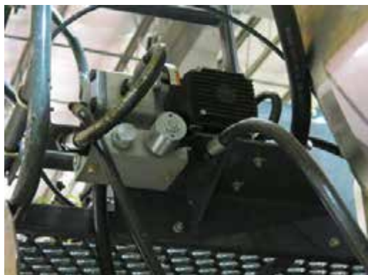
Насос мойки под давлением (расположен сзади на правой стороне машины) - стандартный вид
