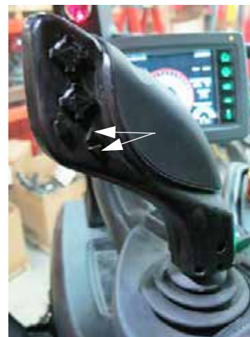
Переключатели передвижений поперечной штанги (находятся на рукоятке управления гидростатической передачей) - Стандартный вид
