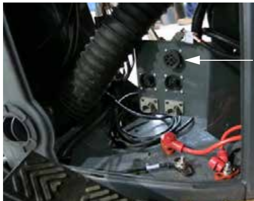
Порт диагностики двигателя (находится в середине боковой панели - для доступа необходимо снять переднюю панель) - Стандартный вид
