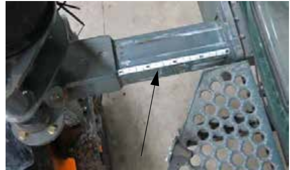
Индикаторная надпись по регулировке ширины колеи (передние опоры) – стандартный вид
