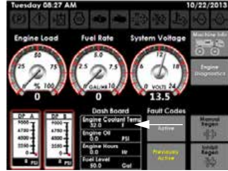
Измерительный прибор температуры охлаждающей жидкости двигателя (расположен на Странице диагностики машины)
