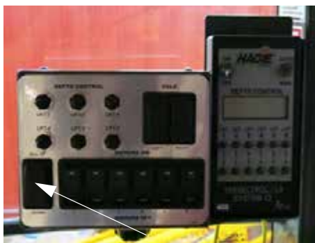
Переключатель «Все вверх/вниз» (расположен на Пульте управления удалением метелок кукурузы) - стандартный вид
