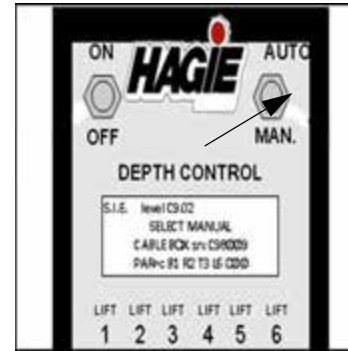
Переключатель «Автоматический/ Ручной режим» (расположен на Пульте управления Tasselrol)
