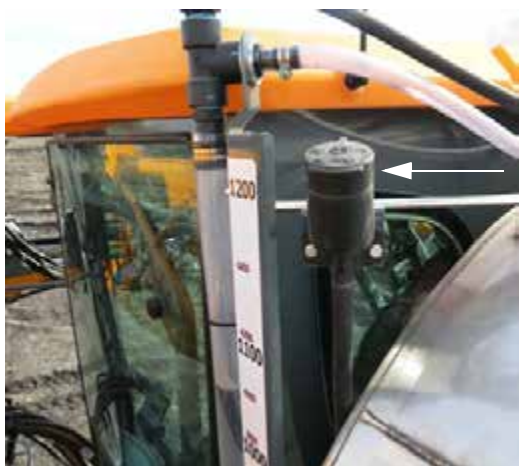
Емкость для жидкости омывателя ветрового стекла (расположена позади левой стороны кабины) - стандартный вид
