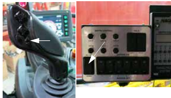
Переключатель «Все вверх/вниз» (расположен на Рукоятке управления гидростатической передачей или Пульте управления удалением метелок кукурузы) - стандартный вид
