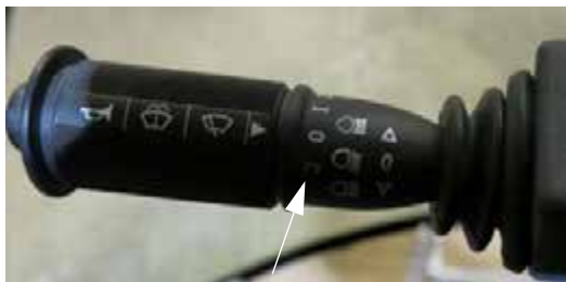
Регулятор скорости перемещения стеклоочистителя (расположен на конце рукоятки сигнала поворота) - Стандартный вид
