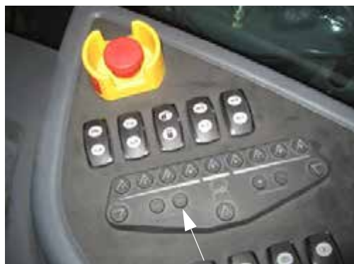
Ручной переключатель управления дозировкой «MAN» (расположен на боковой панели)
