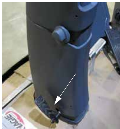
Педаль разблокировки рулевой колонки (находящаяся в левой нижней части рулевой колонки) - Стандартный вид
