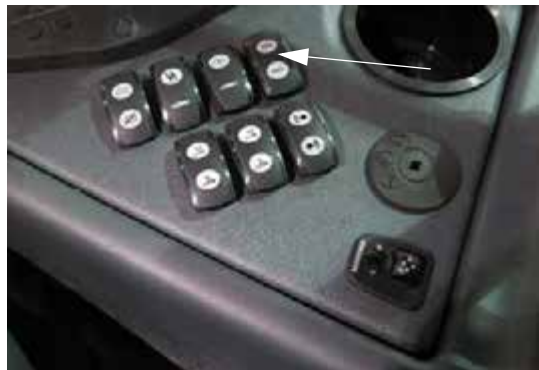
Переключатель промывки (на боковой панели) – стандартный вид
