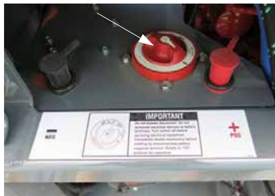
Выключатель массы батареи (расположен на задней раме) - стандартный вид
