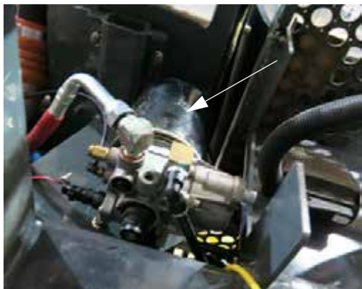
Légszárító (a gépezet alján jobb kéz felőli oldalt) – Tipikus nézet
