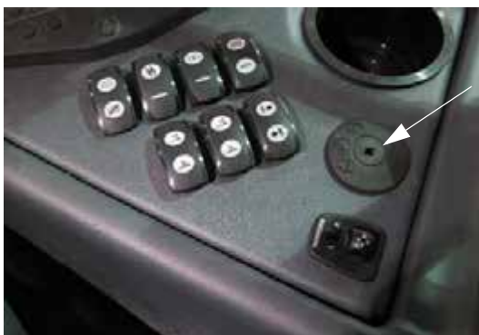
Gyújtáskapcsoló (oldalsó vezérlőpulton) – Tipikus nézet
