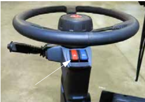
Vészjelző/figyelmeztető fények kapcsoló (a kormányoszlopon)
