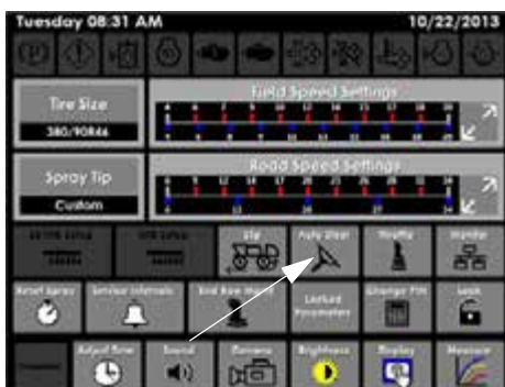
Automatikus kormányzás gombja (a beállítások oldalán)
