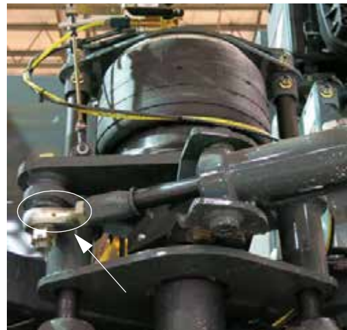
Kormány összekötő rúd gömbcsukló Zerk zsír (az első lábaknál található) – Tipikus nézet
