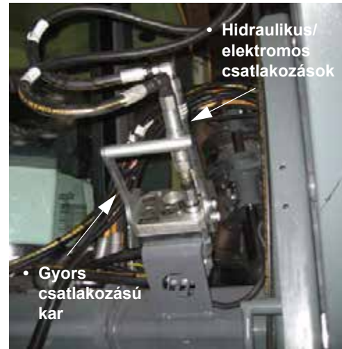
Hidraulikus/elektromos multi-csatlakozó összeszerelés – „ha fel van szerelve” (a gép elülső, bal oldalánál helyezkedik el)
