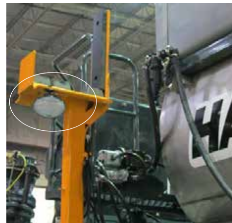
Munkalámpák (a fülke mindkét oldalán) – Tipikus nézet
