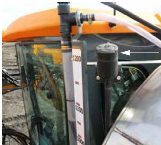
Szélvédő mosó folyadék tartály (a vezetőfülke mögött, bal kéz felől helyezkedik el) – Tipikus nézet
