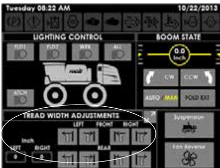
Nyomtáv be szabályozás gombok/kijelzők (a Segédvezérlések oldalán)
