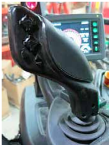
Hidrosztatikus hajtás vezérlőkarja (oldalsó vezérlőpulton) – Tipikus nézet
