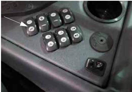
Főtartály szelep kapcsolója (oldalsó vezérlőpulton) – Tipikus nézet
