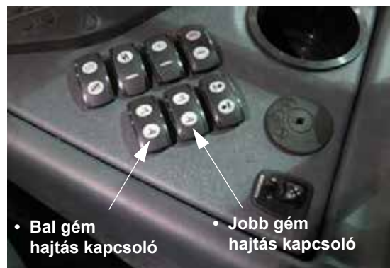
Bal és jobb gém toldalék kapcsolók (oldalsó vezérlőpulton) – Tipikus nézet
