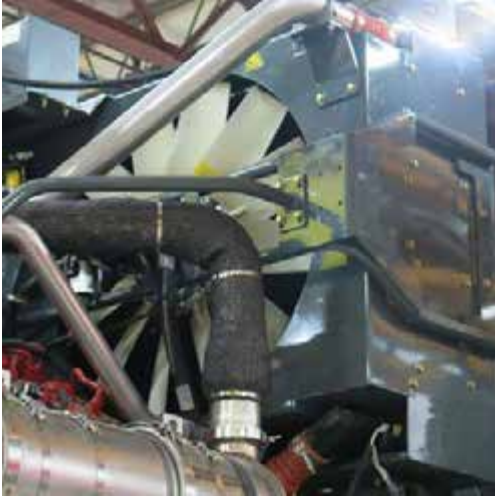
Változtatható irányú ventilátor (a gép hátulja közelében – a motorháztető kinyitásával férhet hozzá) – Tipikus nézet
