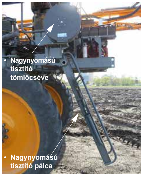
Nagynyomású tisztító rúd/ Tömlőrsó szerelvény (a gép bal oldalán a létra közelében) – Tipikus nézet
