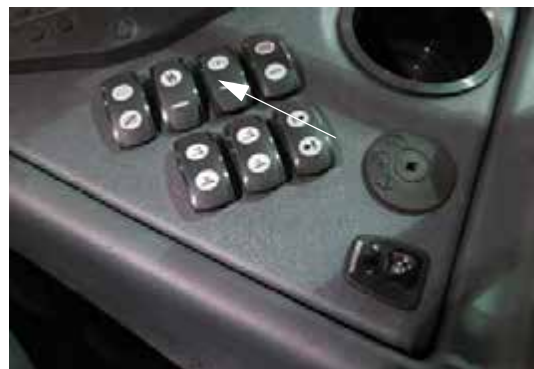
Keverőszelep kapcsolója (oldalsó vezérlőpulton) – Tipikus nézet
