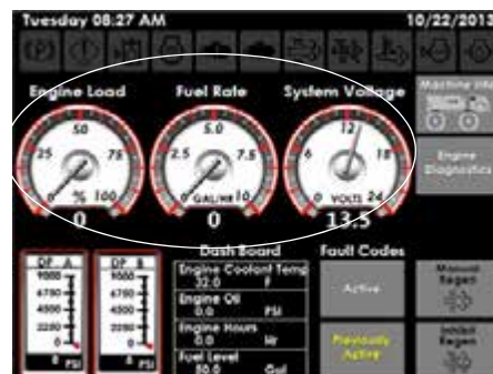
A munkagép mérőműszerei (a gépdiagnosztikai oldalon)
