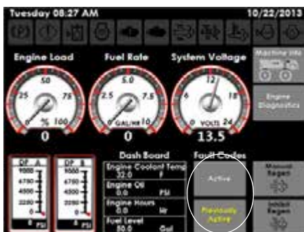
Hibadiagnosztikai gombok (a Gépdiaosztika oldal jobb oldalán)
