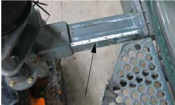
Nyomtáv beállítás jelzőmatrica (Első lábak) - Tipikus nézet
