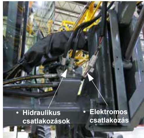
Hidraulikus/elektromos csatlakozások – “szabványos” (a gép elülső bal oldalánál helyezkedik el) – Tipikus nézet
