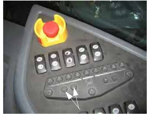
Mérték szabályzó kapcsolók (oldalsó vezérlőpulton) – Tipikus nézet
