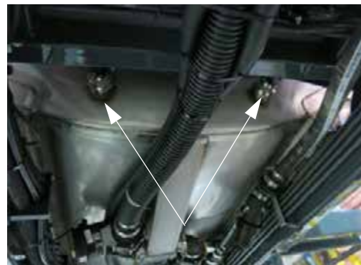
Sugár-keverők (mindegyik permetlé tartály végében kettő van elhelyezve) – Tipikus nézet
