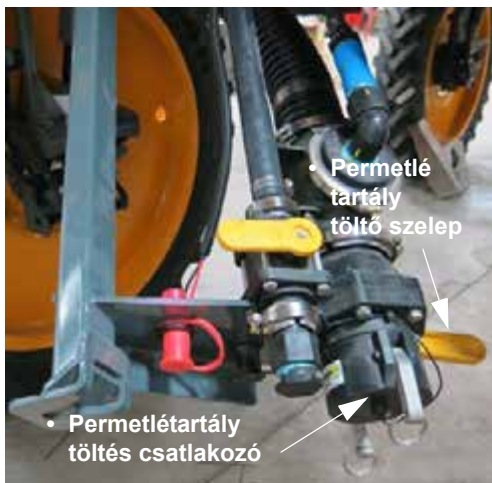
Elülső töltő összeszerelés (lentebbi pozíció látható) – Tipikus nézet
