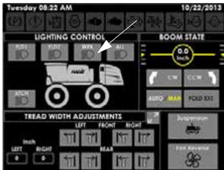
Munkalámpák gombjai (a Kiegészítő vezérlők oldalán)
