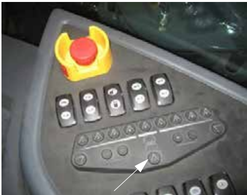
Hátsó fűvóka kapcsolója (oldalsó vezérlőpulton) – Tipikus nézet
