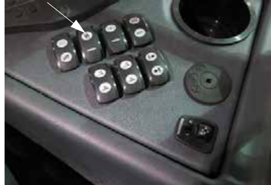
Permetlé oldat szivattyú kapcsolója (oldalsó vezérlőpulton) – Tipikus nézet
