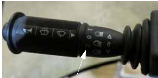
Ablaktörlő sebesség (az irányjelző kapcsolón) – Tipikus nézet
