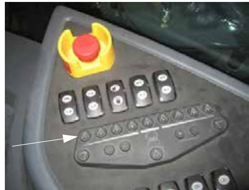
Gém permetlé szelep kapcsolók (oldalsó vezérlőpulton) – Tipikus nézet
