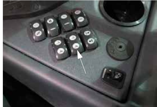
Gém toldalék kapcsoló – „Gém törésgátló” (oldalsó vezérlőpulton) – Tipikus nézet
