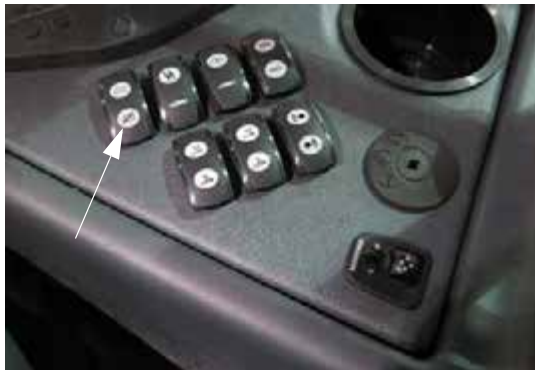
Főtartály szelep kapcsoló (oldalsó vezérlőpulton) – Tipikus nézet
