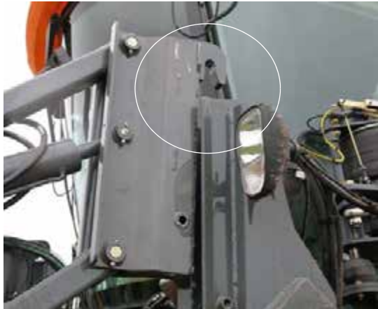
Csatolmány szerelő csap – Tipikus nézet
