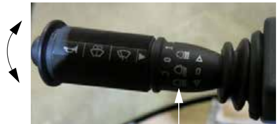
Reflektor (az irányjelző kapcsolón) – Tipikus nézet
