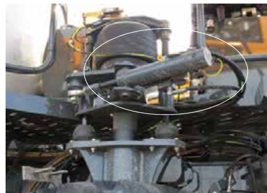
Kormány munkahenger (a hátsó lábakon) – Tipikus nézet
