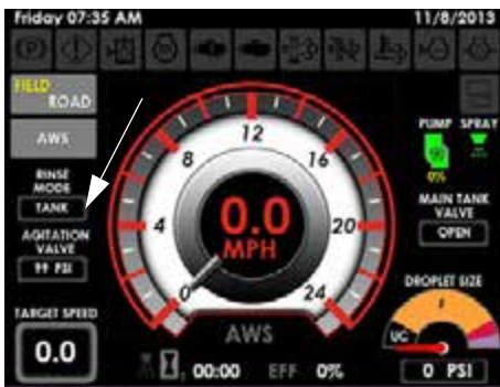
Öblítés mód kijelző (a munkagép képernyőjének kezdőoldalán – Mezei módban)
