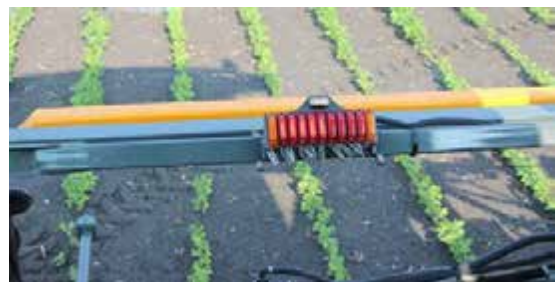
Gém permetlé szelep jelzőfények (a támasztóművön található) – Tipikus nézet
