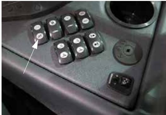
Főtartály szelep kapcsolója (oldalsó vezérlőpulton) – Tipikus nézet
