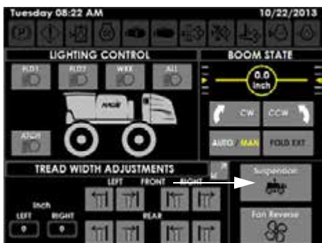
Felfüggesztés gombja (a Munkagép képernyőjének jobb kéz felőli Segédvezérlések oldalán)
