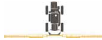
70-es permetezési szélesség behajtott gémpkarokkal a 120/132-es szerelvények esetén
