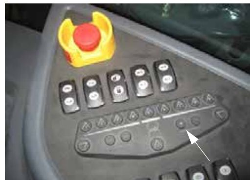
„+” szivattyú sebesség/arány kapcsoló (oldalsó vezérlőpulton) – Tipikus nézet
