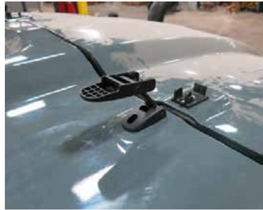
Motorháztető retesz (2) (a motorháztető mindkét oldalán) – Tipikus nézet
