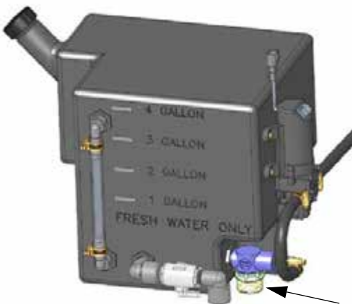
Kézmósó szűrőszita (a kézi víz tartály aljának közelében van elhelyezve)
