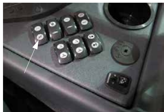
Főtartály szelep kapcsolója (oldalsó vezérlőpulton) - Tipikus nézet
