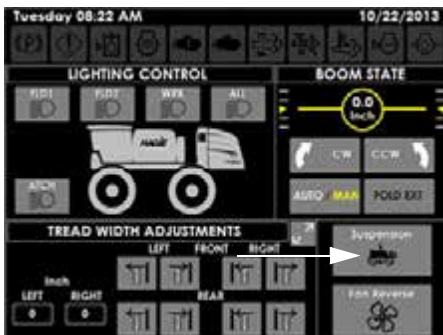
Felfüggesztés gomb (a munkagép képernyőjének Segédvezérlések oldalán)
