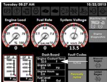
Motor hűtőfolyadék hőmérsékletét kijelző (Elhelyezve a gémen) Gépdiagnosztika oldal
