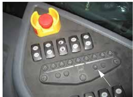
„+” szivattyú sebesség/arány kapcsoló (oldalsó vezérlőpulton) – Tipikus nézet
