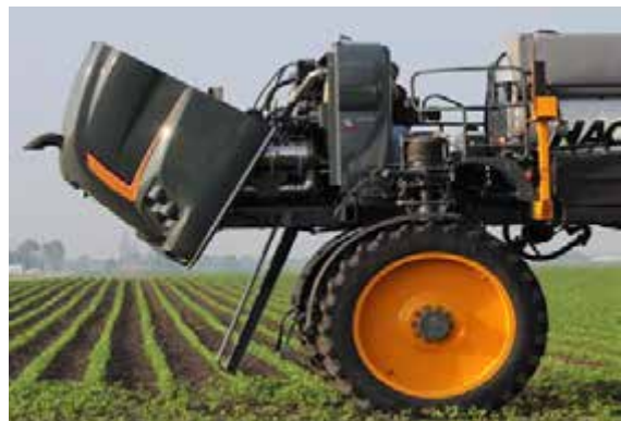
Hátsó burkolat (nyitott helyzet látható) -Tipikus nézet
