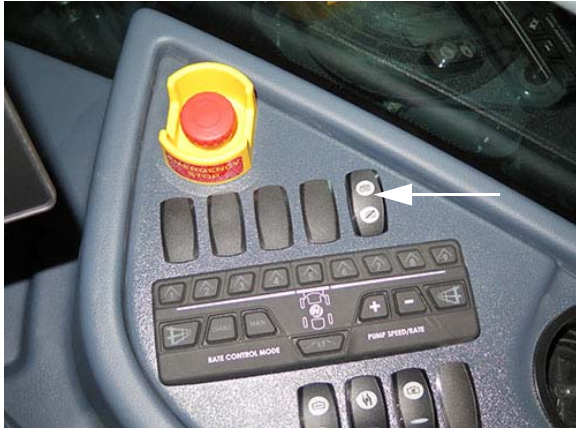
Tartály öblítő kapcsoló (az oldalkonzolon) – Tipikus nézet
