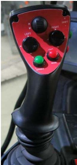
Hidrosztatikus vezérlést irányító kar – Tipikus nézet
