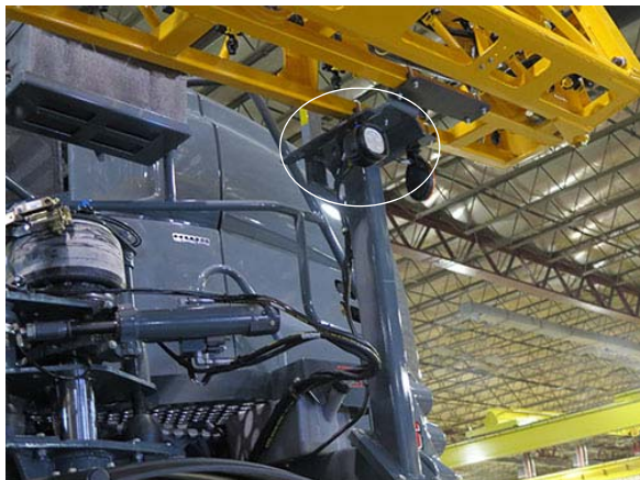
Munkalámpák (2) (a fülke mindkét oldalán) – Tipikus nézet
