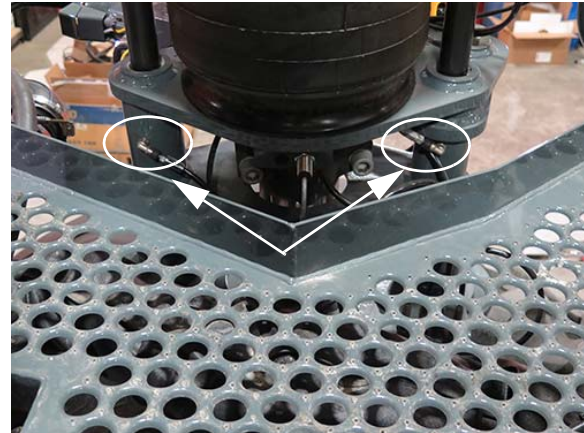
Támasz csapágy Zerk zsír (8) (az első és hátsó lábakon található) – Tipikus nézet
