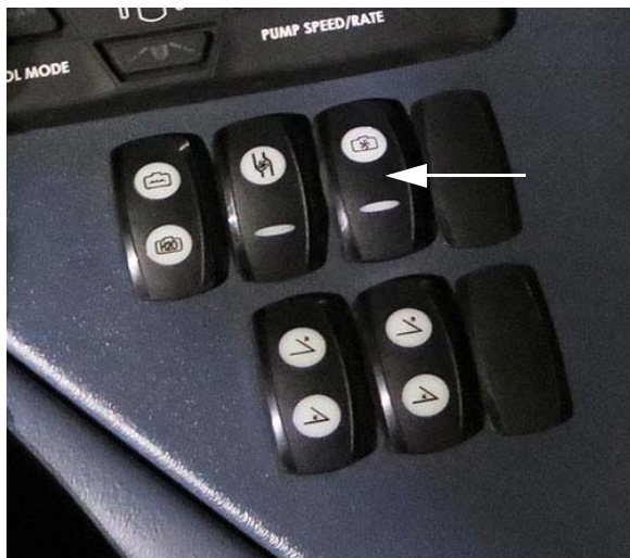
Keverőszelep kapcsolója (oldalsó vezérlőpulton) – Tipikus nézet
