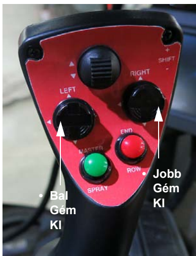
Bal és jobb oldali gémp kapcsolók (a hidrosztatikus vezérlést irányító karon) - Tipikus nézet
