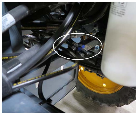
Klíma töltő nyílások (a gép jobb, hátsó oldalánál helyezkedik el - a hozzáféréshez nyissa ki a motorháztetőt) – Tipikus nézet
