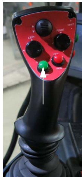
Elsődleges permetező kapcsoló (a hidrosztatikus vezérlést irányító kar hátdalán) – Tipikus nézet
