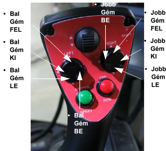
Bal és jobb oldali gémpcsolók (a hidrosztatikus vezérlést irányító karon) – Tipikus nézet
