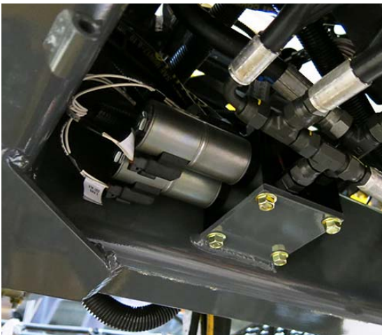
Elosztószelep (a gép alján) – Tipikus nézet
