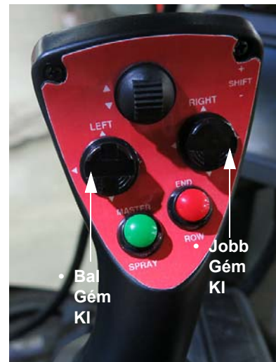
Bal és Jobb gém kapcsolók (a hidrosztatikus vezérlés irányító karon) - Tipikus nézet
