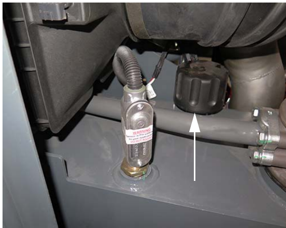
Légzősapka (a hidraulika olaj tartály tetején helyezkedik el) – Tipikus nézet
