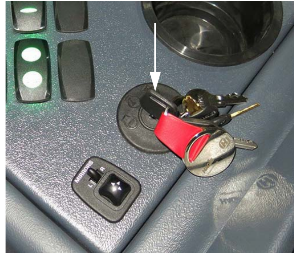
Gyújtás kapcsoló (oldalsó vezérlőpulton) – Tipikus nézet
