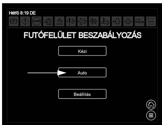
Automatikus kapcsoló (a nyomtávszélesség szabályozás képernyőjén)
