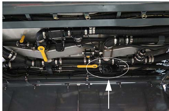
Permetezőszer csőhálózati szűrőszita - Elsődleges (a gép jobb oldalának közepe alatt) – Tipikus nézet
