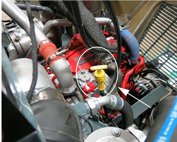
Motorolaj nívópálca (a motor bal kéz felőli oldalán van elhelyezve – a hozzáféréshez nyissa fel a motorháztetőt) – Tipikus nézet
