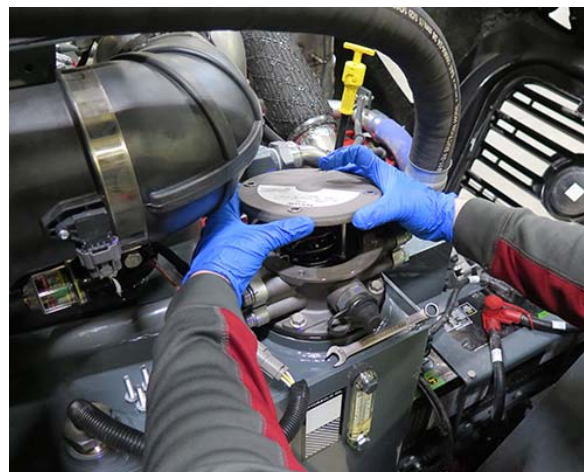
Tartály töltése a hidraulikus visszavezető szűrőházon keresztül –Tipikus nézet
