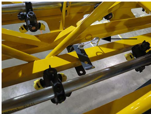
Szállítás rögzítő csap („Tárolási” helyzetben látható) – Tipikus nézet
