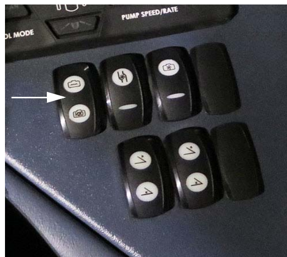
Tartály szelep választó kapcsoló (oldalkonzolon) – Tipikus nézet
