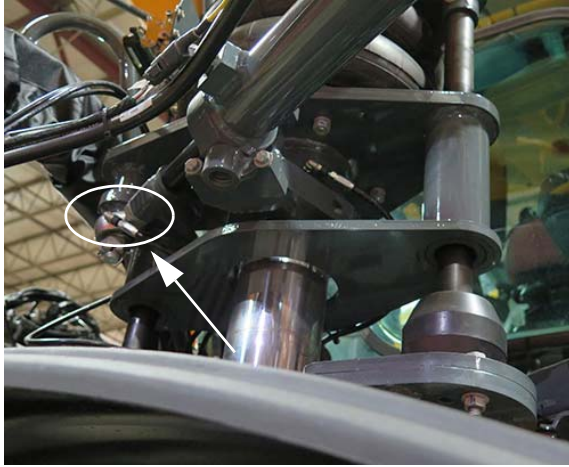
Kormány összekötő rúd (2) gömbcsukló Zerk zsír (az első lábaknál található) – Tipikus nézet
