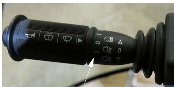
Ablaktörlő sebesség (az irányjelző kapcsolón) – Tipikus nézet
