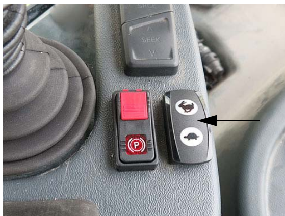
Gázasabályzó/Fojtás kapcsolója (a hidrosztatikus hajtás vezérlőkarja mellett) – Tipikus nézet
