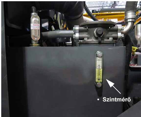
Hidraulika olaj tartály (a gép bal oldalánál van elhelyezve – a hozzáféréshez nyissa ki a motorháztetőt) – Tipikus nézet
