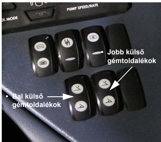
Gém toldalék kapcsolók - Bal/Jobb (oldalkonzolon) - Tipikus nézet
