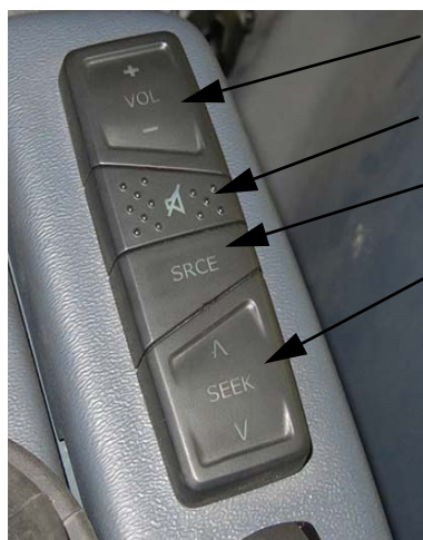
Sztereoó készülék távirányítója (a hidrosztatikus hajtás vezérlőkarja mellett) – Tipikus nézet
