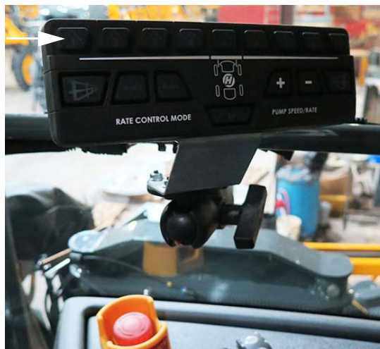
Gém permetlé szelep kapcsolók - Kettős permetlé billentyűblokk (az oldalsó konzol közelében van felszerelve) – Tipikus nézet
