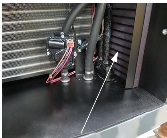
Újrakeringető szűrő (a rekesz jobb oldalánál helyezkedik el) - Tipikus nézet
