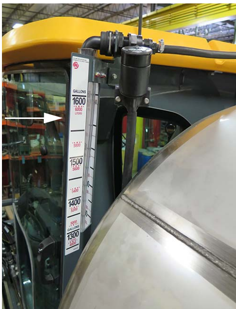
Permetlé tartály szintmérő (A fülke bal kéz felőli oldalának hátulja mögött helyezkedik el) – Tipikus nézet
