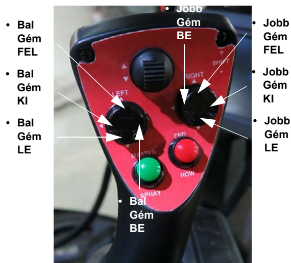
Bal és Jobb gém kapcsolók (a hidrosztatikus vezérlés irányító karon) - Tipikus nézet
