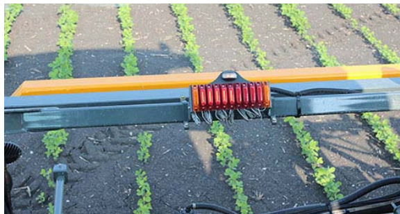
Gém permetlé-szelep állapotjelzők (támasztóművön) – Tipikus nézet
