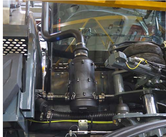
Fülke szűrőrendszer (a fülke külsejének jobb oldalán) – Tipikus nézet
