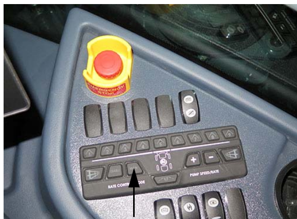
Kézi „MAN” arány szabályozó kapcsoló (oldalsó vezérlőpulton) – Tipikus nézet
