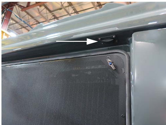
Motorháztető kapcsoló (a motorháztető hátulja mögött, a radiátor hűtőrácsa felett helyezkedik el) – Tipikus nézet
