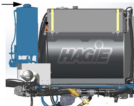
Töltő csatlakozó teteje (a permetszer tartály tetején helyezkedik el) – Tipikus nézet
