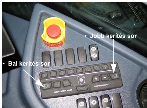
Kerítéssor kapcsolók - Bal/jobbsor (oldalsó vezérlőpulton) – Tipikus nézet
