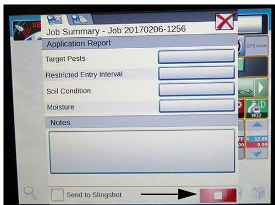
Stop gomb (a permetlé rendszer konzolján) – Tipikus nézet
