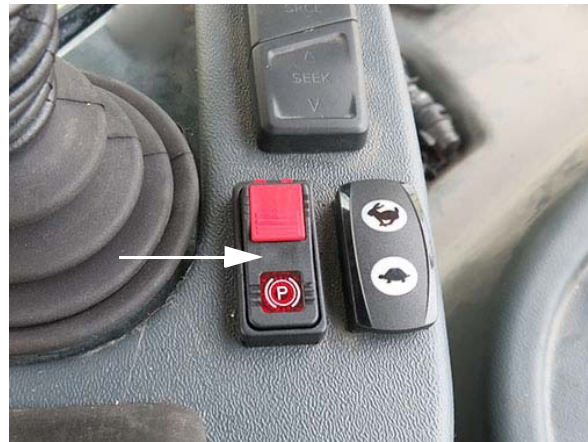
Rögzítőfék (parkolófék) kapcsoló (a hidrosztatikus vezérlést irányító kar közelében) - Tipikus nézet
