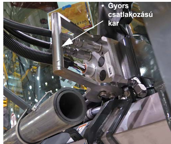
Hidraulikus/elektromos multi-csatlakozó összeszerelés (a gép elülső, bal oldalánál helyezkedik el)
