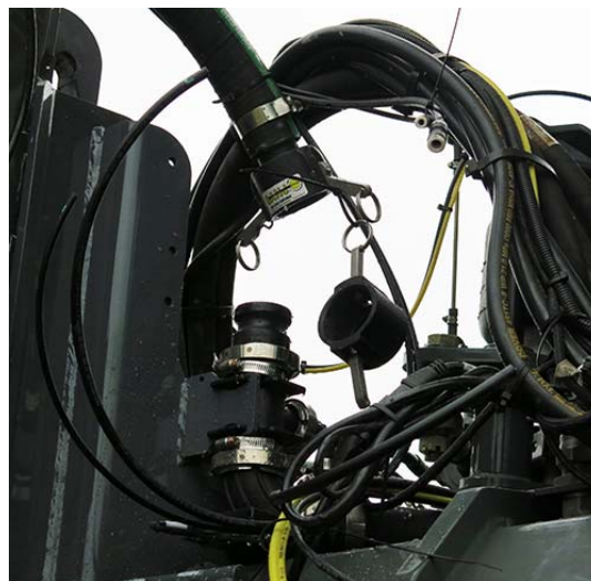
Permetezőszert vezeték csatlakoztatása - Alapfelszereltség (a gép elülső jobb oldalánál helyezkedik el) – Tipikus nézet
