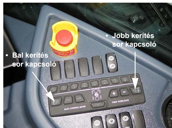
Kerítéssor kapcsolók – Bal és jobb (oldalsó vezérlőpulton) – Tipikus nézet
