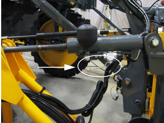
NORAC kézi szelep (2) (A szintező munkahengerek bal, és jobb oldalán helyezkedik el) – Tipikus nézet
