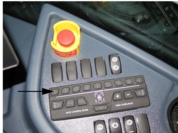
Gép permetlé szelep kapcsolók - Különálló permetlé mód, 1-9 szakaszok (oldalkonzolon) – Tipikus nézet
