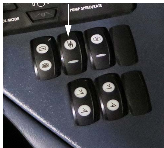
Permetlé szivattyú kapcsoló - Elsődleges (oldalkonzolon) – Tipikus nézet
