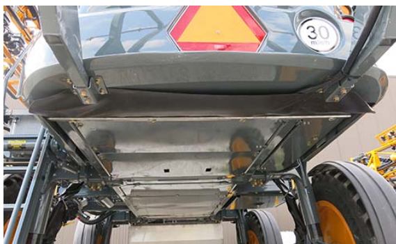
Alvázvédelmi szerelvény/súrlódásvédelmi gumifüggöny telepítés – Tipikus nézet
