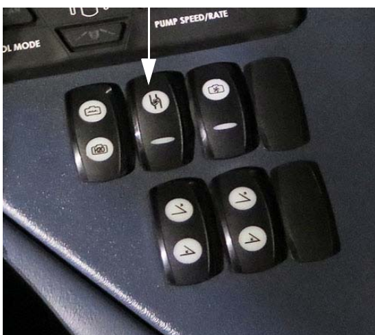
Tartály szivattyú kapcsoló (az oldalkonzolon) – Tipikus nézet
