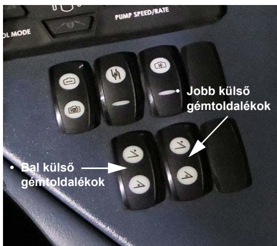
Gém toldalék kapcsolók - Bal/Jobb (oldalkonzolon) - Tipikus nézet
