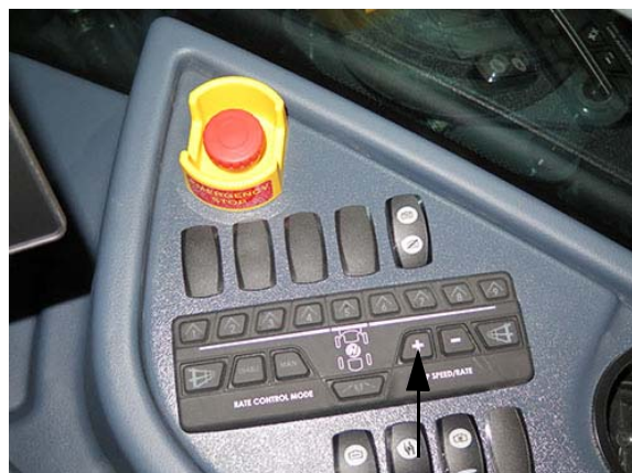
„+” Szivattyú sebesség/arány kapcsoló (oldalkonzolon) – Tipikus nézet
