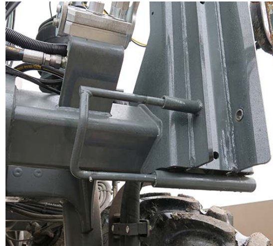
Záró csapszeg (2) (a gép elülső bal, és jobb oldalánál helyezkedik el) – Tipikus nézet
