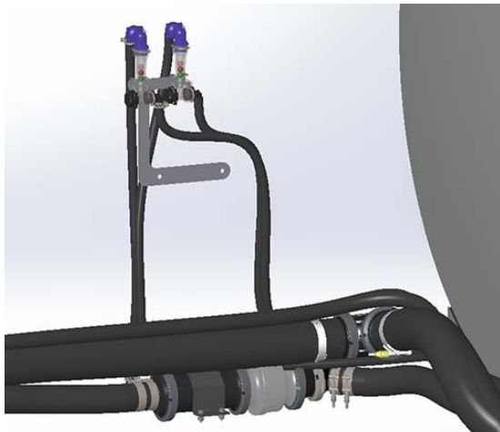
Áramlás jelzők (a fülke jobb oldalának külső részénél) – Tipikus nézet
