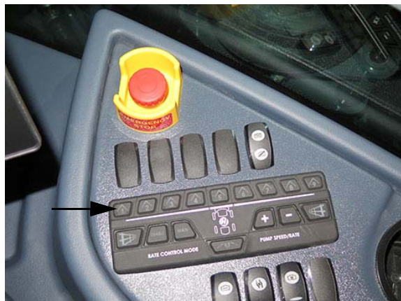
Gémpemetlé szivattyú kapcsolók (oldalkonzolon) – Tipikus nézet
