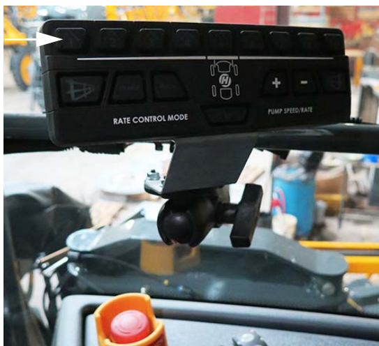
Gém permetlé szelep kapcsolók - Kettős permetlé billentyűblokk, 10-14 szakaszok (az oldalkonzolhoz közelében) – Tipikus nézet * 5-szakaszos, folyadékös gémmel
