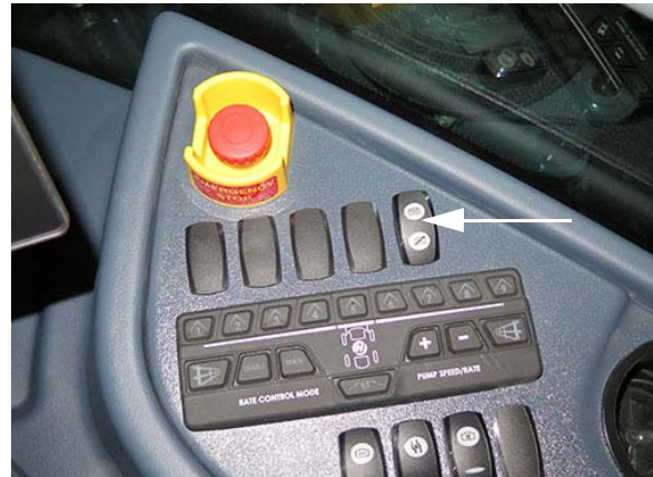
Tartály öblítés kapcsoló (oldalsó vezérlőpulton) – Tipikus nézet
