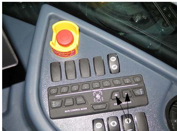
Szivattyú sebesség/Arány kapcsolók (oldalsó vezérlőpulton) – Tipikus nézet
