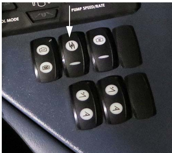
Főtartály szelep kapcsolója (oldalsó vezérlőpulton) - Tipikus nézet
