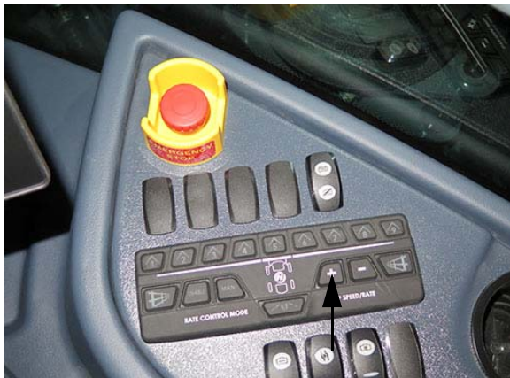
„+” Szivattyú sebesség/arány kapcsoló (az oldalkonzolon) – Tipikus nézet
