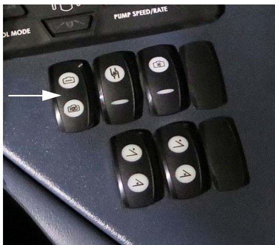
Tartály szelep választó kapcsoló (oldalkonzolon) – Tipikus nézet
