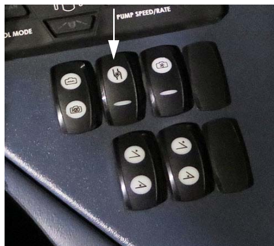
Tartály szivattyú kapcsoló (az oldalkonzolon) – Tipikus nézet
