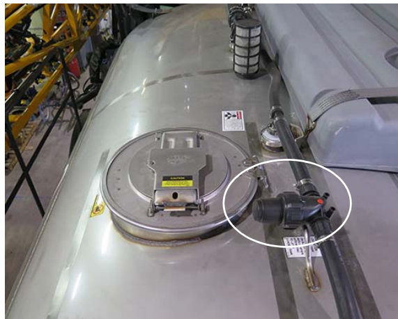
Tartály öblítő szűrőszita - rozsdamentes acél tartály (a permetlé tartály tetején helyezkedik el) – Tipikus nézet
