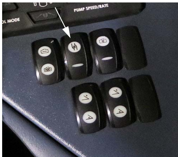
Permetlé szivattyú kapcsoló (oldalkonzolon) – Tipikus nézet
