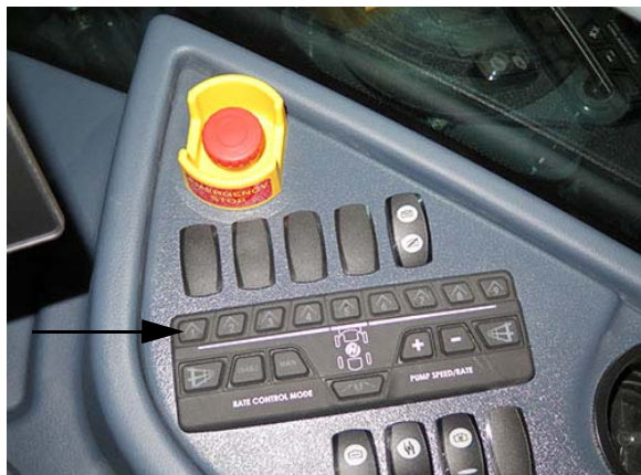
Gém permetlé szelep kapcsolók - Különálló permetlé mód, 1-9 szakaszok (oldalkonzolon) - Tipikus nézet * 9-szakaszos, folyadékös gémmel
