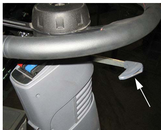
Kormánykerék teleszkóp állító fogantyú (a kormányoszlop jobb oldalán) – Tipikus nézet
