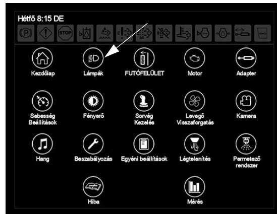
Lámpák gomb (a főmenü lapon található)
