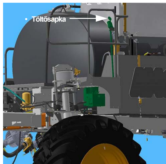
Habzás jelző tartály töltő (a hátsó jobboldali korláton található) - Tipikus nézet
