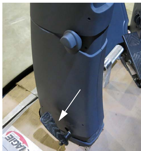
Kormányoszlop kioldó pedál (a kormányoszlop baloldalán alul) – Tipikus nézet
