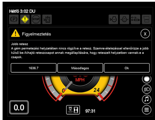
Külső gémtoldalék retesz „Nincs csatlakoztatva” hibaüzenet
