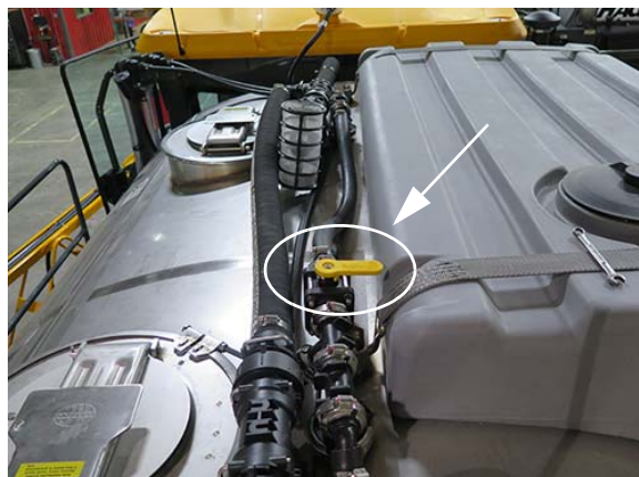
Kettős permetlé öblítő szelep (a permetlé tartály tetején) – Tipikus nézet * ZÁR helyzet (Kettős permetlé mód)
