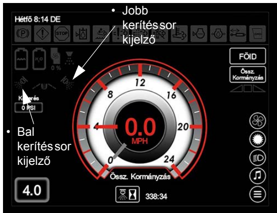
Kerítés sor kijelzők - Bal/Jobb (a munkagép kijelzőjének kezdőoldalán - Mezei üzemmód)
