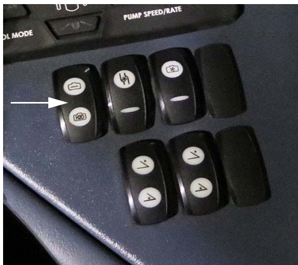
Tartály szelep választó kapcsoló (oldalkonzolon) - Tipikus nézet
