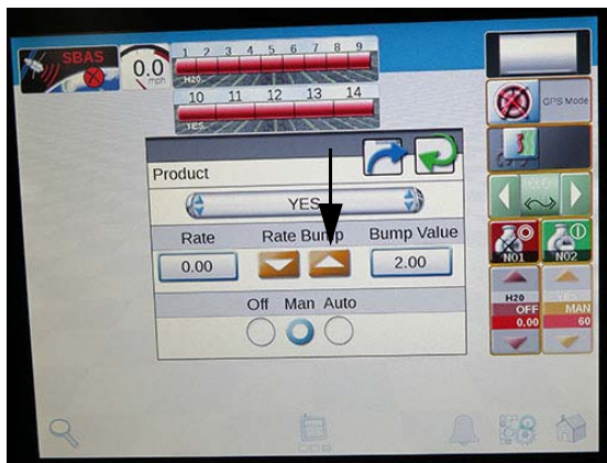
Arány növelés gomb (a permetlé rendszer konzolján) – Tipikus nézet
