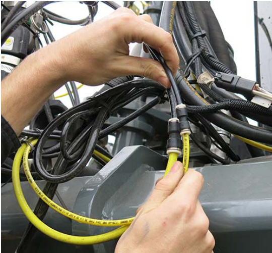
Habjelölő csatlakoztatása (a gép elülső jobb oldalánál helyezkedik el) – Tipikus nézet
