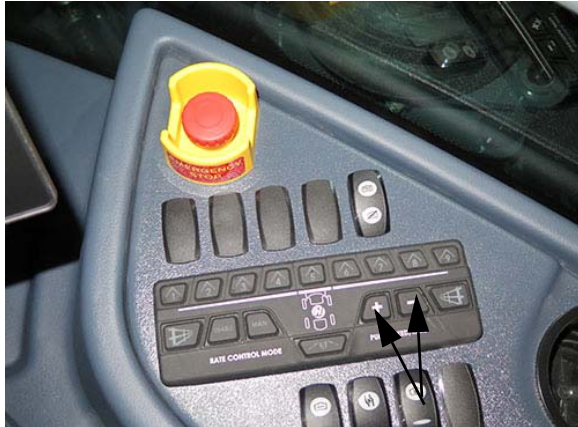
Szivattyú sebesség/Árány kapcsolók (oldalsó vezérlőpulton) – Tipikus nézet
