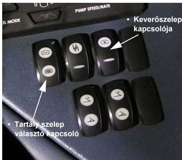
Tartály szelep választó, és keverőszelep kapcsolók (oldalkonzolon) – Tipikus nézet
