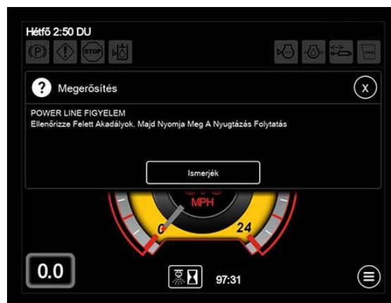
Elektromos vezeték figyelmeztető üzenet (munkagép képernyőjén található)
