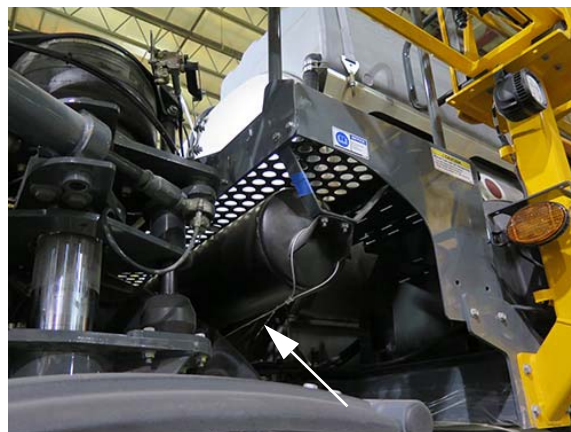
Tartály leeresztő szelep (légtisztító) - ha van ilyen (az emelvény mögött, a gép jobb oldalának középpontjának közelében) * Húzza Le a kinyitáshoz – Tipikus nézet
