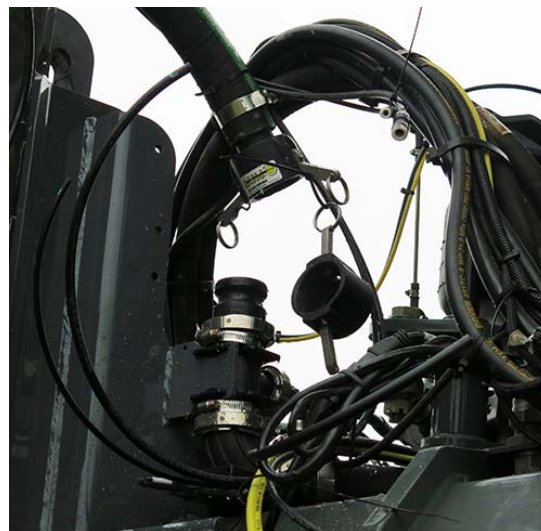
Permetezőszerszert vezeték csatlakoztatása - Alapfelszereltség (a gép elülső jobb oldalánál helyezkedik el) – Tipikus nézet
