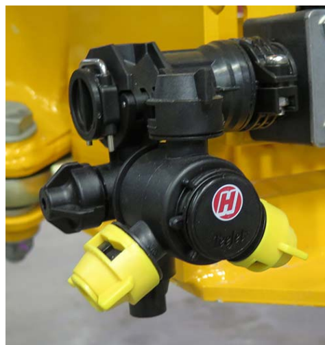
Fúvóka egység (a gémelek mentén helyezkedik el) – Tipikus nézet
