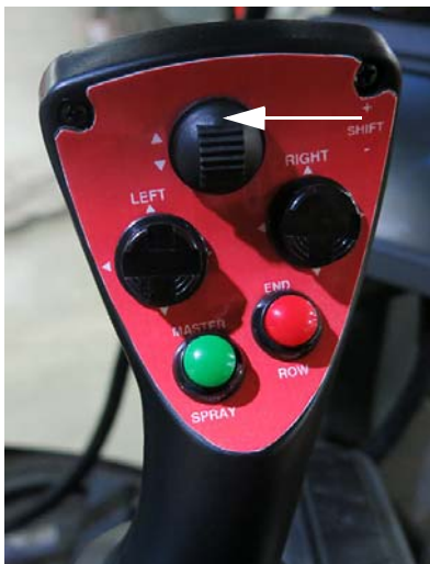
Támasztómű Kapcsoló - FEL (a hidrosztatikus vezérlést irányító karon) – Tipikus nézet
