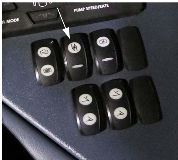
Permetlé szivattyú kapcsoló (oldalsó vezérlőpulton) – Tipikus nézet
