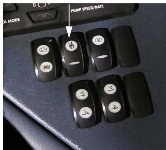
Permetlé szivattyú kapcsoló - Elsődleges (oldalkonzolon) – Tipikus nézet
