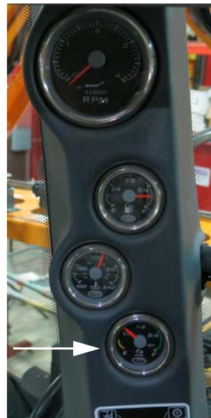
DEF műszer (a fülke a oszlopán) – Tipikus nézet
