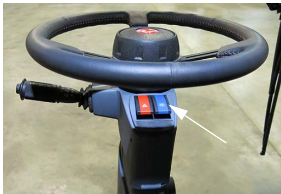
Közúti fényszórók kapcsoló (a kormányoszlopon) – Tipikus nézet
