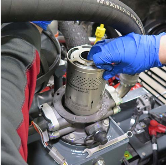
Visszatérő vezeték szűrő (a gép bal oldalán a visszatérő vezeték szűrő házában) – Tipikus nézet
