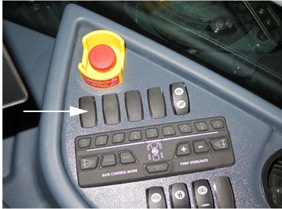
Habjelölő kapcsolója (oldalsó vezérlőpulton) – Tipikus nézet
