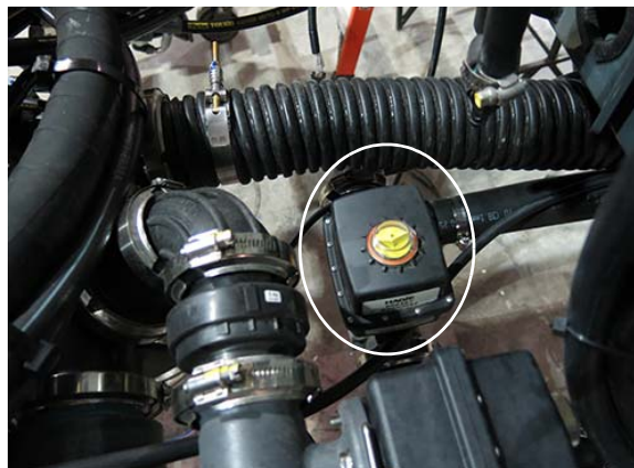
Keverőszelep (közel a gépezet közepéhez) – Tipikus nézet
