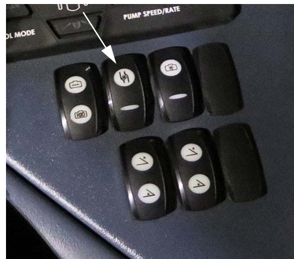
Permetlé oldat szivattyú kapcsolója (oldalsó vezérlőpulton) – Tipikus nézet
