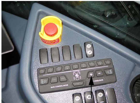
„+” szivattyú sebesség/arány kapcsoló (oldalsó vezérlőpulton) – Tipikus nézet
