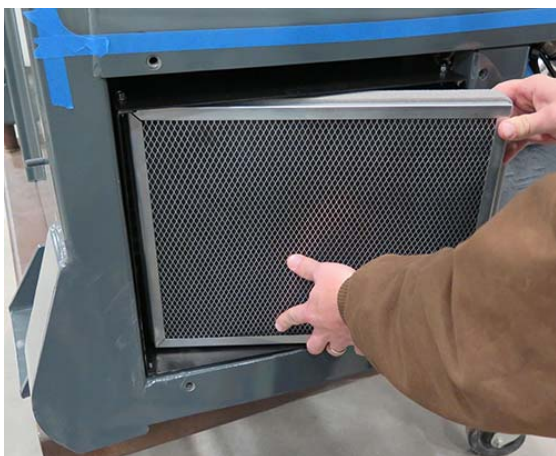
Aktívszén szűrő (a külső szerviz panel mögött helyezkedik el A vezetőfülke jobb oldalán) – Tipikus nézet
