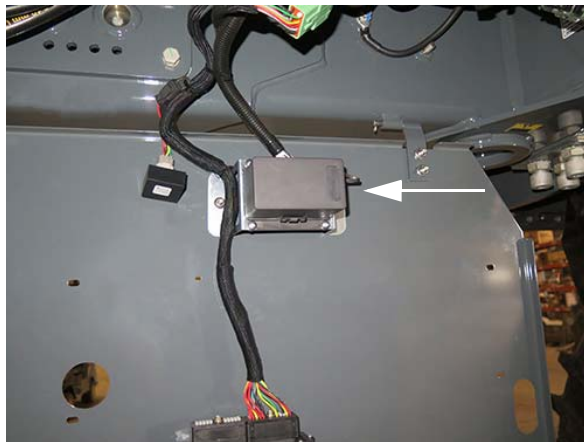
Permetlé szivattyú relé tartódoboz (A fülke előső vége alatt helyezkedik el- hozzáférés az alsó panelen keresztül) – Tipikus nézet
