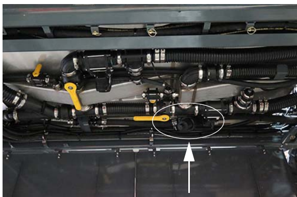
Permetezőszer csőhálózati szűrőszita - Elsődleges (a gépezet középső, jobb-kéz felőli oldalán) – Tipikus nézet
