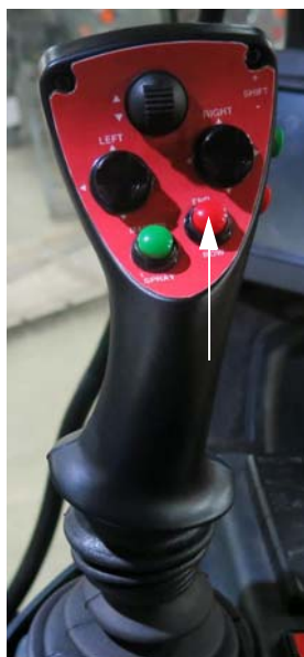
Sorvég kezelés kapcsoló (a hidrosztatikus vezérlést irányító karon) – Tipikus nézet
