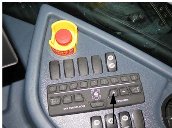
„+” szivattyú sebesség/arány kapcsoló (oldalsó vezérlőpulton) – Tipikus nézet
