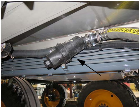
Permetezőszer csőhálózati szűrőszitája (a gépezet alján, középen jobb-kéz felőli oldalt) – Tipikus nézet
