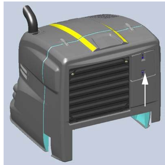
Motor Levegőbeszívó hozzáférést biztosító burkolat (a motorháztető bal oldalánál van elhelyezve) – Tipikus nézet
