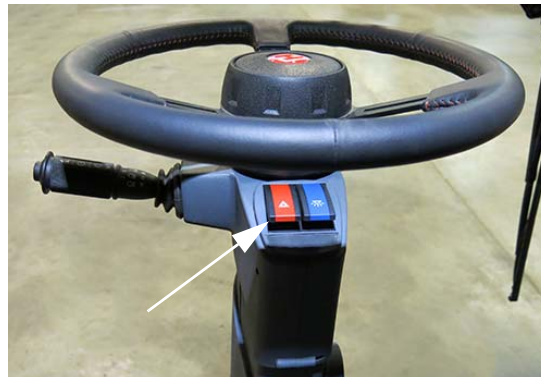
Vészjelző/figyelmeztető fények kapcsoló (a kormányoszlopon) – Tipikus nézet
