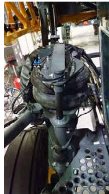
Пневмоподушка (на каждой опоре) - стандартный вид
