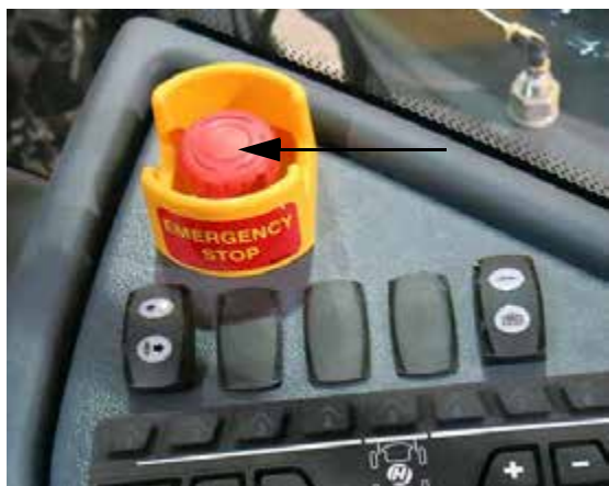
Кнопка аварийного останова E-Stop (расположена на боковой панели) - стандартный вид
