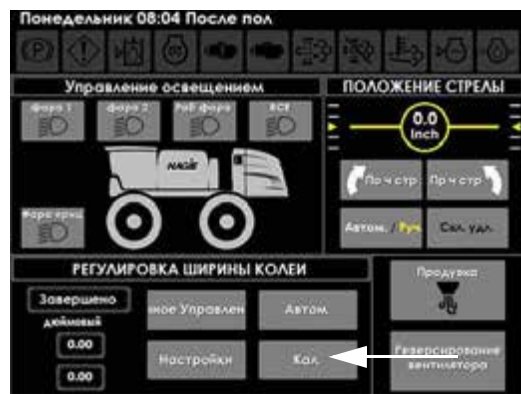
Кнопка калибровки (расположена на Странице вспомогательных элементов управления Дисплея машины)
