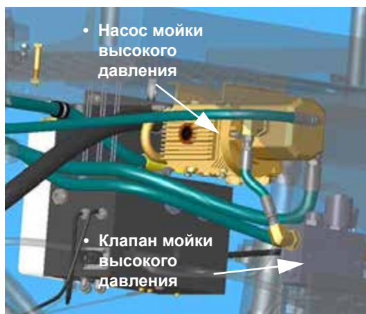
Насос/клапан мойки высокого давления (расположен под платформой на задней правой стороне машины) - стандартный вид
