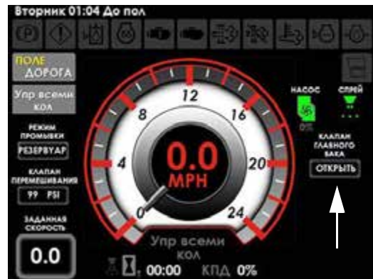
Индикатор состояния клапана главного бака (расположен на Главной странице дисплея машины - в Полевом режиме)
