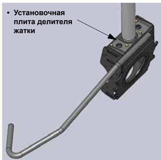
• Установочная плита делителя жатки Монтаж установочной плиты/болта (вариант подпорки для тяжелых режимов работы) - стандартный вид
