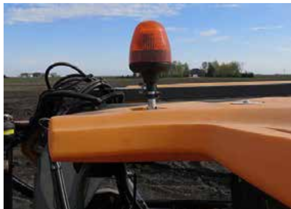
Проблесковые маячки (2) (расположены с каждой стороны переднего покрытия крыши) - стандартный вид
