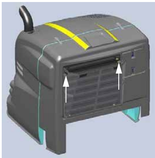
Пружинные зажимы воздухозаборника двигателя (расположены на верхней левой и правой сторонах внутреннего воздухозаборника) - стандартный вид
