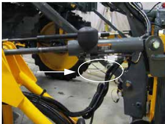
Клапан с ручным приводом NORAC (2) - если установлен (расположен на левом и правом цилиндрах уровня) - стандартный вид * показан правый цилиндр уровня
