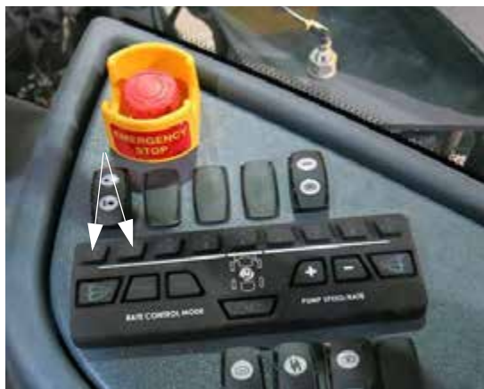
Переключатели 1 и 2 клапана подачи раствора в штангу (расположены на боковой панели) - стандартный вид
