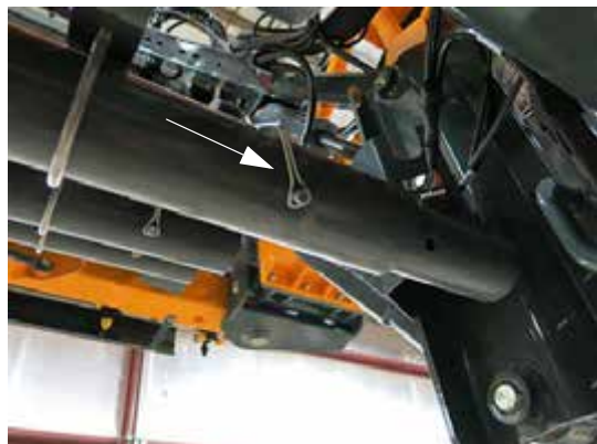
Регулировочный зажим щеточного ограждения (расположен на конце каждой трубы) - стандартный вид
