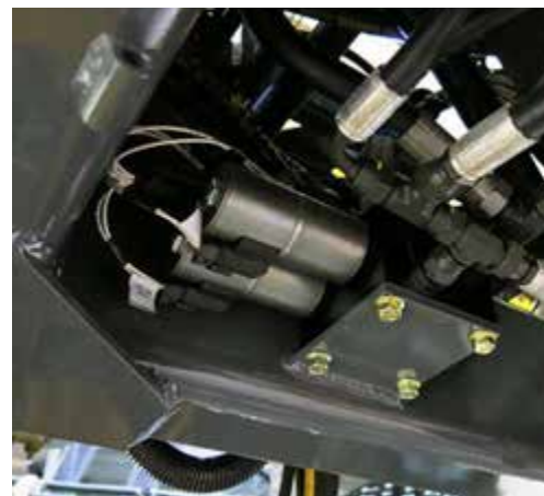
Групповой распределительный золотник (расположен на днище кузова) - стандартный вид
