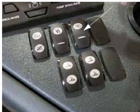
Переключатель клапана перемешивания (расположен на боковой панели) - стандартный вид
