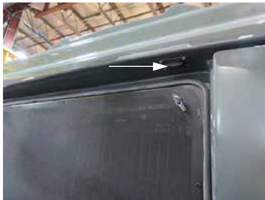
Переключатель капота (расположен перед задним капотом над жалюзи радиатора) - стандартный вид
