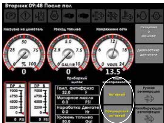
Кнопки кодов неисправности (расположены на странице Диагностики машины)
