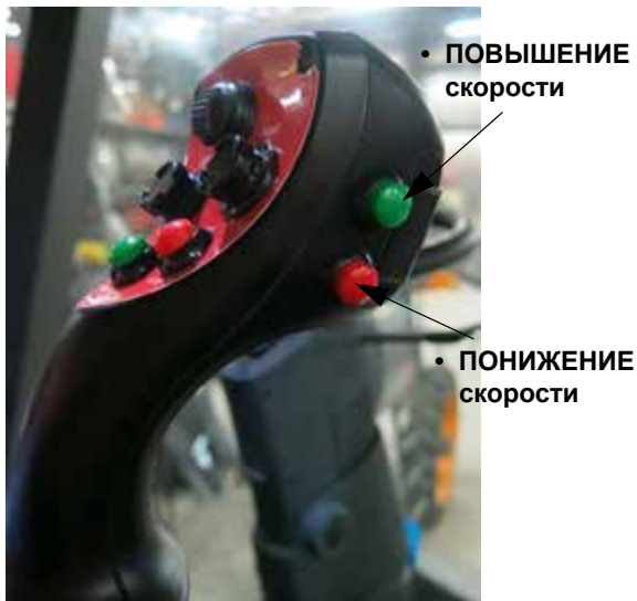
Переключатели Shift Up и Shift Down (расположены сбоку Рукоятки управления гидростатической передачей) - стандартный вид
