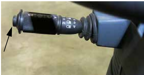
Кнопка звукового сигнала (расположена на конце рукоятки сигнала поворота) - стандартный вид
