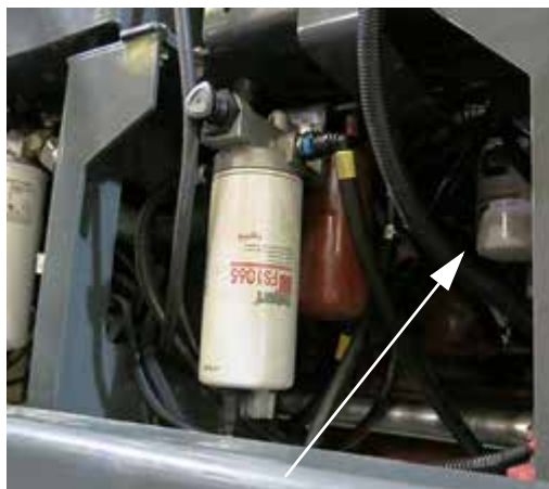
Масляный фильтр двигателя (расположен вдоль левой стороны машины – для доступа откройте капот) - стандартный вид
