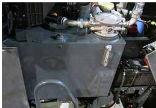
Бак масла для гидросистем (расположен на левой стороне машины, откройте капот для доступа) - стандартный вид
