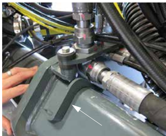
Монтажный кронштейн щеточного ограждения (показана правая сторона машины) - стандартный вид
