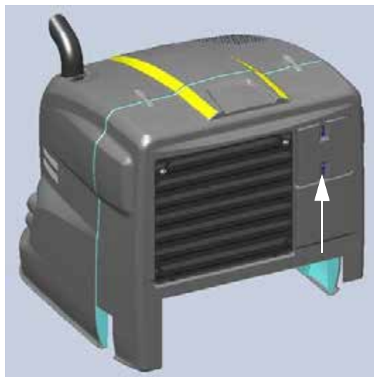
Панель доступа к фильтру впуска воздуха в двигатель (расположена на левой стороне капота) - стандартный вид
