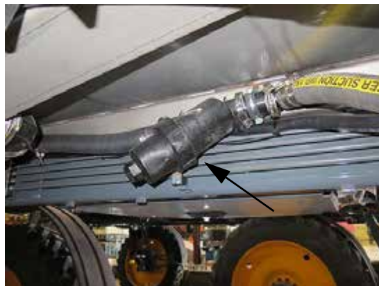
Сетчатый фильтр затворной линии (расположен снизу с правой стороны машины) - стандартный вид
