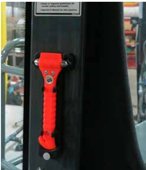
Инструмент запасного выхода (расположен вдоль задней правой стороны кабины) - стандартный вид
