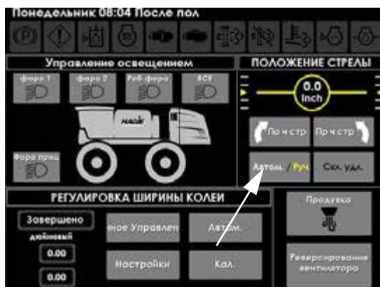
Кнопка состояния штанги – Авто/Ручное (на Странице вспомогательных органов управления дисплея машины)
