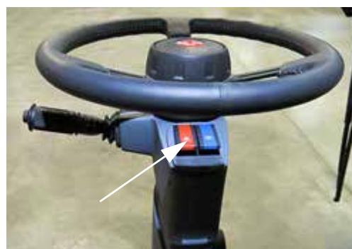
Переключатель сигнальных ламп поворотов и аварийных сигналов (расположенный на рулевой колонке) - стандартный вид
