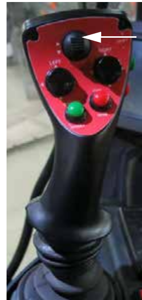
Переключатель поперечины – Вверх (расположен на Рукоятке управления гидростатической передачей) - стандартный вид
