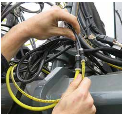
Штуцер индикатора пены (расположен спереди на правой стороне машины) - стандартный вид
