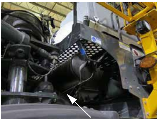
Спускной клапан бака (продувочный) – если установлен (расположен под платформой в центре возле правой стороны машины)
