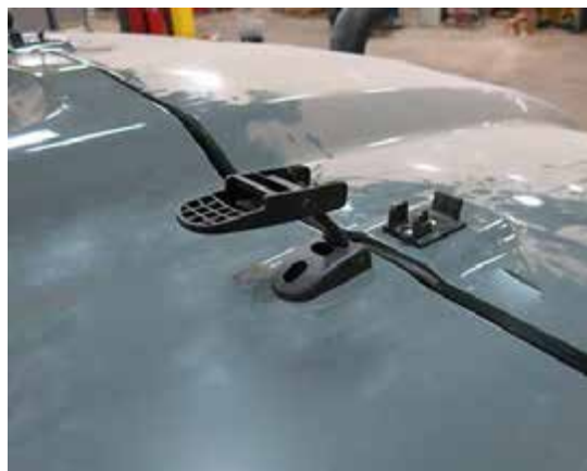
Защелка капота (2) (расположена с обеих сторон верхнего капота) - стандартный вид
