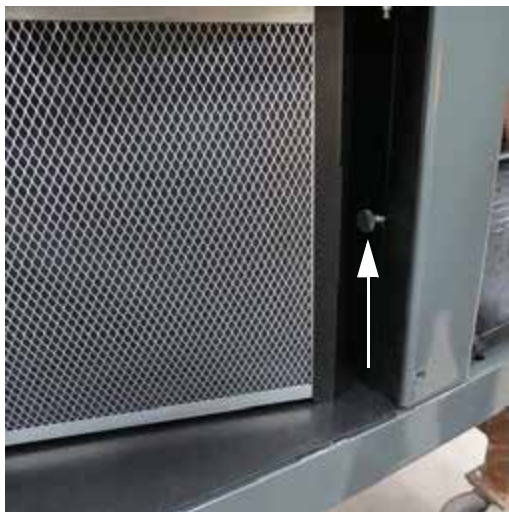
Винт безопасности (расположен вдоль внутренней стороны отделения фильтра) - стандартный вид
