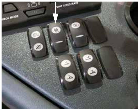
Переключатель насоса подачи раствора (расположен на боковой панели) - стандартный вид
