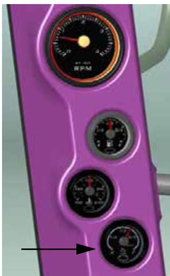
Датчик DEF (расположен на А-стойке кабины) - стандартный вид
