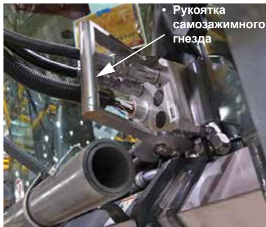
Узел комбинированной гидравлико-электрической муфты с самозажимным гнездом (расположен спереди на левой стороне машины)
