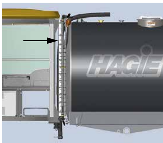
Смотровой указатель бака для раствора (расположен за задней левой стороной кабины) - стандартный вид
