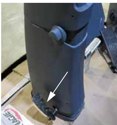
Педаль разблокировки рулевой колонки (находящаяся в левой нижней части рулевой колонки) - стандартный вид
