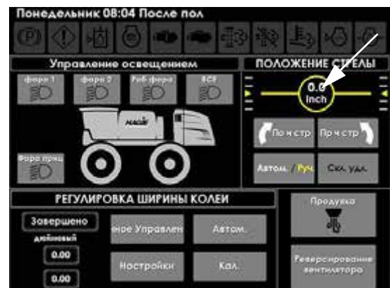
Значение центрирования штанги (с правой стороны Страницы вспомогательных элементов управления на дисплее машины)
