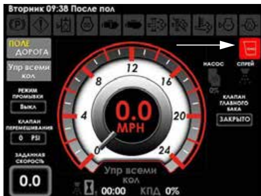
Индикатор недостаточного давления воздуха в кабине (расположен на Главной странице дисплея машины – в Дорожном или Полевом режиме)
