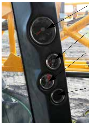
Панель приборов машины (расположена в кабине на стойке А) - стандартный вид
