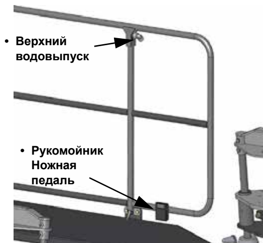
Верхний водовыпуск/ ножная педаль рукомойника (установлены на левом поручне возле дверцы кабины) - стандартный вид
