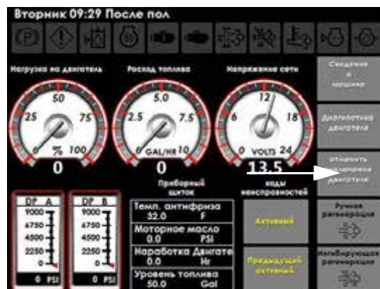
Кнопка блокировки остановки двигателя (расположена на странице Диагностики машины)
