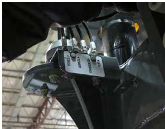
Ряд масленок Зерка (4) (расположен спереди каждой опоры) - стандартный вид
