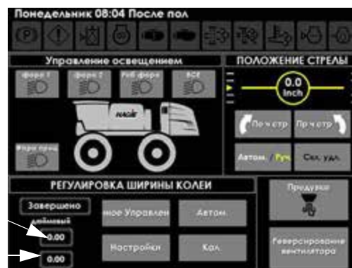
Индикаторы ширины передней/задней колеи (расположены на Странице вспомогательных элементов управления Дисплея машины)
