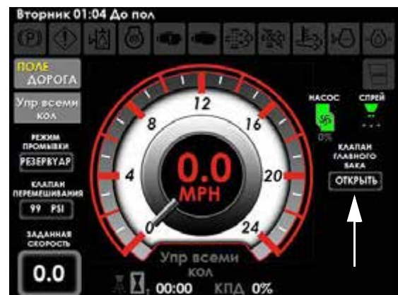
Индикатор состояния клапана главного бака (расположен сверху справа на Главной странице дисплея машины - Полевой режим)
