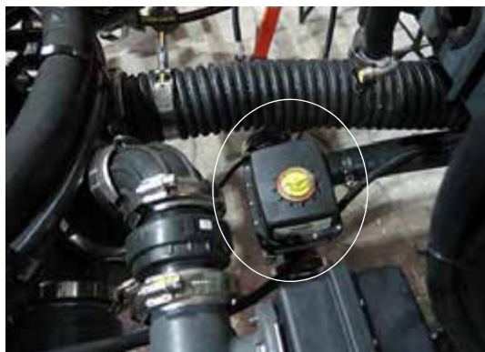
Клапан перемешивания (расположен рядом с центром машины) - стандартный вид * Вид с верхней части машины
