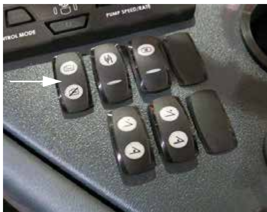
Переключатель клапана главного бака (расположен на боковой панели) - стандартный вид
