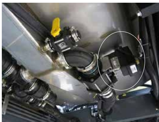
Клапан бака для раствора (расположен под баком для раствора снизу машины) - стандартный вид
