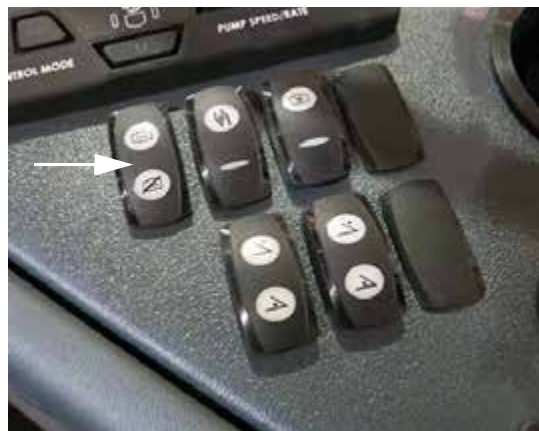
Переключатель клапана главного бака (расположен на боковой панели) - стандартный вид
