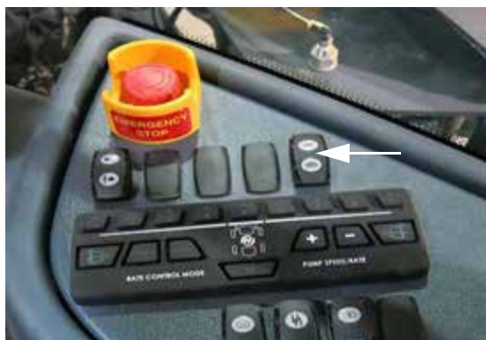
Переключатель промывки (расположен на боковой панели) - стандартный вид
