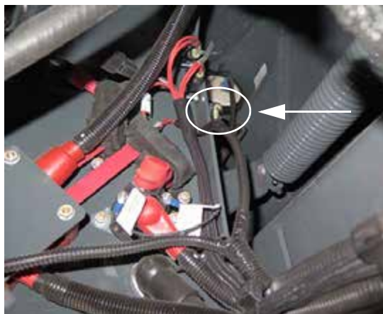
Предохранитель привода капота (расположены под задней левой стороной машины) - стандартный вид
