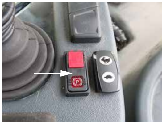
Переключатель стояночного тормоза (расположен возле Рукоятки управления гидростатической передачей) - стандартный вид
