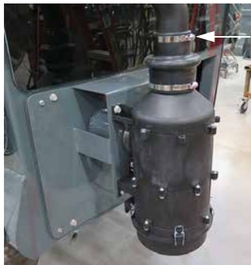
Зажим фланца – верх (расположен около верха фильтрационной установки RESPA) - стандартный вид
