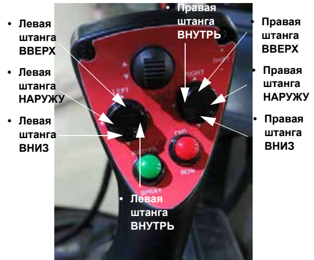
Переключатели выдвижения левой и правой штанг (расположен на Рукоятке управления гидростатической передачей) - стандартный вид
