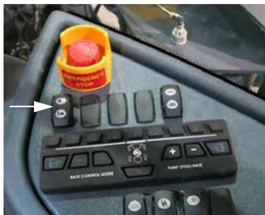
Переключатель индикатора пены (расположен на боковой панели) - стандартный вид
