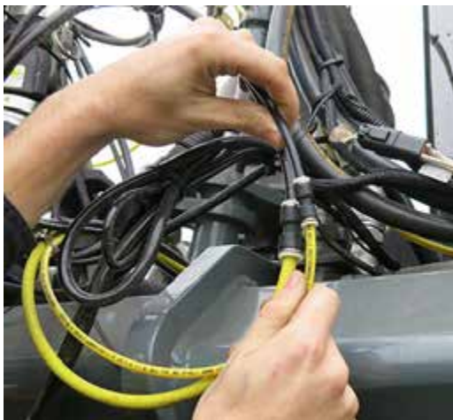
Штуцер индикатора пены (расположен спереди на правой стороне машины) - стандартный вид
