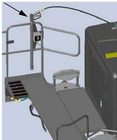
Ствол мойки высокого давления (установлен на заднем правом поручне) - стандартный вид
