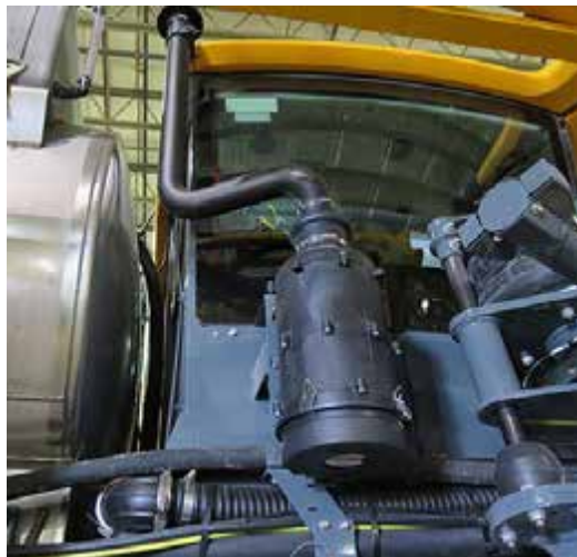
Система фильтрации кабины (расположена на правой стороне наружной поверхности кабины) - стандартный вид
