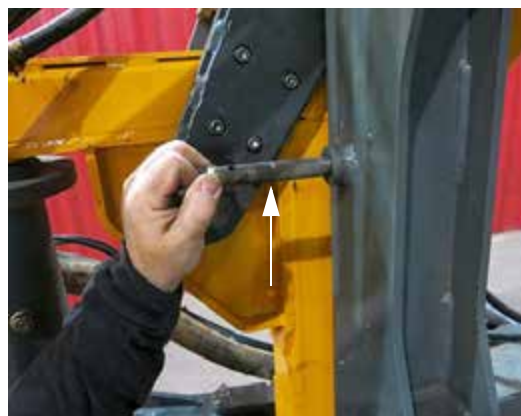
Монтажный болт (расположен снаружи рамы поперечины) - стандартный вид
