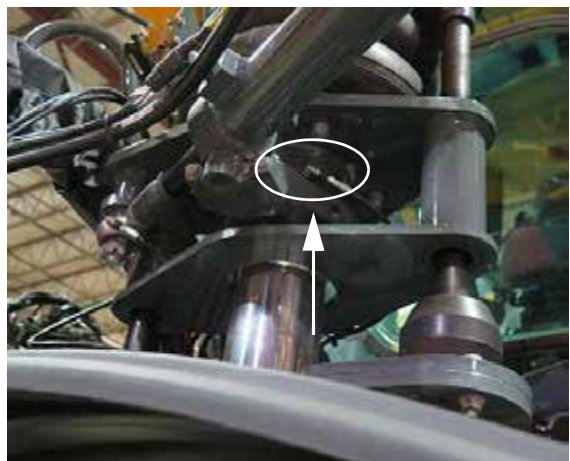
Масленка Зерка хомута (4) (под установочной плитой пневмоподушки) - стандартный вид
