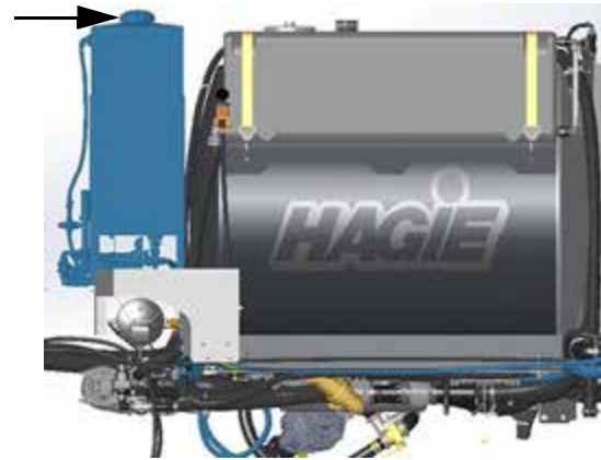
Крышка заправочного отверстия (расположена сверху бака для химикатов) - стандартный вид
