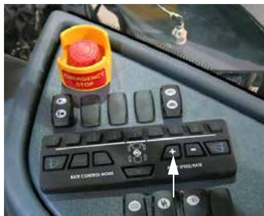
«+» Переключатель частоты вращения/расхода насоса (расположен на боковой панели) - стандартный вид
