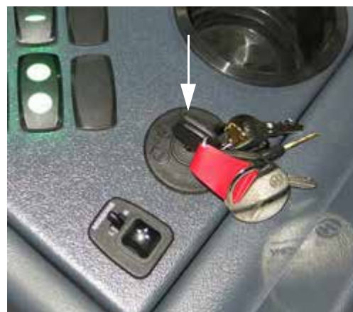
Выключатель зажигания (расположен на боковой панели) - стандартный вид
