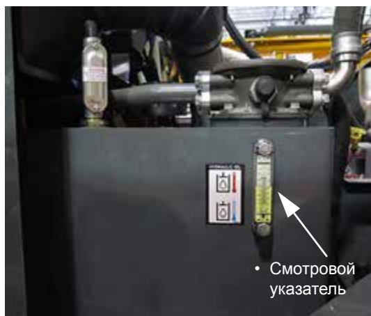
Гидробак (расположен на левой стороне машины, откройте капот для доступа) - стандартный вид
