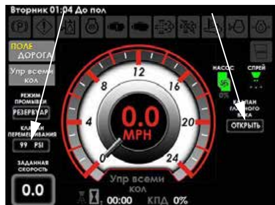
Индикаторы состояния главного бака и давления в клапане перемешивания (на Главной странице дисплея машины – Полевой режим)
