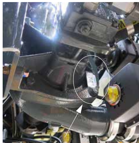
Идентификационная пластина насоса подачи раствора * Показан вид снизу машины - стандартный вид
