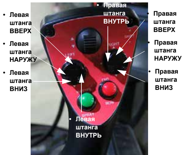
Переключатели выдвижения левой и правой штанг (расположены на Рукоятке управления гидростатической передачей) - стандартный вид
