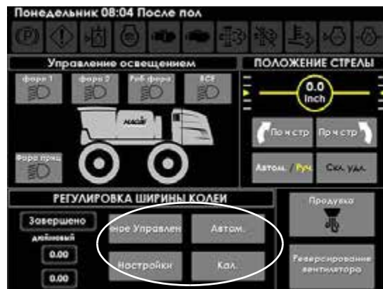
Кнопки регулировки колеи (расположены на странице вспомогательных элементов управления)
