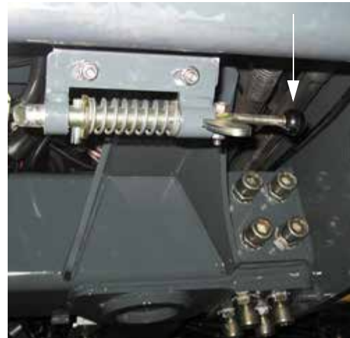
Передний расцепляющий рычаг заполнения (расположен под передней частью машины) – стандартный вид
