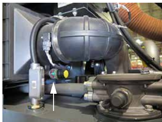
Filter Minder (расположен около предфильтра двигателя – для доступа откройте капот) - стандартный вид
