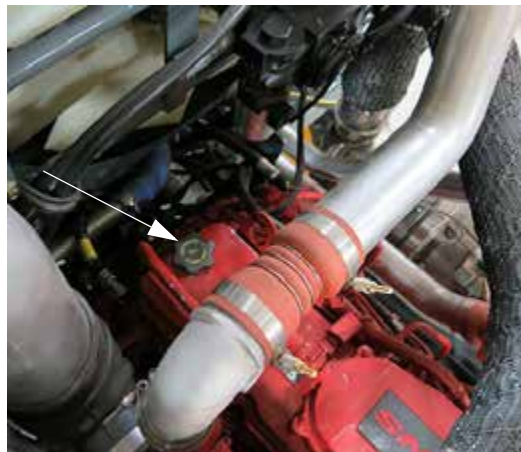
Заливка моторного масла (расположена сверху двигателя) - стандартный вид
