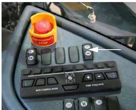
Переключатель промывки (расположен на боковой панели) - стандартный вид
