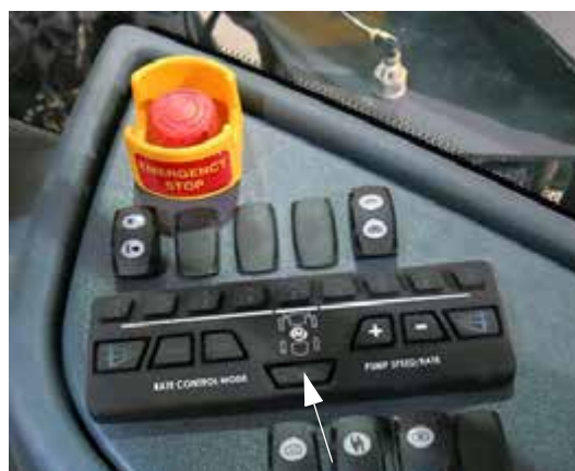
Переключатель задней форсунки (расположен на боковой панели) - стандартный вид
