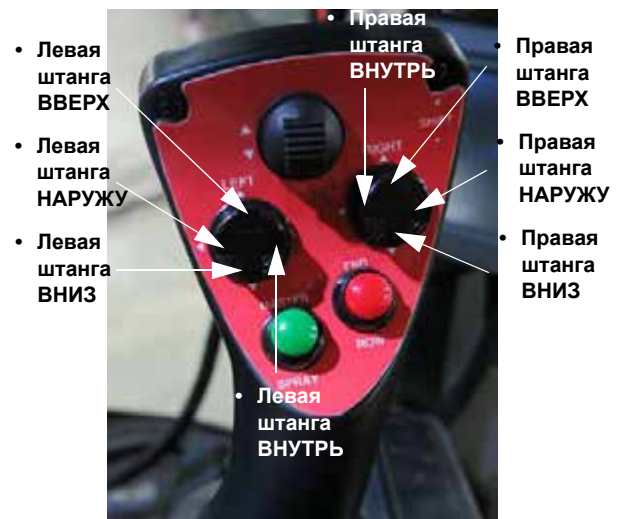
Переключатели выдвижения левой и правой штанг (расположены на Рукоятке управления гидростатической передачей) - стандартный вид
