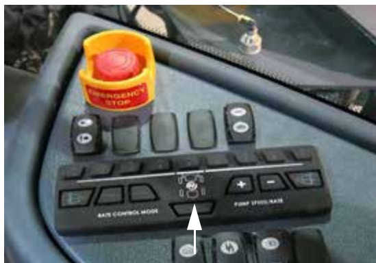
Переключатель задних распылителей (расположен на боковой панели) - стандартный вид
