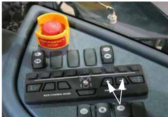
Переключатели скорости работы/ расхода насоса (расположены на боковой панели) - стандартный вид
