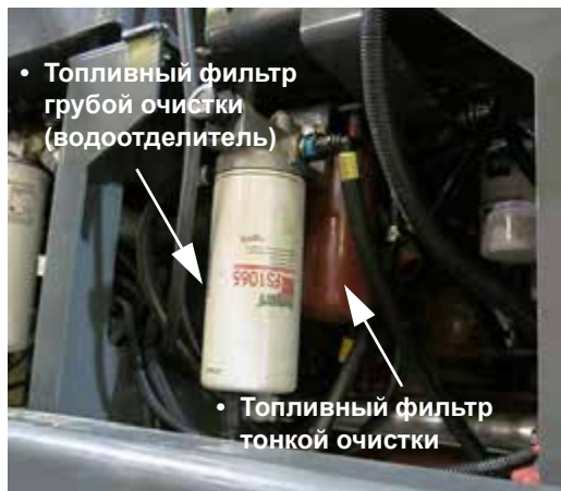
Фильтры предварительной и тонкой очистки топлива (расположены вдоль левой стороны машины – для доступа откройте капот) - стандартный вид
