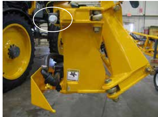
Sensores de proximidad -Vista típica
