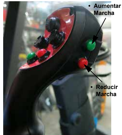
Interruptores para aumentar la marcha/reducir la marcha (ubicados en la manilla de control de la transmisión hidrostática) -Vista típica
