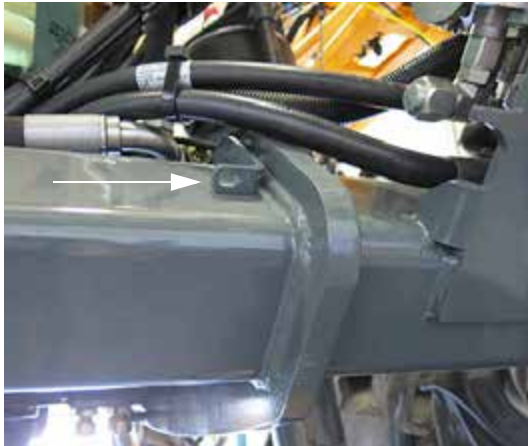
Soporte de montaje del protector de maleza (se muestra el lado izquierdo de la máquina) -Vista típica
