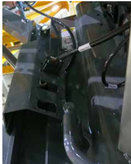
Conexión del NORAC -si está equipado (ubicada en el lado delantero derecho de la máquina) -Vista típica
