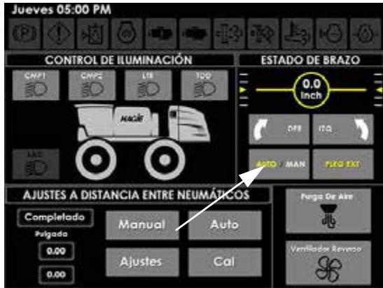
Botón de estado del brazo - Automático/Manual (ubicado en la página de controles auxiliares de la pantalla de la máquina)
