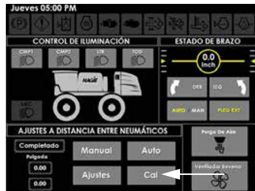
Botón de calibración (ubicado en la página de controles auxiliares de la pantalla de la máquina).
