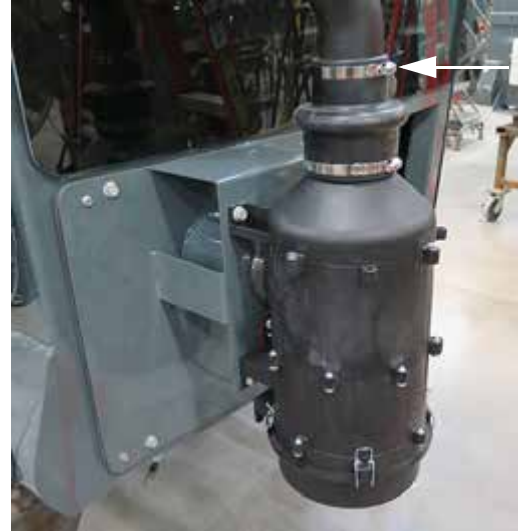
Abrazadera de brida - Superior (ubicada cerca de la parte superior de la unidad de filtración RESPA) -Vista típica
