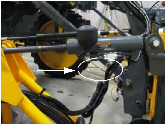
Válvula manual del NORAC (2) -si está equipado (ubicadas en los cilindros de nivelación del lado izquierdo y derecho) -Vista típica *Se muestra el cilindro de nivelación del lado derecho.
