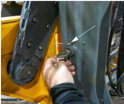
Pasador de bloqueo (ubicado en el lado exterior del marco del travesaño) -Vista típica
