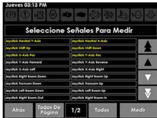
Pulse para seleccionar las señales para la pantalla de mediciones
