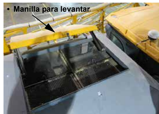
Tapa de la caja seca (se muestra en posición abierta) - Vista típica
