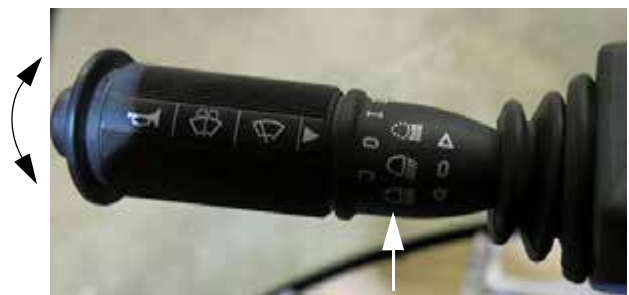
Luces altas (ubicadas en la palanca de las luces de giro) -Vista típica
