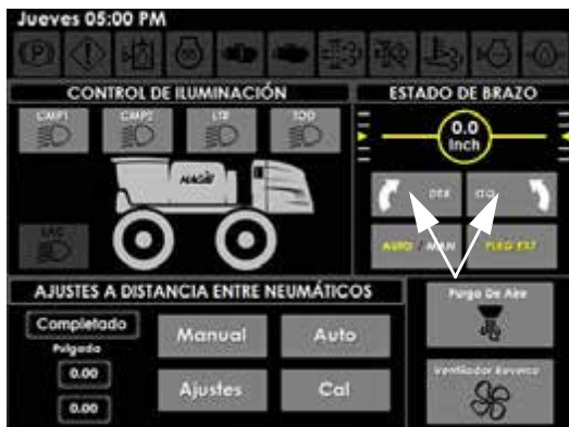
Botones de control de giro (CW/CCW) (ubicados en la página de controles auxiliares)
