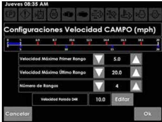
Pantalla de ajustar las configuraciones de velocidad de campo
