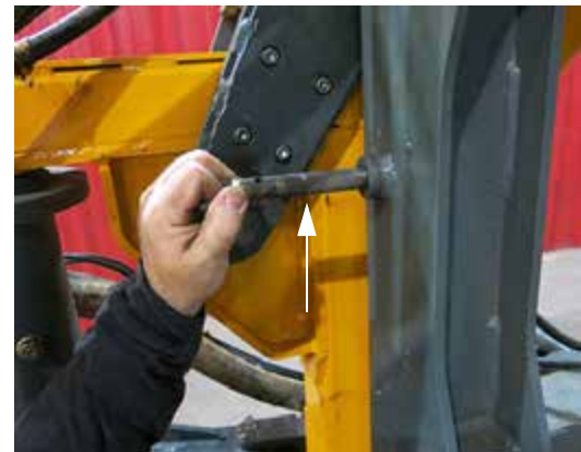
Perno de montaje (ubicado en el lado externo del marco del travesaño) -Vista típica
