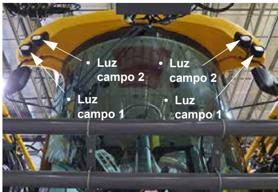
Luces de campo (4) (ubicadas en la parte delantera de la cabina) -Vista típica
