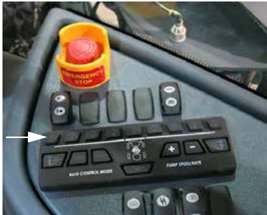
Interruptores de la válvula de solución del brazo (ubicados en la consola lateral) -Vista típica
