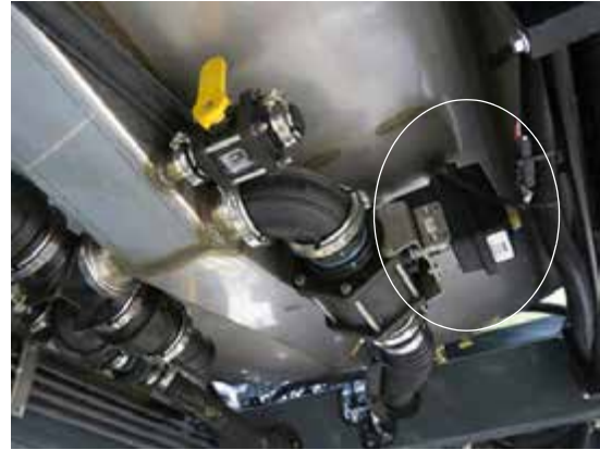
Válvula del tanque de solución (ubicada debajo del tanque de solución en la parte inferior de la máquina) -Vista típica
