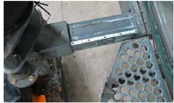
Calcomanía de distancia entre neumáticos (ubicada en cada pata) -Vista típica
