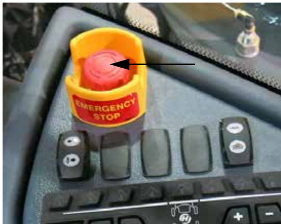
Interruptor E-Stop (ubicado en la consola lateral) -Vista típica
