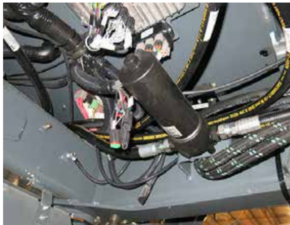
Filtro de presión (ubicada debajo del lado derecho e la máquina – baje el protector de metal para tener acceso) -Vista típica
