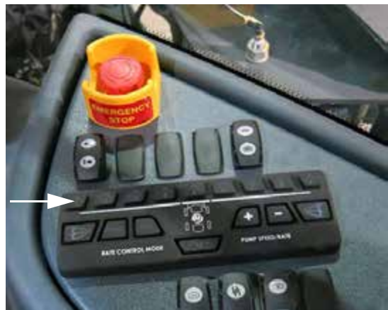
Interruptores de las válvulas de solución de los brazos (ubicados en la consola lateral) -Vista típica
