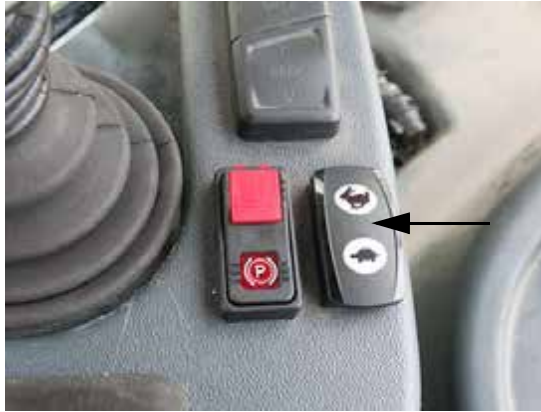
Interruptor del acelerador (ubicado cerca de la manilla de control de la transmisión hidrostática) -Vista típica
