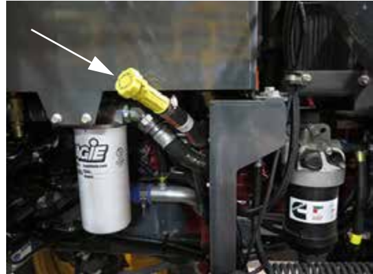
Llenado de aceite del motor remoto (situado en la parte trasera izquierda de la máquina - abra el capó para acceder) -Vista típica
