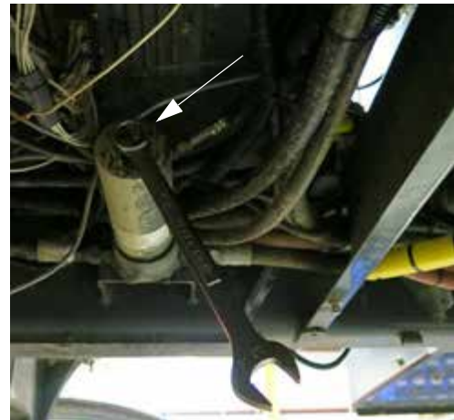
Carcasa del filtro de presión (ubicada debajo del lado derecho de la máquina – baje la protección metálica para tener acceso) -Vista típica
