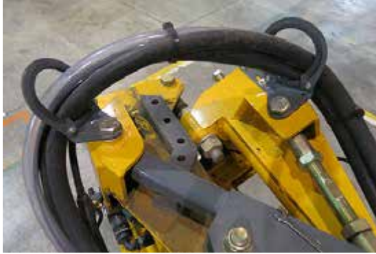
Instalación de las abrazaderas de manguera -Vista típica
