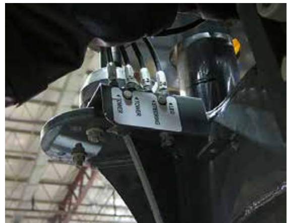
Banco de engrasadores tipo Zerk (4) (ubicados en el lado delantero de cada pata) -Vista típica
