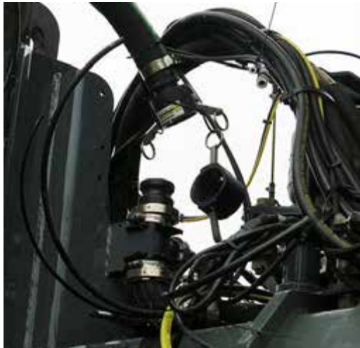
Conexión de la solución (situada en la parte delantera derecha de la máquina) -Vista típica
