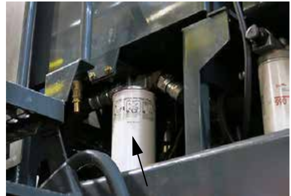
Filtro de drenaje de la carcasa (ubicado en el lado izquierdo de la máquina) -Vista típica
