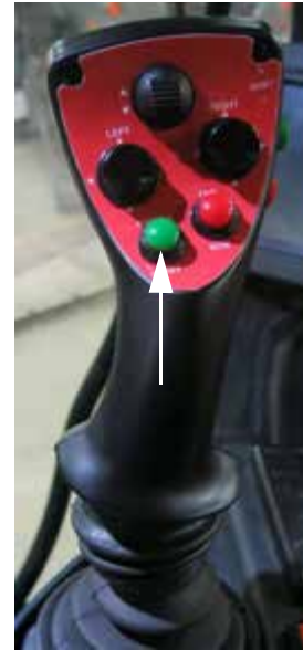
Interruptor del aspersor principal (ubicado en la manilla de control de la transmisión hidrostática) - Vista típica
