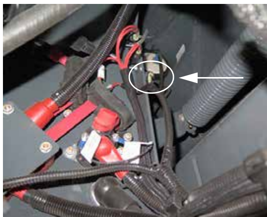
Fusible del actuador del capó (ubicado en el lado posterior izquierdo de la máquina) -Vista típica
