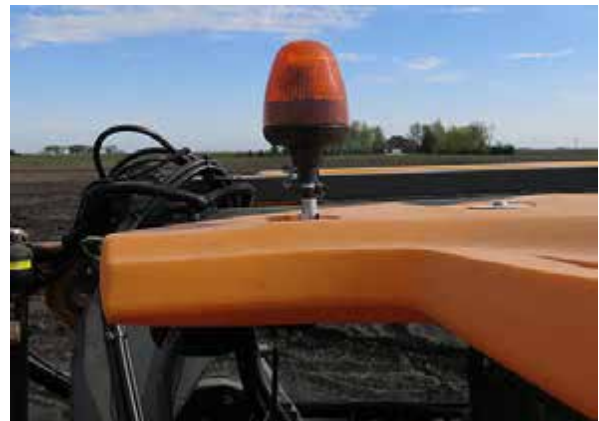
Faro giratorio (2) (ubicados a ambos lados de la parte delantera del techo de la cabina) -Vista típica
