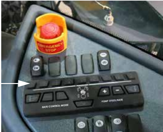
Interruptores de las válvulas de solución del brazo (ubicados en la consola lateral) - Vista típica
