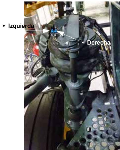
Válvulas de suspensión de aire (ubicadas en las bolsas de aire izquierda y derecha delanteras y traseras) -Vista típica
