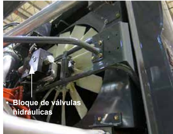
Ventilador reversible (ubicado cerca de la parte trasera de la máquina; abra el capó para tener acceso) -Vista típica
