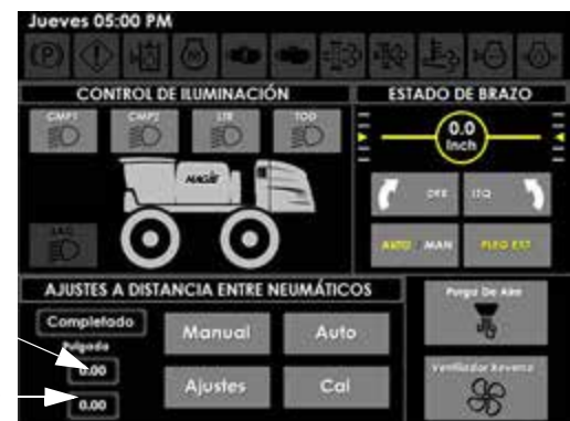
Indicadores de distancia entre neumáticos delanteros/traseros (ubicados en la página de controles auxiliares de la pantalla de la máquina)
