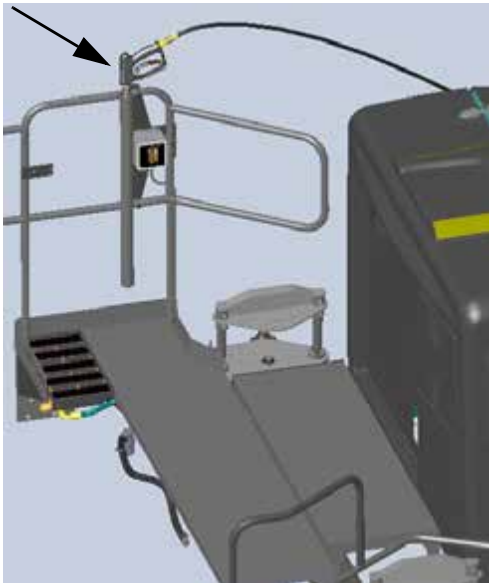
Vara de la lavadora a presión (montada en el pasamanos posterior derecho) -Vista típica
