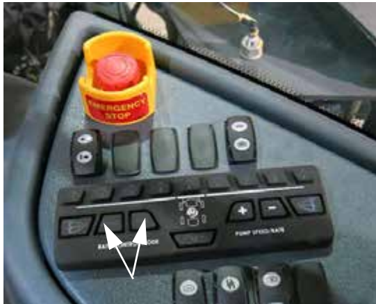
Interruptores de control de tasa (ubicados en la consola lateral) -Vista típica
