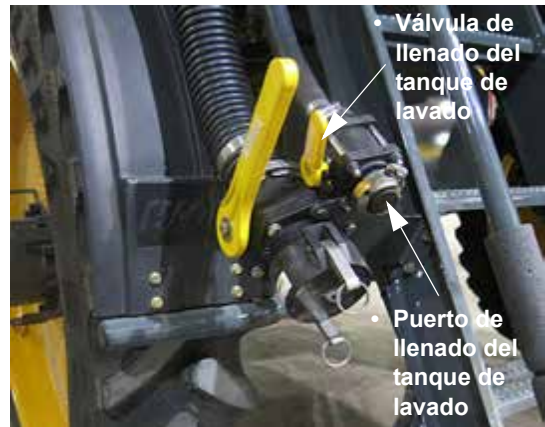
Conjunto de llenado trasero (ubicado detrás de la rueda trasera izquierda) -Vista típica
