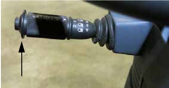
Botón del lavaparabrisas (ubicado al final de la palanca de la direccional) -Vista típica
