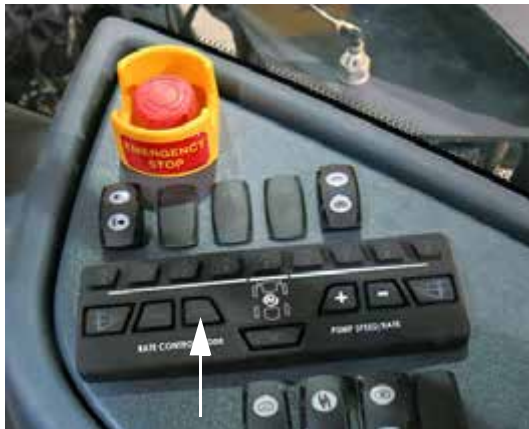
El interruptor de control de tasa “MAN” (ubicado en la consola lateral) -Vista típica
