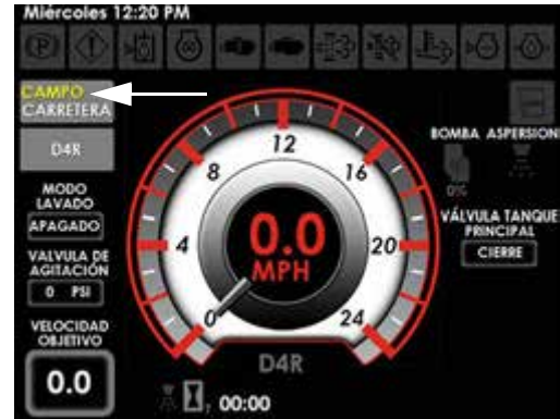
Botón de campo/carretera (ubicado en la página principal de la pantalla de la máquina)
