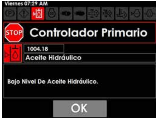
Mensaje de advertencia de nivel bajo de aceite hidráulico (ubicado en la pantalla de la máquina)
