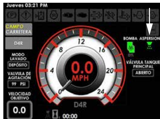
Indicador del aspersor principal (ubicado en la página principal de la pantalla de la máquina en modo de campo)
