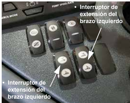
Interruptores de extensión del brazo izquierdo y derecho (ubicados en la consola lateral) -Vista típica
