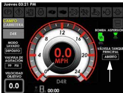
Indicador del estado de la válvula del tanque principal (ubicado en la página principal de la pantalla de la máquina) - Modo de campo
