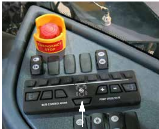
Interruptor de boquilla trasera (ubicado en la consola lateral) -Vista típica
