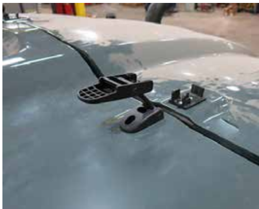
Cierre con traba del capó (2) (situados a cada lado del capó superior) -Vista típica
