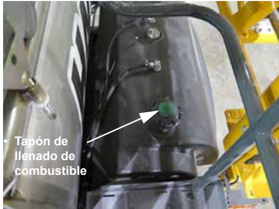
Llenado de combustible del motor (ubicado en la parte superior del tanque de combustible en el lado derecho de la máquina) -Vista típica
