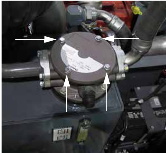
Carcasa del filtro de retorno (ubicado en la parte superior del depósito de aceite hidráulico) -Vista típica
