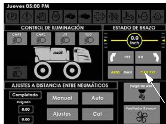
Botón de plegar extensión (Ext) (ubicado la página de controles auxiliares de la pantalla de la máquina)
