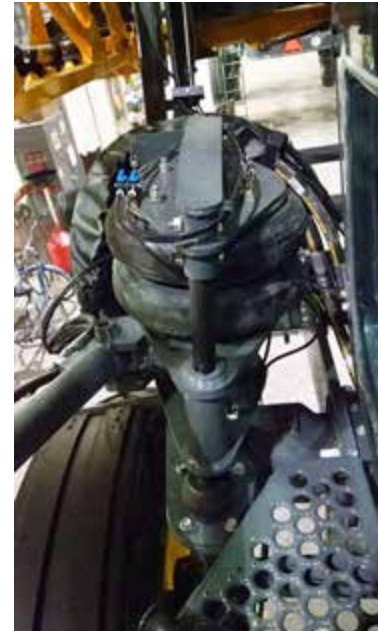
Bolsa de aire (ubicada en cada pata) -Vista típica
