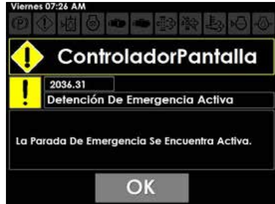
Mensaje de interruptor de parada de emergencia activado (ubicado en la pantalla de la máquina)
