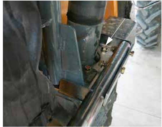
Perno de placa de montaje -Vista típica
