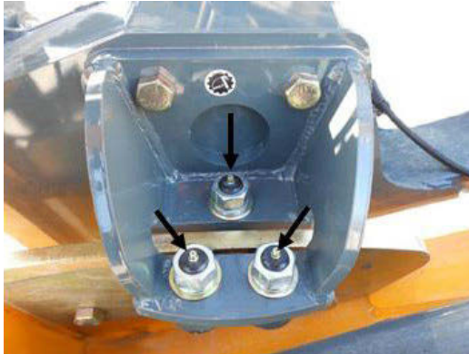
Conjunto de montaje del rodillo -Vista típica
