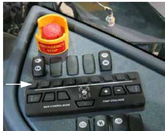
Interruptores de las válvulas de solución del brazo (ubicados en la consola lateral) -Vista típica
