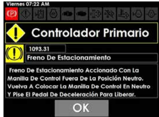
Mensaje de advertencia del freno de estacionamiento
