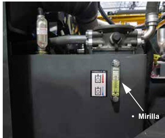
Depósito de aceite hidráulico (ubicado en el lado izquierdo de la máquina; abra el capó para tener acceso) -Vista típica
