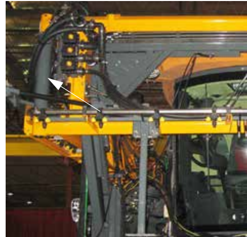
Tubo de articulación del travesaño -Vista típica
