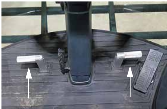
Estribos para el pie del operador (ubicados a cada lado de la columna de dirección) -Vista típica
