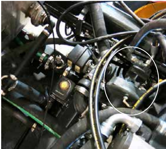
Bomba de solución (ubicada cerca del centro de la máquina) -Vista típica * Vista desde la parte superior de la máquina
