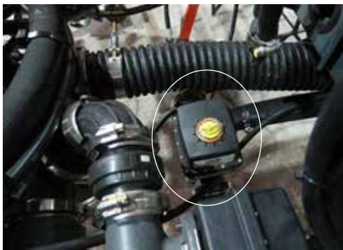
Válvula de agitación (ubicada cerca del centro de la máquina) -Vista típica
