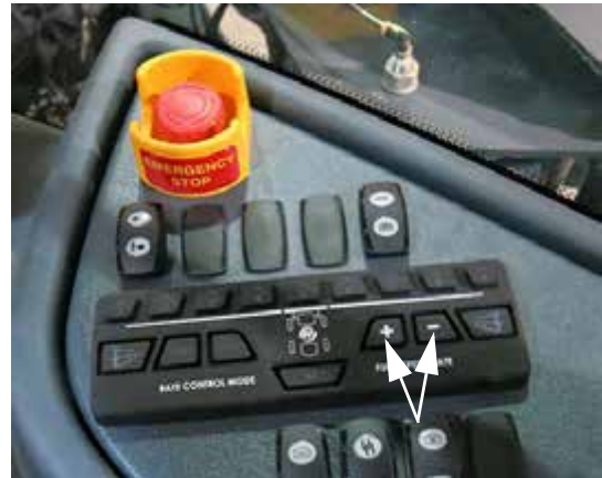
Interruptores de tasa/velocidad de la bomba (ubicados en la consola lateral) -Vista típica
