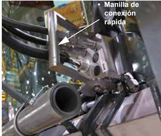
Conjunto del acoplador múltiple hidráulico/eléctrico (ubicado en la parte delantera izquierda de la máquina)
