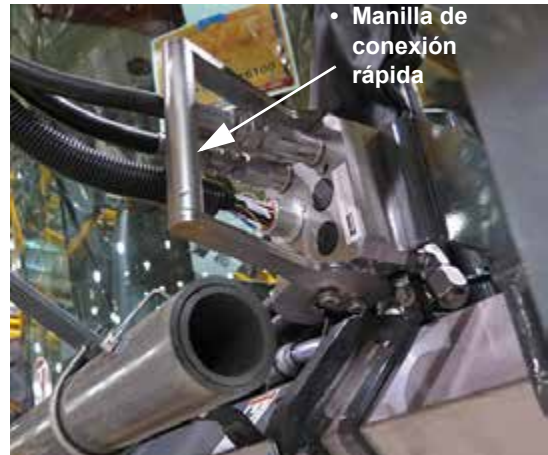
Conjunto del acoplador múltiple hidráulico/ eléctrico (ubicado en el lado delantero izquierdo de la máquina)
