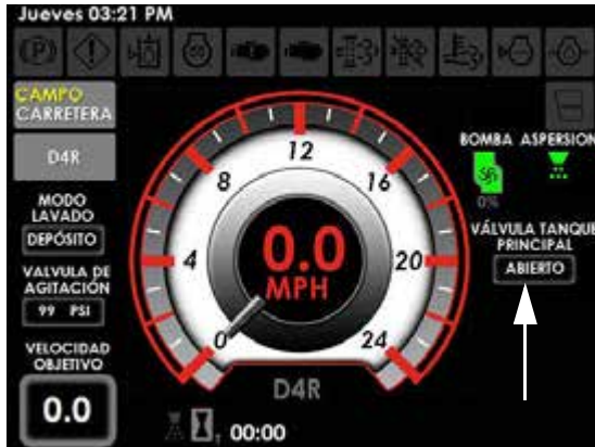
Indicador de estado de la bomba de solución (ubicado en el lado derecho de la página de inicio de la pantalla de la máquina - modo de campo)
