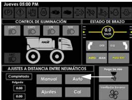
Botón automático (ubicado en la página de controles auxiliares de la pantalla de la máquina)
