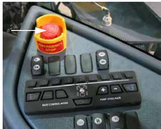
Interruptor de parada de emergencia (ubicado en la consola lateral)
