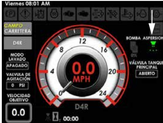
Indicador principal del aspersor (ubicado en la página principal de la pantalla de la máquina - Modo de campo) - Vista típica
