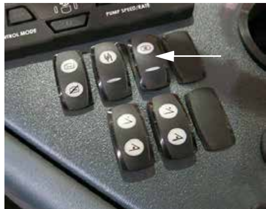
Interruptor de válvula de agitación (ubicado en la consola lateral) -Vista típica
