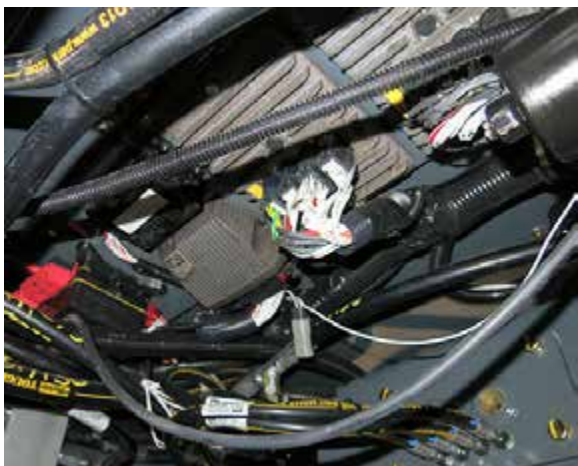
Interrupidores automáticos/fusibles (exteriores) (ubicados debajo de la cabina; quite el panel para tener acceso) -Vista típica
