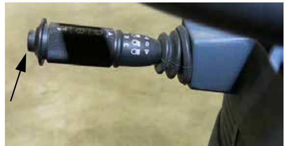
Botón de la bocina (ubicado en la punta de la palanca de la direccional) -Vista típica
