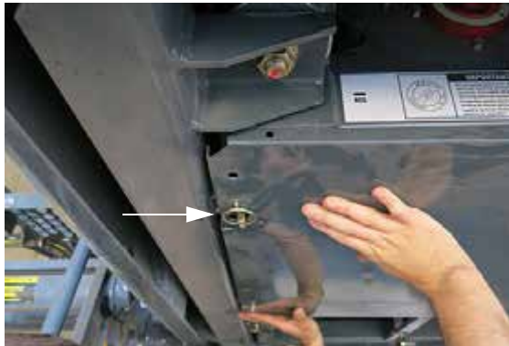
Pasador de fijación (instalado en el pasador de soporte colgante) -Vista típica
