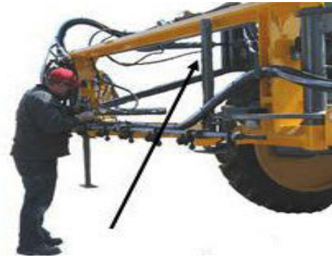
Soporte del brazo en posición de “Viaje” -Vista típica
