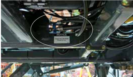
Puertos de carga del sistema de aire acondicionado (ubicados debajo del centro del bastidor principal) -Vista típica
