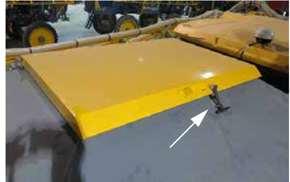
Pestillo de seguridad (Ubicado en el lado de la tapa de la caja seca) - Vista típica
