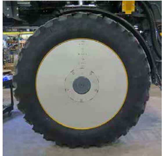
Instalación de la cubierta de la rueda -Vista típica
