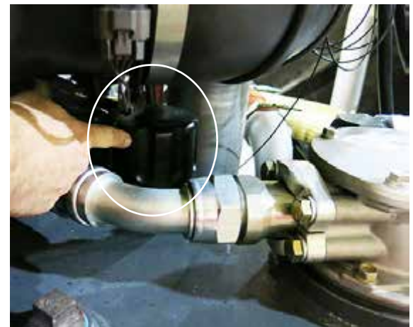
Tapón con respiradero (ubicado en el lado izquierdo de la máquina cerca del alojamiento del filtro de retorno) -Vista típica
