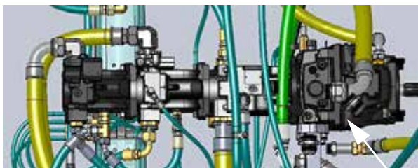
Bomba hidrostática (bomba de accionamiento) -Vista típica (vista desde la parte superior de la máquina)
