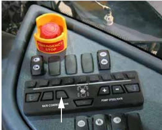
Interruptor manual (“MAN”) de control de tasa (ubicado en la consola lateral) -Vista típica
