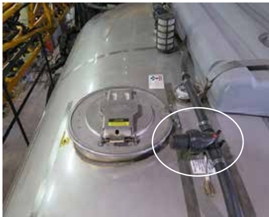
Tamiz de enjuague del tanque (ubicado en la parte superior del tanque de solución) -Vista típica
