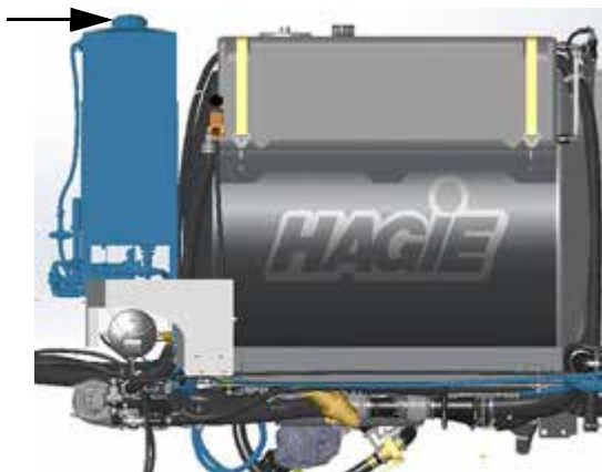
Tapa del orificio de llenado (ubicado en la parte superior del tanque de productos químicos) - Vista típica
