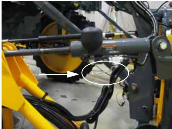
Válvula manual del NORAC (2) - si está equipada (ubicadas en los cilindros de nivelación del lado izquierdo y derecho) -Vista típica
