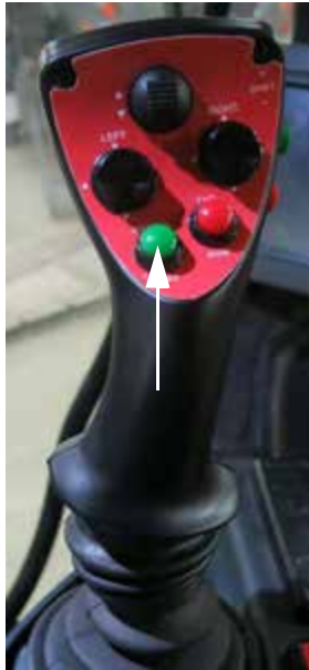
Interruptor de aspersión principal (ubicado en la manilla de control de la transmisión hidrostática) -Vista típica
