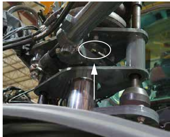
Engrasador tipo Zerk del collarín (4) (situado debajo de la placa de montaje de cada bolsa de aire) -Vista típica
