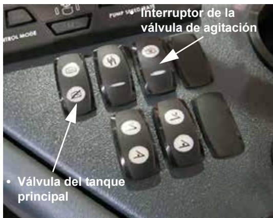
Interruptores del tanque principal y las válvulas de agitación (ubicados en la consola lateral) -Vista típica
