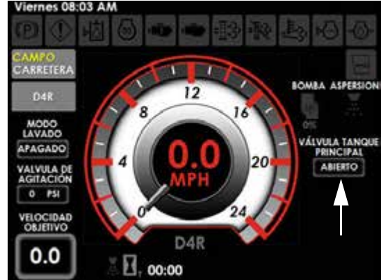
Indicador del estado de la válvula del tanque principal (ubicado en la página principal de la pantalla de la máquina Modo de campo) - Vista típica
