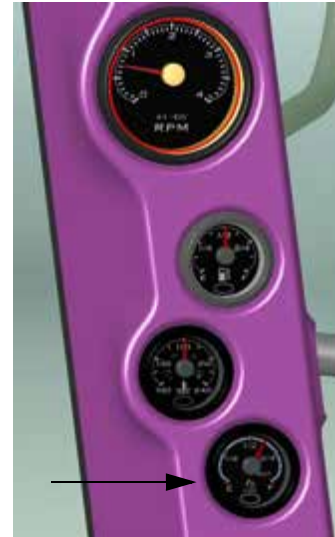
Indicador de nivel de DEF (ubicado en el poste A de la cabina) -Vista típica
