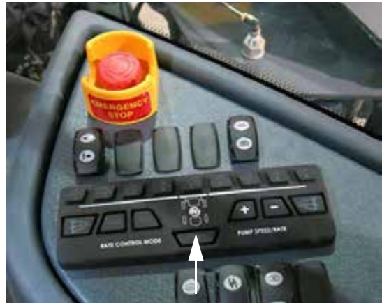
Interruptor de las boquillas traseras (ubicado en la consola lateral) -Vista típica
