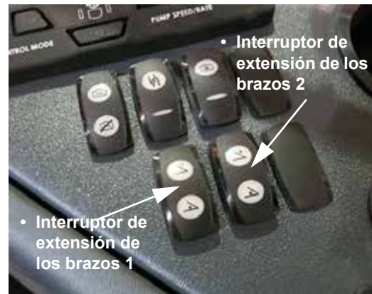
Interruptores de extensión de los brazos – Izquierdo/derecho (ubicados en la consola lateral) -Vista típica
