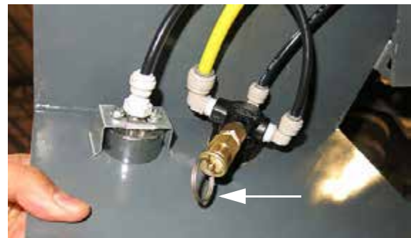
Anillo de tiro para el alivio de presión (ubicado en la parte trasera del regulador de presión de la espuma) -Vista típica
