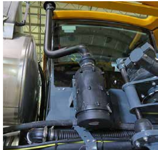
Sistema de filtrado de la cabina (ubicado en el lado derecho del exterior de la cabina) -Vista típica
