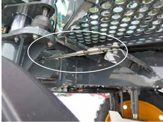
Sensor de ajuste de la distancia entre neumáticos (4) (ubicado en cada pata) -Vista típica
