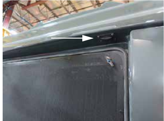
Interruptor del capó (situado delante del capó trasero por encima de la rejilla del radiador) -Vista típica
