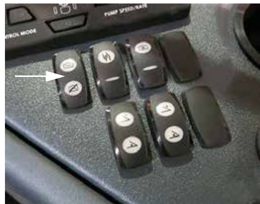
Interruptor de la válvula del tanque principal (ubicado en la consola lateral) -Vista típica
