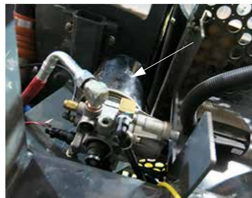
Secadora de aire (ubicada debajo del lado derecho de la máquina) -Vista típica
