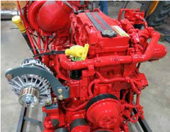
Motor diésel nivel 4 final (ubicado cerca de la parte trasera de la máquina – abra el capó para obtener acceso) - Vista típica
