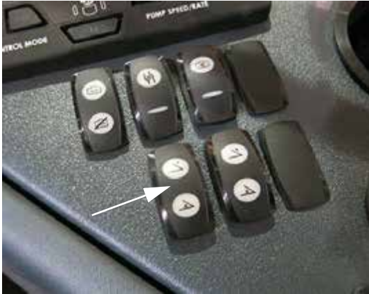
Interruptor de extensión del brazo * Brazos de aspersión de 90 pies (ubicado en la consola lateral) -Vista típica
