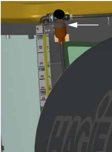
Depósito de líquido del lavaparabrisas (situado detrás del lado izquierdo de la cabina) -Vista típica
