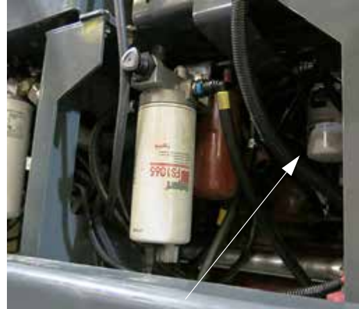
Filtro de aceite del motor (ubicado en el lado izquierdo de la máquina – abra el capó para tener acceso) -Vista típica
