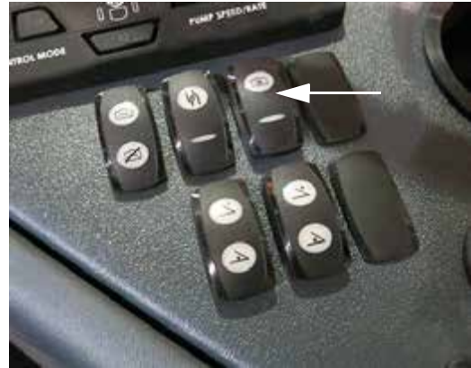
Interruptor de la válvula de agitación (ubicado en la consola lateral) -Vista típica
