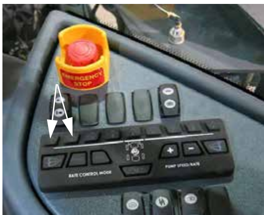
Interruptores de las válvulas de solución del brazo 1 y 2 (ubicados en la consola lateral) - Vista típica
