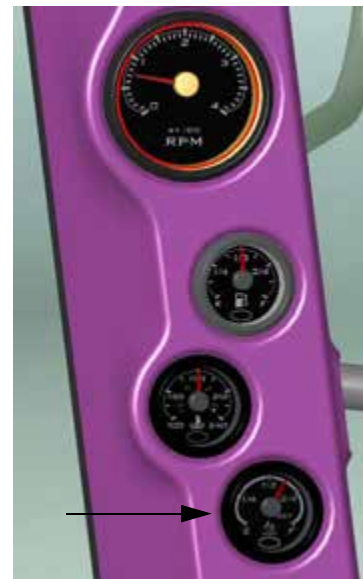
Medidor DEF (ubicado en el poste A de la cabina) - Vista típica
