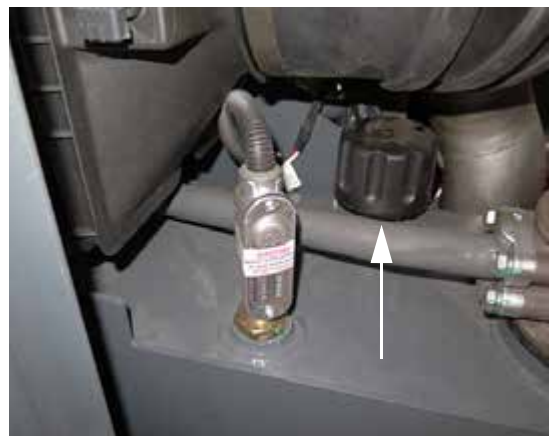
Tapón del tanque con respiradero (ubicado en la parte superior del depósito de aceite hidráulico) -Vista típica
