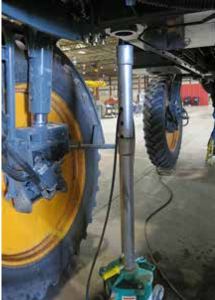
Alinee el gato con el anillo de contención del punto de elevación -Vista típica
