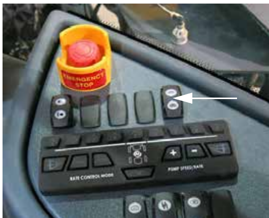
Interruptor de lavado (ubicado en la consola lateral) -Vista típica
