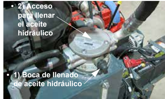
Opciones de llenado de aceite hidráulico -Vista típica
