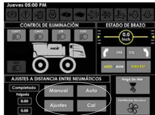
Botones de ajuste de la distancia entre neumáticos (ubicados en la página de controles auxiliares)
