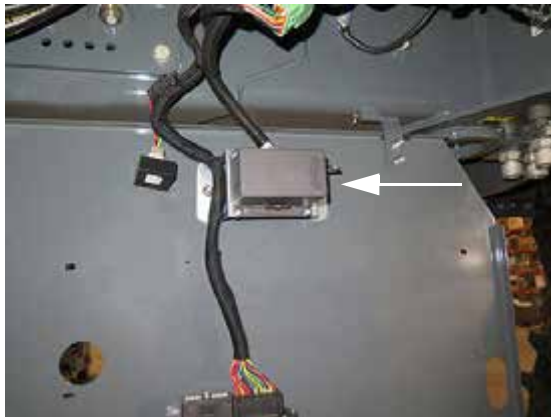
Caja de relés de la bomba de solución (ubicada debajo del extremo delantero de la cabina, bajo el panel para tener acceso) -Vista típica
