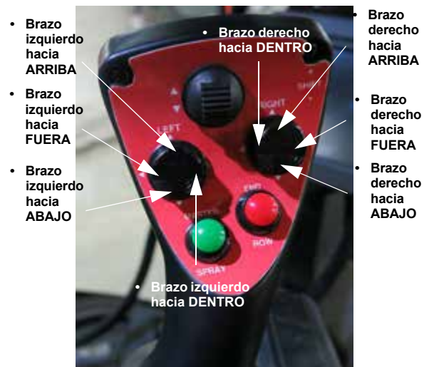
Interruptores del brazo izquierdo y derecho (ubicados en la manilla de control de la transmisión hidrostática) -Vista típica
