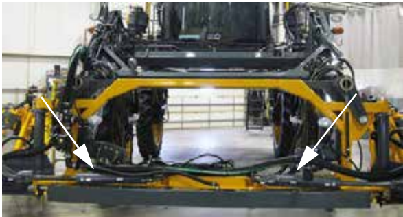
Cilindros principales de giro/desenganche -Vista típica
