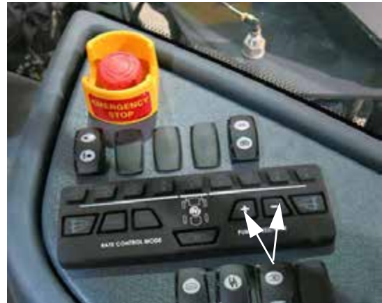
Interruptores de velocidad/ tasa de la bomba (ubicados en la consola lateral) -Vista típica
