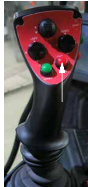
Interruptor de manejo de la última hilera (ubicado en la manilla de control de la transmisión hidrostática) -Vista típica
