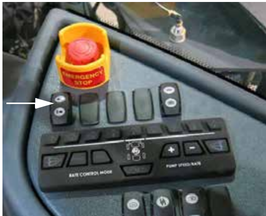
Interruptor del marcador con espuma (ubicado en la consola lateral) -Vista típica
