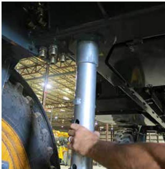
Inserte el gato en el anillo de contención del punto de elevación -Vista típica
