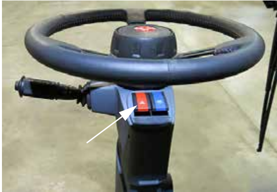
Interruptor de luces de peligro/emergencia (ubicado en la columna de dirección) -Vista típica
