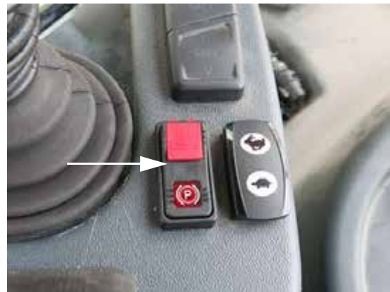
Interruptor del freno de estacionamiento (ubicado cerca de la manilla de control de la transmisión hidrostática)
