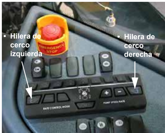
Interruptores de hilera de cerco – Izquierda/derecha (ubicados en la consola lateral) -Vista típica
