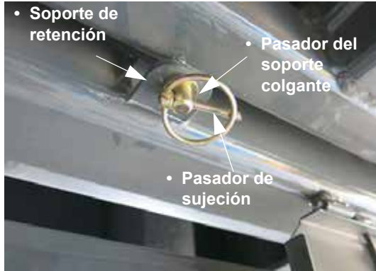
Conjunto de soporte de retención / conjunto del pasador de fijación -Vista típica
