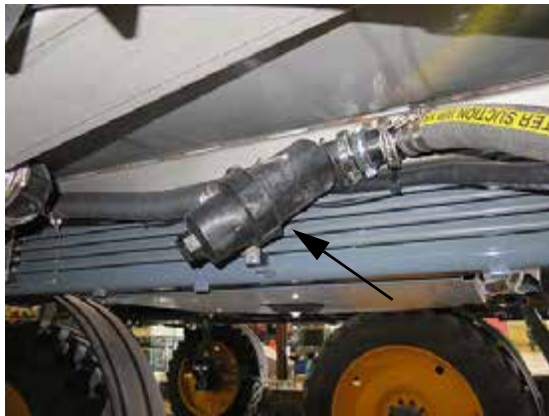
Tamiz de la tubería de solución (ubicado debajo del lado central derecho de la máquina) -Vista típica
