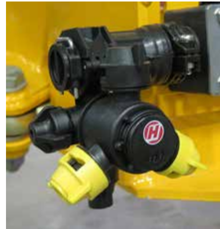
Cuerpo de boquilla (ubicados a lo largo del brazo) -Vista típica
