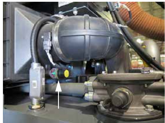
Filter Minder (ubicado cerca del prefiltro del motor, abra el capó para acceder) -Vista típica
