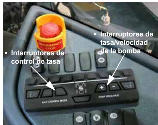
Interruptores de control de tasa/ velocidad de la bomba (ubicados en la consola lateral) - Vista típica
