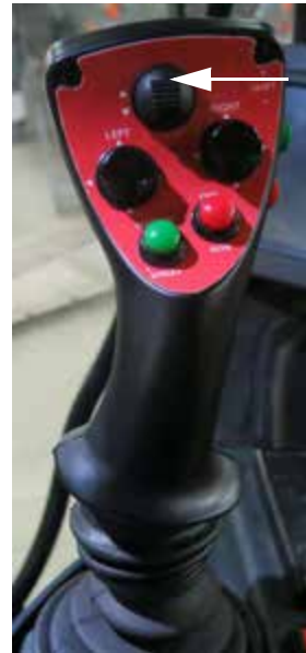
Interruptor del travesaño – ARRIBA (ubicado en la manilla de control de la transmisión hidrostática) -Vista típica
