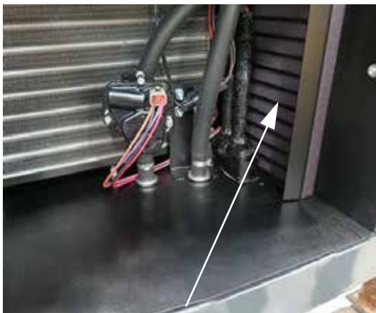
Filtro de recirculación (ubicado por el lado derecho del compartimento) -Vista típica
