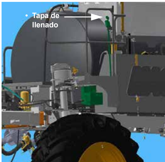
Llenado del tanque del marcador de espuma (ubicado en el pasamanos derecho trasero) - Vista típica
