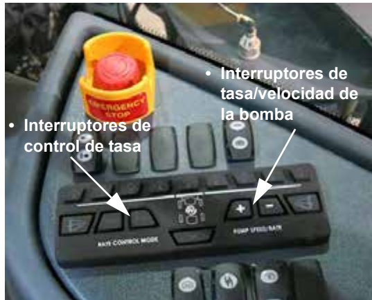
Interruptores de control de tasa/ velocidad de la bomba (ubicados en la consola lateral) -Vista típica
