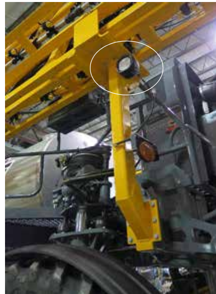
Luces de trabajo (2) (ubicadas en el receptáculo de cada brazo) -Vista típica
