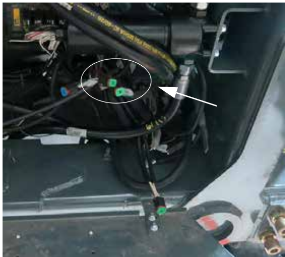
Conexiones de entrada para cámaras de vídeo (ubicadas debajo de la cabina; quite el panel frontal para tener acceso) -Vista típica
