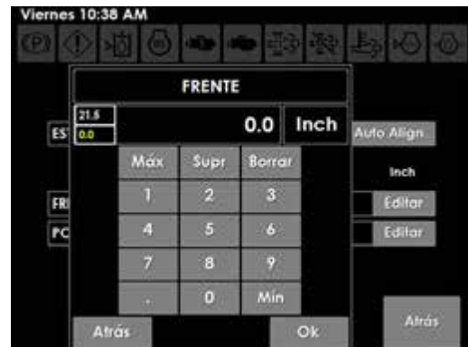
Pantalla para ingresar datos (se muestra la distancia entre neumáticos delanteros)
