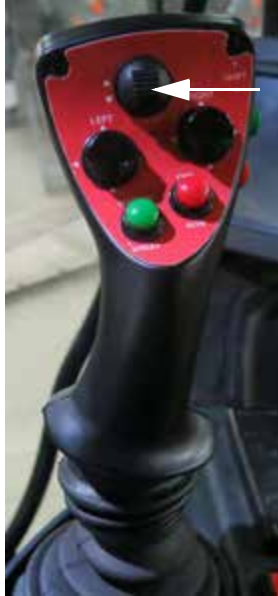
Interruptor del travesaño – ABAJO (ubicado en la manilla de control de la trasmisión hidrostática) -Vista típica
