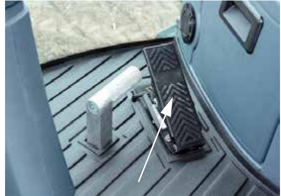
Pedal desaceleración (ubicado en la parte baja derecha de la columna de dirección) -Vista típica
