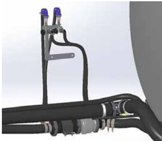
Indicadores de flujo (ubicados en el exterior del lado derecho de la cabina) - Vista típica
