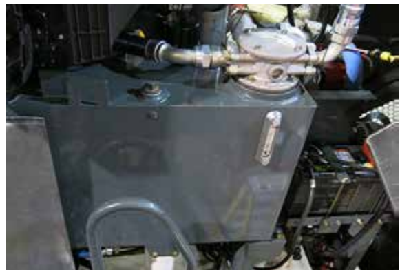
Depósito de aceite hidráulico (ubicado en el lado izquierdo de la máquina, abra el capó para tener acceso) -Vista típica
