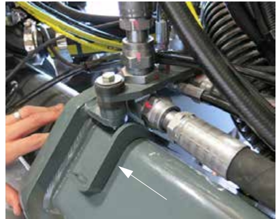
Soporte de montaje de la protección de maleza (se muestra el lado derecho de la máquina) -Vista típica
