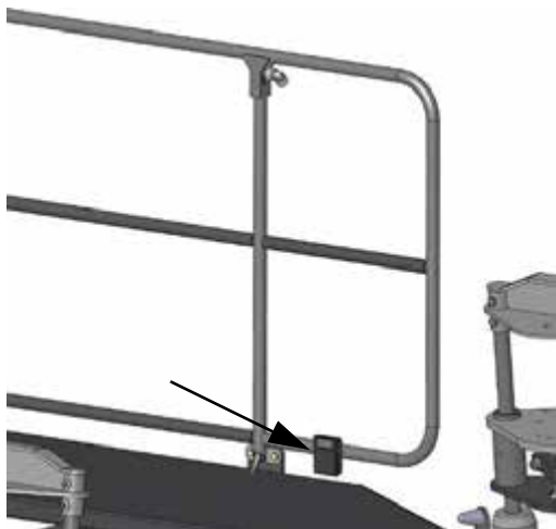
Pedal del lavado de manos (ubicado por el pasamanos inferior del lado izquierdo) -Vista típica
