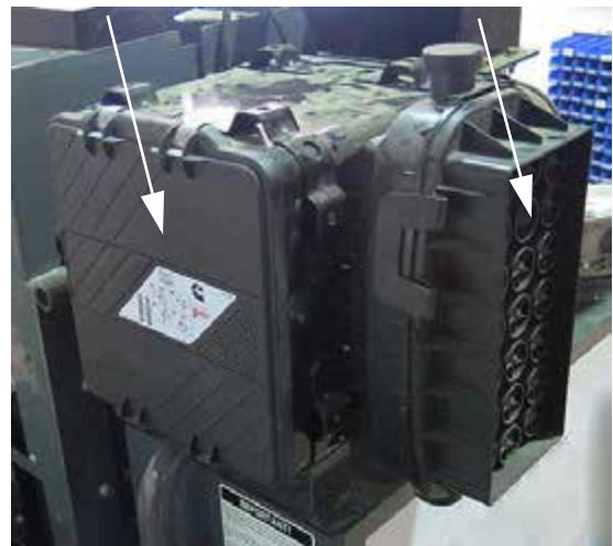
Filtro y prefiltro de admisión de aire del motor (ubicados en el lado izquierdo de la máquina) -Vista típica
