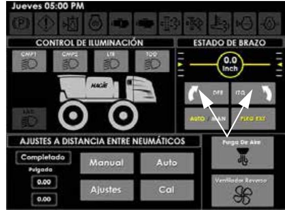
Botones de control de giro (CW/CCW) (ubicados en la página de controles auxiliares de la pantalla de la máquina)
