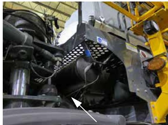
Válvula de drenaje del tanque (purga de aire) - si está equipado (ubicada debajo de la plataforma cerca del lado derecho central de la máquina) * Jale hacia ABAJO para abrir -Vista típica
