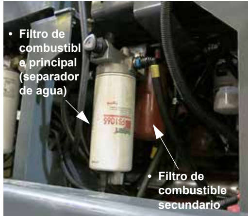
Filtros de combustible principal y secundario (ubicado en el lado izquierdo de la máquina – abra el capó para tener acceso) -Vista típica
