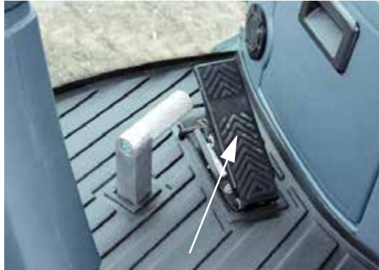
Pedal de desaceleración (ubicado en el lado inferior derecho de la columna de la dirección) -Vista típica
