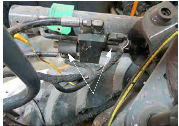
Válvulas de bloqueo -Vista típica
