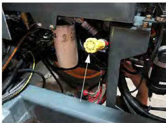
Közvetett motorolaj töltés (a gép hátsó, bal kéz felőli részén helyezkedik el – a hozzáféréshez nyissa fel a motorháztetőt) – Tipikus nézet
