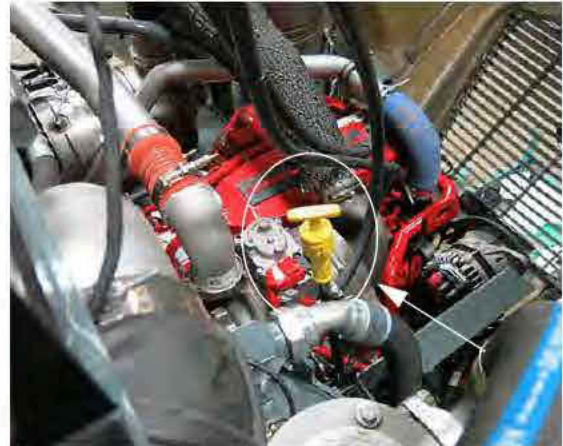
Motorolaj nívópálca (a motor bal kéz felőli oldalán van elhelyezve – a hozzáféréshez nyissa fel a motorháztetőt) – Tipikus nézet
