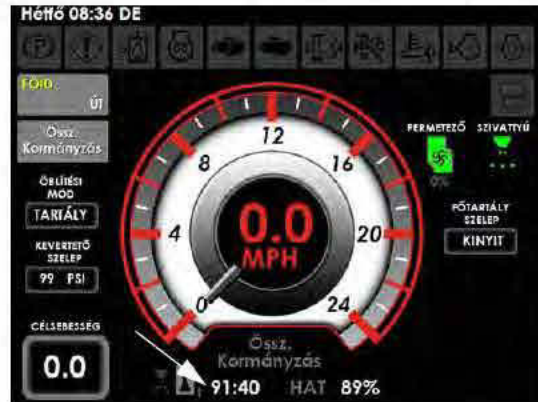
Permetezési idő jelző (A Főoldal – Mezei üzemmód oldal alján)
