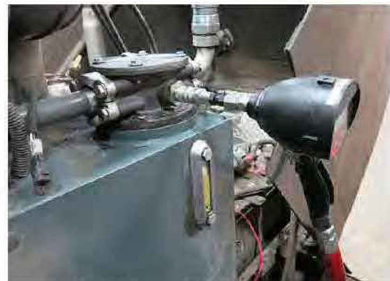
Tartály töltése a hidraulikus olaj töltő nyíláson keresztül – Tipikus nézet
