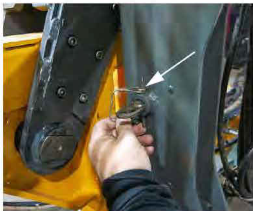
Záró csapszeg (a támasztómű keret külső oldalánál helyezkedik el) – Tipikus nézet
