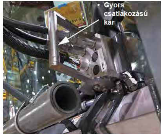
Hidraulikus/elektromos multi-csatlakozó összeszerelés (a gép elülső, bal oldalánál helyezkedik el)
