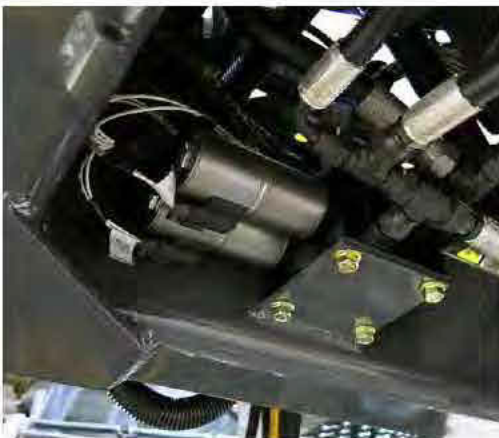
Elosztószelep (a gép alján) – Tipikus nézet
