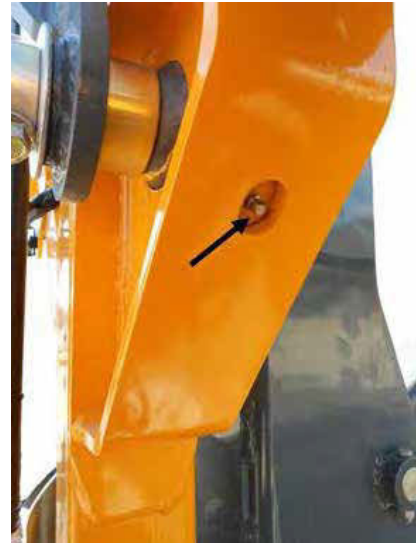
Forgótengelyes támasztómű gömbcsukló – Tipikus nézet
