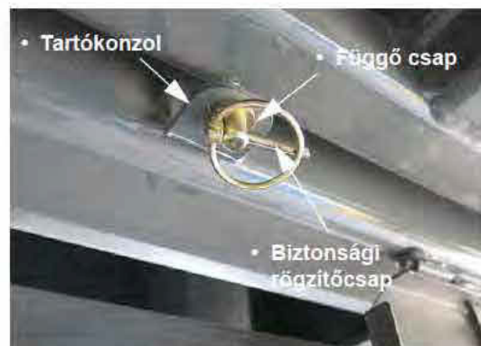
Támtartó/biztonsági rögzítőcsap összeszerelés – Tipikus nézet
