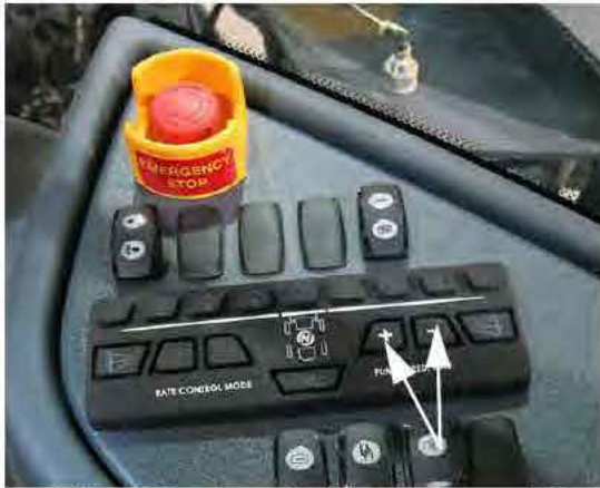
Szivattyú sebesség/Arány kapcsolók (oldalsó vezérlőpulton) – Tipikus nézet
