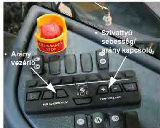
Arány szabályozó, és szivattyú sebesség/arány kapcsolók (a vezérlőpult oldalán helyezkedik el) – Tipikus nézet
