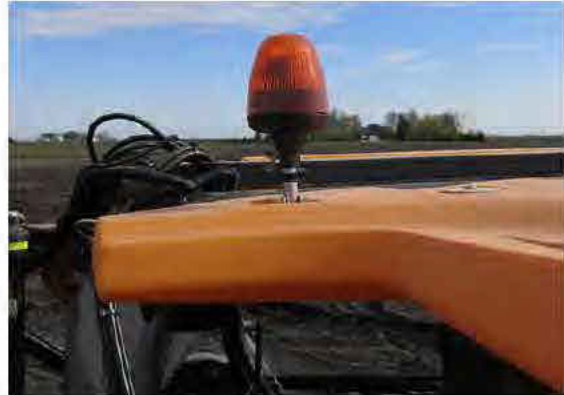
Körforgó jelzőfény (2) (A vezetőfülke tetején, elől mindkét oldalon) – Tipikus nézet
