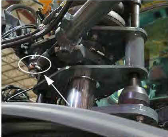
Kormány összekötő rúd (2) gömbcsukló Zerk zsír (az első lábknál található) – Tipikus nézet
