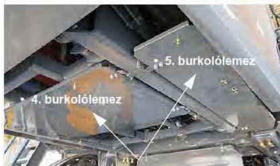
Hátsó alvázvédelmi szerelvény telepítése – Tipikus nézet
