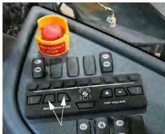
Mérték szabályzó kapcsolók (oldalsó vezérlőpulton) – Tipikus nézet
