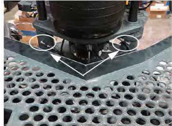
Támasz csapágó Zerk zsír (8) (az első és hátsó lábakon található) – Tipikus nézet
