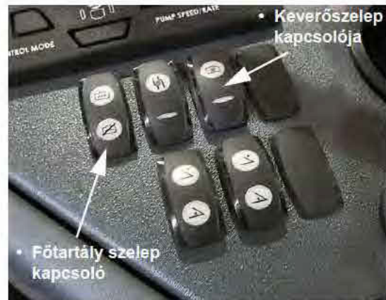
Főtartály és keverőszelep kapcsolók (oldalkonzolon) – Tipikus nézet
