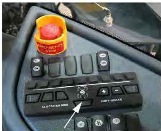
Hátsó fúvóka kapcsolója (oldalsó vezérlőpulton) – Tipikus nézet
