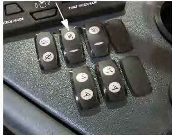
Permetlé oldat szivattyú kapcsolója (oldalsó vezérlőpulton) – Tipikus nézet
