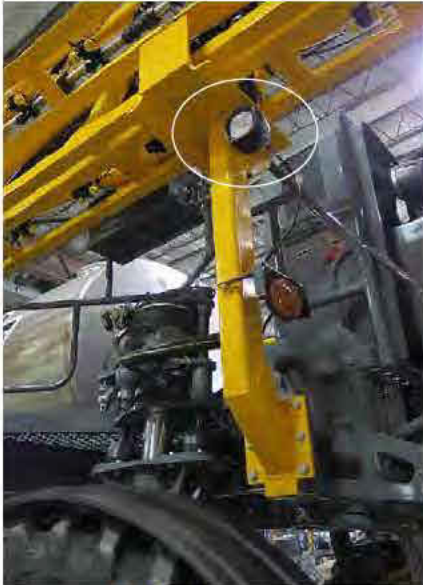
Munkalámpák (2) (a fülke mindkét oldalán) – Tipikus nézet
