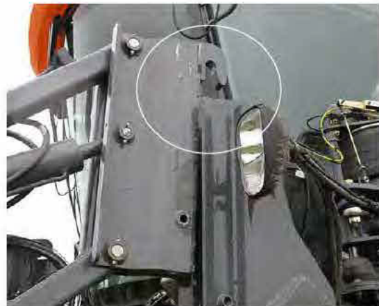
Csatolmány szerelőcsap – Tipikus nézet
