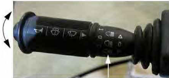
Reflektor (az irányjelző kapcsolón) – Tipikus nézet
