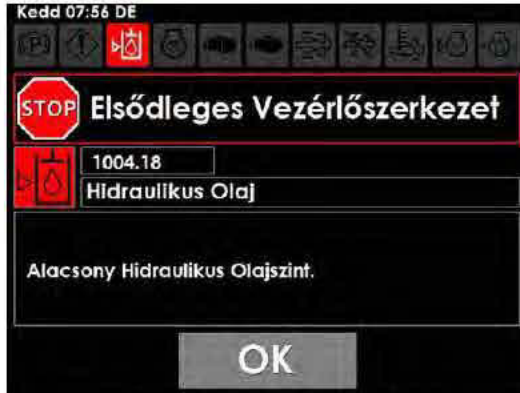
Alacsony hidraulika olaj szint figyelmeztető üzenet (Munkagép képernyőjén található)
