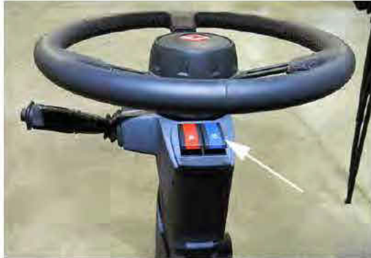
Közúti fényszórók kapcsoló (a kormányoszlopon) – Tipikus nézet
