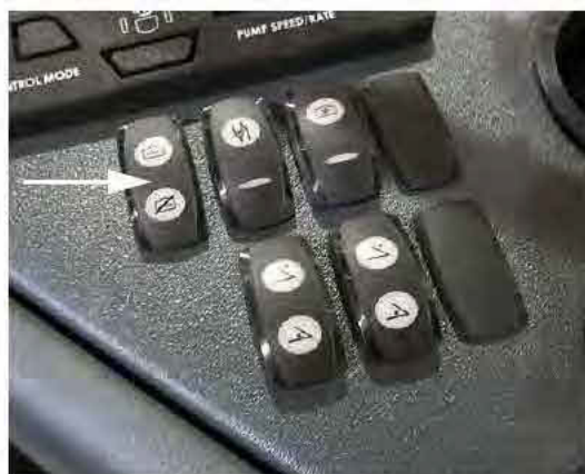
Főtartály szelep kapcsolója (az oldalkonzolon található) - Tipikus nézet
