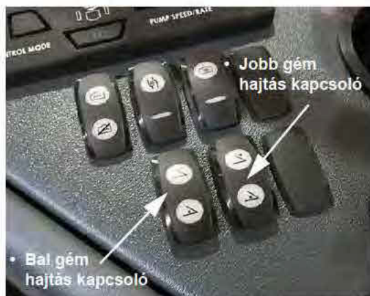
Bal és jobb gémmel toldalék kapcsolók (oldalsó vezérlőpulton) – Tipikus nézet
