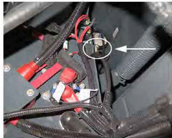
Motorháztető működtető szerkezet biztosíték (a gép hátsó, bal oldala alatt helyezkedik el) – Tipikus nézet
