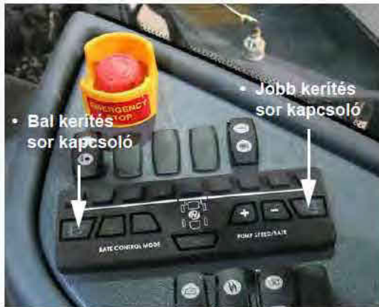
Kerítéssor kapcsolók – Bal és jobb (oldalsó vezérlőpulton) – Tipikus nézet
