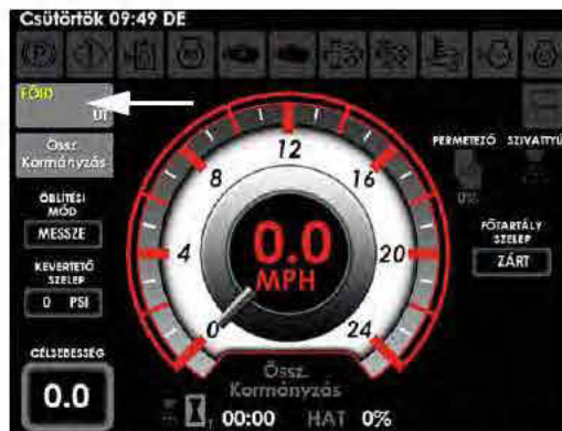
Mezei/közúti üzemmód kapcsoló (a gép képernyőjének kezdőoldalon) - Tipikus nézet
