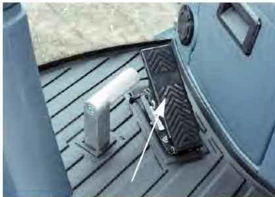
Lassító pedál (a kormányoszlop jobb kéz felőli oldalán alul) – Tipikus nézet
