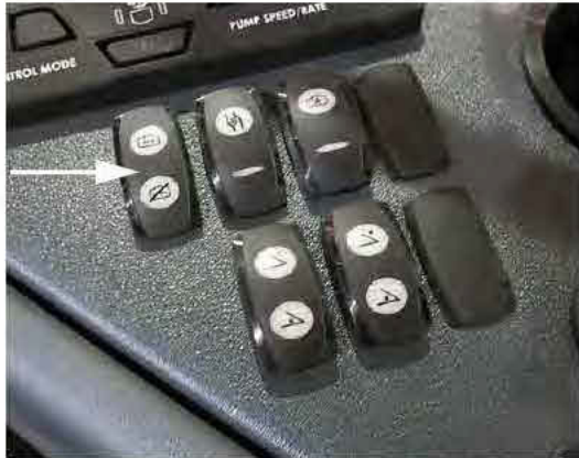
Főtartály szelep kapcsoló (oldalsó vezérlőpulton) – Tipikus nézet
