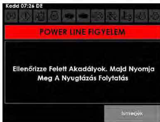
Elektromos vezeték figyelmeztető üzenet (munkagép képernyőjén található)
