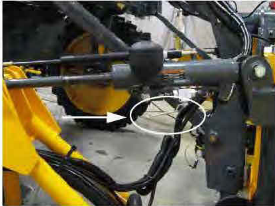
NORAC kézi szelep (2) - ha van ilyen (A szintező munkahengerek bal, és jobb oldalán helyezkedik el) – Tipikus nézet
