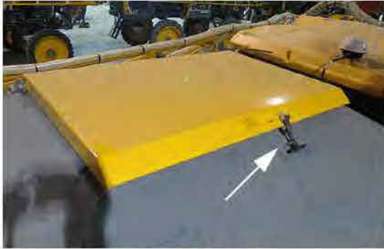
Biztonsági retesz (a száraz tartály fedélnél helyezkedik el) - Tipikus nézet
