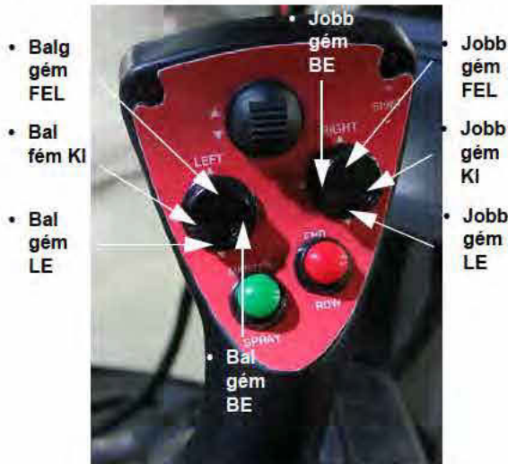
Bal és jobb oldali gém kapcsolók (A hidrosztatikus vezérlést irányító karon) – Tipikus nézet
