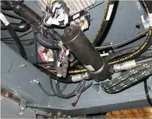
Nyomás szűrő (a gép jobb oldala alatt - a fém lemez levételével férhet hozzá) – Tipikus nézet
