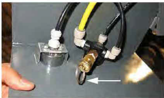
Nyomás csökkentő húzó gyűrű (A hab nyomás szabályozó hátsó oldalán) - Tipikus nézet
