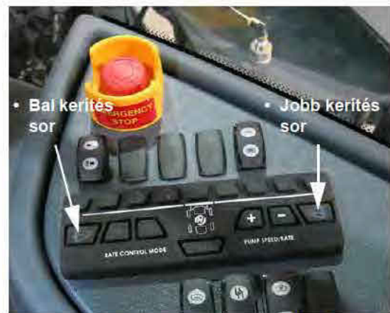
Kerítéssor kapcsolók - Bal/jobbsor (oldalsó vezérlőpulton) – Tipikus nézet
