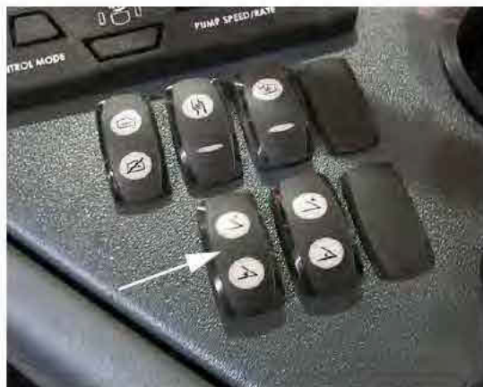
Gém toldalék kapcsoló * 90 láb permetező gémekek (oldalsó vezérlőpulton) – Tipikus nézet
