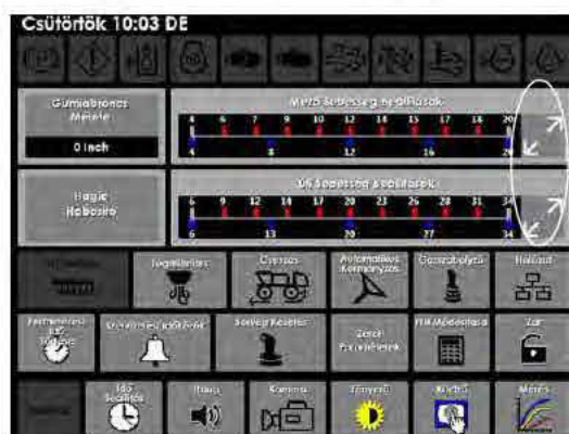
Beszabályozás gombok - Mezei/Országúti sebesség beállítások (a beállítások oldalon)
