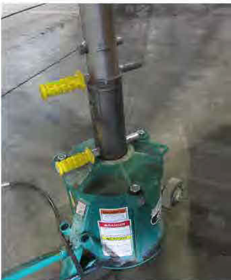
Rögzítő csapszeg elhelyezése – Tipikus nézet
