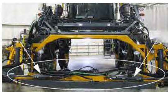
Fő forgástengely/törésgátló munkahengerek – Tipikus nézet
