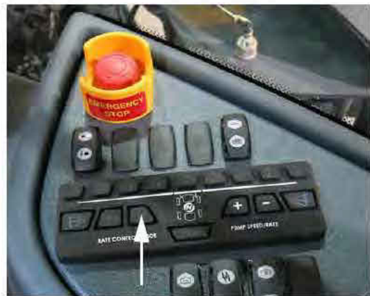
Kézi „KÉZI” arány szabályzó kapcsoló (oldalsó vezérlőpulton) – Tipikus mézet
