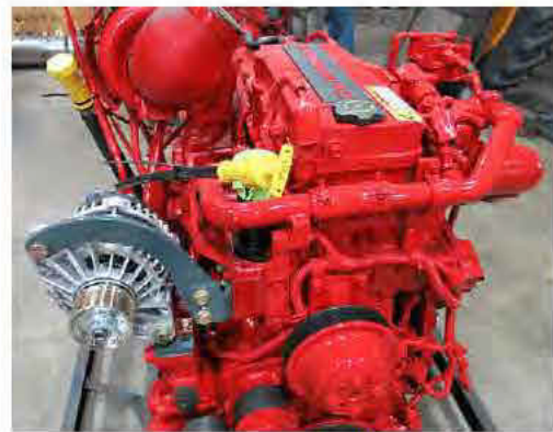
Tier 4 végső dízelmotor – Tipikus nézet
