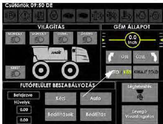
Gém állapot gombok - Automatikus/Kézi (a Segédvezérlések oldalán)
