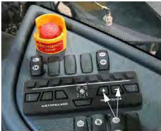
Szivattyú sebesség/Arány kapcsolók (oldalsó vezérlőpulton) –Tipikus nézet
