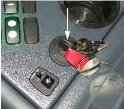
Gyújtás kapcsoló (oldalsó vezérlőpulton) – Tipikus nézet
