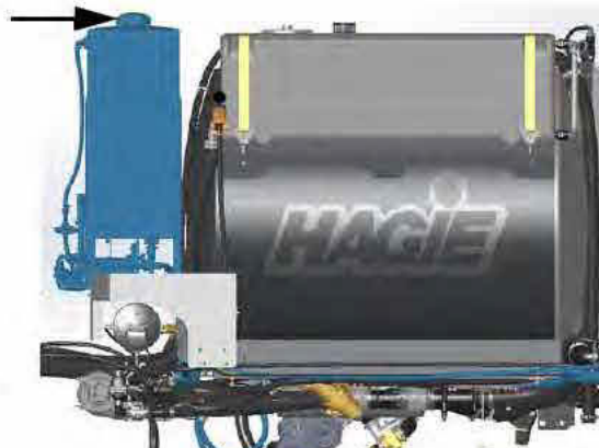
Töltő csatlakozó teteje (a permeteszertartály tetején helyezkedik el) – Tipikus nézet
