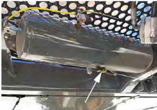
Tartály leeresztő szelep (fő) (az emelvény mögött, a gép bal oldalán helyezkedik el) * Húzza Le a kinyitáshoz – Tipikus nézet
