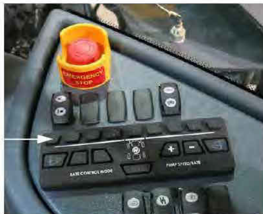
Gém permetlé szelep kapcsolók (oldalsó vezérlőpulton) – Tipikus nézet
