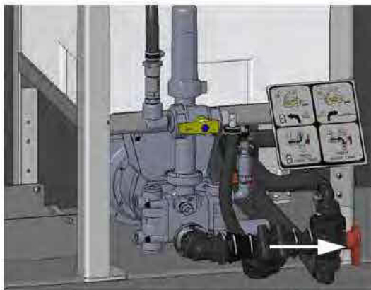
Bemenet választó szelep(ek) (elhelyezve a permetszer tartály(ok) jobb oldali aljának közelében) – Tipikus nézet * 1-tartály/1-szivattyú elrendezés látható
