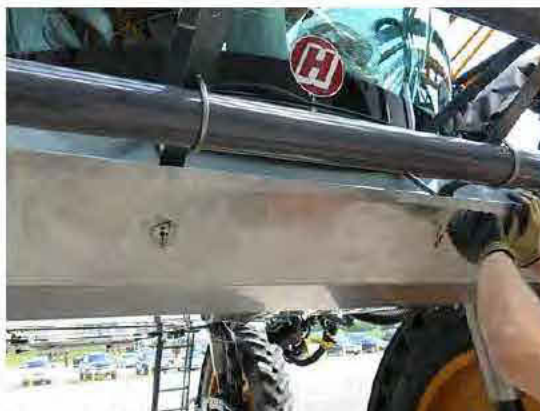
Elülső alvázvédelmi szerelvény telepítése – Tipikus nézet
