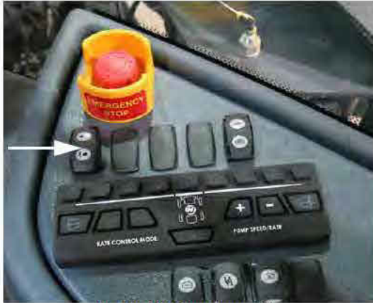
Habjelölő kapcsolója (az oldalkonzolon található) - Tipikus nézet
