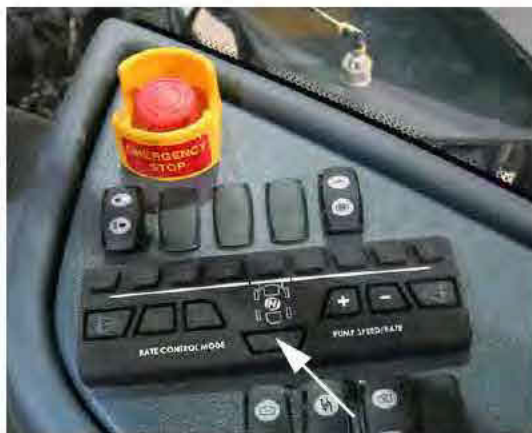
Hátsó fúvóka kapcsoló (oldalsó vezérlőpulton) – Tipikus nézet
