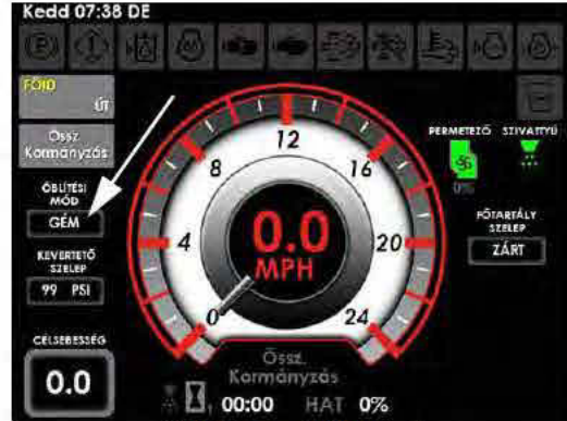
Öblítés mód kijelző (a munkagép képernyőjének kezdőoldalán - Mezei módban)
