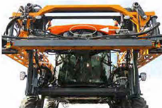
Szélvédőmosó folyadék fúvóka (a fülke külső részének a tetejénél) – Tipikus nézet
