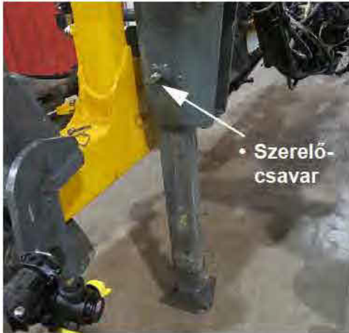
Gém állvány (kihajtott pozíciót mutatja) – Tipikus nézet
