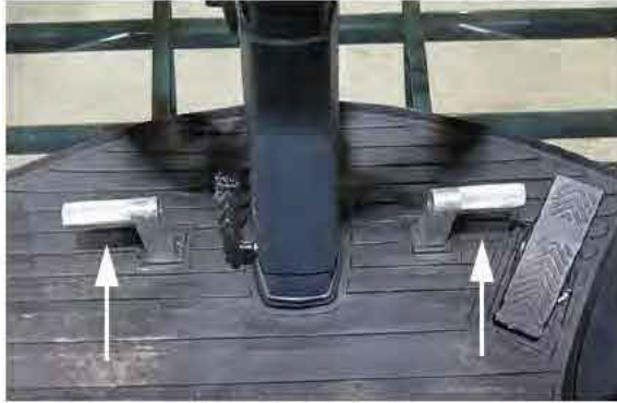
Kezelői lábtartók (a kormányoszlop mindkét oldalán) – Tipikus nézet
