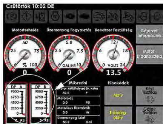
HSZ-A/HSZ-B mérőműszerek (a gépdiagnosztika oldal jobb oldalán alul)
