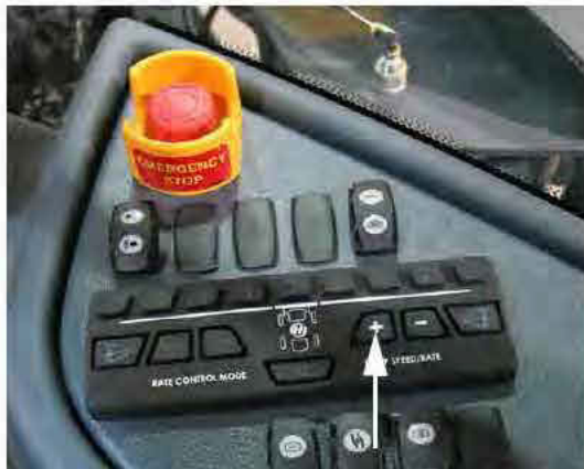
„+” szivattyú sebesség/arány kapcsoló (oldalsó vezérlőpulton) – Tipikus nézet
