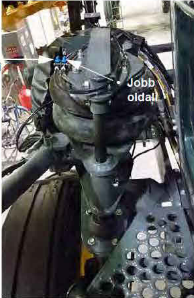
Lég-felfüggesztő szelepek (A bal kéz felőli első légzsáknál helyezkedik el) – Tipikus nézet
