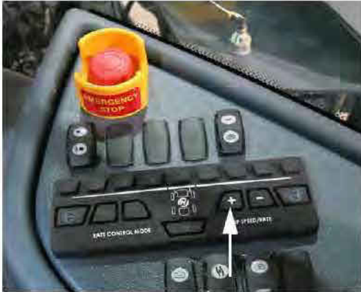
„+” szivattyú sebesség/arány kapcsoló (oldalsó vezérlőpulton) – Tipikus nézet
