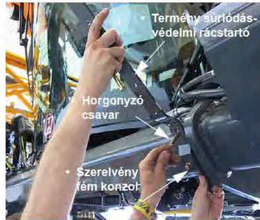
Termény súrlódásvédelmi rácstartó – Tipikus nézet
