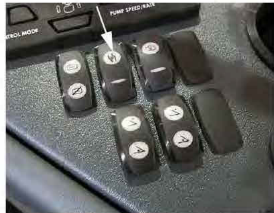
Permetlé szivattyú kapcsoló (oldalsó vezérlőpulton) – Tipikus nézet
