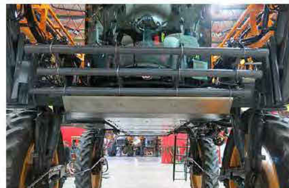
Termény súrlódásvédelem telepítése – Tipikus nézet
