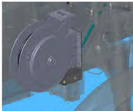
Nagynyomású mosó nyomótömlő cséve (A gép jobb oldalának hátuljának közelében) – Tipikus nézet
