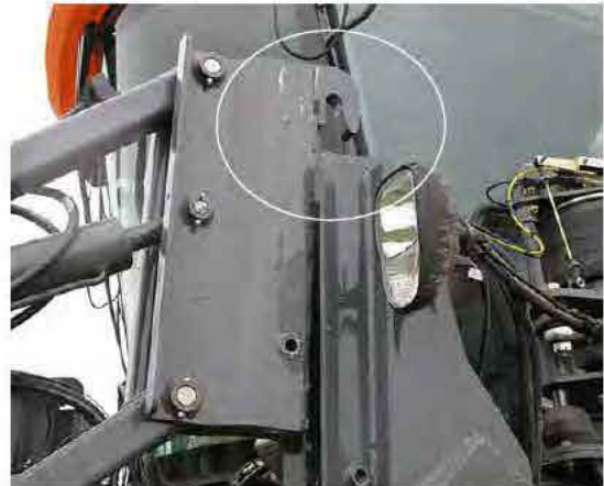
Csatolmány szerelőcsap – Tipikus nézet
