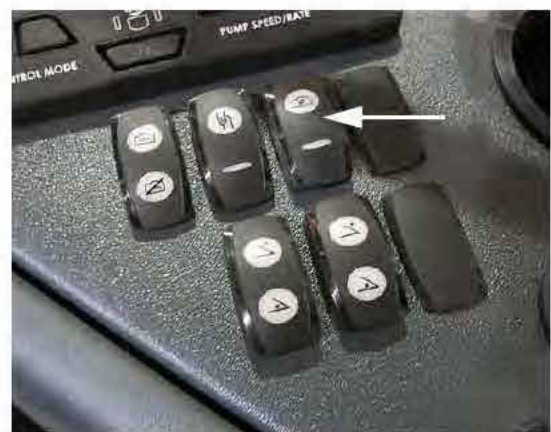
Keverőszelep kapcsolója (oldalsó vezérlőpulton) – Tipikus nézet
