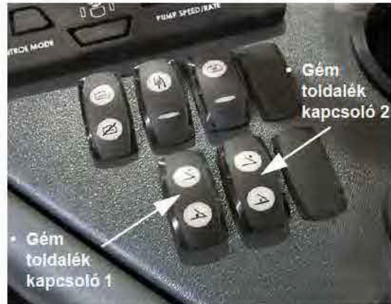
Gém toldalék kapcsolók - Bal/jobb (oldalsó vezérlőpulton) – Tipikus nézet
