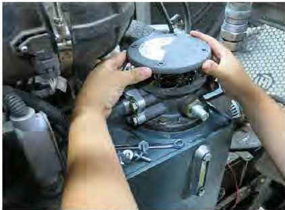
Tartály töltése a hidraulikus visszavezető szűrőházon keresztül –Típikus nézet
