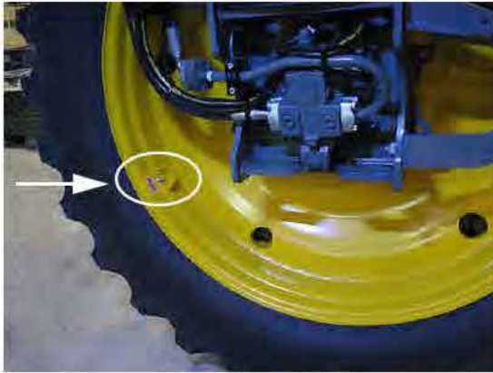
Szelepszár (4) (az egyes kerekek belsején) – Tipikus nézet
