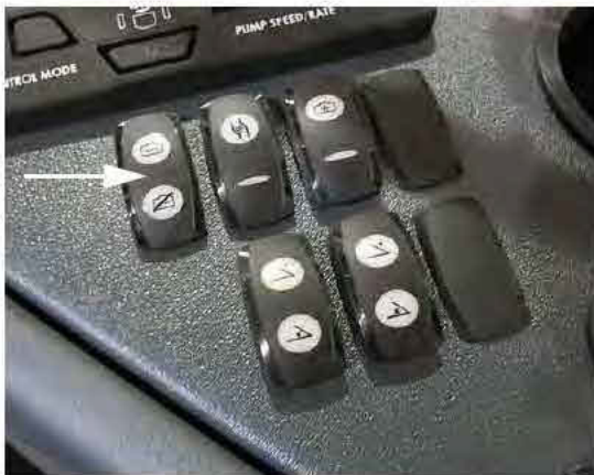
Főtartály szelep kapcsolója (oldalsó vezérlőpulton) – Tipikus nézet
