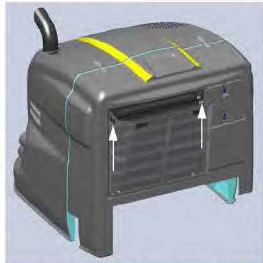
- Motor légbeszívó rugós szorítói (a belső légbeszívó tetejének bal, és jobb oldalain helyezkedik el) – Tipikus nézet
