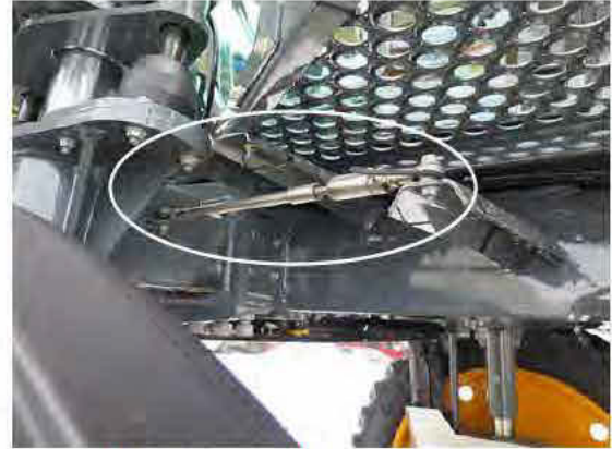
Nyomtáv beállító érzékelő (4) (Minden lábon egy van elhelyezve) – Tipikus nézet
