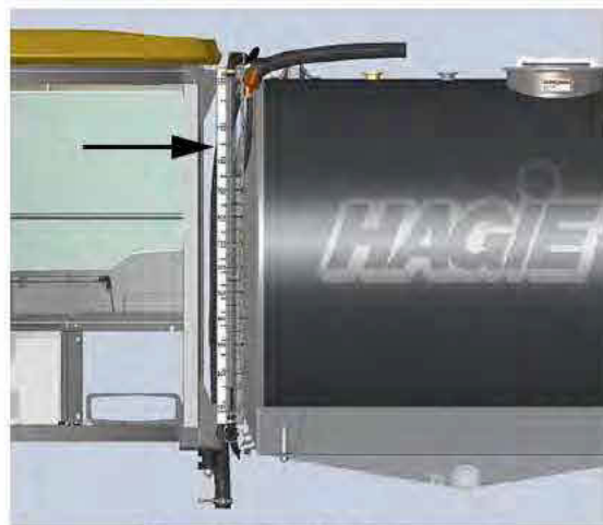
Permetlé tartály szintmérő (A fülke bal kéz felőli oldalának hátlujja mögött helyezkedik el) – Tipikus nézet
