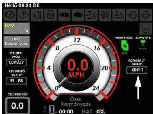
Főtartály szelep állapot kijelző (a gép képernyőjének kezdőoldalán - Mezei üzemmód) - Tipikus nézet
