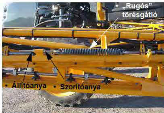
Rugós törésgátló beállítás / szorító anyák (a rugós törésgátló külső végének közelében helyezkedik el) – Tipikus nézet
