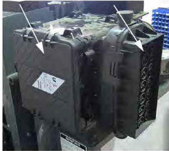
Motor Levegőbeszívó Szűrő és Előtisztító (a gép bal kéz felőli oldalához közel helyezkedik el) – Tipikus nézet
