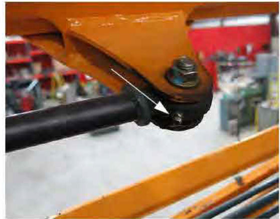
Gém törésgátló henger rúd vég – Tipikus nézet
