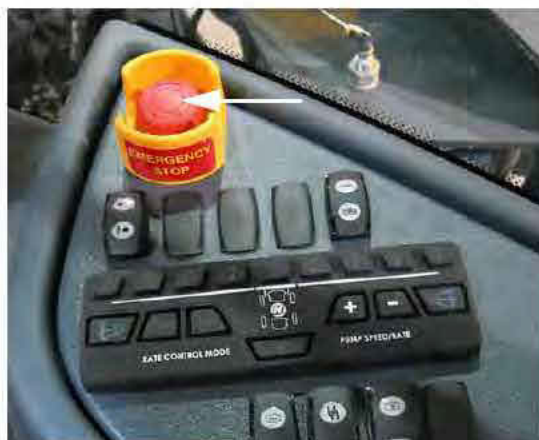
E-Stop kapcsoló (oldalkonzolon) – Tipikus nézet
