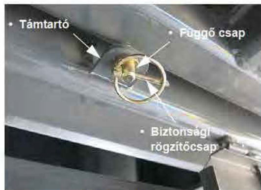
Támtartó/biztonsági rögzítőcsap összeillesztése – Tipikus nézet
