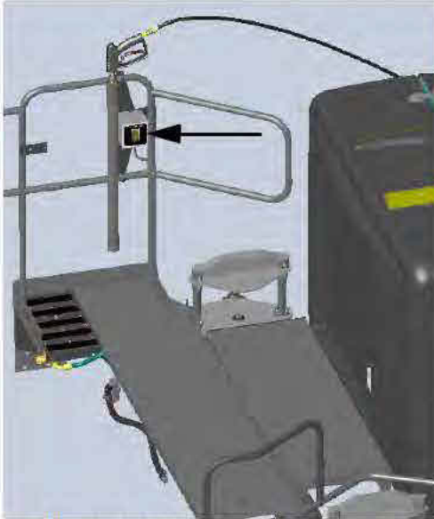
Nagynyomású tisztító kapcsoló (A jobb oldali korlátra van felszerelve) – Tipikus nézet
