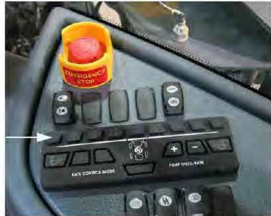
Gép permetlé szelep kapcsolók (oldalsó vezérlőpulton) – Tipikus nézet
