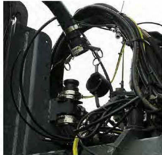
Permetezőszer vezeték csatlakoztatása (a gép elülső jobb oldalánál helyezkedik el) – Tipikus nézet
