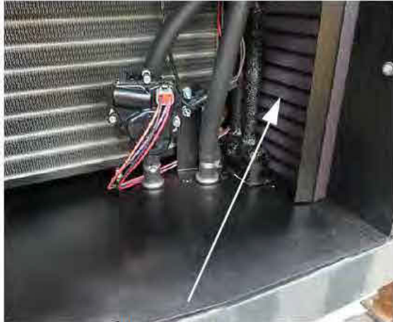
Újrakeringető szűrő (A szerviz rekesz jobb oldalán helyezkedik el) – Tipikus nézet
