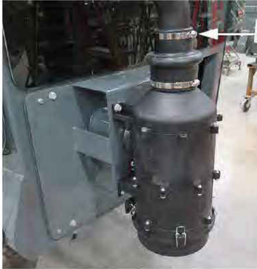
Karimás bilincs - felső (A RESPA szűrőegység tetejének közelében helyezkedik el) – Tipikus nézet
