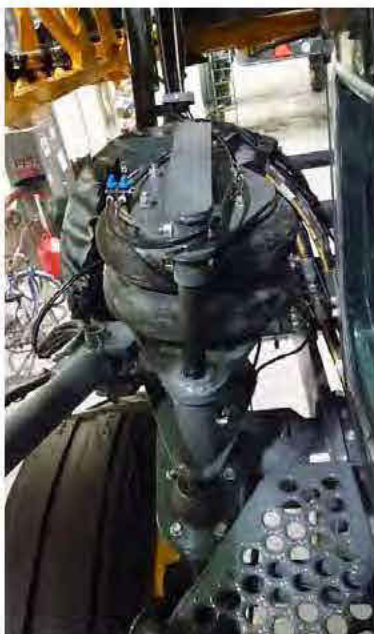
Coussin d'air (situé sur chaque jambe de la machine) - Vue typique
