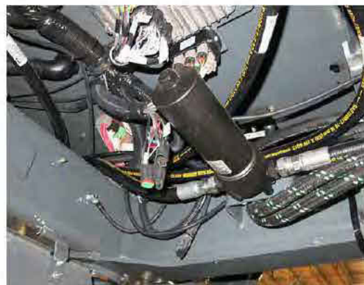
Filtre sous pression (situé sous le côté droit de la cabine - ouvrez le capot pour y accéder) - Vue typique
