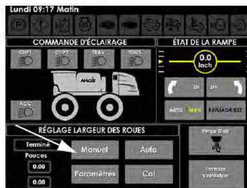
Touche Manuel (située sur la page Contrôles auxiliaires de l'afficheur de la machine)
