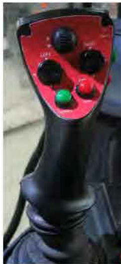
Levier de vitesse de la transmission hydrostatique - Vue typique
