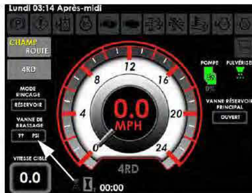
Indicateur de pression de la vanne de brassage (situé sur la page d'accueil de l'afficheur de la machine - mode Route et mode Champ)
