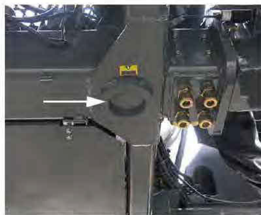
Anneau de rétention du point de levage (situé sur le châssis, près de chaque jambe) - Vue typique
