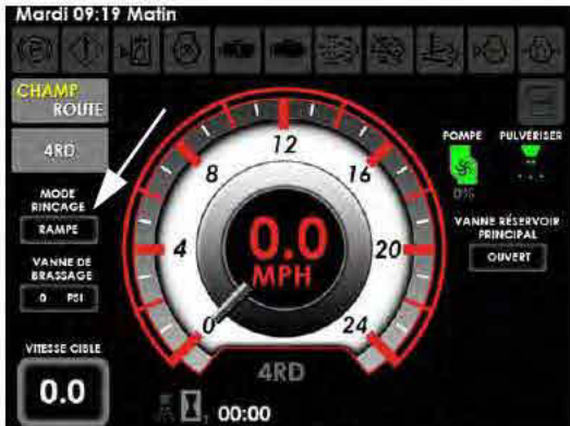
Indicateur du mode Rinçage (situé sur la page d'accueil de l'afficheur de la machine - mode Champ)
