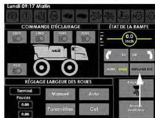
Touche Repliage Ext (située sur la page Contrôles auxiliaires)
