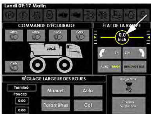
Valeur Alignement de la rampe (située sur la page Contrôles auxiliaires)
