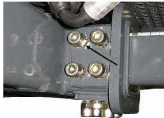
Contre-écrou (situé sur chaque boulon du palier de réglage de la largeur des roues) - Vue typique
