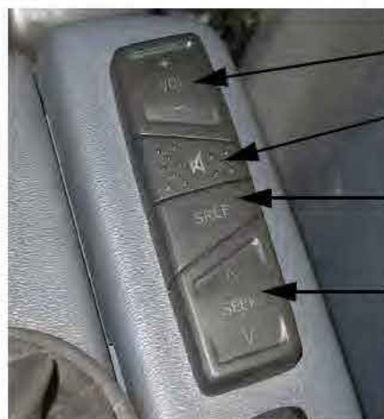
Commandes audio à distance (situées près du levier de vitesse de la transmission hydrostatique) - Vue typique
