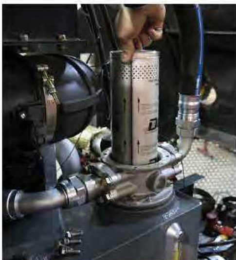
Filtre de retour (situé à l'intérieur du boîtier du filtre) - Vue typique
