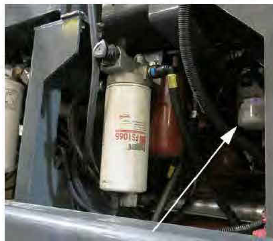
Filtre à huile moteur (situé le long du côté gauche de la machine - ouvrez le capot pour y accéder) - Vue typique
