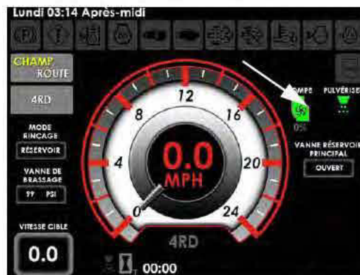
Indicateur de la pompe à solution (situé sur la page d'accueil de l'afficheur de la machine - mode Champ)
