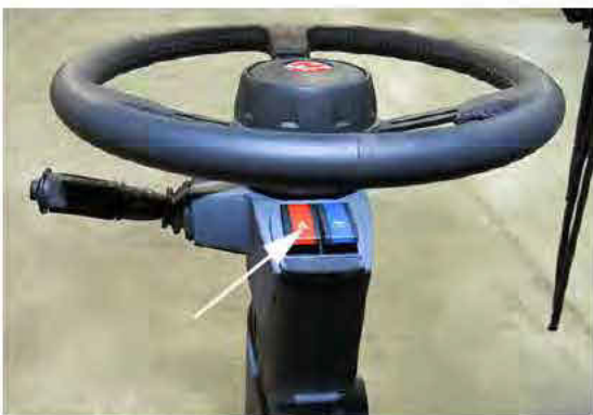
Interrupteur des feux de détresse / feux d'avertissement (situé sur la colonne de direction) - Vue typique
