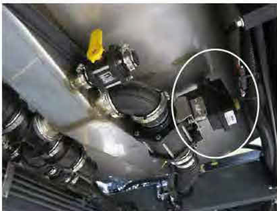
Vanne du réservoir de solution (située sous le réservoir de solution sur le dessous de la machine) - Vue typique
