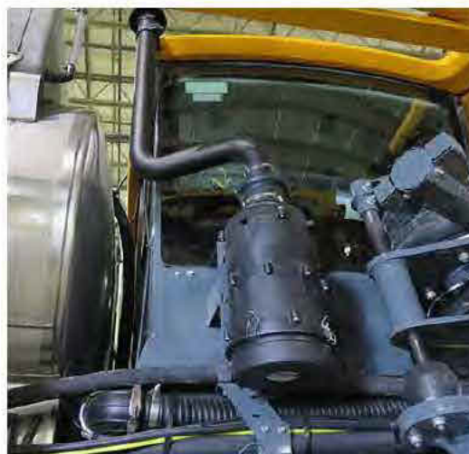
Système de filtration de la cabine (situé sur le côté droit à l'extérieur de la cabine) - Vue typique
