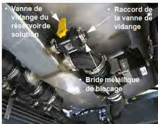
Ensemble de la vanne de vidange du réservoir de solution (situé sous le réservoir de solution sur le dessous de la machine) - Vue typique
