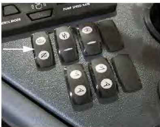
Interrupteur de la vanne du réservoir principal (situé sur la console latérale) - Vue typique
