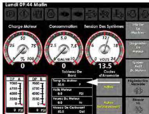
Indicateur de température du liquide de refroidissement moteur (situé sur la page Diagnostic de la machine)
