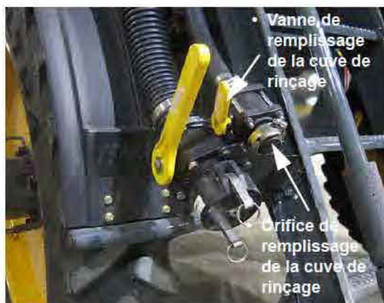
Dispositif de remplissage par l'arrière (situé derrière la roue arrière gauche) - Vue typique
