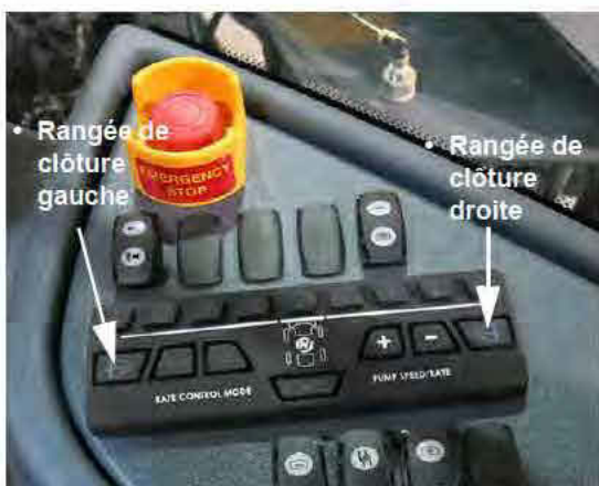
Commutateurs de rangée de clôture - Gauche/Droit (situés sur la console latérale) - Vue typique
