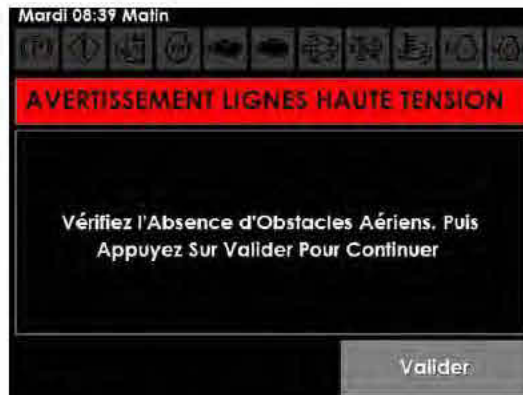
Avertissement lignes haute tension (situé sur l'afficheur de la machine)
