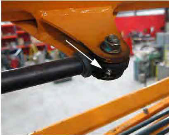
Extrémité de la tige du vérin de décrochage de la rampe - Vue typique
