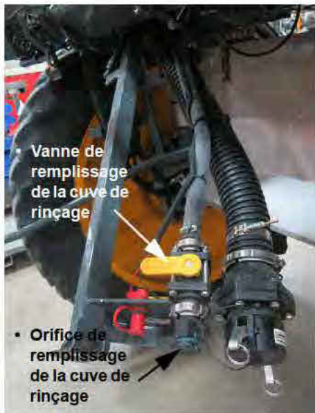
Dispositif de remplissage par l'avant (illustré en position abaissée) - Vue typique
