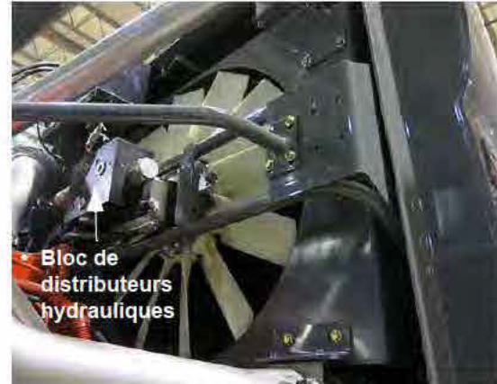
Ventilateur réversible (situé vers l'arrière de la machine - ouvrez le capot pour y accéder) - Vue typique
