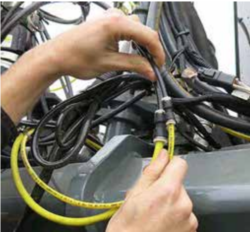
Branchement du marqueur à mousse (situé sur le côté avant droit de la machine) - Vue typique
