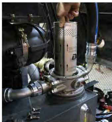
Filtre de retour (situé à l'intérieur du boîtier de filtre à air sur le côté gauche de la machine) - Vue typique
