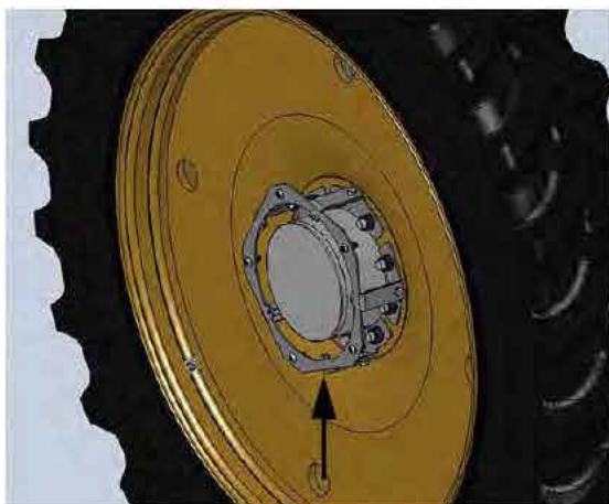
Ensemble soudé d'adaptation du cache-moyeu - Vue typique
