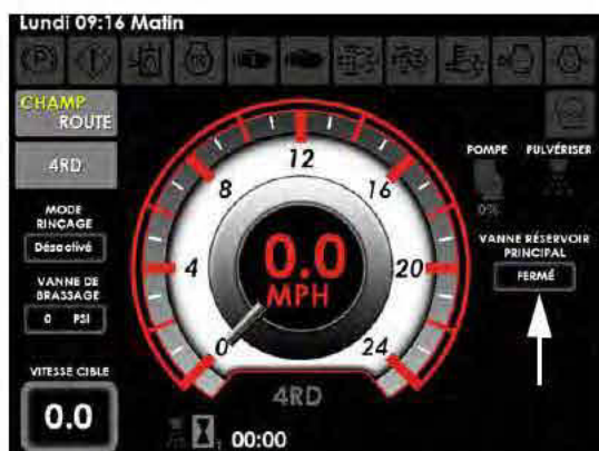
Indicateur d'état de la vanne du réservoir principal (situé sur la page d'accueil de l'afficheur de la machine - mode Champ) - Vue typique
