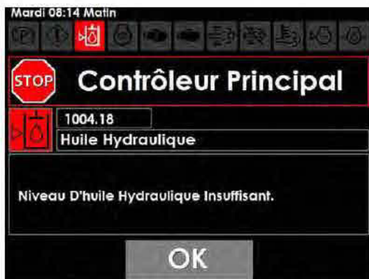
Message d'avertissement de niveau d'huile hydraulique bas (situé sur l'afficheur de la machine)
