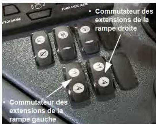
Commutateurs d'extension des rampes droite et gauche (situés sur la console latérale) - Vue typique
