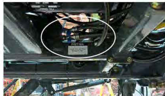
Orifices de pressurisation de la climatisation (situés sous la partie centrale du châssis) - Vue typique
