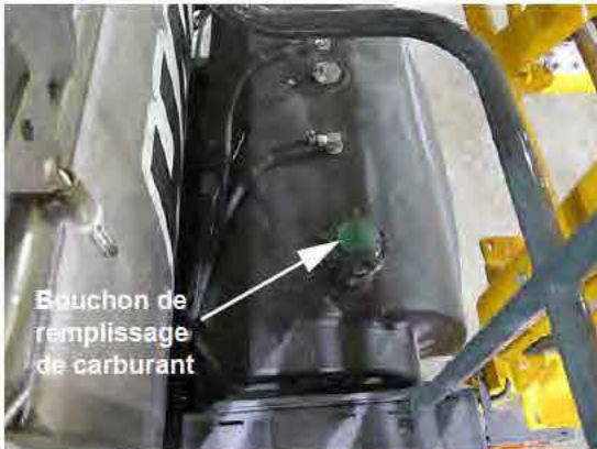
Remplissage de carburant (situé sur le haut du réservoir de carburant, du côté droit de la machine) - Vue typique
