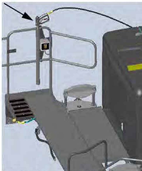
Lance du nettoyeur haute pression (monté sur la main courante sur la partie arrière droite de la machine) - Vue typique
