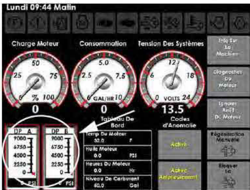
Indicateurs PE A et PE B (situés sur la page Diagnostic de la machine)
