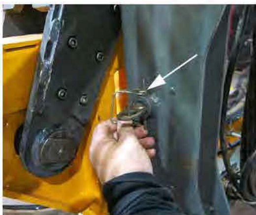
Clavette de sécurité (située sur la partie extérieure du châssis de la traverse) - Vue typique
