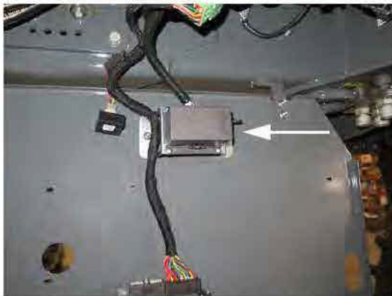
Boîte à relais de la pompe à solution (située en dessous de la partie avant de la cabine - abaisser le panneau pour y accéder) - Vue typique
