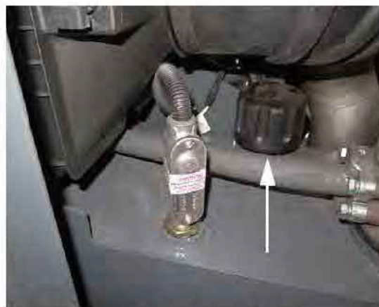
Bouchon de reniflard (situé sur le dessus du réservoir d'huile hydraulique) - Vue typique
