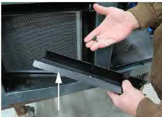
Support du filtre (situé sur le côté droit du filtre à charbon actif) - Vue typique
