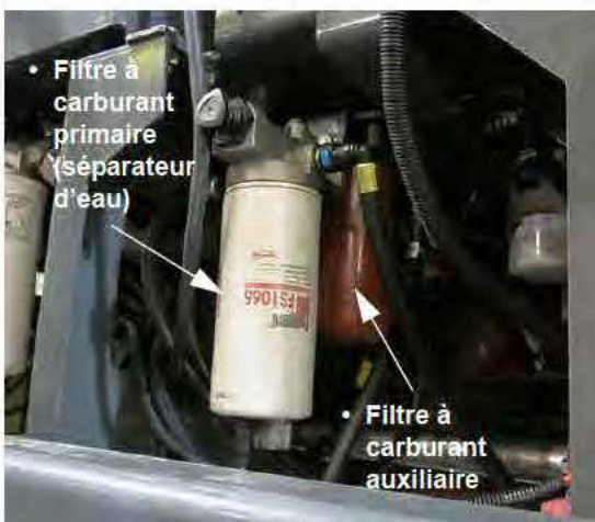
• Filtre à carburant primaire (séparateur d'eau) • Filtre à carburant auxiliaire Filtres à carburant principal et auxiliaire (situé le long du côté gauche de la machine - ouvrez le capot pour y accéder) - Vue typique
