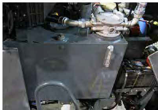
Réservoir d'huile hydraulique (situé sur le côté gauche de la machine - ouvrez le capot pour y accéder) - Vue typique
