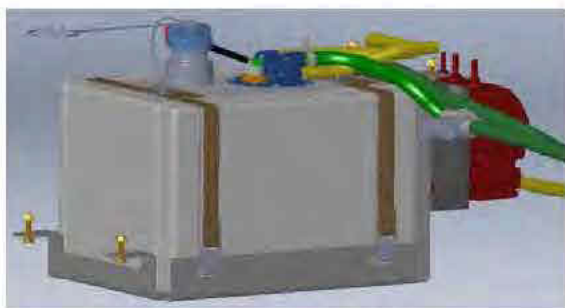
Réservoir d'AUS 32 (situé sous la partie centrale de la machine) - Vue typique
