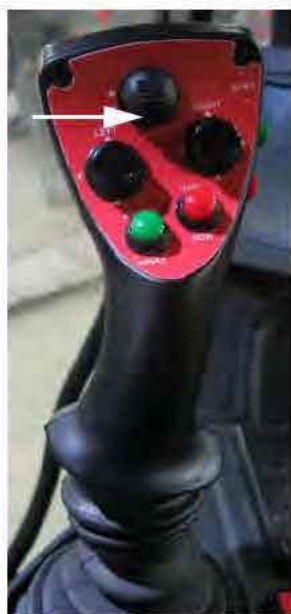
Commutateur de la traverse - BAS (situé sur le levier de vitesse de la transmission hydrostatique) - Vue typique
