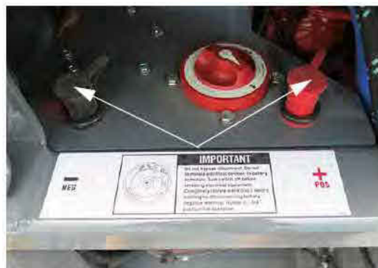
Bornes de charge de la batterie auxiliaire (situées sur le châssis principal arrière) - Vue typique
