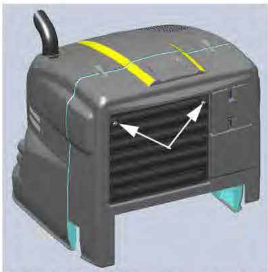
Agrafes à ressort de la grille de calandre (2) (situées en haut de la grille, à gauche et à droite) - Vue typique
