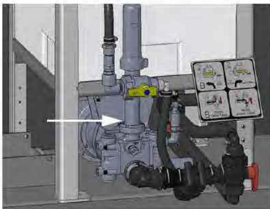
Pompe(s) d'injection (située(s) dans la partie en bas du/des réservoir(s) de produit(s) chimique(s)) - Vue typique
