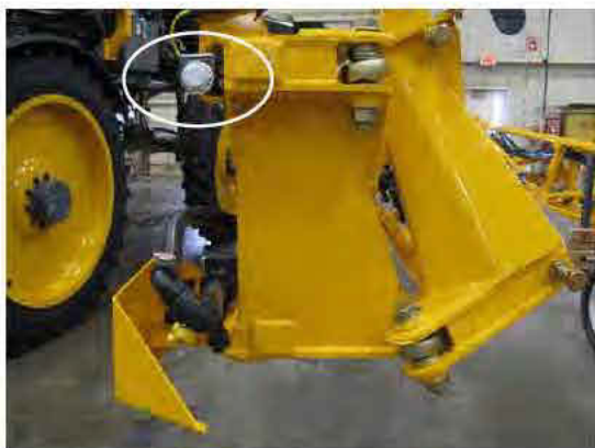
Capteurs de proximité - Vue typique
