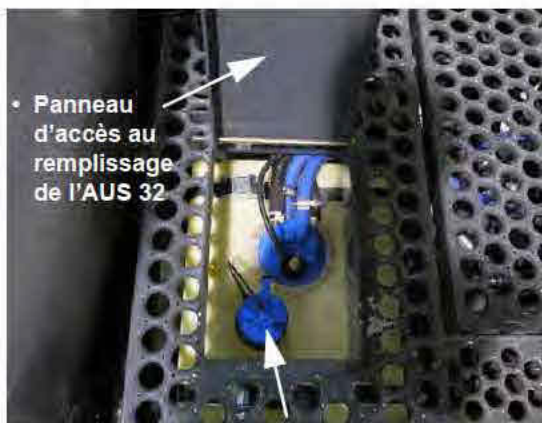
• Panneau d'accès au remplissage de l'AUS 32 Bouchon de remplissage de l'AUS 32 (situé sous la plate-forme centrale, derrière le réservoir de solution - soulevez le panneau pour y accéder) - Vue typique
