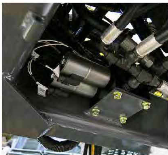
Collecteur de commande des vannes (situé sur le dessous de la machine) - Vue typique
