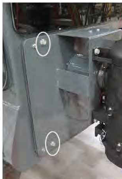
Boulons de fixation (4) (deux situés de chaque côté du panneau d'accès extérieur sur le côté droit de la cabine) - Vue typique
