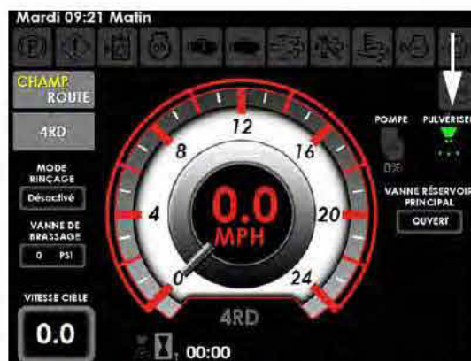
Indicateur du pulvérisateur principal (situé sur la page d'accueil de l'afficheur de la machine - mode Champ) - Vue typique
