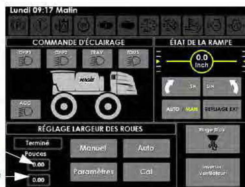
Indicateurs de largeur des roues avant/arrière (situés sur la page Contrôles auxiliaires de l'afficheur de la machine)
