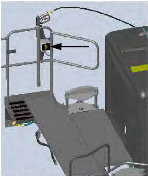
Interrupteur du nettoyeur haute pression (monté sur la main courante sur la partie arrière droite de la machine) - Vue typique
