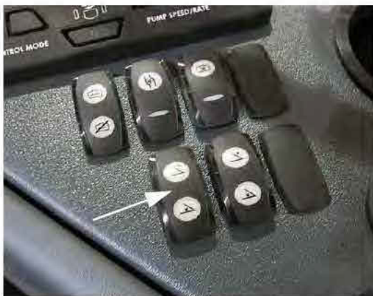
Commutateur des extensions de la rampe * Rampes de pulvérisation de 27 mètres (situé sur la console latérale) - Vue typique
