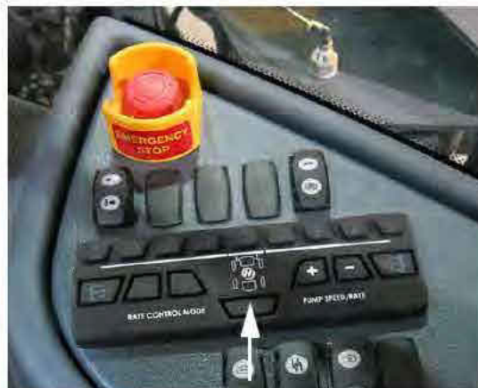
Interrupteur des buses arrière (situé sur la console latérale) - Vue typique
