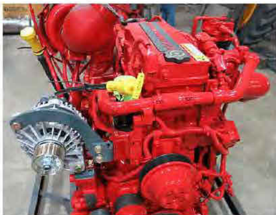
Moteur Tier 4 Final (situé vers l'arrière de la machine - ouvrez le capot pour y accéder) - Vue typique
