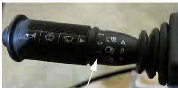
Vitesses des essuie-glaces (situées sur le levier des clignotants) - Vue typique
