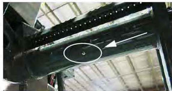
Tube de pivotement de l'échelle - Vue typique
