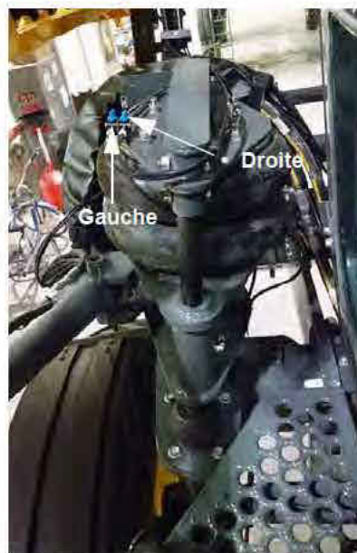
Vannes de la suspension pneumatique (situées sur le coussin d'air gauche avant) - Vue typique
