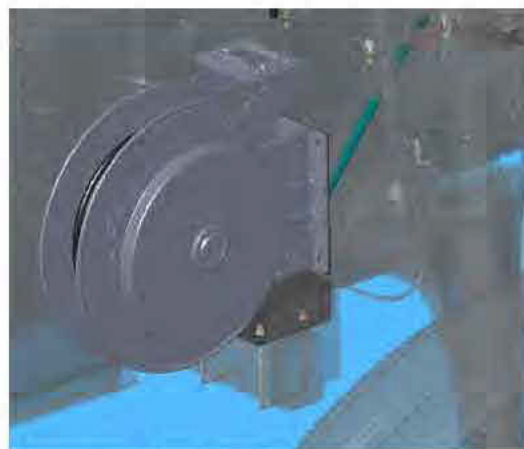
Enrouleur du tuyau du nettoyeur haute pression (situé sur la partie arrière droite de la machine) - Vue typique
