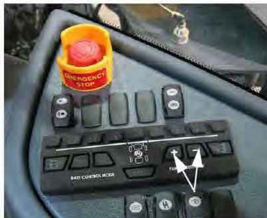
Commutateurs de vitesse/ de débit de la pompe (situés sur la console latérale) - Vue typique
