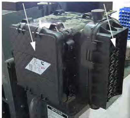
Filtre de l'admission d'air et prénettoyeur d'air du moteur (situés sur le côté arrière gauche de la machine) - Vue typique
