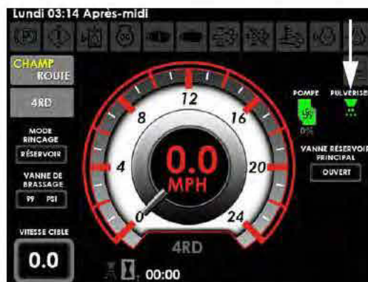
Indicateur du pulvérisateur principal (situé sur la page d'accueil de l'afficheur de la machine - mode Champ)
