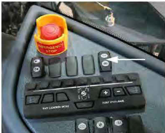
Interrupteur de rinçage (situé sur la console latérale) - Vue typique
