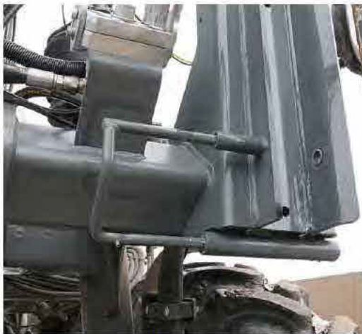
Clavette de sécurité (situées à l'avant gauche et droit de la machine) - Vue typique
