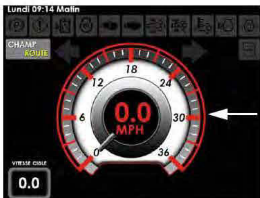
Compteur de vitesse (situé sur la page d'accueil de l'afficheur de la machine - Mode Route ou mode Champ)
