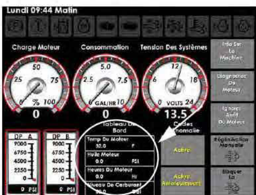
Diagnostic des systèmes (situé sur la page Diagnostic de la machine)
