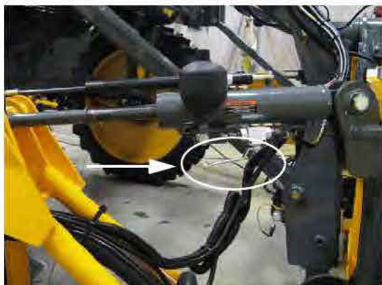
Vannes manuelles NORAC (2) - si la machine en est équipée (situées sur les vérins de mise de niveau gauche et droit) - Vue typique
