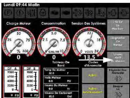
Touche Annulation de l'arrêt du moteur (située sur la page Diagnostic de la machine)
