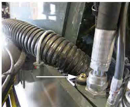
Boulons de fixation (2) - Avant/arrière (situés sur le support de fixation de l'ensemble des tuyaux flexibles de la traverse de droite) - Vue typique
