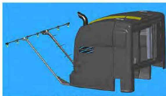
Installation de la rampe arrière - Vue typique
