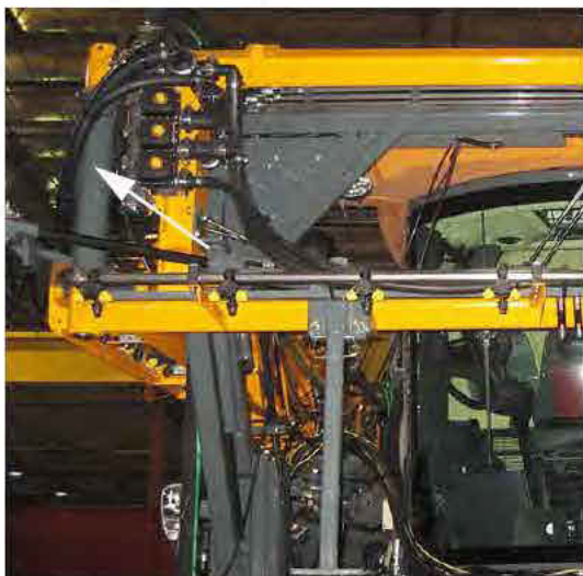
Tube de pivotement de la traverse - Vue typique
