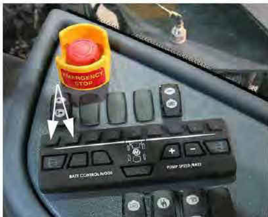
Interrupteurs 1 et 2 des vannes de solution de la rampe (situés sur la console latérale) - Vue typique
