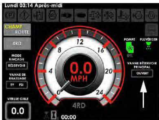
Indicateur d'état de la vanne du réservoir principal (situé sur la page d'accueil de l'afficheur de la machine - mode Champ)
