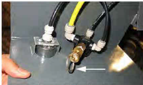
Anneau de traction de décharge de la pression (situé sur la partie arrière du régulateur de pression du mousser) - Vue typique
