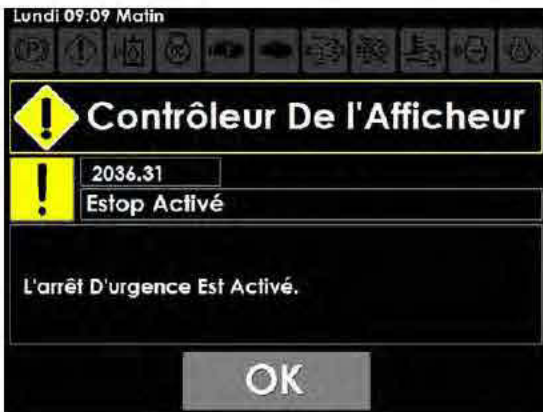
Message de bouton d'arrêt d'urgence activé (situé sur l'afficheur de la machine)
