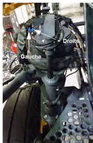
Vannes de la suspension pneumatique (situées sur le côté gauche Des coussins d'air avant et arrière) - Vue typique
