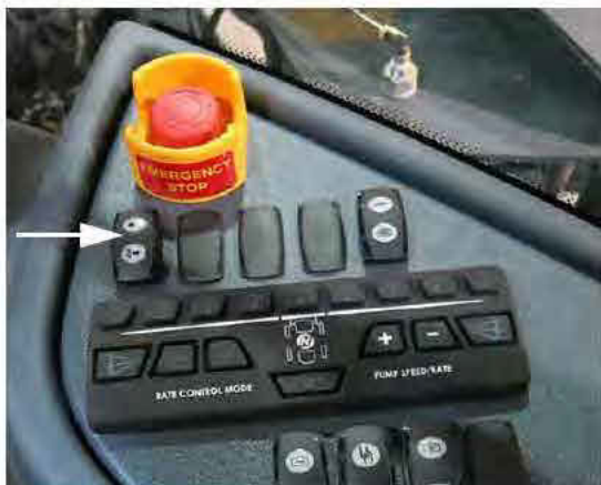
Commutateur du marqueur à mousse (situé sur la console latérale) - Vue typique
