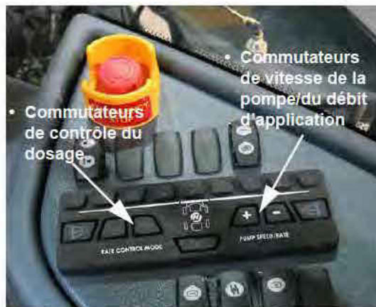
Commutateurs de contrôle du dosage et de vitesse/de débit de la pompe (situés sur la console latérale) - Vue typique
