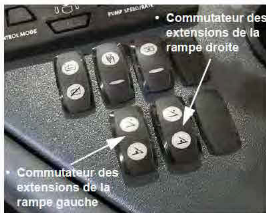
Commutateurs d'extension des rampes droite et gauche (situés sur la console latérale) - Vue typique
