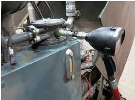
Remplissage du réservoir par l'orifice de remplissage d'huile hydraulique - Vue typique
