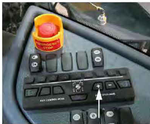
Commutateur « + » de vitesse de la pompe/du débit d'application (situé sur la console latérale) - Vue typique
