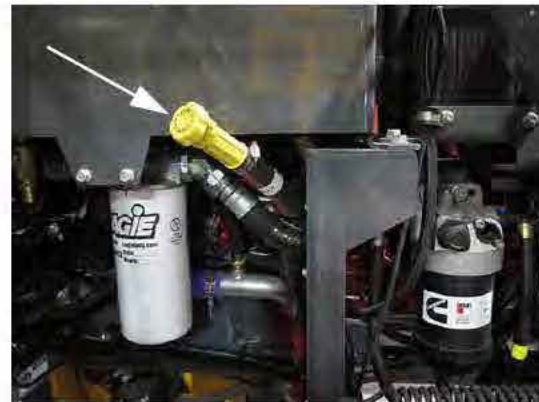
Orifice de remplissage d'huile moteur à distance (situé à l'arrière gauche de la machine) - ouvrez le capot pour y accéder) - Vue typique
