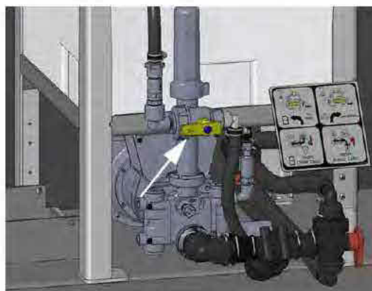
Vanne(s) de sélection des sorties (située(s) devant la/les pompe(s) d'injection) - Vue typique
