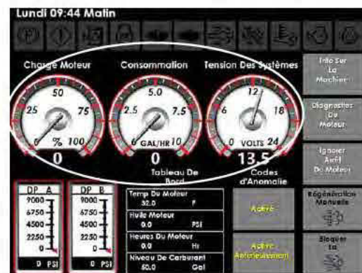
Instruments de mesure des systèmes (situés sur la page Diagnostic de la machine)
