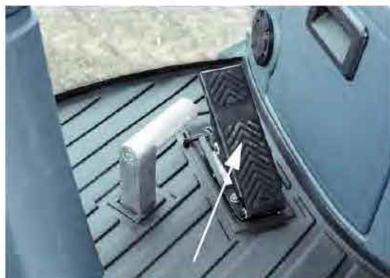
Pédale de décélération (située dans la partie inférieure droite de la colonne de direction) - Vue typique
