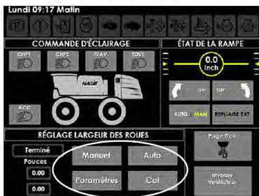
Touches de réglage de la largeur des roues (situées sur la page Contrôles auxiliaires)
