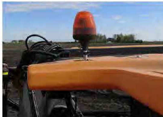
Gyrophare (2) (situés de chaque côté de la partie avant du toit de la cabine) - Vue typique
