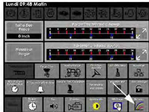
Touche Mesure (située sur la page Configuration des paramètres)
