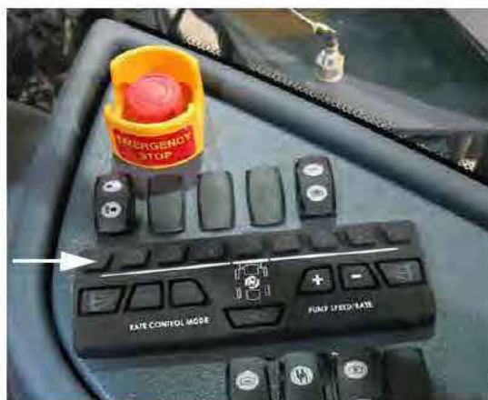
Interrupteurs des vannes de solution de la rampe (situé sur la console latérale) - Vue typique
