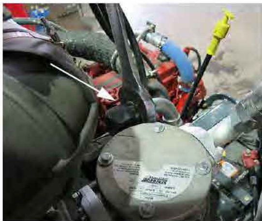
Tuyau flexible de vidange du carter (situé près de la partie supérieure du réservoir d'huile hydraulique) - Vue typique
