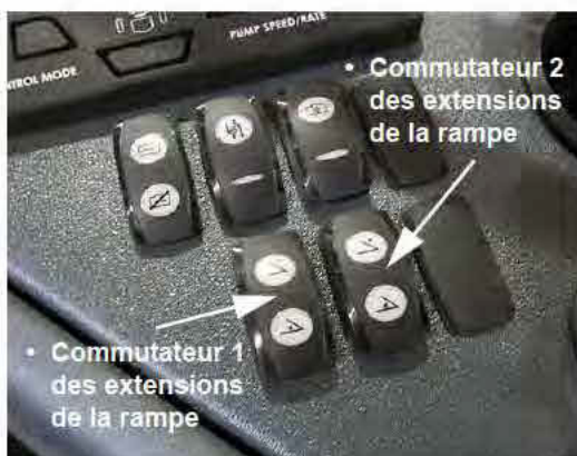
Commutateurs des extensions de la rampe - Gauche/Droit (situés sur la console latérale) - Vue typique
