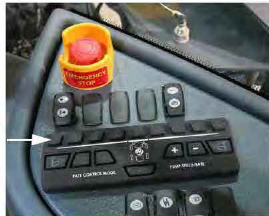
Interrupteurs des vannes de solution de la rampe (situés sur la console latérale) - Vue typique
