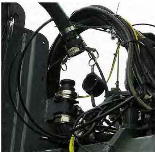
Branchement du système de solution (situé sur le côté avant droit de la machine) - Vue typique
