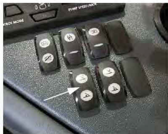
Commutateur des extensions de la rampe * Rampes de pulvérisation de 27 mètres (situé sur la console latérale) - Vue typique
