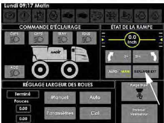
Touche Repliage Ext (située sur la page Contrôles auxiliaires de l'afficheur de la machine)
