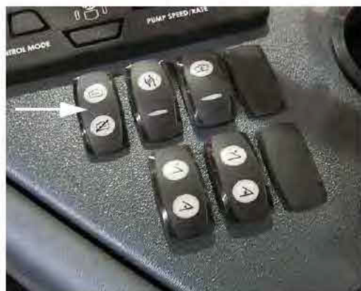
Interrupteur de la vanne du réservoir principal (situé sur la console latérale) - Vue typique
