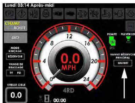
Indicateur d'état de la vanne du réservoir principal (situé sur la page d'accueil de l'afficheur de la machine - mode Champ)
