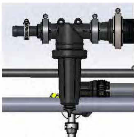
Crépines de sections (Situées tout au long des diverses sections de la rampe) - Vue typique
