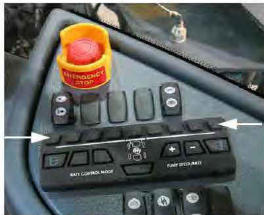
Interrupteurs des vannes de solution de la rampe - Sections 1 et 9 (situés sur la console latérale) - Vue typique
