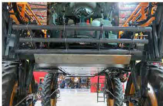
Installation du pare-broussailles - Vue typique
