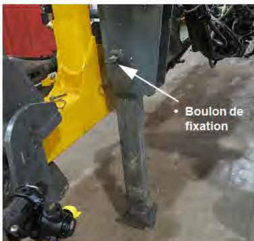
Chandelle de support de la rampe (illustrée en position étirée) - Vue typique
