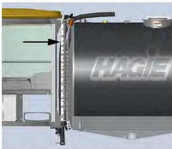
Jauge de niveau du réservoir de solution (située derrière la partie arrière gauche de la cabine) - Vue typique
