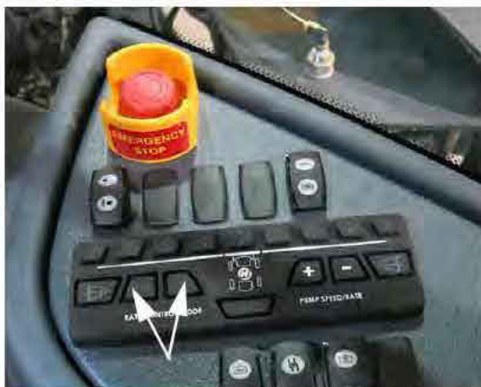
Commutateurs de contrôle du dosage (situés sur la console latérale) - Vue typique
