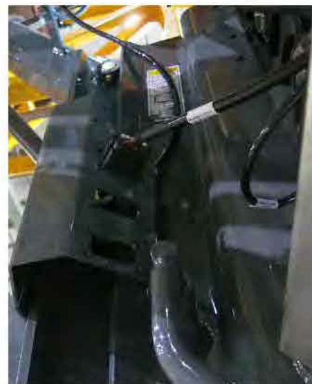
Branchement du système NORAC - si la machine en est équipée (situé sur le côté avant droit de la machine) - Vue typique
