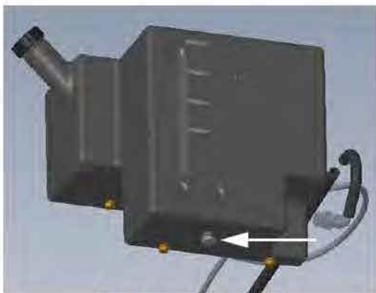
Bouchon de vidange (situé sous le réservoir du lave-mains) - Vue typique
