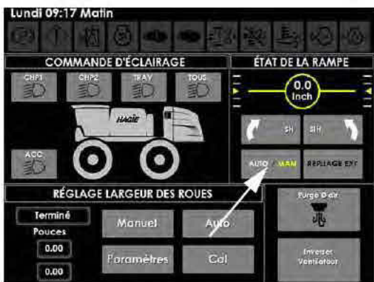
Touche État de la rampe - Auto/Manuel (située sur la page Contrôles auxiliaires de l'afficheur de la machine)
