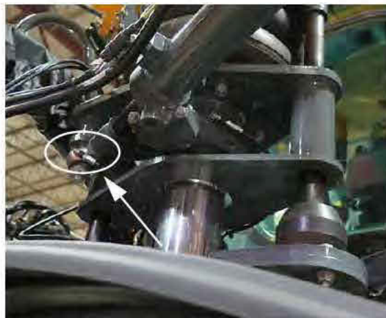
Embout de graissage de la rotule de la biellette de direction (2) (situés sur chacune des jambes avant) - Vue typique
