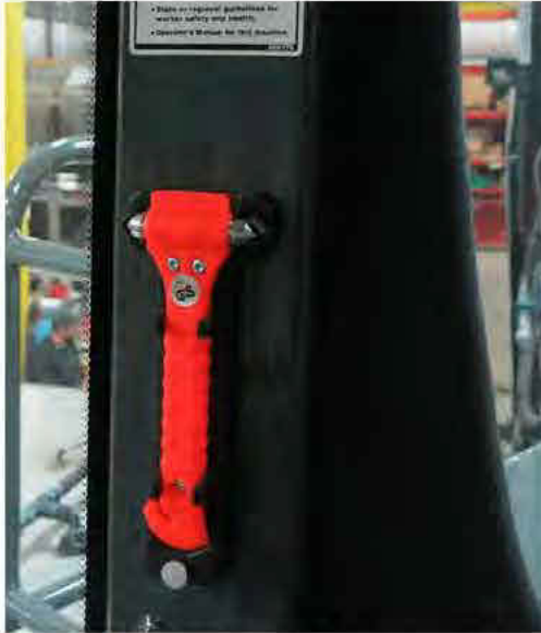
Outil d'évacuation d'urgence (situé le long du côté droit de la cabine) - Vue typique
