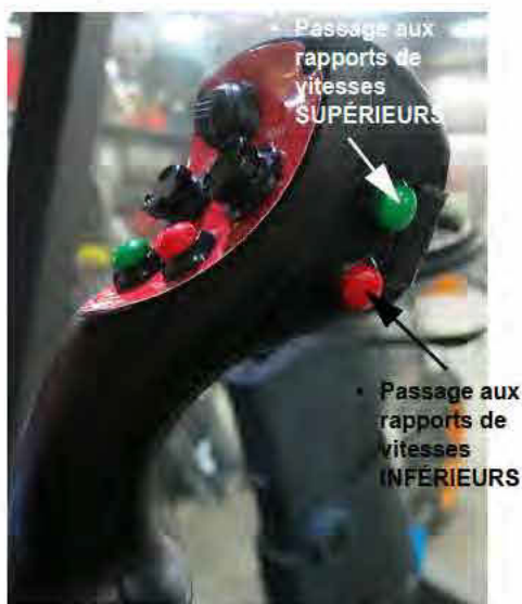
Commutateurs de passage aux rapports de vitesses supérieurs/inférieurs (situés sur le côté du levier de vitesse de la transmission hydrostatique) - Vue typique
