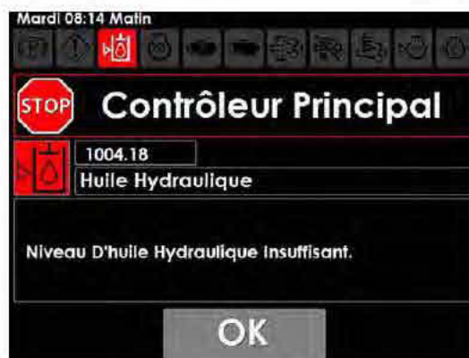
Message d'avertissement de niveau d'huile hydraulique bas (situé sur l'afficheur de la machine)
