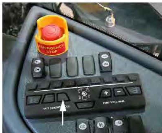
Commutateur de commande manuelle (« MANUEL ») du dosage (situé sur la console latérale) - Vue typique
