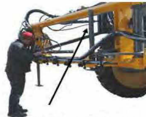
Chandelle de support de la rampe en position « Déplacement » - Vue typique
