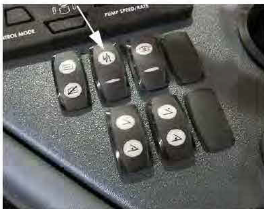
Interrupteur de la pompe à solution (situé sur la console latérale) - Vue typique
