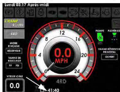
Indicateur de temps d'application de la pulvérisation (situé sur la page d'accueil de l'afficheur de la machine - mode Champ)
