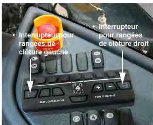
Interrupteurs pour rangées de clôture - gauche et droit (situés sur la console latérale) - Vue typique
