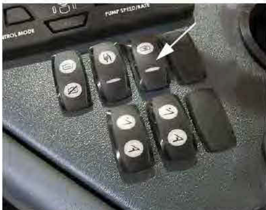
Commutateur de la vanne de brassage (situé sur la console latérale) - Vue typique
