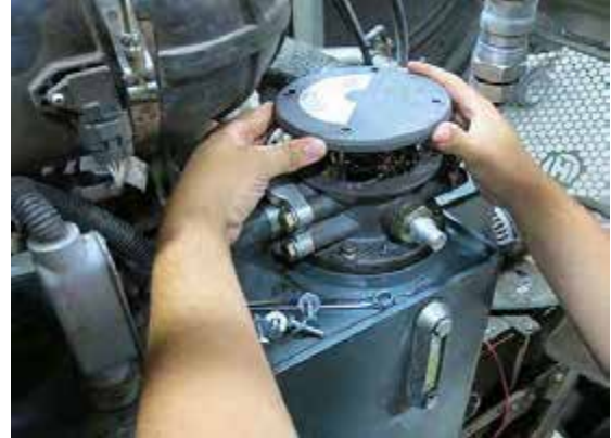
Remplissage du réservoir par le haut du boîtier du filtre de retour hydraulique - Vue typique
