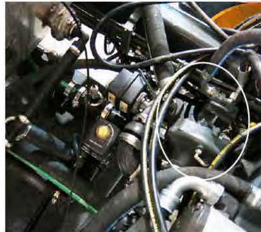
Pompe à solution (située dans la partie centrale de la machine) - Vue typique
