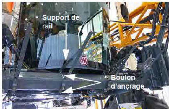
Ensemble du rail central du pare-broussailles - Vue typique
