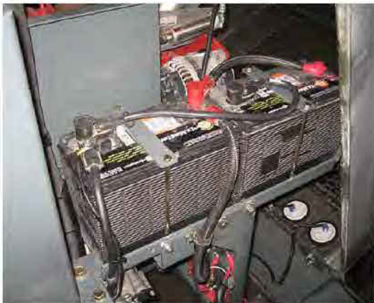
Accès à la batterie (située dans la partie arrière gauche De la machine - ouvrez le capot pour y accéder) - Vue typique
