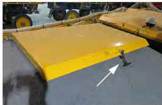
Loquet de sécurité (situé sur le côté du couvercle de la boîte sèche) - Vue typique
