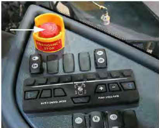
Bouton d'arrêt d'urgence (situé sur la console latérale) - Vue typique
