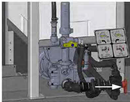
Vanne(s) de sélection des entrées (située(s) dans la partie en bas à droite du/ des réservoir(s) de produit(s) chimique(s)) - Vue typique
