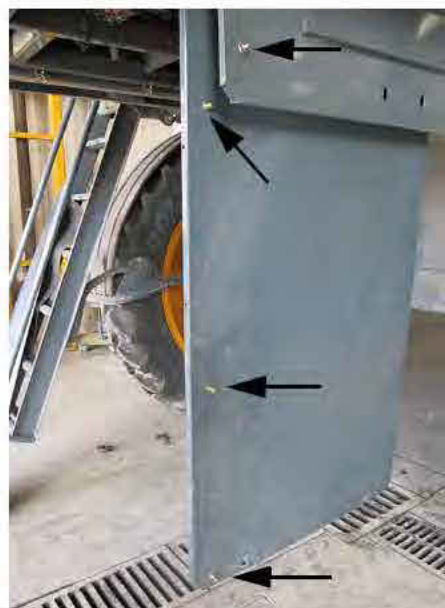
Goupilles percées (Installez trois goupilles percées sur panneau 4 et une goupille percée sur le panneau 5, comme illustré) - Vue typique
