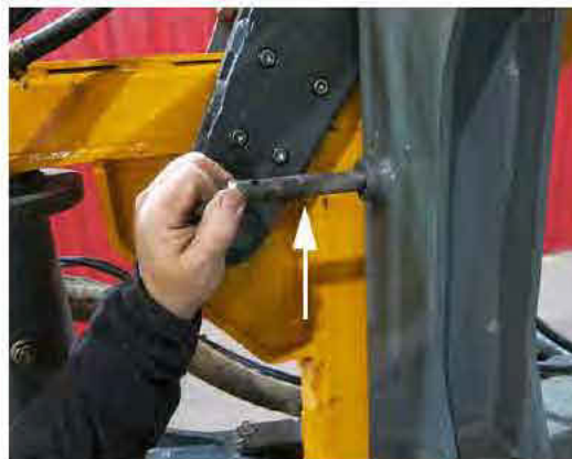
Boulon de fixation (situé sur la partie extérieure du châssis de la traverse) - Vue typique
