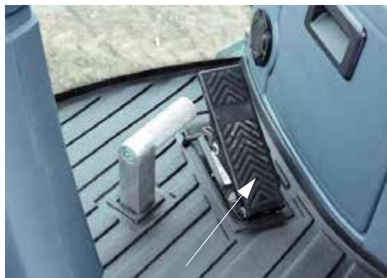
Педаль уменьшения скорости (расположена в правой нижней части рулевой колонки) - Стандартный вид
