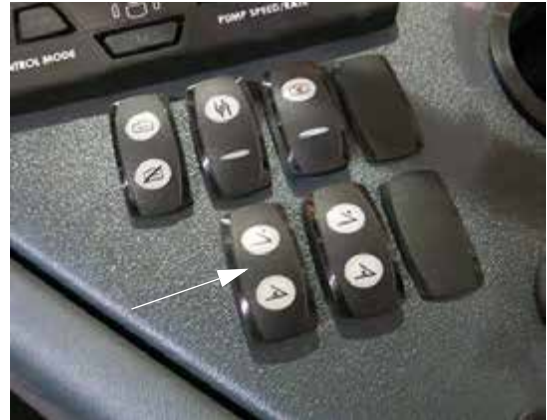
Переключатель выдвижения штанги * Штанги опрыскивателя дл. 90 футов (расположен на боковой панели) - стандартный вид
