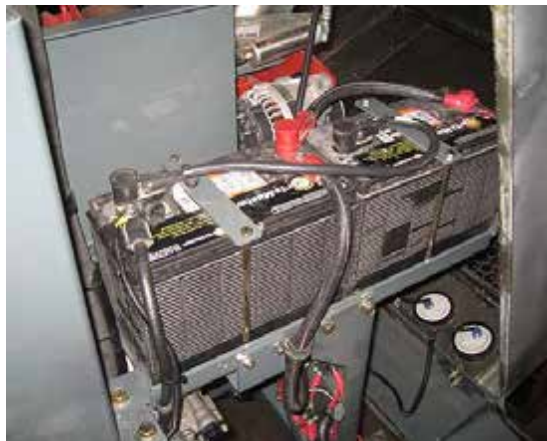
Доступ к батарее (расположена на левой стороне машины — для доступа откройте капот) - Стандартный вид
