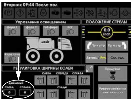
Левый/Правый индикаторы ширины колеи на задних опорах (на Странице вспомогательных органов управления дисплея машины)
