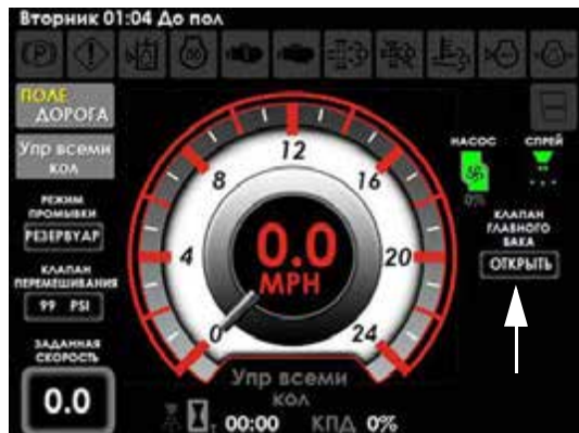
Индикатор состояния клапана главного бака (расположен на Главной странице дисплея машины - в Полевом режиме) - стандартный вид
