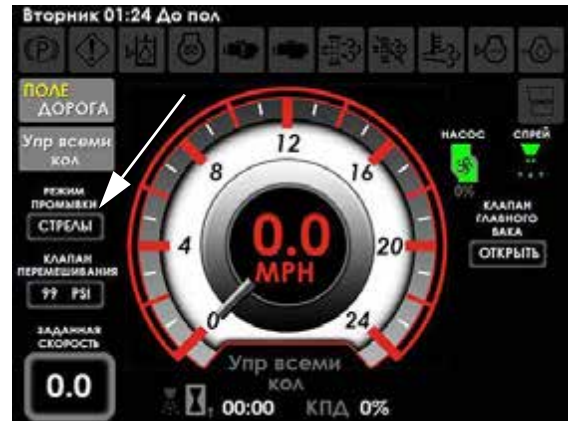
Индикатор режима промывки (расположен на Главной странице дисплея машины – в Полевом режиме)
