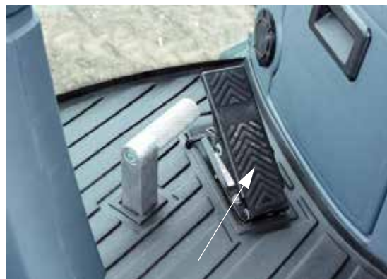
Педаль уменьшения скорости (расположена внизу справа от рулевой колонки) - стандартный вид
