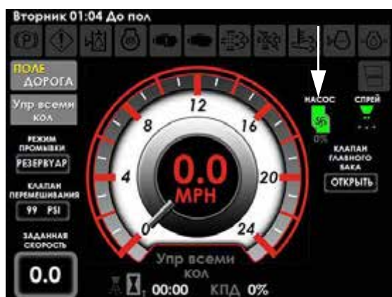
Индикатор насоса подачи раствора (расположен сверху справа Главной страницы дисплея машины - Полевой режим)
