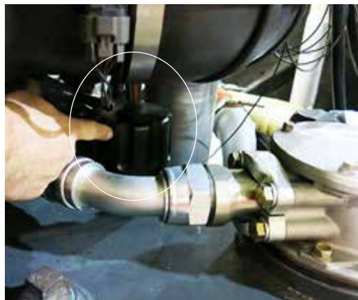
Крышка сапуна (расположена с левой стороны машины возле корпуса обратного фильтра) - стандартный вид
