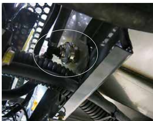
Струйная мешалка (расположена с каждого конца бака для раствора) - стандартный вид
