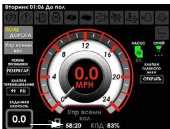
Индикатор классификации капель по размеру (расположен снизу на домашней странице - в Полевом режиме)
