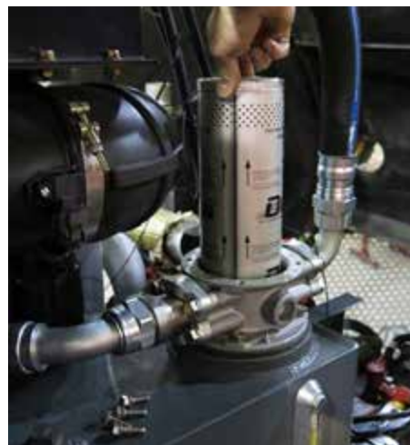
Обратный фильтр (расположен внутри корпуса фильтра на левой стороне машины) - стандартный вид
