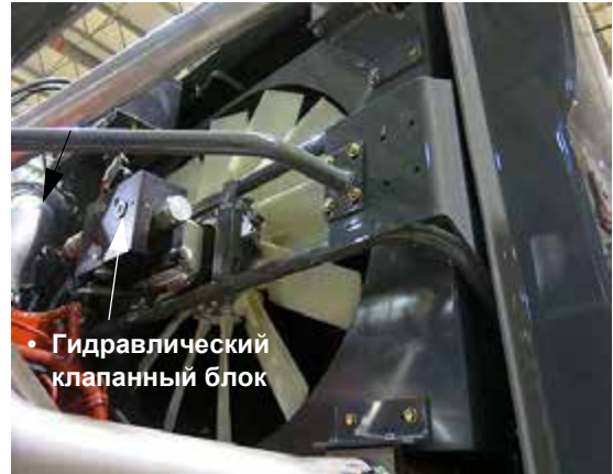
Реверсивный вентилятор (расположен в задней части машины, откройте капот для доступа) - стандартный вид
