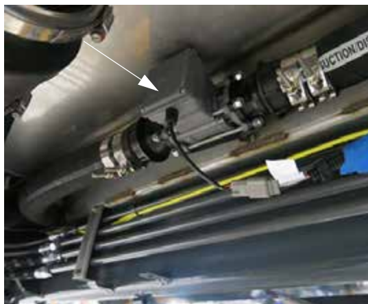
Расходомер (под правой стороной машины) - стандартный вид
