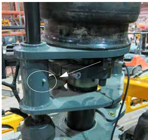
Масленка Зерка опорного подшипника (расположена на передней и задней опорах) - стандартный вид
