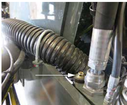
Монтажные болты (2) – Передний/Задний (расположены на монтажном кронштейне шлангового соединения правой траверсы) - стандартный вид * Показан задний болт
