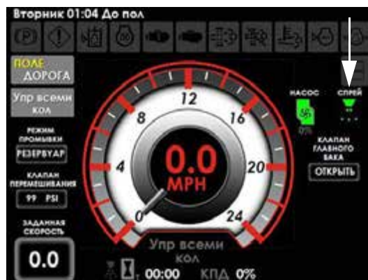
Главный индикатор опрыскивателя (расположен на Главной странице дисплея машины – в Полевом режиме) - стандартный вид
