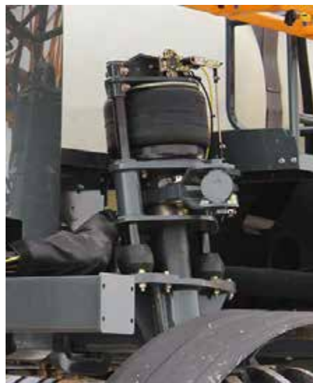
Пневмоподушка (на каждой опоре) - стандартный вид
