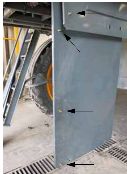
Подвесные штифты (поставьте три штифта на Панель 4 и один штифт на Панель 5, как показано на рис.) - стандартный вид
