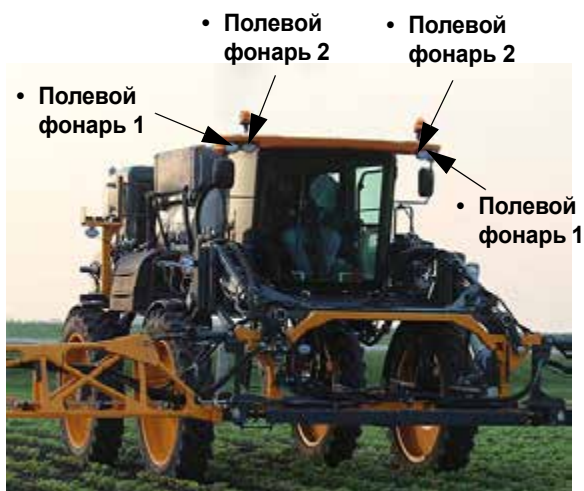
Полевые фары (расположены спереди кабины) - Стандартный вид
