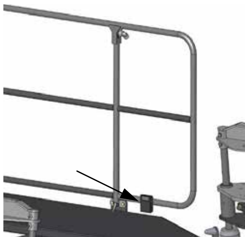
Ножная педаль рукомыльника (расположена слева вдоль нижнего поручня) - стандартный вид
