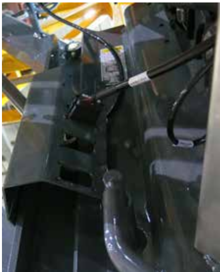
Штуцер NORAC - если установлен (расположен спереди на правой стороне машины) - стандартный вид
