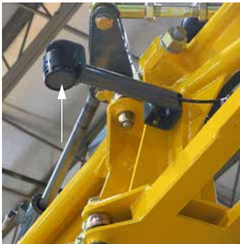
Прокладка из пеноматериала для датчика NORAC (расположена снизу каждого датчика) - стандартный вид
