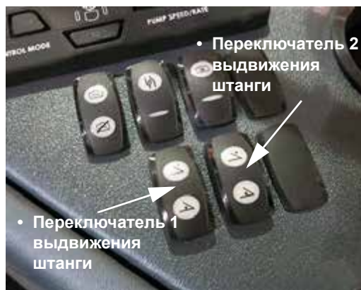
Переключатели выдвижения штанг (расположенные на боковой панели) - Стандартный вид
