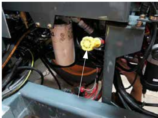
Дистанционная заливка моторного масла (с левой стороны машины - откройте капот для доступа) - стандартный вид
