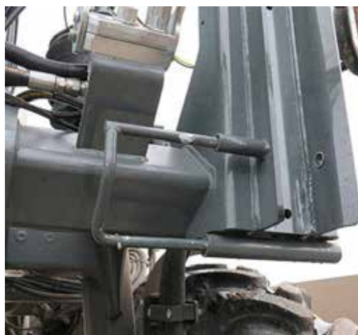
Стопорный штифт (расположен спереди левого и правого бока машины) - стандартный вид
