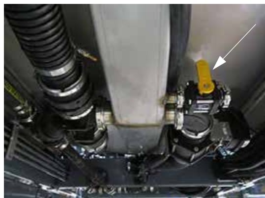
Спускной клапан бака для раствора (расположен под баком для раствора снизу машины) - стандартный вид
