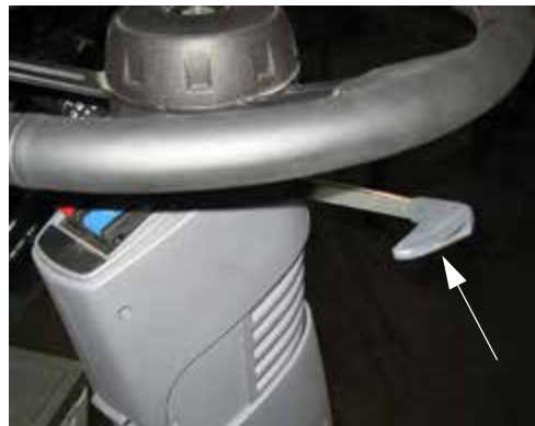
Рукоятка регулировки телескопического рулевого колеса (находящаяся справа на рулевой колонке) - Стандартный вид
