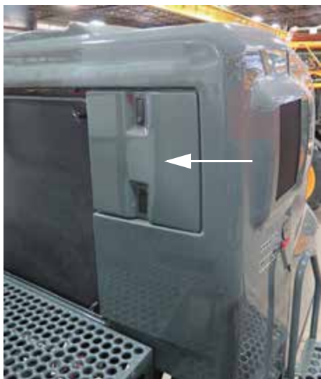
Панель доступа к фильтру впуска воздуха в двигатель (расположена на левой стороне капота) - стандартный вид
