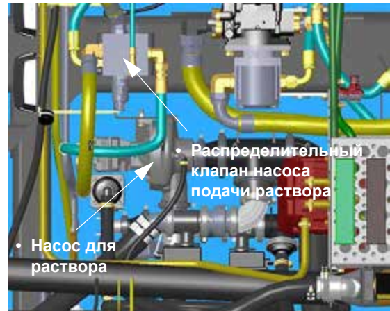
Насос для раствора и распределительный клапан насоса подачи раствора (расположены рядом с центром машины) - стандартный вид
