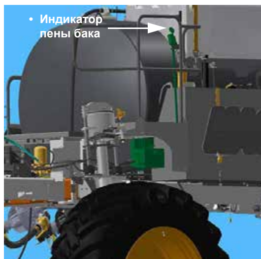
Заправочное отверстие бака индикатора пены (расположено на заднем правом поручне) - стандартный вид
