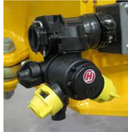
Корпус форсунки (располагаются по всей штанге) - стандартный вид
