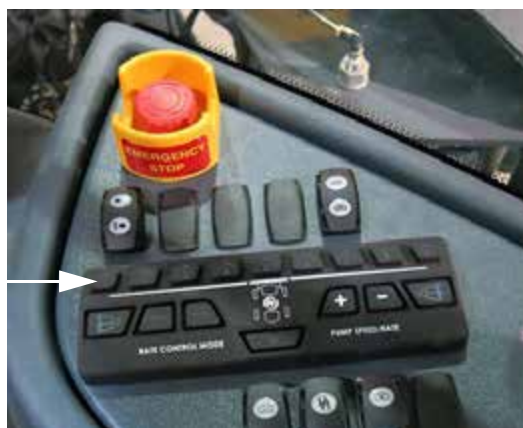
Переключатели клапана подачи раствора в штангу (расположены на боковой панели) - стандартный вид
