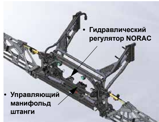
Управляющий manifold штанги и гидравлический регулятор NORAC (расположен около центра внутренней перекладины) - стандартный вид
