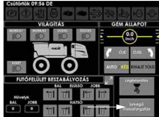
Változtatható forgásirányú ventilátor gomb (a Segédvezérlések oldalán)
