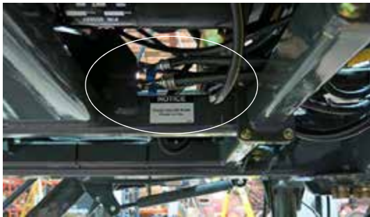
Klíma töltő nyílások (a fő alváz közepének aljánál helyezkedik el) – Tipikus nézet
