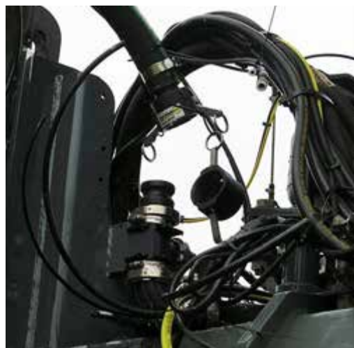
Permetezőszerszám vezetékek csatlakoztatása (a gép elülső jobb oldalánál helyezkedik el) – Tipikus nézet
