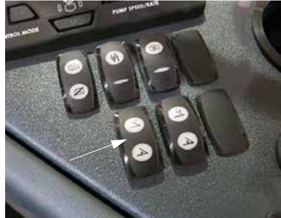
Gém toldalék kapcsoló * 90 láb permetező géme (oldalsó vezérlőpulton) – Tipikus nézet
