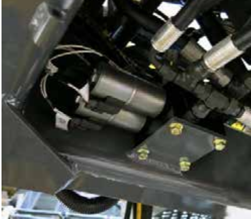
Elosztószelep (a gép alján) – Tipikus nézet
