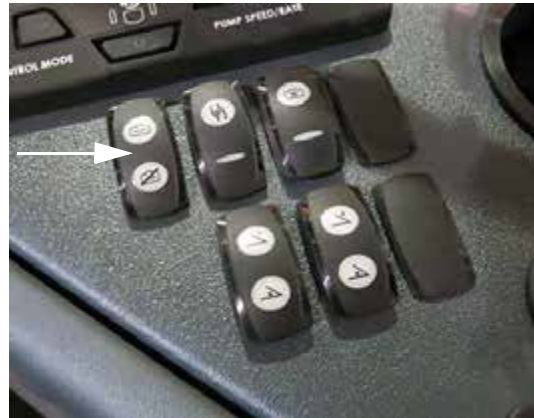
Főtartály szelep kapcsolója (oldalsó vezérlőpulton) – Tipikus nézet
