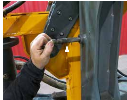
Szerelőcsavar (a támasztómű keret külső oldalánál helyezkedik el) – Tipikus nézet
