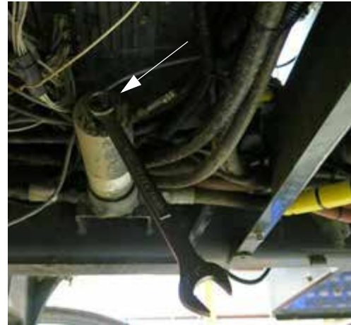
Nyomó vezeték szűrő háza (a gép jobb oldala alatt - a fém lemez levételével férhet hozzá) – Tipikus nézet
