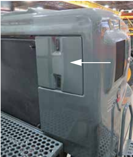
Motor Levegőbeszívó hozzáférést biztosító burkolat (A motorháztető bal oldalánál van elhelyezve) – Tipikus nézet
