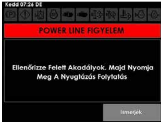
Elektromos vezeték figyelmeztető üzenet (munkagép képernyőjén található)
