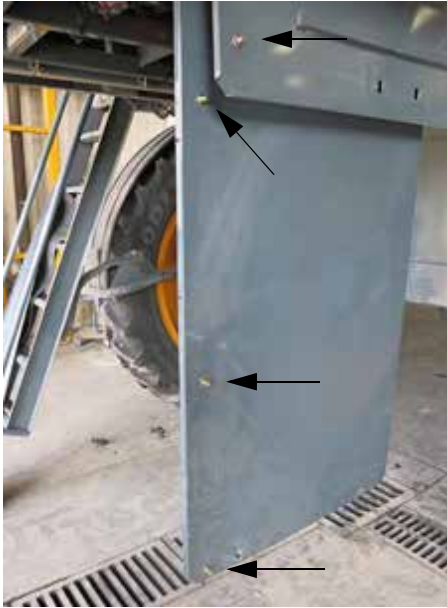
Függő csapok (Helyezzen el három csapot a 4. burkoló- lemezre, és egyet pedig az 5. burkoló- lemezre, ahogy az az ábrán látható) – Tipikus nézet
