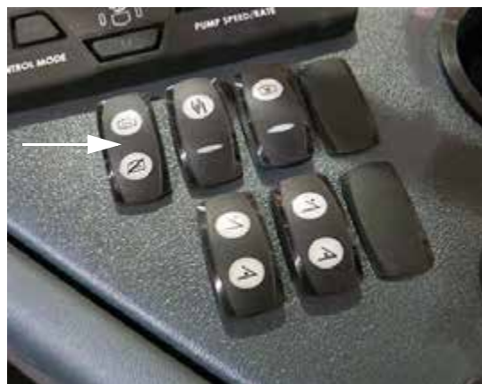
Főtartály szelep kapcsolója (oldalsó vezérlőpulton) – Tipikus nézet
