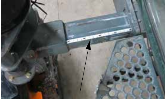
Nyomtáv beállítás jelzőmatrica (Első lábak) - Tipikus nézet
