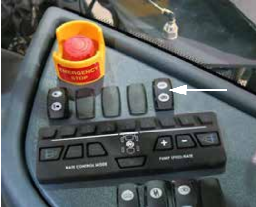
Permetlé szivattyú kapcsoló (oldalsó vezérlőpult) – Tipikus nézet
