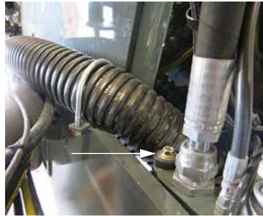
Szerelőcsavarok (2) - első/hátsó (a jobb oldali keresztartó tömlő összeszerelés-szerelő konzolján található) – Tipikus nézet *A hátsó csavar látható
