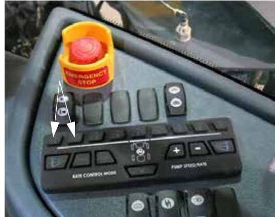
Gép permetlé szelep kapcsolók - 1-es és 2-es (az oldalkonzolon található) - Tipikus nézet
