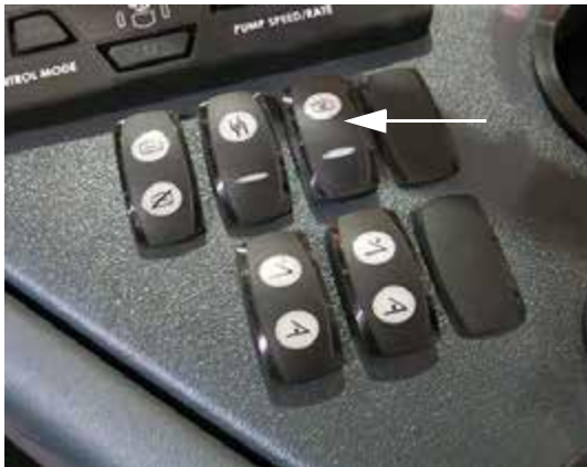
Keverőszelep kapcsoló (oldalsó vezérlőpulton) – Tipikus nézet
