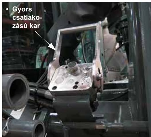
Hidraulikus/elektromos multi-csatlakozó összeszerelés – ha fel van szerelve (a gép elülső, bal oldalánál helyezkedik el)
