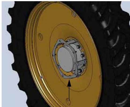
Kerékagy lemezsapkát rögzítő szerelvénylemez – Tipikus nézet
