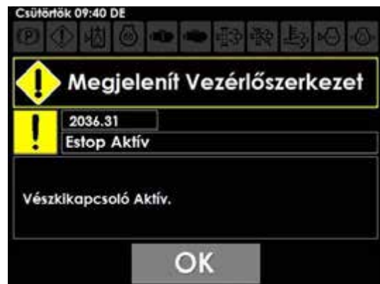
Vészleállítás aktív üzenete (a gép képernyőjén található)
