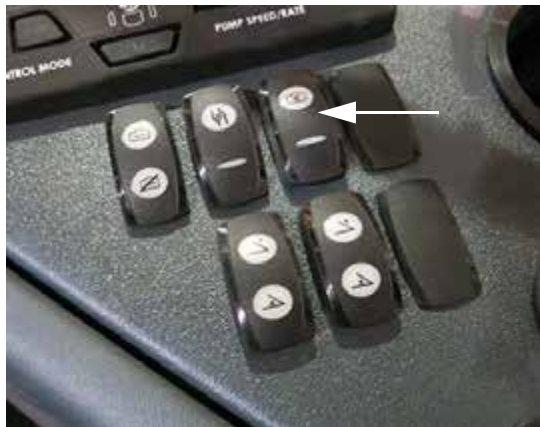
Keverőszelep kapcsolója (oldalsó vezérlőpulton) – Tipikus nézet
