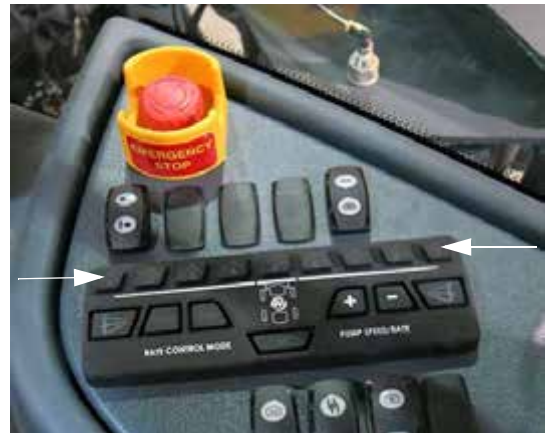
Gém permetlé szelep kapcsolók - 1-es, és 9-es szakasz (oldalkonzolon) - Tipikus nézet
