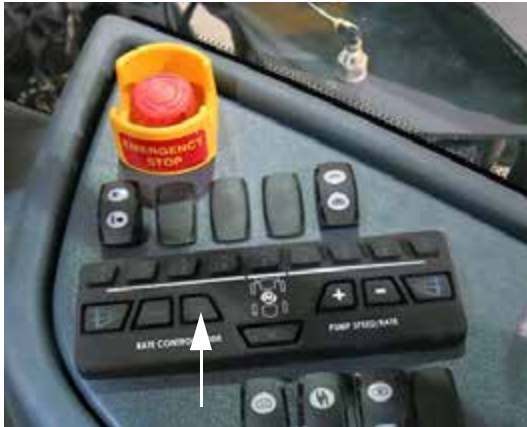
Kézi „MAN” arány szabályzó kapcsoló (oldalsó vezérlőpulton) – Tipikus nézet
