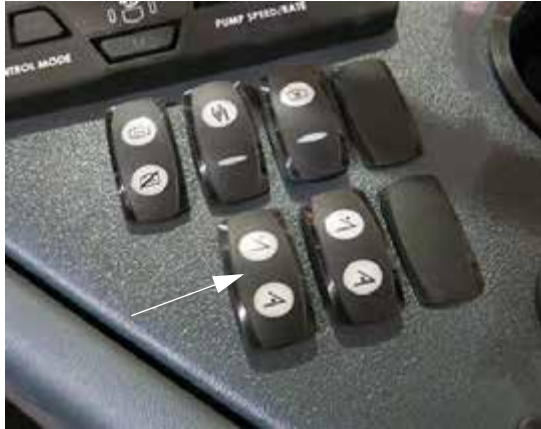
Gém toldalék kapcsoló * 90 láb permetező gémek (oldalsó vezérlőpulton) – Tipikus nézet
