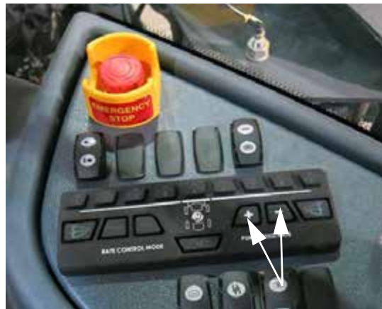
Szivattyú sebesség/Arány kapcsolók (oldalsó vezérlőpulton) – Tipikus nézet
