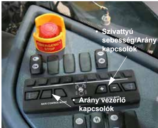
Arány szabályozó, és szivattyú sebesség/arány kapcsolók (a vezérlőpult oldalán helyezkedik el) – Tipikus nézet
