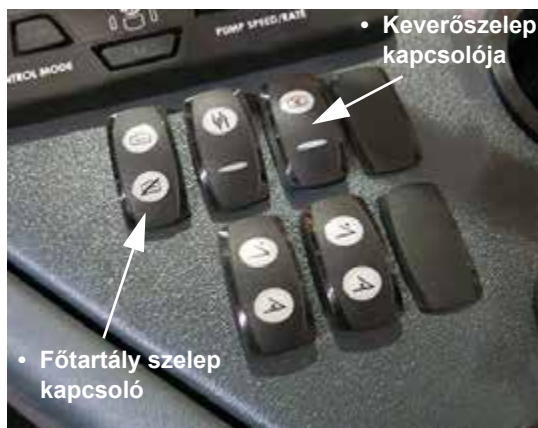
Főtartály és keverőszelep kapcsolók (oldalkonzolon) – Tipikus nézet
