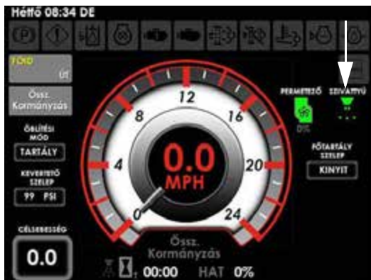
Elsődleges permetező kijelző (a gépezet kijelzőjének kezdő oldalán a felső jobb kéz felőli oldalt – Mezei üzemmód)
