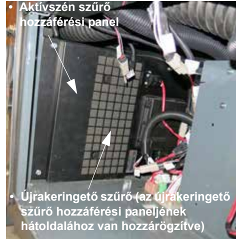
Aktívszén szűrő hozzáférési panel (a vezetőfülke jobb oldalán, a külső szerviz panel mögött helyezkedik el) – Tipikus nézet
