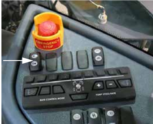
Habjelölő kapcsolója (az oldalkonzolon található) - Tipikus nézet
