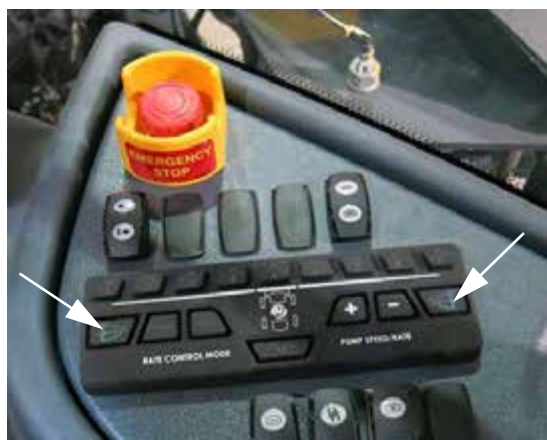
Kerítéssor kapcsolók (oldalsó vezérlőpulton) – Tipikus nézet
