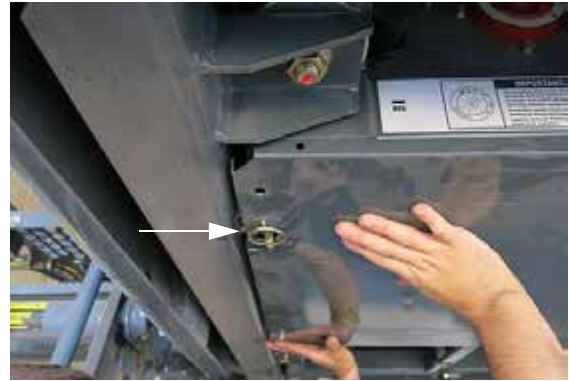
Biztonsági rögzítőcsap (a függő csapba elhelyezve) – Tipikus nézet
