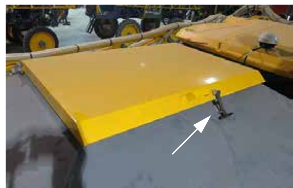
Biztonsági retesz (a száraz tartály fedélénél helyezkedik el) - Tipikus nézet
