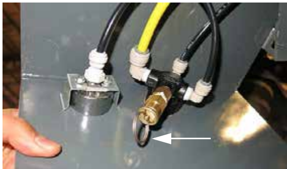
Nyomás csökkentő húzó gyűrű (A hab nyomás szabályozó hátsó oldalán) - Tipikus nézet
