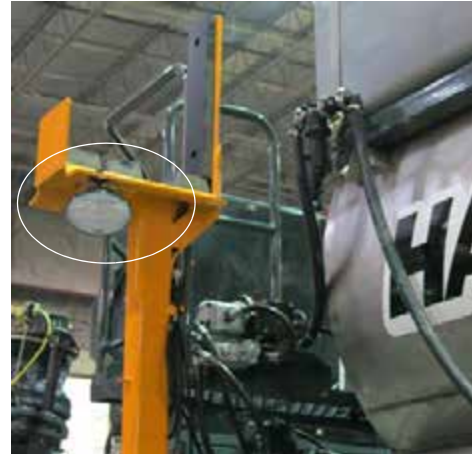
Munkalámpák (a fülke mindkét oldalán) – Tipikus nézet
