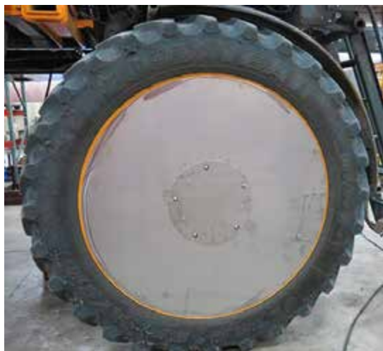
Kerék fedlemez telepítés – Tipikus nézet
