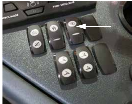
Öblítés kapcsoló (oldalsó vezérlőpult) – Tipikus nézet
