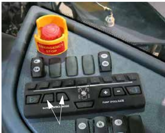
Mérték szabályzó kapcsolók (oldalsó vezérlőpulton) – Tipikus nézet
