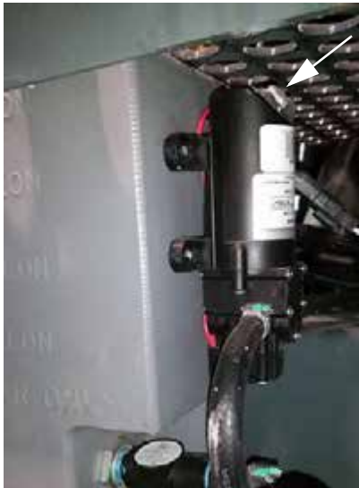
Kézmosó szivattyú hálózati kapcsoló (A szivattyú tetején helyezkedik el) – Tipikus nézet
