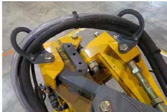
Gémtömlő rögzítő telepítés - Tipikus nézet
