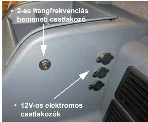
12V-os elektromos csatlakozók és 2-es hangfrekvenciás bemeneti csatlakozó (az oldalkonzol belső borításán) – Tipikus nézet
