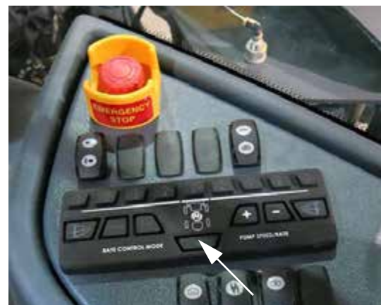
Hátsó fúvóka kapcsoló (oldalsó vezérlőpulton) – Tipikus nézet
