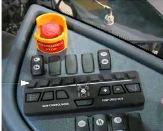
Gémpertelé szelep kapcsolók (oldalsó vezérlőpulton) – Tipikus nézet
