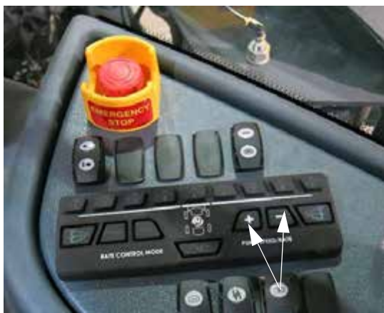
Szivattyú sebesség/Arány kapcsolók (oldalsó vezérlőpulton) –Tipikus nézet
