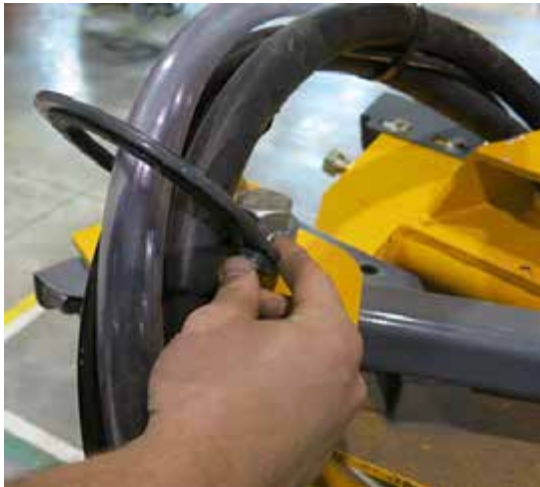
Gémtömlő rögzítő - Tipikus nézet
