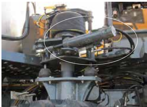
Kormány munkahenger (a hátsó lábakon) – Tipikus nézet
