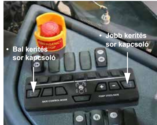
Kerítéssor kapcsolók – Bal és jobb (oldalsó vezérlőpulton) – Tipikus nézet
