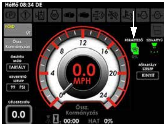
Permetlé szivattyú kijelző (a gépezet kijelzőjének kezdő oldalán a felső, jobb kéz felőli oldalt – Mezei üzemmód)
