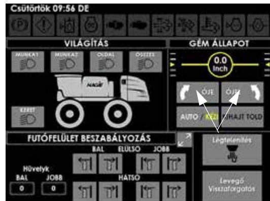
Behajtás/forgatás vezérlő gombok (CW/CCW) (jobb kéz felőli Segédvezérlések oldalán)
