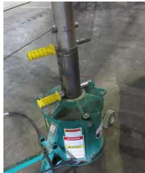
Rögzítő csapszeg elhelyezése – Tipikus nézet
