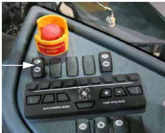
Habjelölő kapcsolója (oldalsó vezérlőpulton) – Tipikus nézet
