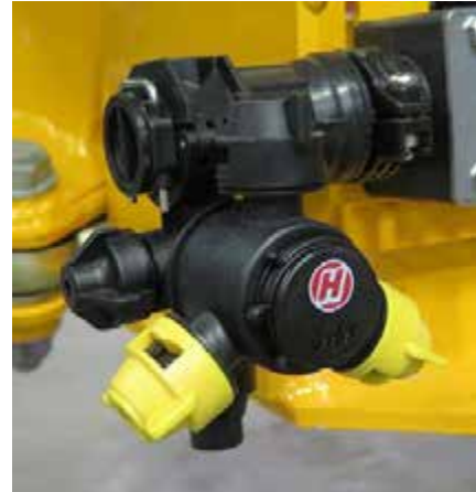
Szeleptest (A gém mentén helyezkednek el) – Tipikus nézet
