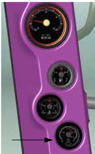
DEF műszer (a fülke a oszlopán) - Tipikus nézet
