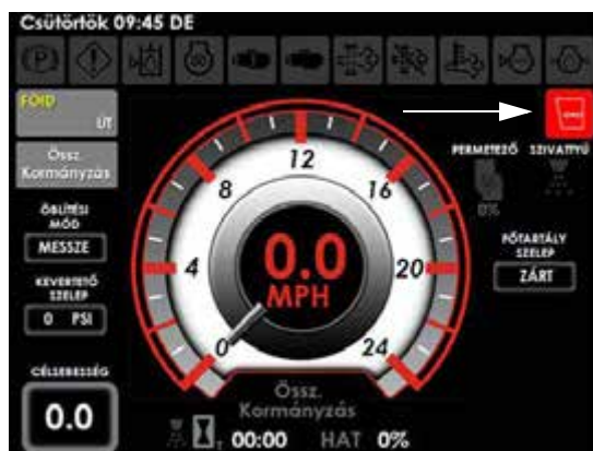
Fülke légnyomása nem elegendő (a Munkagép Képernyőjének Kedőoldalán- Közúti és Mezei üzemmód)
