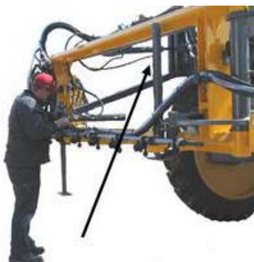
Gém állvány szállítási pozícióban – Tipikus nézet
