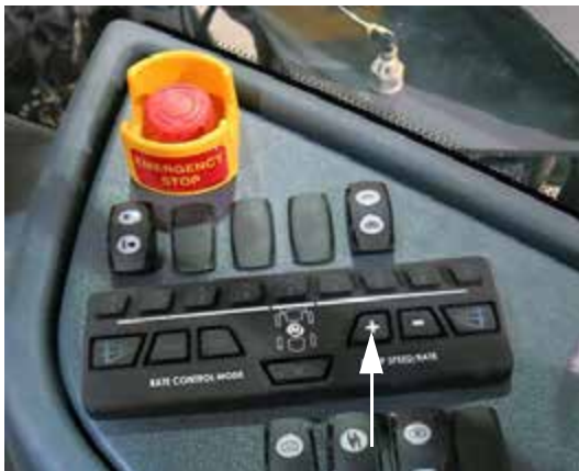
„+” szivattyú sebesség/arány kapcsoló (oldalsó vezérlőpulton) – Tipikus nézet
