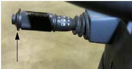
Ablakmosó kapcsoló (az irányjelző kapcsolókar végén) – Tipikus nézet
