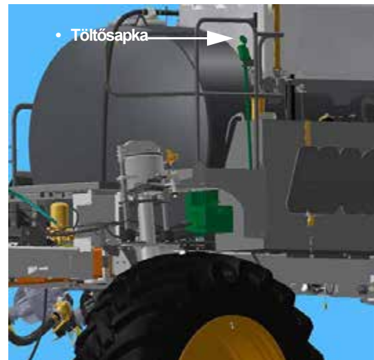
Habzás jelző tartály töltő (a hátsó jobb oldali korláton található) - Tipikus nézet
