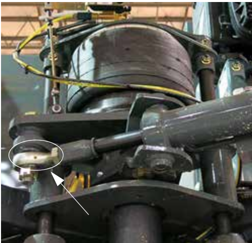
Kormány összekötő rúd gömbcsukló Zerk zsír (az első lábknál található) – Tipikus nézet
