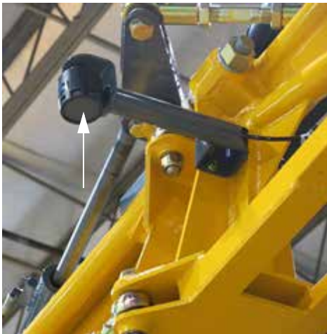
NORAC érzékelő habszivacs (az egyes érzékelők alatt van elhelyezve) – Tipikus nézet
