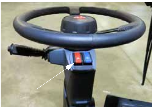
Vészjelző/figyelmeztető fények kapcsoló (a kormányoszlopon) – Tipikus nézet
