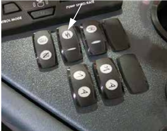
Permetlé szivattyú kapcsoló (oldalsó vezérlőpulton) – Tipikus nézet
