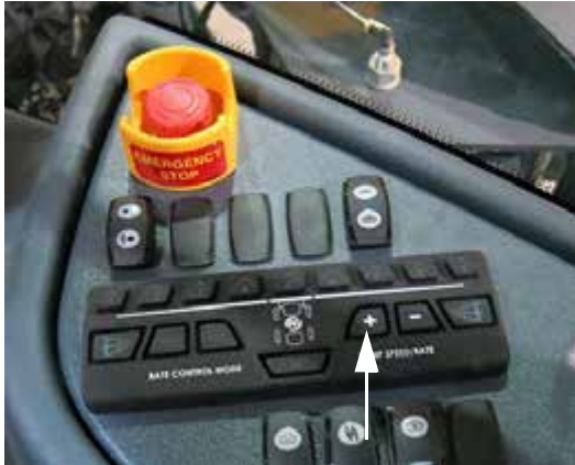
„+” szivattyú sebesség/arány kapcsoló (oldalsó vezérlőpulton) – Tipikus nézet
