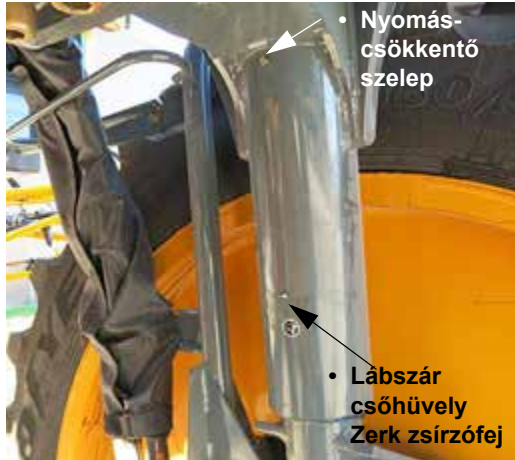
Lábszár csőhüvely Zerk zsír és nyomáscsökkentő szelep (elülső és hátsó lábszárakon) – Tipikus nézet
