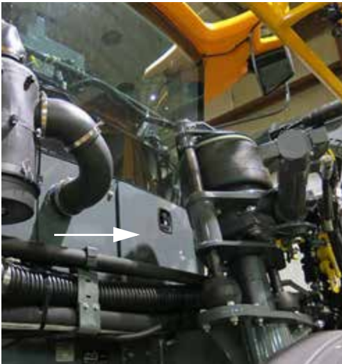
Külső szerviz panel (a vezetőfülke jobb oldalán helyezkedik el) – Tipikus nézet
