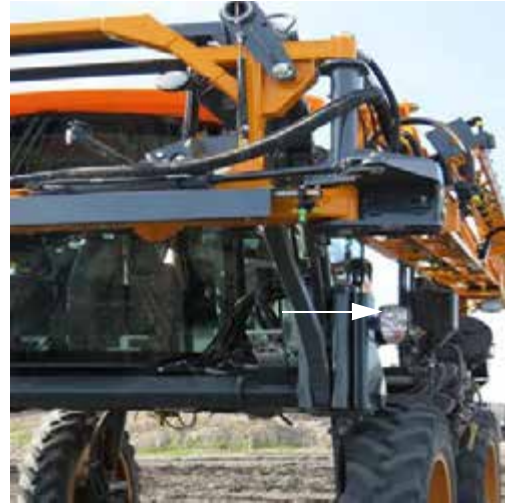
Közúti fényszórók (a fülke mindkét oldalán) – Tipikus nézet
