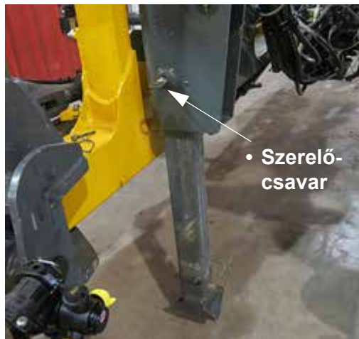
Gém állvány (kihajtott pozíciót mutatja) – Tipikus nézet
