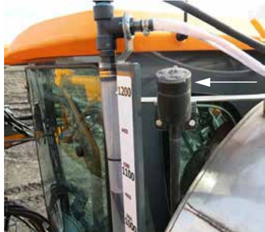
Szélvédő mosó folyadék tartály (a vezetőfülke mögött, bal kéz felől helyezkedik el) – Tipikus nézet
