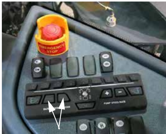
Mérték szabályzó kapcsolók (oldalsó vezérlőpulton) – Tipikus nézet
