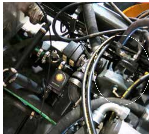
Permetlé szivattyú (közel a gépezet közepéhez) – Tipikus nézet * A berendezés felülnézete
