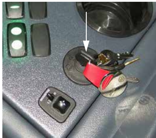
Gyújtás kapcsoló (oldalsó vezérlőpulton) – Tipikus nézet
