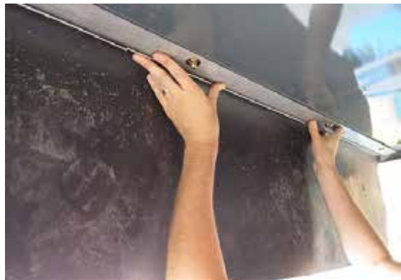
Súrolásvédelmi gumifüggöny telepítés – Tipikus nézet
