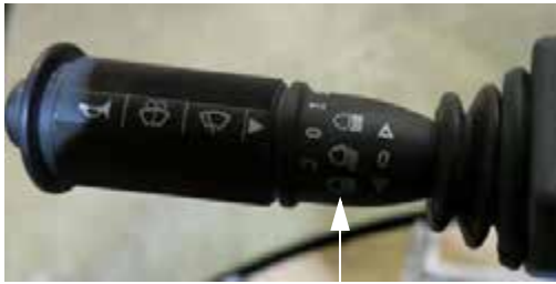
Reflektor (az irányjelző kapcsolón) – Tipikus nézet
