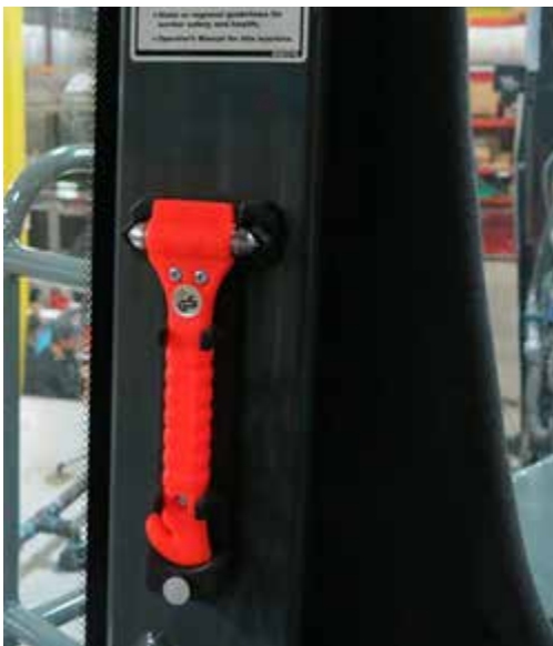
Vészhelyzeti üvegtörő eszköz (a fülke hátsó jobb oldalán) –Tipikus nézet
