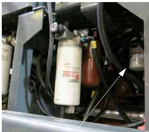
Motorolajsűrő (A gép bal-kéz felőli oldala mentén - hozzáféréshez nyissa fel a motorháztetőt) – Tipikus nézet
