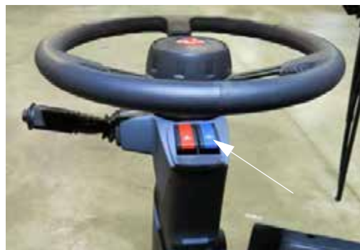
Közúti fényszórók kapcsoló (a kormányoszlopon) – Tipikus nézet
