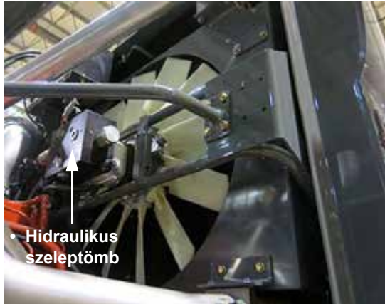
Változtatható irányú ventilátor (a gép hátulja közelében – a motorháztető kinyitásával férhet hozzá) – Tipikus nézet
