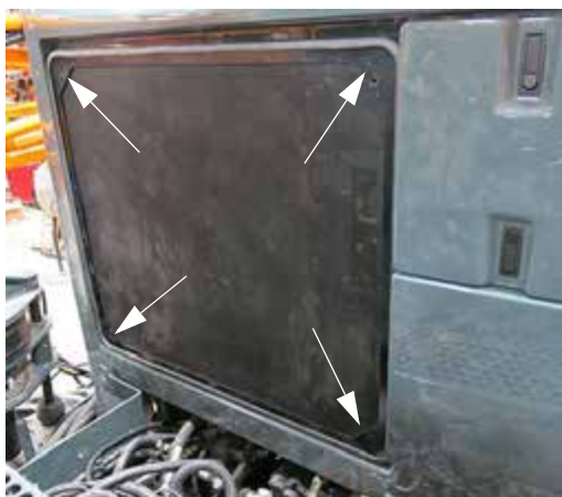
Radiátor üveg reteszek (az üveg négy sarkánál helyezkednek el) – Tipikus nézet
