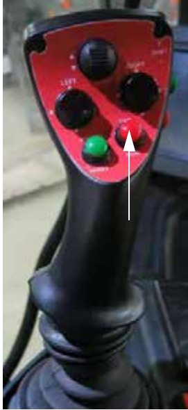
Sorvég kezelés kapcsoló (a hidrosztatikus vezérlést irányító karon) – Tipikus nézet
