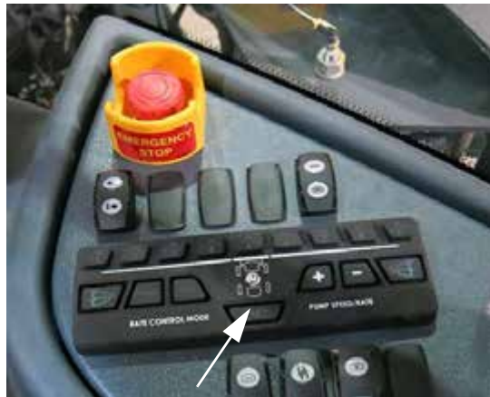
Hátsó fúvóka kapcsolója (oldalsó vezérlőpulton) – Tipikus nézet
