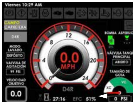
Grado de eficiencia (EFF) (ubicado en la página principal - modo de campo)
