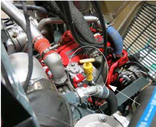
Varilla de nivel de aceite del motor (situada en el lado izquierdo del motor - abra el capó para acceder) -Vista típica
