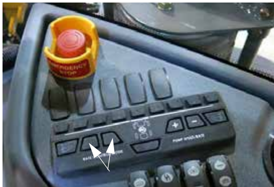
Interruptores de control de tasa (ubicados en la consola lateral) -Vista típica
