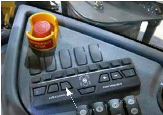
El interruptor de control de tasa “MAN” (ubicado en la consola lateral) -Vista típica
