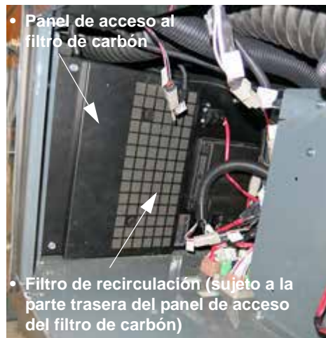
Panel de acceso al filtro de carbón (ubicado detrás del panel de servicio exterior en el lado derecho de la cabina) -Vista típica
