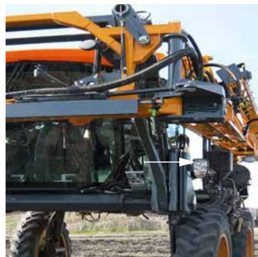
Luces de manejo/carretera (ubicadas en cada lado de la cabina) -Vista típica
