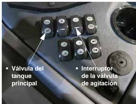
Interruptores del tanque principal y las válvulas de agitación (ubicados en la consola lateral) -Vista típica
