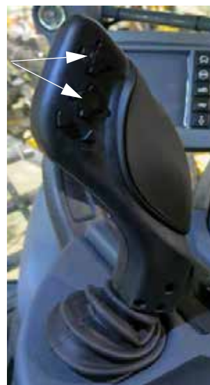
Interruptores de los brazos izquierdo y derecho (ubicados en la manilla de control de la transmisión hidrostática) -Vista típica
