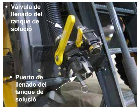
Conjunto de llenado (ubicado detrás de la rueda trasera izquierda) -Vista típica
