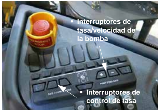
Interruptores de control de tasa de tasa/velocidad de la bomba (ubicados en la consola lateral) -Vista típica
