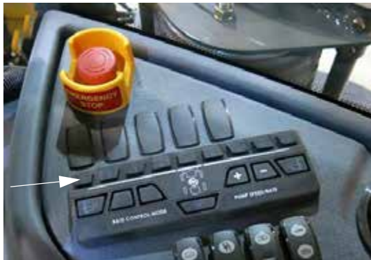
Interruptores de la válvula de solución del brazo (ubicados en la consola lateral) -Vista típica
