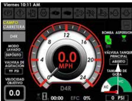
Indicador de estado de la bomba de solución (ubicado en el lado derecho de la página de inicio de la pantalla de la máquina - modo de campo)
