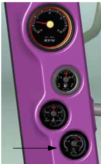
Medidor DEF (ubicado en el poste A de la cabina) - Vista típica
