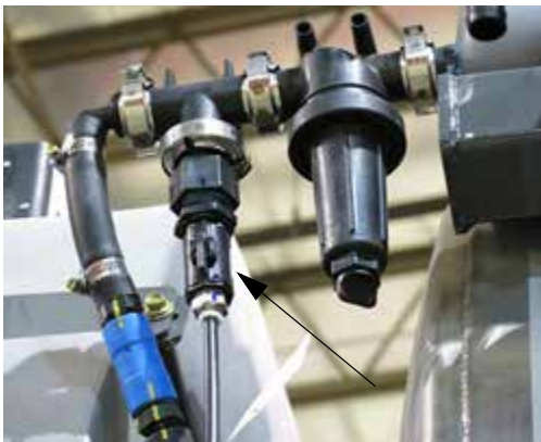
Válvula del marcador de espuma (situada cerca de la parte posterior del tanque de lavado) -Vista típica
