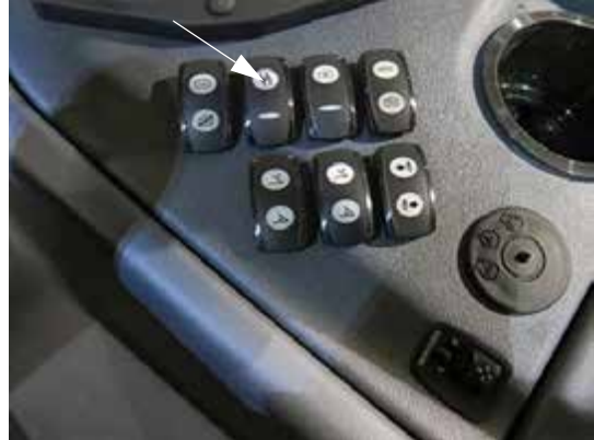
Interruptor de la bomba de la mezcla (ubicado en el lateral de la consola lateral) -Vista típica
