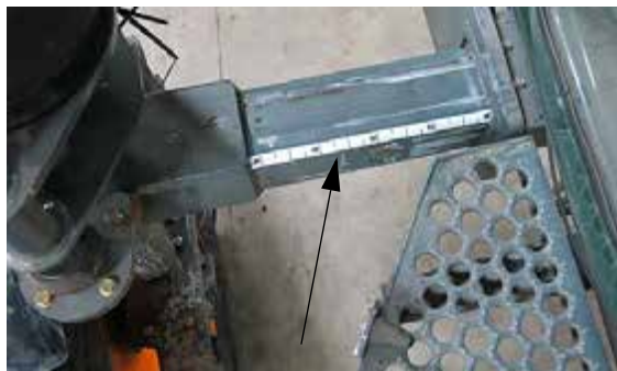
Calcomanía indicadora del ajuste de la distancia entre neumáticos (patas delanteras) -Vista típica
