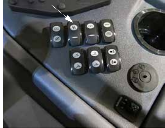
Interruptor de la bomba de solución (ubicado en la consola lateral) -Vista típica
