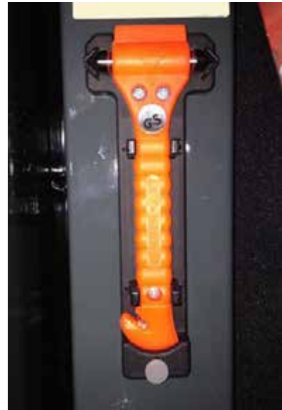
Herramienta de salida de emergencia (ubicada en la parte trasera derecha de la cabina) -Vista típica
