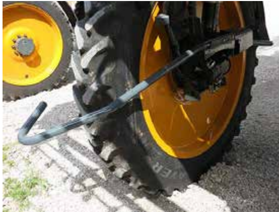
Divisor de cultivos instalado -Vista típica
