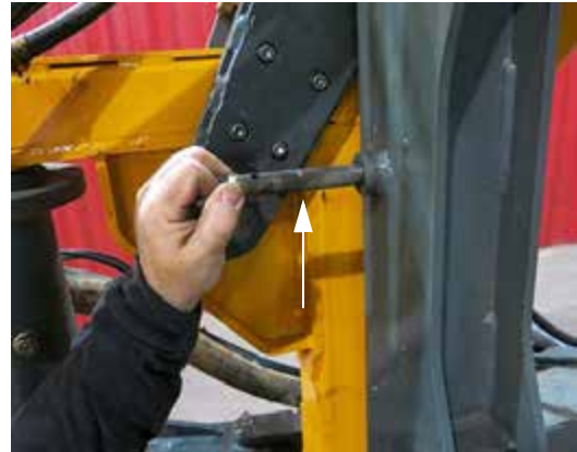
Perno de montaje (ubicado en el lado exterior del marco del travesaño) -Vista típica
