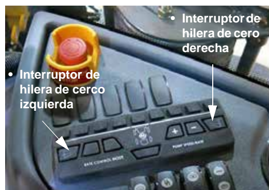
Interruptores de hilera de cerco - derecha e izquierda (ubicado en la consola lateral) -Vista típica
