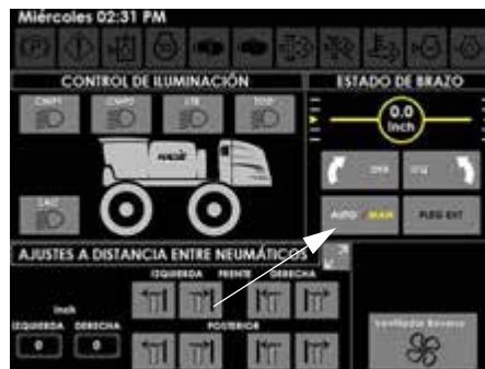
Botón de estado del brazo: Automático/Manual (ubicado en la página de controles auxiliares de la pantalla de la máquina)
