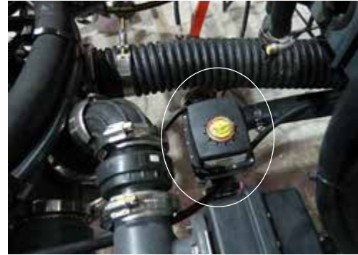
Válvula de agitación (ubicada cerca del centro de la máquina) -Vista típica * Vista mostrada desde la parte superior de la máquina
