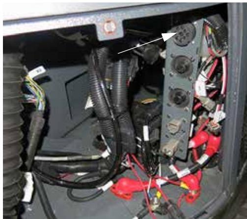
Puerto de diagnóstico del motor (ubicado dentro de la consola lateral, retire el panel frontal para su acceso) -Vista típica
