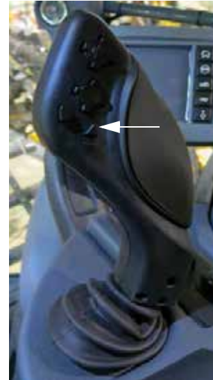
Interruptor del travesaño – ARRIBA (ubicado en la manilla de control de la transmisión hidrostática) -Vista típica
