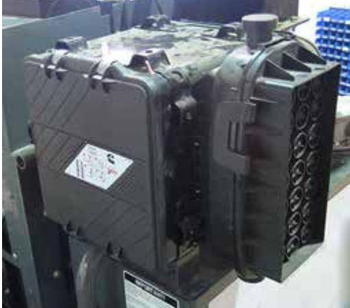
Filtro de admisión de aire del motor (situado a lo largo de la pasarela del lado izquierdo de la máquina - abra el capó para acceder) -Vista típica
