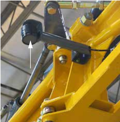
Cojín de hule espuma del sensor NORAC (ubicado debajo de cada sensor) -Vista típica
