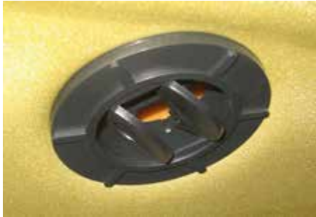
Conducto de ventilación de cabina -Vista típica
