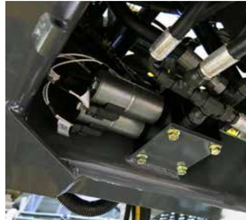
Colector de válvulas (ubicado en la parte inferior de la máquina) -Vista típica
