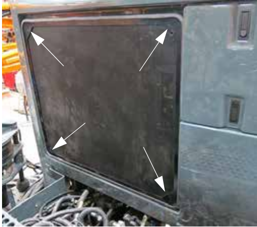
Pestillos de la rejilla del radiador (ubicados en cada esquina de la rejilla) -Vista típica
