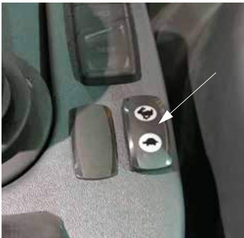
Interruptor del acelerador (ubicado cerca de la manilla del control de la transmisión hidrostática) -Vista típica
