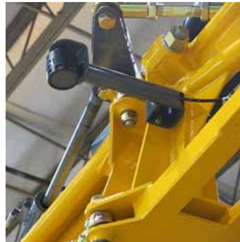
Sensor Norac -Vista típica
