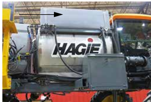
Tanque de lavado -Vista típica
