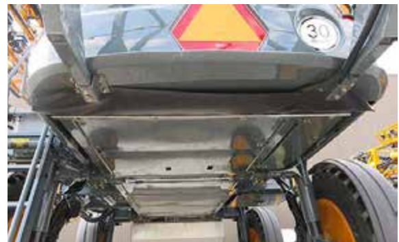
Instalación del panel de protección inferior y la cortina de maleza -Vista típica
