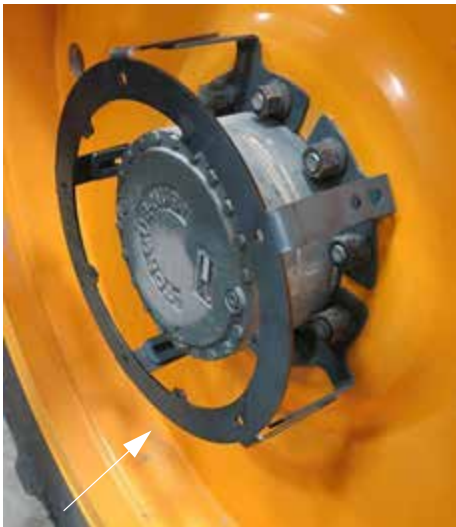
Conjunto soldado del tapacubos -Vista típica
