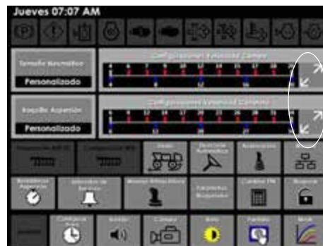
Botones de ajuste – configuraciones de velocidad de campo/carretera (ubicado en la página de ajustes)
