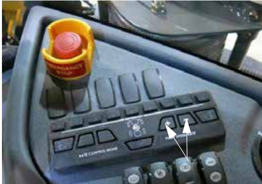
Interruptores de velocidad/flujo (ubicados en la consola lateral) -Vista lateral
