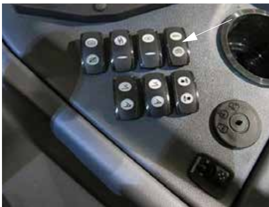
Interruptor de enjuague (ubicado en la consola lateral) -Vista típica
