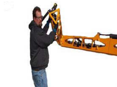
Perno de fijación (ubicado en la parte trasera del brazo) -Vista típica
