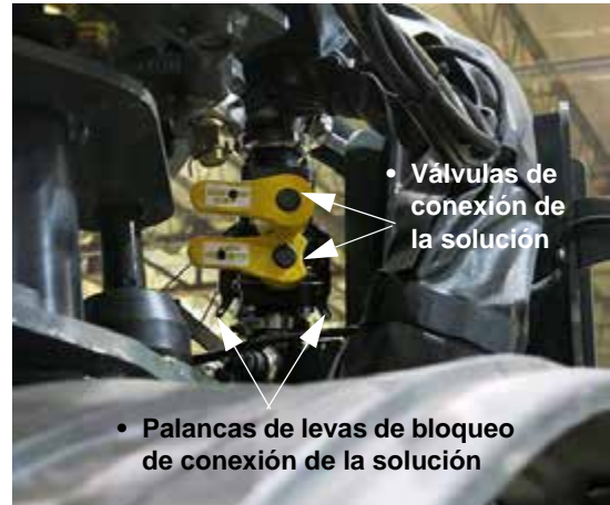
Válvulas de conexión de la solución y levas de bloqueo (ubicadas en el lado derecho delantero de la máquina) -Vista típica
