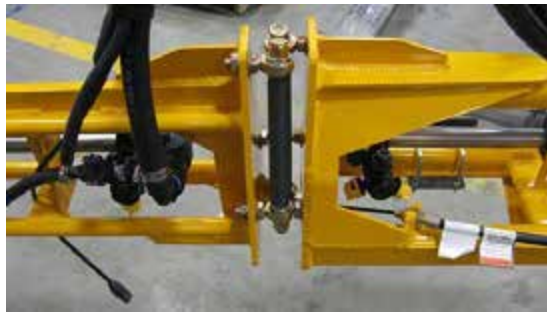
Desenganche exterior -Vista típica
