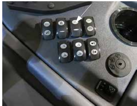
Interruptor de la válvula de agitación (ubicados en la consola lateral) -Vista típica
