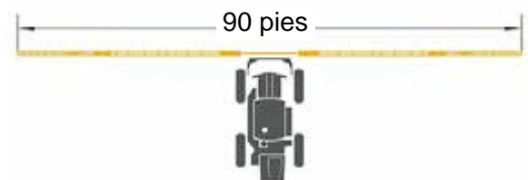
Sistema de 60/80/90 pies con todas las extensiones desplegadas
