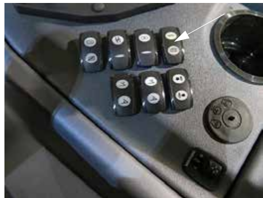
Interruptor de lavado (ubicado en la consola lateral) -Vista típica
