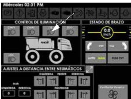
Botón de las luces de trabajo (ubicado en la página de controles auxiliares)
