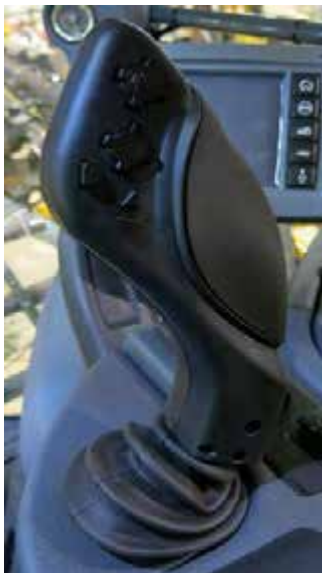
Manilla de control de la transmisión hidrostática (ubicada en la consola lateral) -Vista típica
