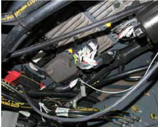
Interruptores automáticos/fusibles (exteriores) (ubicados debajo de la cabina; quite el panel para tener acceso) -Vista típica
