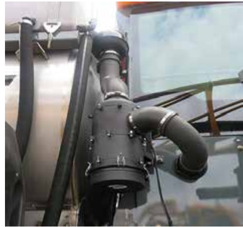
Sistema de filtrado de la cabina (ubicado al lado derecho del exterior de la cabina) -Vista típica
