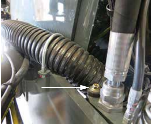
Pernos de montaje (2) – Delantero/trasero (ubicados en el soporte de montaje del conjunto de la manguera del travesaño del lado derecho) -Vista típica
