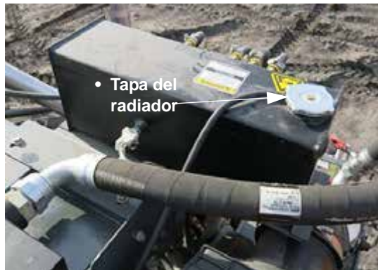
Radiador (ubicado cerca de la parte trasera de la máquina – abra el capó para tener acceso) -Vista típica
