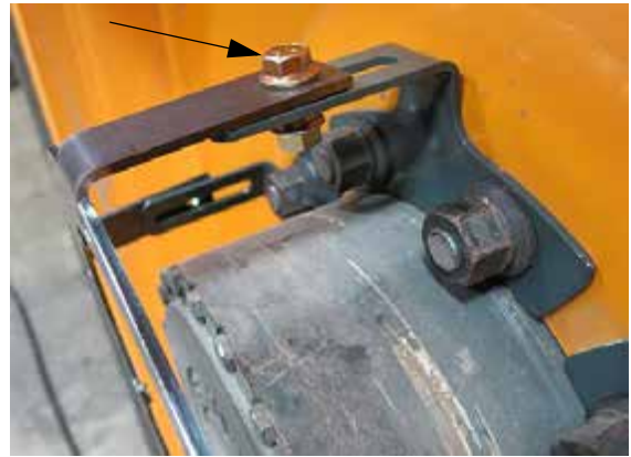
Instalación del perno del adaptador del tapacubos - Vista típica
