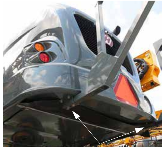
Cortina de maleza sujeta al capó -Vista típica
