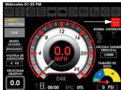
Indicador de presión de aire insuficiente en la cabina (ubicado en página principal de la pantalla de la máquina (modo de campo o carretera))
