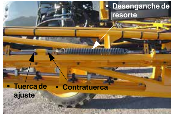
Tuercas de ajuste/contratuerca del desenganche de resorte (ubicadas cerca del lado exterior del desenganche de resorte) -Vista típica
