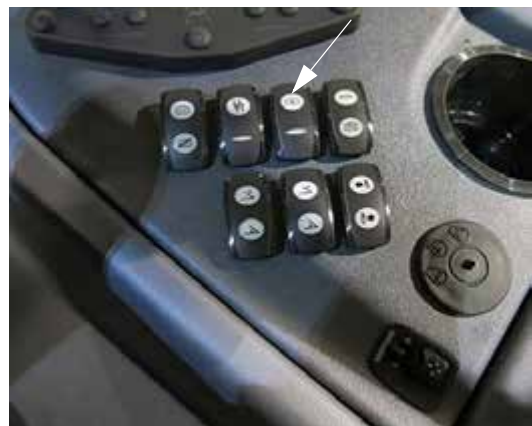
Interruptor de válvula de agitación (ubicado en la consola lateral) -Vista típica
