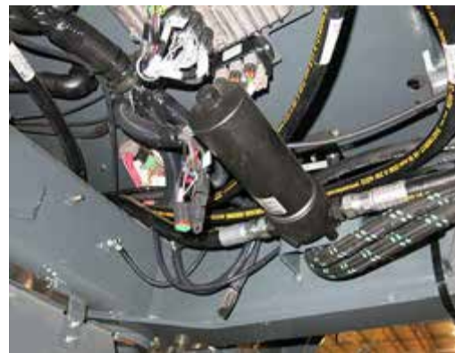
Filtro de presión (ubicada debajo del lado derecho de la máquina – baje el protector de metal para tener acceso) -Vista típica
