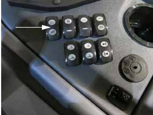
Interruptor de la válvula del tanque principal (ubicado en la consola lateral) -Vista típica
