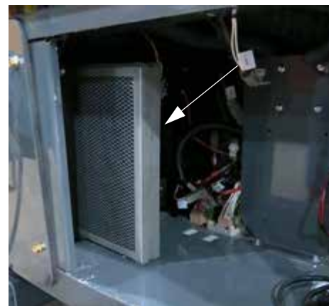
Filtro de carbón -Vista típica
