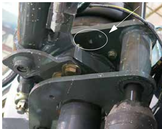
Engrasador tipo Zerk del collarín (situado debajo de la placa de montaje de cada bolsa de aire) -Vista típica
