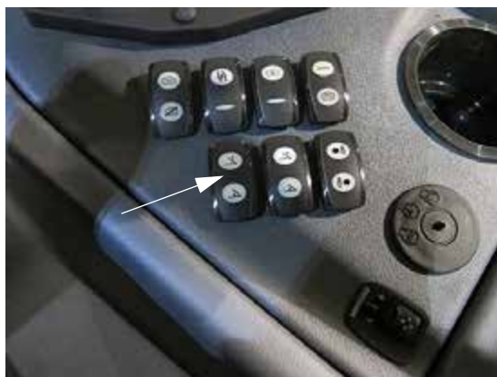
Interruptor de extensión del brazo * Brazos de aspersión de 90 pies (ubicado en la consola lateral) -Vista típica
