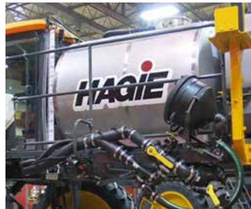
Tanque de solución -Vista típica
