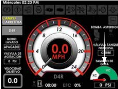
Indicador de tamaño de gota (ubicado en la página principal de la pantalla de la máquina - modo de campo)
