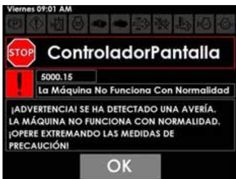
Advertencia de falla de la máquina
