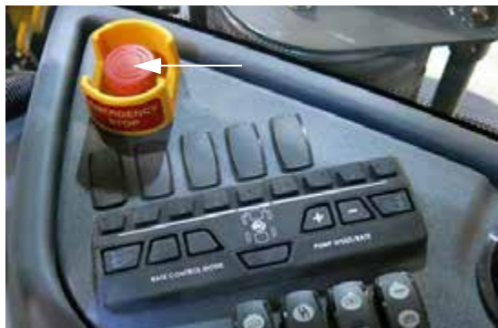
Interruptor E-Stop (ubicado en la consola lateral) -Vista típica
