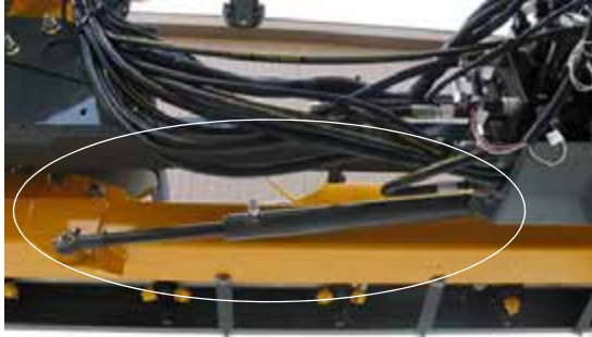
Cilindro de balanceo -Vista típica
