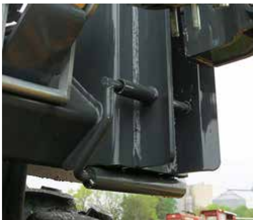
Pasador de bloqueo -Vista típica
