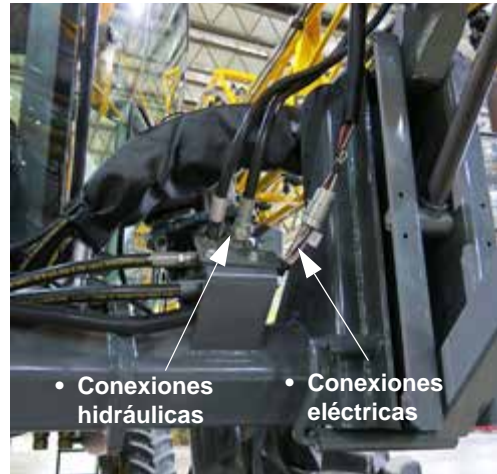
Conexiones eléctricas/hidráulicas - “estándar” (situadas en la parte delantera izquierda de la máquina) -Vista típica
