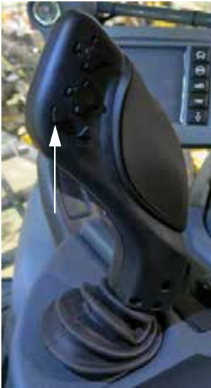
Interruptor de manejo de la última hilera (ubicado en la manilla de control de la transmisión hidrostática) -Vista típica
