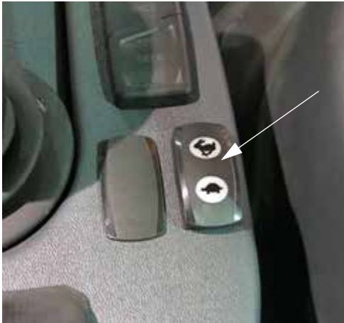
Interruptor del acelerador (ubicado cerca de la manilla de control de la transmisión hidrostática) -Vista típica
