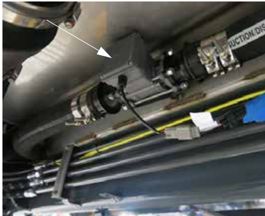
Medidor de flujo (ubicado debajo del lado derecho de la máquina) -Vista típica
