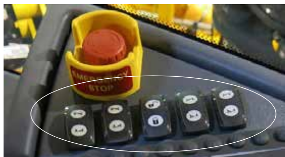
Interruptores del BHN de 60 pies (ubicado en la consola lateral) -Vista típica
