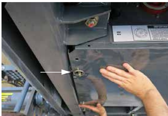
Pasador de fijación (instalado en el pasador de soporte colgante) -Vista típica
