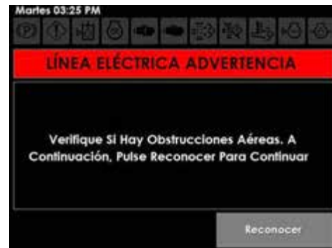
Mensaje de advertencia de línea de alta tensión (en la pantalla de la máquina)
