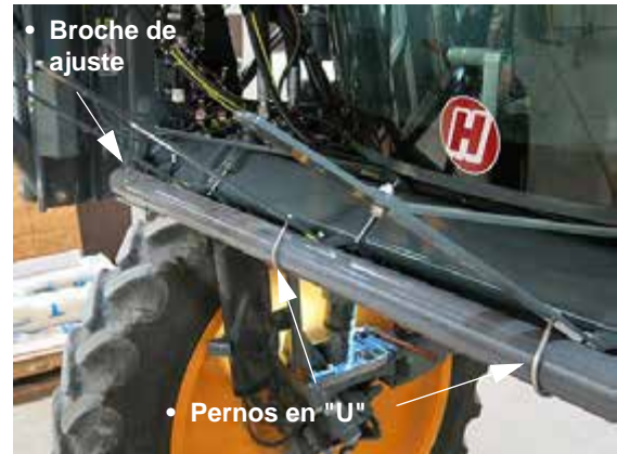
Tubo de protección de maleza -Vista típica
