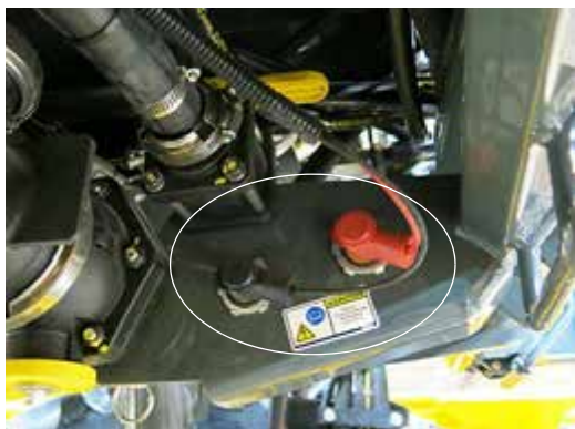
Puertos de suministro eléctrico (situados cerca del conjunto de llenado delantero) -Vista típica
