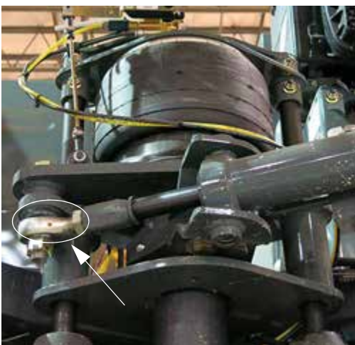
Engrasador tipo Zerk de la rótula de la barra de acoplamiento (situado en las patas delanteras) -Vista típica
