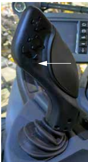
Interruptor del travesaño – ABAJO (ubicado en la manilla de control de la transmisión hidrostática) -Vista típica
