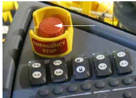
Interruptor E-Stop (ubicado en la consola lateral) -Vista típica
