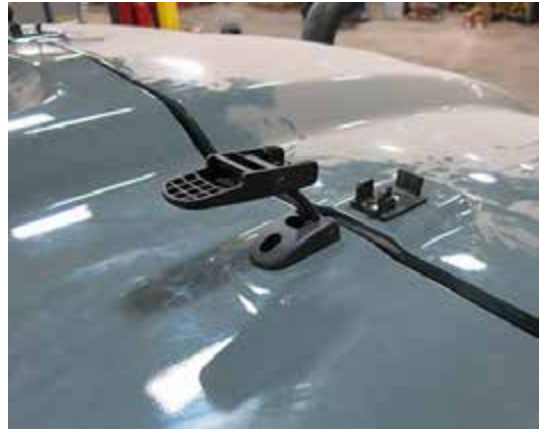
Cierre con traba del capó (2) (situados a cada lado del capó superior) -Vista típica
