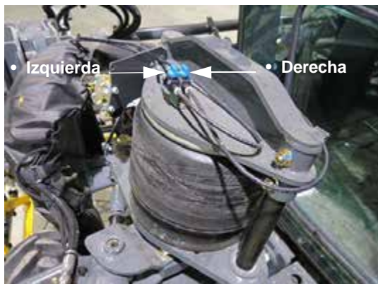
Válvulas de suspensión de aire (ubicadas en las bolsas de aire izquierda y derecha delanteras y traseras) -Vista típica
