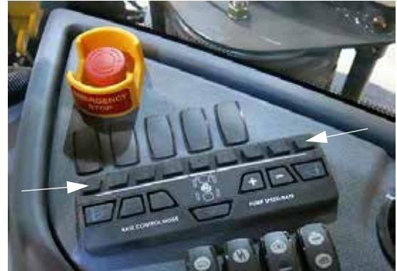
Interruptores de las válvulas de solución del brazo: secciones 1 y 9 (ubicados en la consola lateral) -Vista típica
