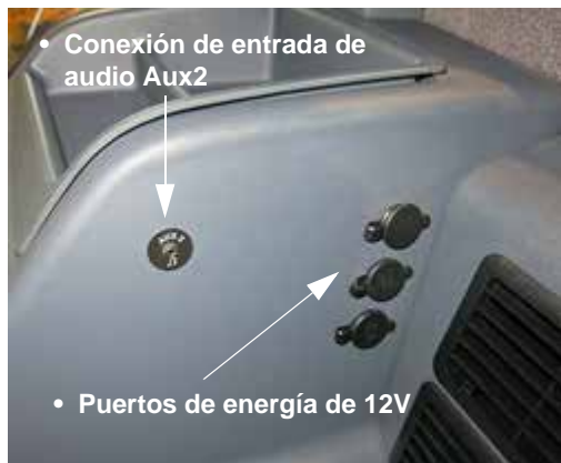
Puertos de energía de 12V y conexión de entrada de audio Aux2 (ubicada en el lado interno del panel de la consola lateral) -Vista típica
