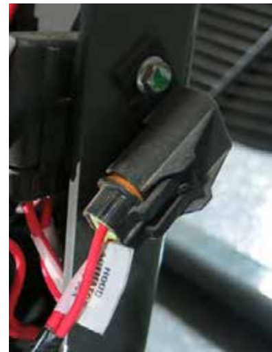
Fusible del actuador del capó (ubicado cerca del lado izquierdo trasero de la máquina) -Vista típica
