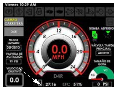
Indicador de tiempo de aplicación de la aspersión (ubicado en la página principal - modo de campo)
