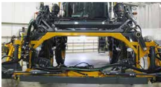
Travesaño de giro -Vista típica
