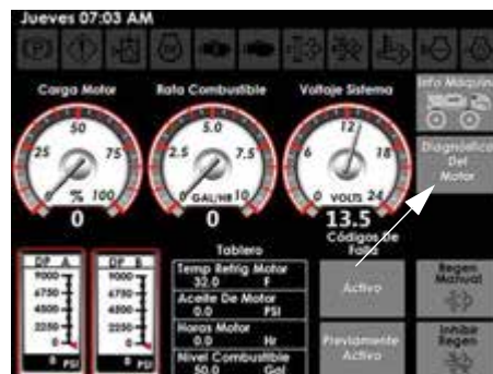
Botón de diagnóstico del motor (ubicado en la página de diagnóstico de la máquina)
