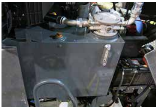
Depósito de aceite hidráulico (ubicado en el lado izquierdo de la máquina, abra el capó para tener acceso) -Vista típica
