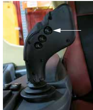
Interruptor de aspersión principal (situado en la parte posterior de la manilla de control de la transmisión hidrostática)
