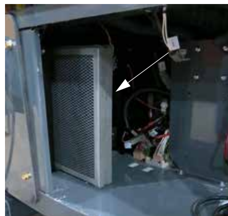
Filtro de carbón -Vista típica
