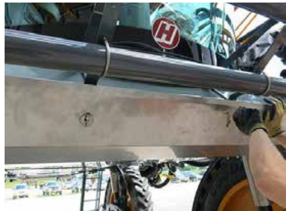
Instalación de protección frontal -Vista típica
