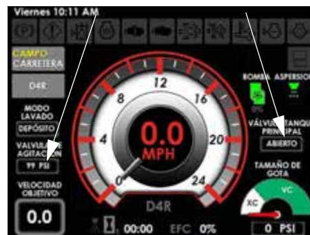
Indicadores del estado de la válvula del tanque y de la presión de la válvula de agitación (ubicados en la página principal de la pantalla de la máquina – modo de campo)
