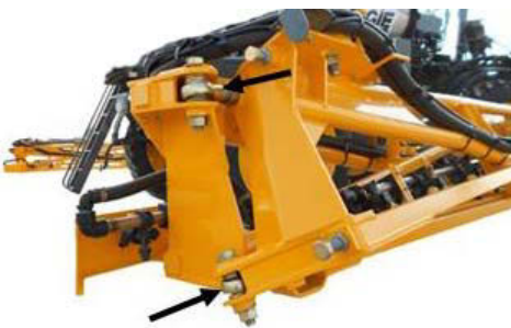
Articulaciones de plegado del brazo -Vista típica
