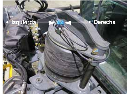
Válvulas de la suspensión neumática (ubicadas en las bolsas de aire izquierda delantera e izquierda trasera) -Vista típica
