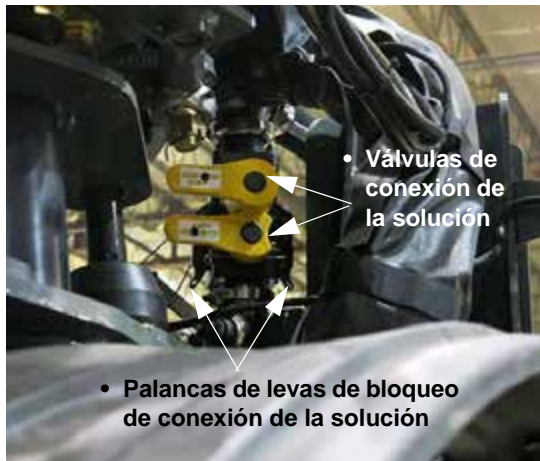
Válvulas de conexión de la solución y levas de bloqueo (ubicadas en el lado derecho delantero de la máquina) -Vista típica
