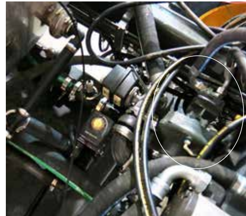
Bomba de solución (ubicada cerca del centro de la máquina) -Vista típica
