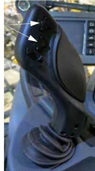
Orientación de los interruptores de los brazos izquierdo y derecho (ubicados en la manilla de control de la transmisión hidrostática) -Vista típica
