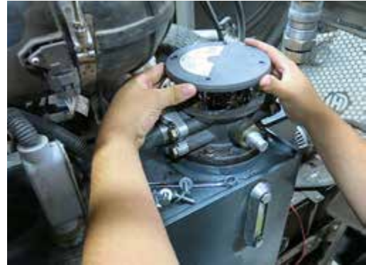
Llenar el depósito a través del alojamiento del filtro de retorno hidráulico -Vista típica
