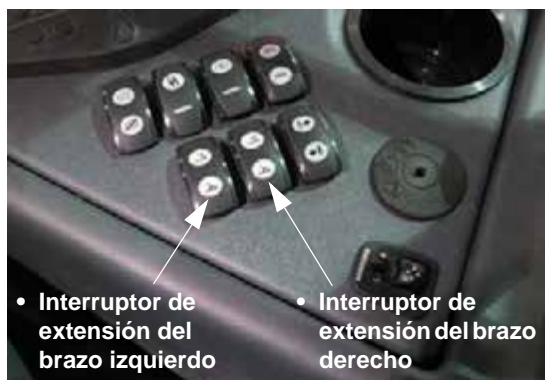
Interruptores de extensión del brazo izquierdo y derecho (ubicados en la consola lateral) -Vista típica
