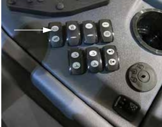
Főtartály szelep kapcsolója (oldalsó vezérlőpulton) – Tipikus nézet
