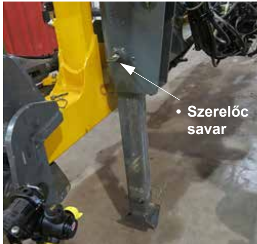
Gém állvány (Kihajtott pozíciót mutatja) – Tipikus nézet
