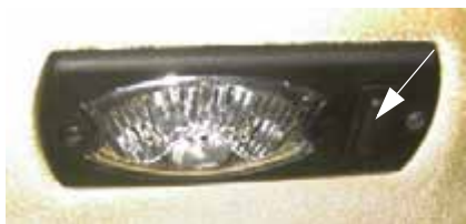
Belső munkalámpa kapcsoló – Tipikus nézet
