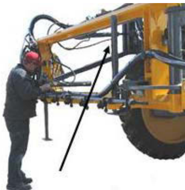
Gém állvány szállítási pozícióban – Tipikus nézet
