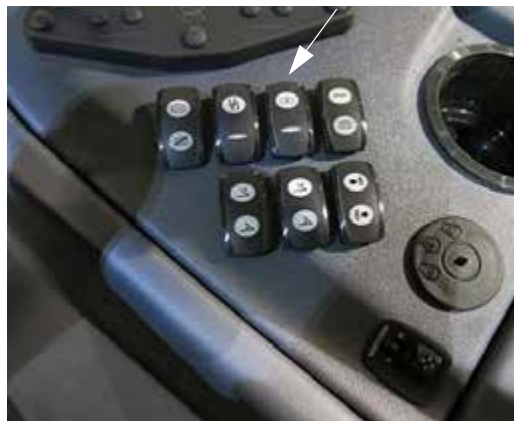
Keverőszelep kapcsolója (oldalsó vezérlőpulton) – Tipikus nézet
