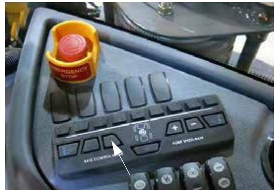
Kézi „MAN” arány szabályzó kapcsoló (oldalsó vezérlőpulton) – Tipikus nézet
