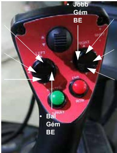
Bal és jobb oldali gém kapcsolók (A hidrosztatikus vezérlést irányító kar 2-es változatán) – Tipikus nézet
