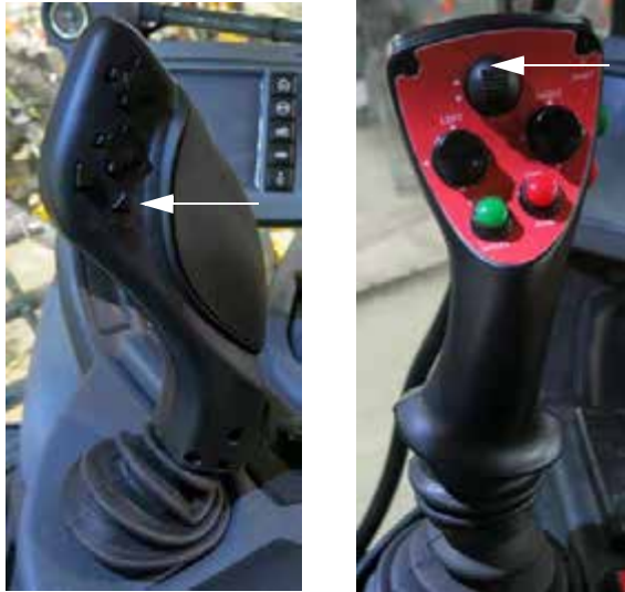
Támasztómű kapcsolója - FEL (a hidrosztatikus vezérlést irányító karon) – Tipikus nézet
