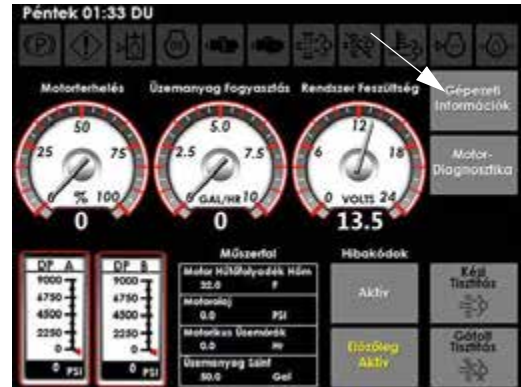
Gépi információk gombja (a Gépdiagnosztika oldalán)
