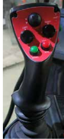
Hidrosztatikus vezérlést irányító kar (2-es változat) – Tipikus nézet
