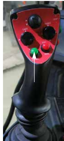
Elsődleges permetező kapcsoló (A hidrosztatikus vezérlést irányító kar 2-es változatán) – Tipikus nézet
