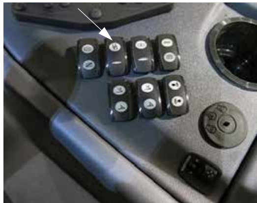
Főtartály szelep kapcsolója (oldalsó vezérlőpulton) - Tipikus nézet
