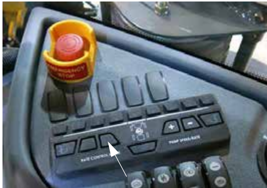
Kézi „KÉZI” arány szabályzó kapcsoló (oldalsó vezérlőpulton) – Tipikus mézet
