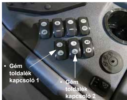
Gém toldalék kapcsolók (oldalsó vezérlőpulton) – Tipikus nézet
