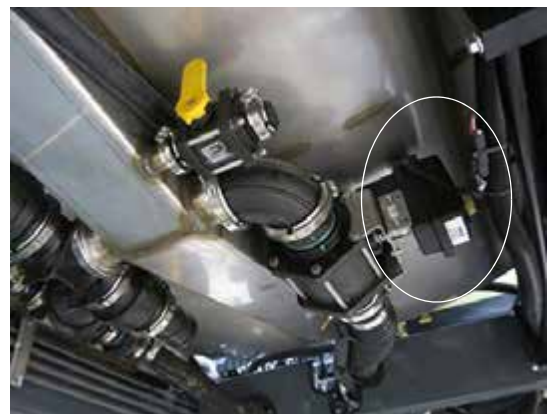
Permetlé tartály szelep (a gépezet alsó oldalán a permetlé tartály alatt) – Tipikus nézet
