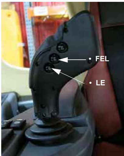
(A hidrosztatikus vezérlést irányító kar 1-es változatának hátsó oldalán helyezkedik el) - Tipikus nézet
