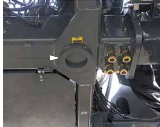
Emelési pont, szorító gyűrűk (a vázon vannak elhelyezve, az egyes lábak közelében) – Tipikus nézet
