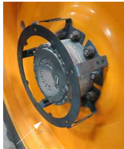
Kerékagy lemezsapkát rögzítő szerelvénylemez – Tipikus nézet
