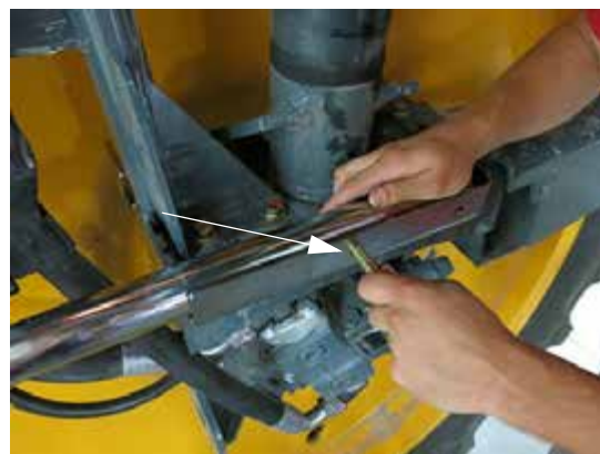
Terményterelő szerelőcsavar – Tipikus nézet
