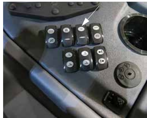
Keverőszelep kapcsoló (oldalsó vezérlőpulton) – Tipikus nézet
