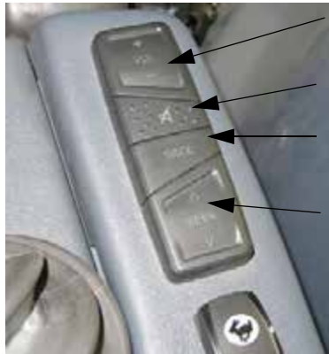
Sztereo készülék távirányítója (a hidrosztatikus hajtás vezérlőkarja mellett) – Tipikus nézet
