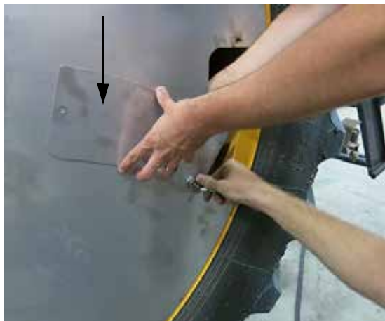
Szelepszár hozzáférési burkolólemez – Tipikus nézet
