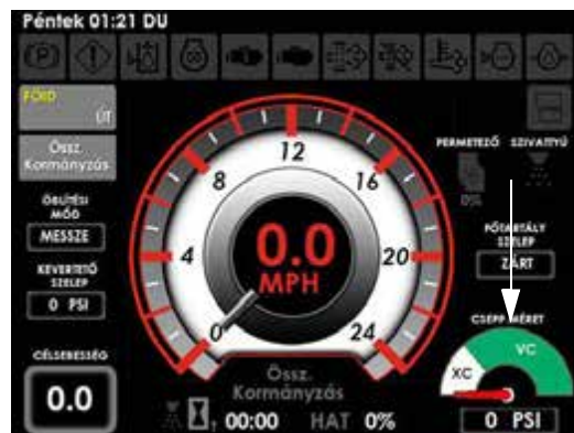
Cseppméret kijelző (a gép kijelzőjének kiindulási képernyőjén van elhelyezve –Mezei üzemmódban)
