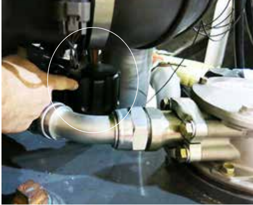
Légzsapka (a gép visszatérő vezeték szűrő házának bal oldalán van elhelyezve) – Tipikus nézet
