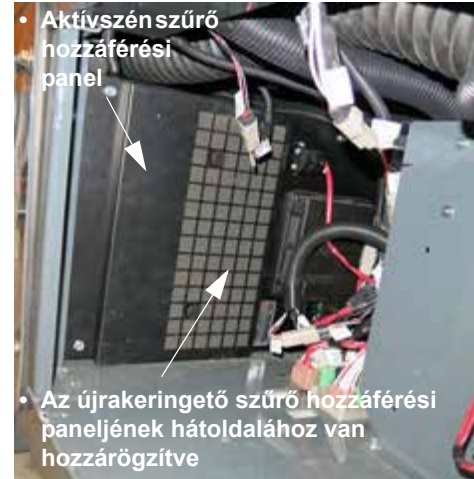
Aktívszén szűrő hozzáférési panel Az újrakeringető szűrő hozzáférési paneljének hátdoldalához van hozzárögzítve Aktívszén szűrő hozzáférési panel (A vezetőfülke jobb oldalán, a külső szerviz panel mögött helyezkedik el) – Tipikus nézet
