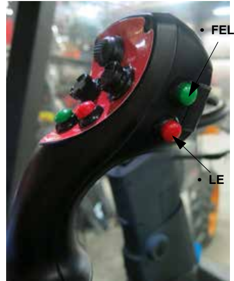
Felemelés/lesüllyesztés kapcsolók (A hidrosztatikus vezérlést irányító kar 2-es változatának oldalán helyezkedik el) - Tipikus nézet
