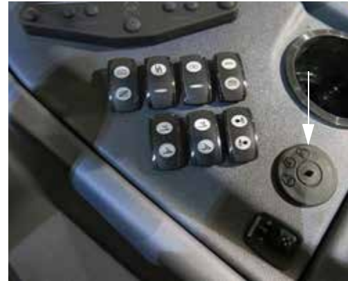
Gyújtáskapcsoló (oldalsó vezérlőpulton) – Tipikus nézet
