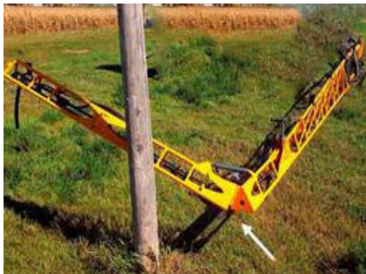
Külső gém törésgátló – Tipikus nézet
