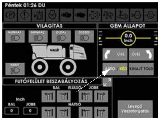
Gém állapot gomb - Automatikus/kézi (jobb kéz felőli oldalt a munkagép képernyőjének segédvezérlések oldalán)
