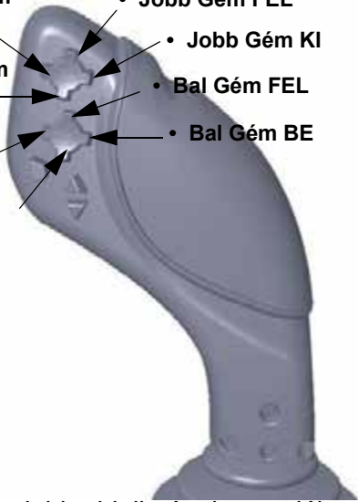
Bal és jobb oldali gém kapcsolók (A hidrosztatikus vezérlést irányító kar 1-es változatán) – Tipikus nézet
