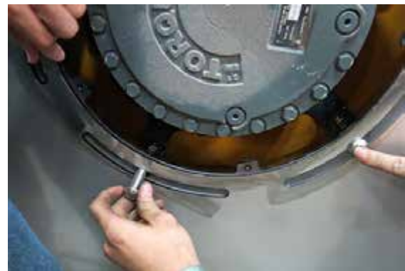
Kerék fedlemez szerelőcsavar telepítés – Tipikus nézet
