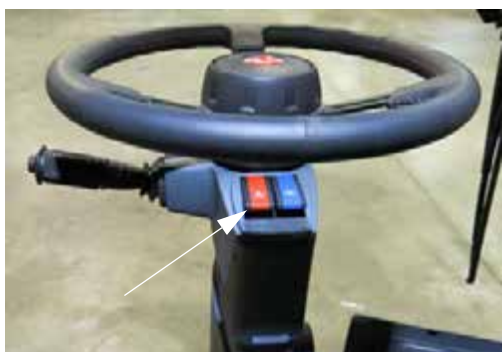
Vészjelző/figyelmeztető fények kapcsoló (a kormányoszlopon)
