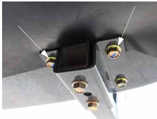
Szerelőcsavarok (a motorháztető tartó egyes oldalain kettő van belőle) – Tipikus nézet
