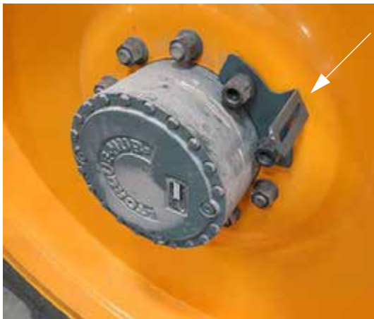
Kerékagy lemezsapkát rögzítő szerelvénylemez – Tipikus nézet
