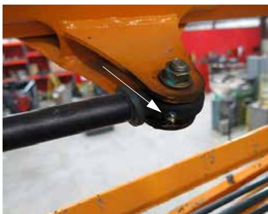
Gém törésgátló henger rúd vég – Tipikus nézet
