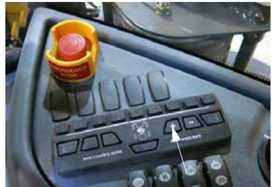
„+” szivattyú sebesség/arány kapcsoló (oldalsó vezérlőpulton) – Tipikus nézet
