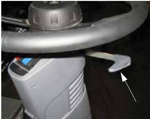
Kormánykerék teleszkóp állító fogantyú (a kormányoszlop jobb oldalán) – Tipikus nézet
