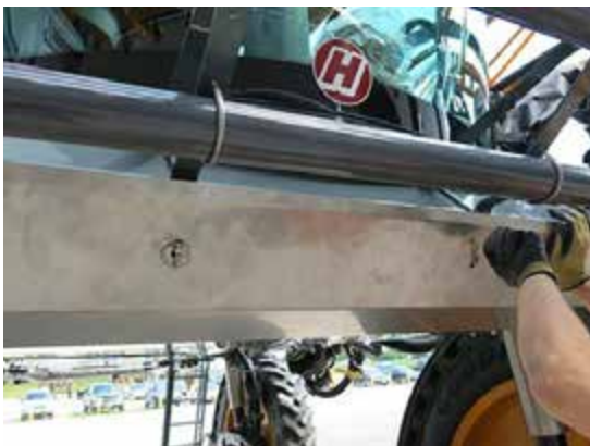
Elülső alvázvédelmi szerelvény telepítése – Tipikus nézet
