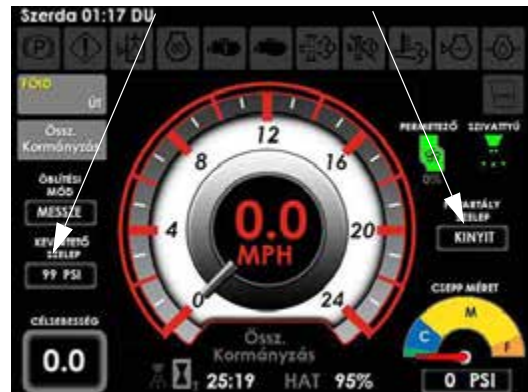
A főtartály szelep állapota és a keverőszelep nyomásának kijelzése (a munkagép képernyőjének kezdőoldalán - Mező módban)
