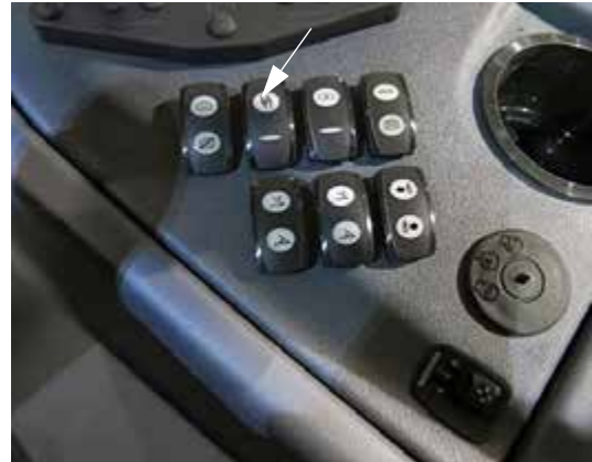
Permetlé szivattyú kapcsoló (oldalsó vezérlőpulton) – Tipikus nézet
