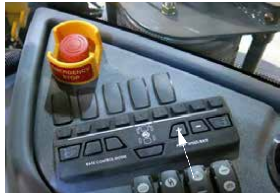
„+” szivattyú sebesség/arány kapcsoló (oldalsó vezérlőpulton) – Tipikus nézet
