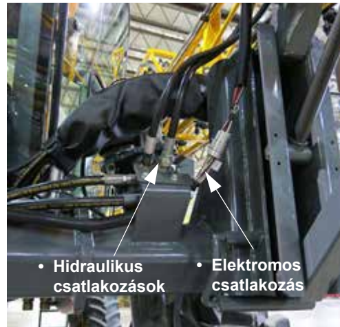
• Hidraulikus csatlakozások • Elektromos csatlakozás Hidraulikus/elektromos csatlakozások – „szabványos” (a gép elülső bal oldalánál helyezkedik el) – Tipikus nézet
