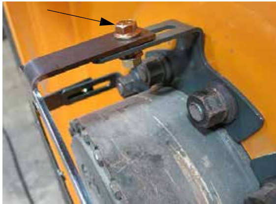
Kerékagy lemezsapkát rögzítő szerelvénylemez telepítése – Tipikus nézet
