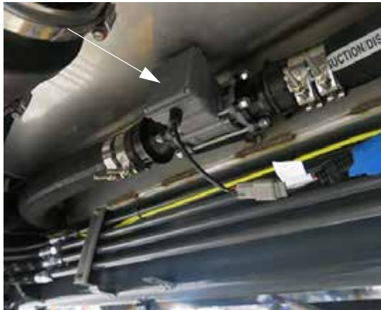
Áramlásmérő (A gépezet alján jobb-kéz felőli oldalt) – Tipikus nézet
