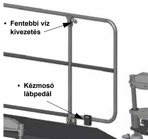
Fentebbi víz kivezetés/Kézmosó láb pedál (a gép bal oldalánál, a lépcső korlát mentén helyezkedik el) – Tipikus nézet
