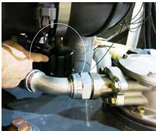
Légzősapka (a gép visszatérő vezeték szűrő házának bal oldalán van elhelyezve) – Tipikus nézet
