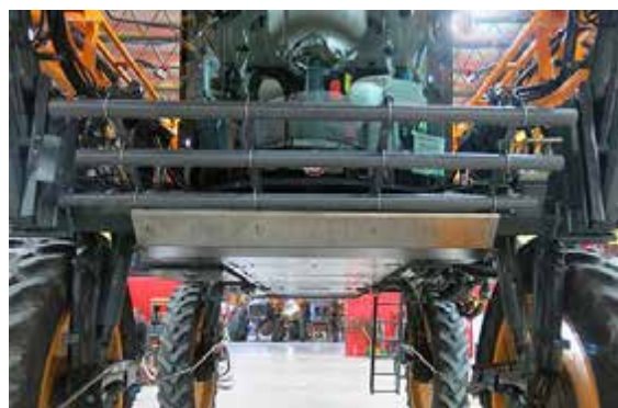
Termény súrlódásvédelem telepítése – Tipikus nézet
