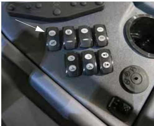
Főtartály szelep kapcsolója (oldalsó vezérlőpulton) – Tipikus nézet
