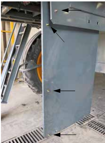
Függő csapok (Helyezzen el három csapot a 4. burkolólemezzre, és egyet pedig az 5.burkolólemezzre, ahogy az az ábrán látható)
