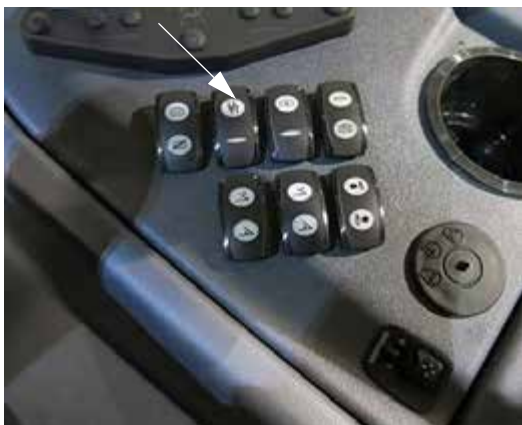
Permetlé Szivattyú Kapcsoló (oldalkonzolon) – Tipikus nézet
