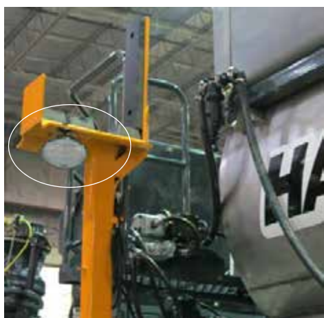
Munkalámpák (a fülke mindkét oldalán) – Tipikus nézet
