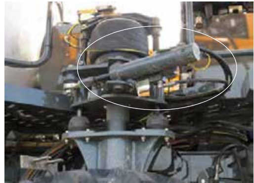
Kormány munkahenger (a hátsó lábakon) – Tipikus nézet
