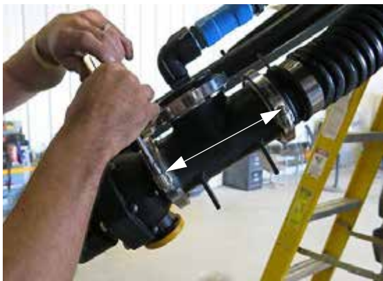
Homlokoldali töltő csőcsonk rögzítők – Tipikus nézet
