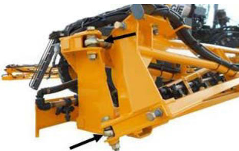
Gém összehajtás kapcsolódásai – Tipikus nézet
