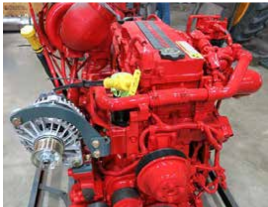
Tier 4 végső dízelmotor (A gép hátulja mellett - a motorháztető kinyitásával férhet hozzá) - Tipikus nézet
