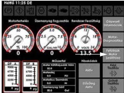
Motor leállító gomb felülírása (a gépdiaosztika oldalán)
