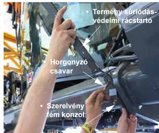
Termény súrlódásvédelmi rácstartó – Tipikus nézet
