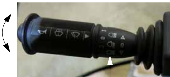
Reflektor (az irányjelző kapcsolón) – Tipikus nézet
