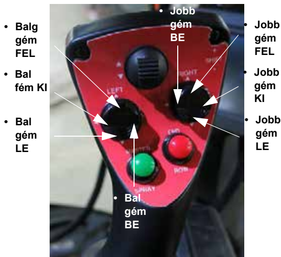
Bal és jobb oldali gém kapcsolók (A hidrosztatikus vezérlést irányító kar 2-es változatán) – Tipikus nézet
