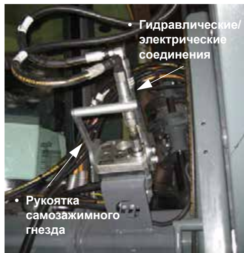
Узел комбинированной гидроэлектрической муфты с самозажимным гнездом - если есть (на передней левой стороне машины)
