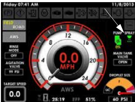
Главный индикатор опрыскивателя (сверху справа Главной дисплея машины - в Полевом режиме)
