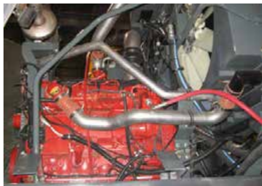
Дизельный двигатель, соответствующий стандарту Tier 3 - стандартный вид
