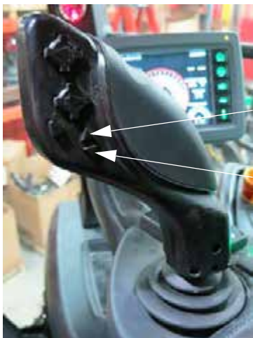
Переключатели «Все вверх/вниз» (расположены на Рукоятке управления гидростатической передачей) - стандартный вид
