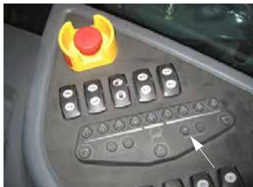
“+” Переключателя скорости работы/расхода насоса (на боковой панели) - стандартный вид
