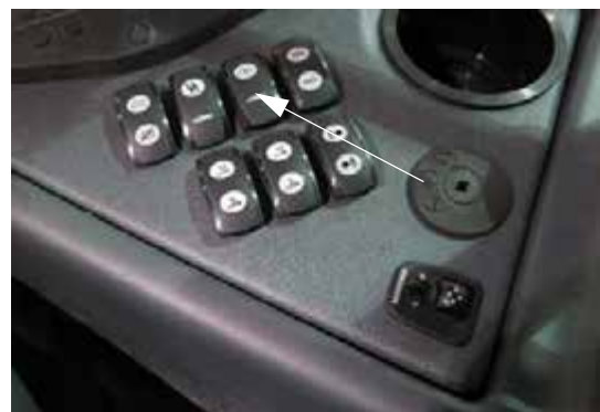
Переключатель клапана перемешивания (расположен на боковой панели) - стандартный вид
