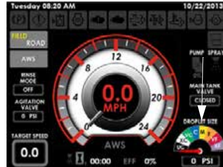
Индикатор размера капель (на дисплее машины Главная страница - Полевой режим)
