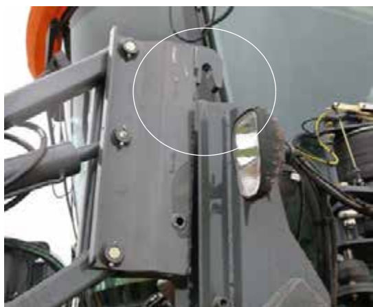
Штифт крепления для высвобождения прицепки - стандартный вид
