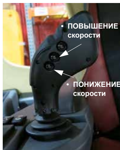
Переключатель повышения/ понижения скорости (находятся на задней стороне рукоятки управления гидростатической передачей) - Стандартный вид
