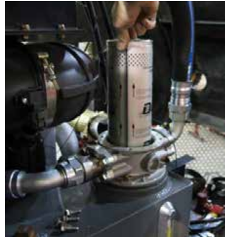
Обратный фильтр (расположен внутри корпуса фильтра на левой стороне машины) - стандартный вид
