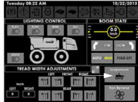
Кнопка подвески (на Странице вспомогательных органов управления дисплея машины)
