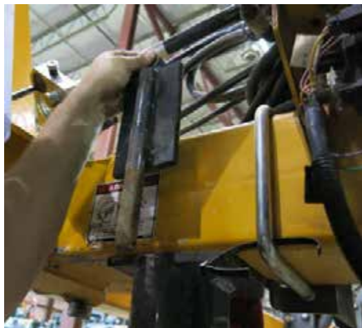
Ограничитель (с внутренней части каждой опоры комбинированной прицепки) - стандартный вид
