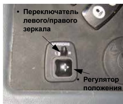
Переключатель зеркал с электроприводом (расположен на боковой панели) - Стандартный вид
