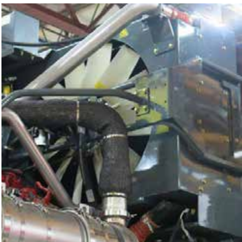
Реверсивный вентилятор (расположен в задней части машины, откройте капот для доступа) - стандартный вид
