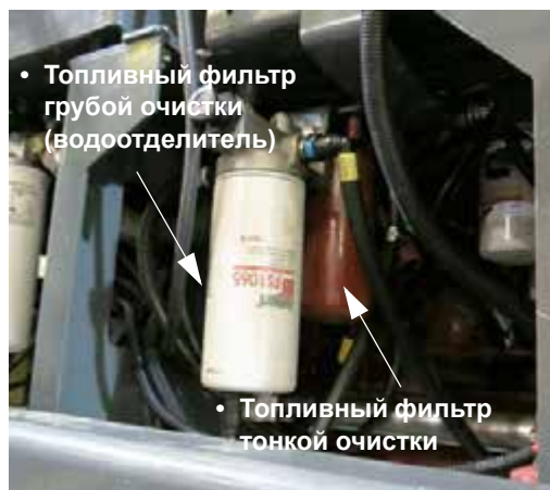
Фильтры грубой и тонкой очистки (расположенные вдоль левой стороны машины) - стандартный вид
