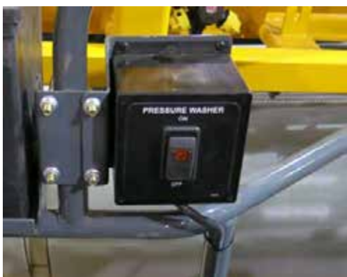
Выключатель мойки под давлением (расположен вдоль перил на левой стороне машины) - стандартный вид
