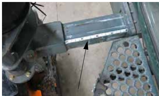
Индикаторная надпись по регулировке ширины колеи (передние опоры) – стандартный вид
