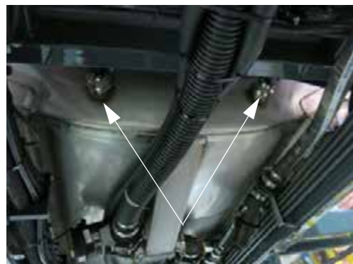
Струйные мешалки (по две с каждого конца бака для раствора) - стандартный вид
