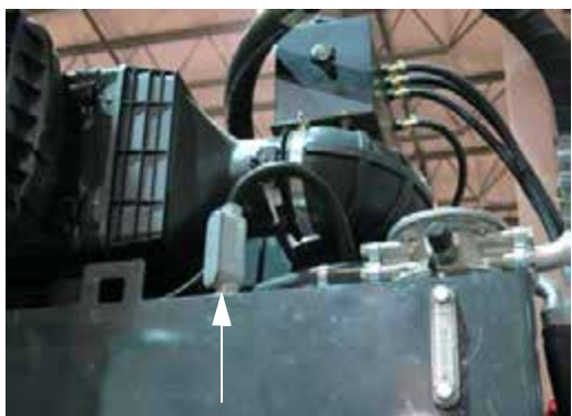
Датчик уровня и температуры (расположен в верхней части бака масла для гидросистем) - стандартный вид
