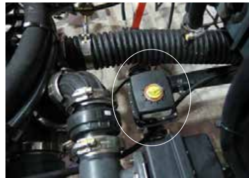
Клапан перемешивания (расположен рядом с центром машины) - стандартный вид * Вид с верхней части машины
