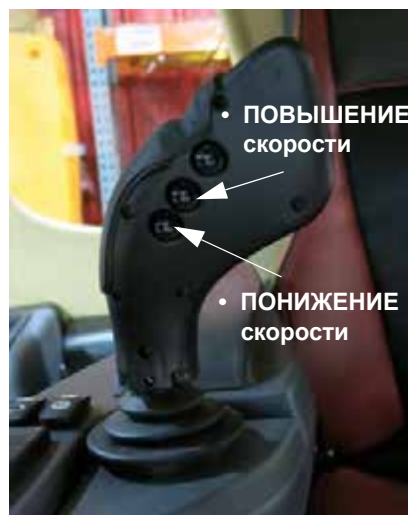
Переключатели Shift Up и Shift Down (расположены на обратной стороне ручки управления гидростатической передачей) - стандартный вид
