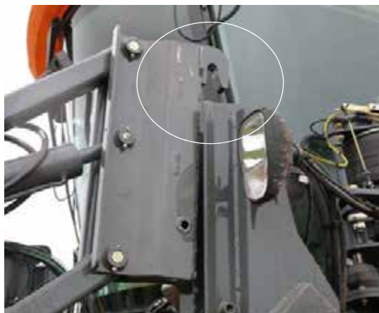
Штифт крепления для высвобождения прицепа - стандартный вид
