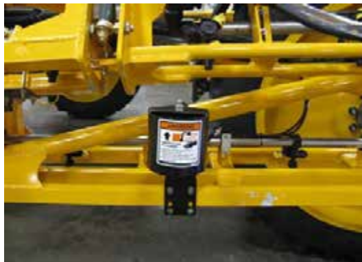
Прокладка из пеноматериала для датчика Norac (на каждом датчике Norac) - стандартный вид
