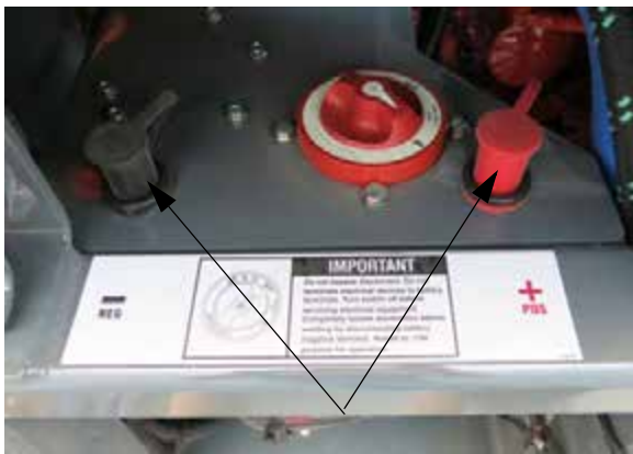
Вспомогательные посты заправки батарей (расположены на задней раме) - стандартный вид
