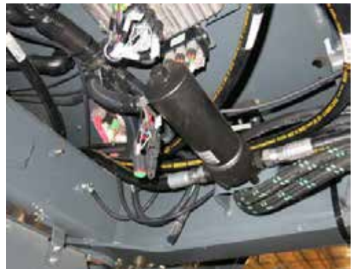
Напорный фильтр (расположен на правой стороне машины, откройте металлический экран для доступа) - стандартный вид
