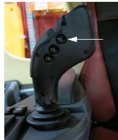
Главный выключатель опрыскивателя (сзади Рукоятки управления гидростатической передачей)
