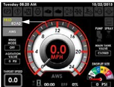
Кнопка Поле/Дорога (на Главной странице дисплея машины – Дорожный и Полевой режимы)
