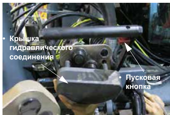
Крышка гидравлического соединения и Пусковая кнопка (показана правая сторона машины) - стандартный вид
