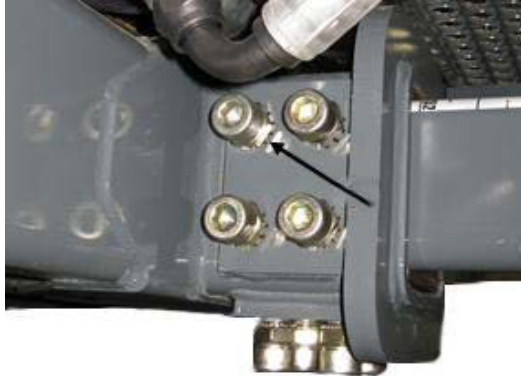
Стопорная гайка (на каждом опорном болте регулировки колеи) - стандартный вид
