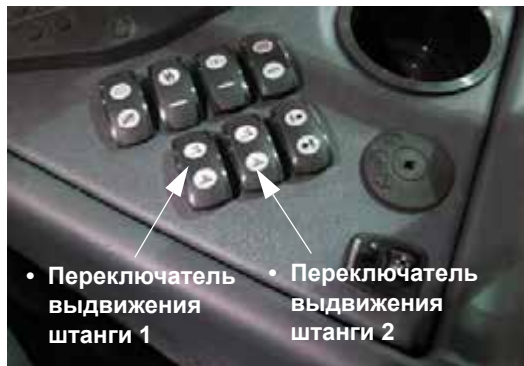
Переключатели выдвижения штанг (расположены на боковой панели) - Стандартный вид
