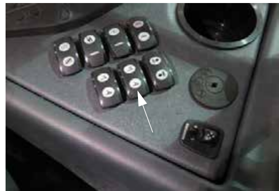
Переключатель выдвижения штанги - “Сгибание штанги” (расположен на боковой панели) - стандартный вид
