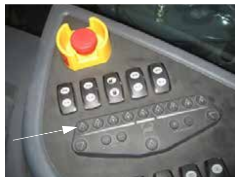
Переключатели клапана подачи раствора в штангу (расположен на боковой панели) - стандартный вид
