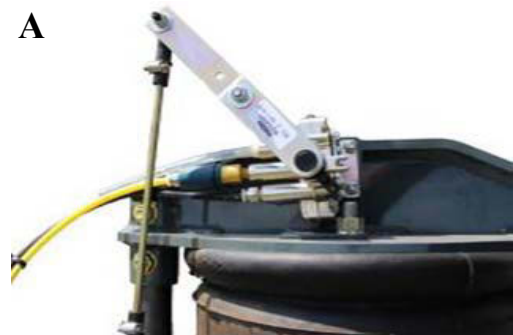
Клапан сброса давления (по одному клапану на каждой опоре) - стандартный вид
