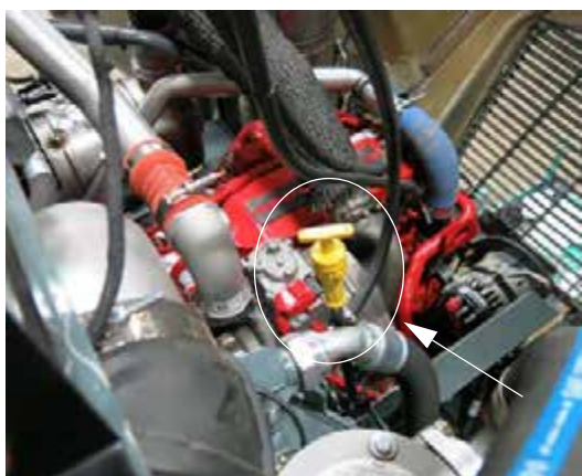
Масляный щуп двигателя (с левой стороны двигателя - откройте капот для доступа) - стандартный вид
