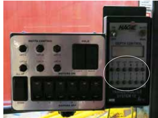
Переключатели подъема/опускания (расположен на Пульте управления Tassel-trol) - стандартный вид
