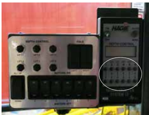
Переключатели подъема/опускания (расположен на Пульте управления Tassel-trol) - стандартный вид
