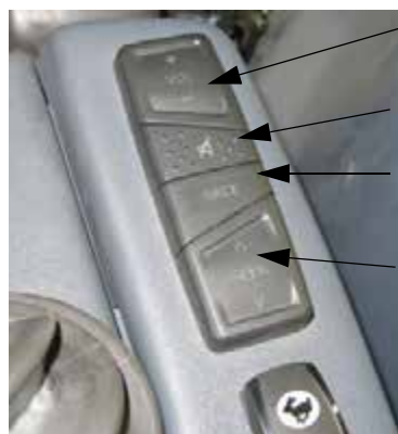
Регулятор стереобаланса (находится рядом с рукояткой управления гидростатической передачей) - Стандартный вид
