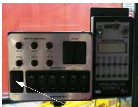
Переключатель «Все вверх/вниз» (расположен на Пульту управления удалением метелок кукурузы) - стандартный вид
