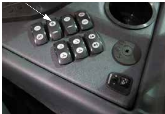
Переключатель насоса поддачи раствора (расположен на боковой панели) - стандартный вид
