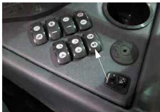
Переключатель индикатора пены (расположен на боковой панели) - Стандартный вид
