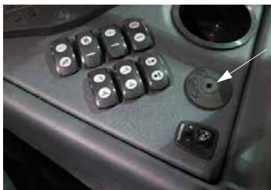
Выключатель зажигания (расположен на боковой панели) - Стандартный вид
