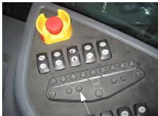
Переключатель ручного (MAN) регулирования скорости (на боковой панели) - стандартный вид
