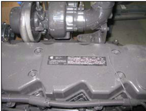
Серийный номер двигателя - стандартный вид
