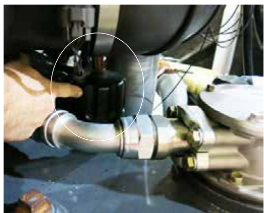
Крышка сапуна (расположен на левой стороне машины около корпуса обратного фильтра) - стандартный вид
