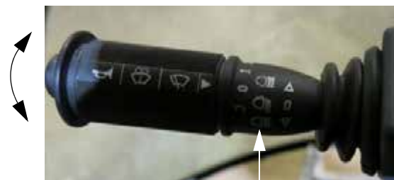
Переключатель фар дальнего света (расположен на конце переключателя указателей поворота) - Стандартный вид
