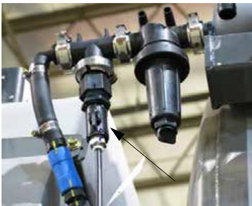
Клапан индикатора пены (расположен около задней части промывного бака) - стандартный вид
