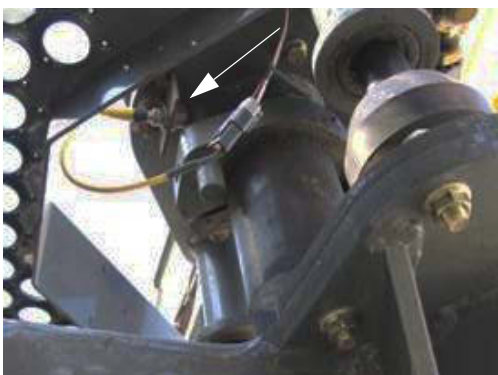
Внешний датчик близости - стандартный вид
