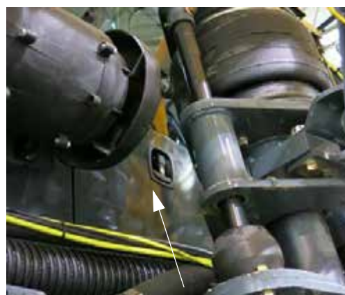
Эксплуатационная панель наружной обшивки (расположен с правой стороны кабины) - Стандартный вид
