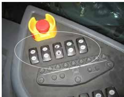
Переключатели инструментальной оправки для азота длиной 60 футов (расположен на боковой панели) - Стандартный вид
