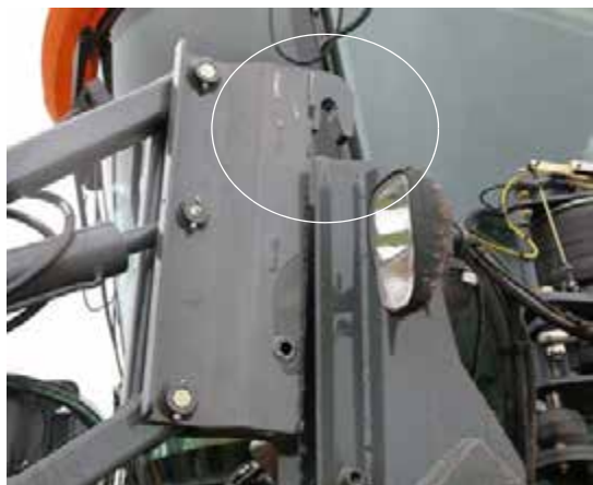
Штифт крепления для высвобождения прицепа - стандартный вид
