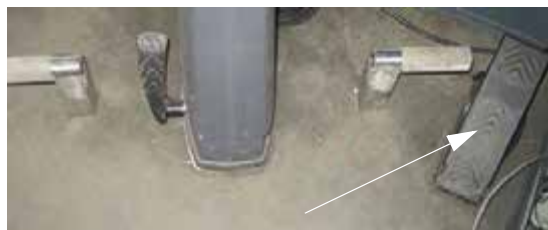
Педадь уменьшения скорости (расположена в правой нижней части рулевой колонки) - Стандартный вид
