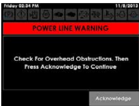
Сообщение, предупреждающее о линии электропередачи (на дисплее машины)
