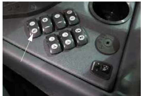
Переключатель клапана главного бака (расположен на боковой панели) – стандартный вид
