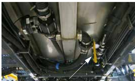
Вентиль отстойника (расположен под баком для раствора с правой стороны машины) - стандартный вид
