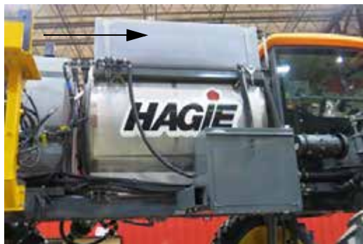
Промывной бак - стандартный вид
