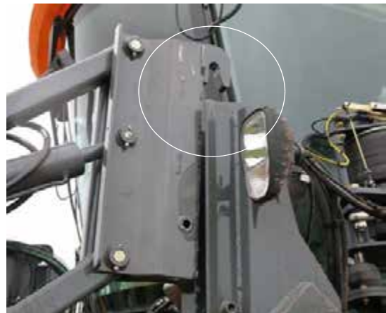
Штифт крепления для высвобождения прицепки - стандартный вид
