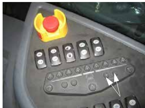
Переключатели скорости работы/ расхода насоса (на боковой панели) - стандартный вид
