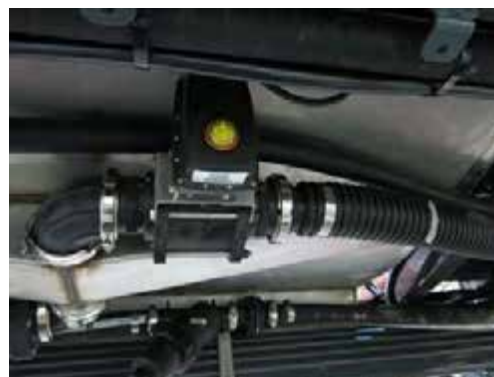
Клапан бака для раствора - стандартный вид
