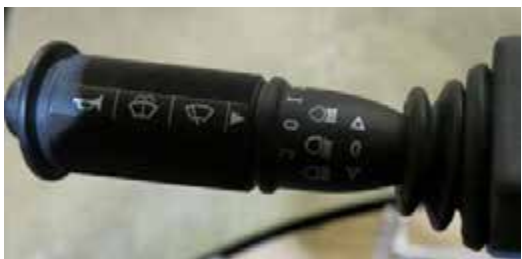
Переключатель указателей поворота - Стандартный вид
