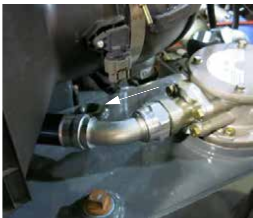
Снятая крышка сапуна - стандартный вид
