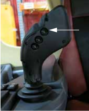
Главный выключатель опрыскивателя (сзади Рукоятки управления гидростатической передачей) - стандартный вид
