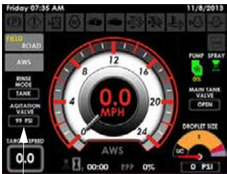
Индикатор давления в клапане перемешивания (на Главной странице дисплея машины – Полевой режим)
