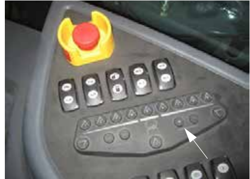
“+” Переключателя скорости работы/расхода насоса (на боковой панели) - стандартный вид
