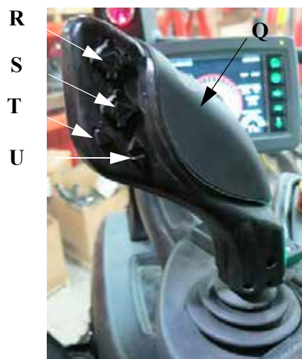
Рукоятка управления гидростатической передачей Вид спереди - Стандартный вид
