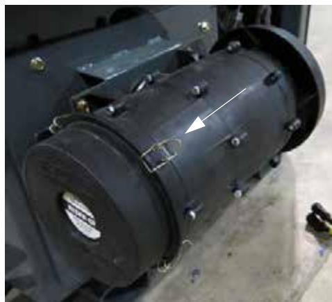
Защелки фильтра - стандартный вид
