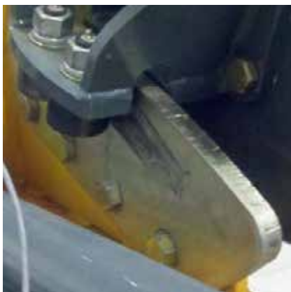
Фрикционный диск (в нижних углах между фиксированной и поворотной поперечинами) - стандартный вид
