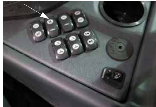
Переключатель насоса подачи раствора (на боковой панели) - стандартный вид
