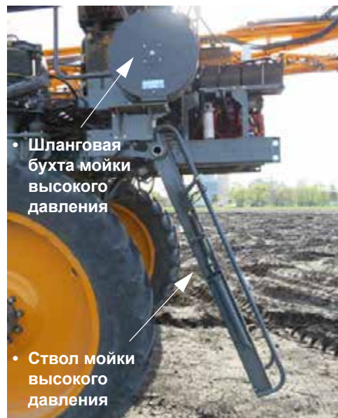
Ствол и шланговая бухта мойки высокого давления в сборе (расположены около лестницы на левой стороне машины) - стандартный вид
