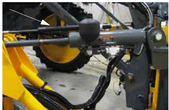
Датчик положения - стандартный вид
