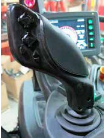
Ручка управления гидростатической передачей (расположена на боковой панели) - стандартный вид
