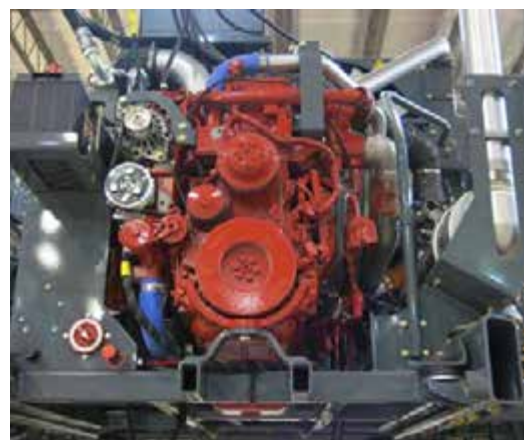
Дизельный двигатель, соответствующий стандарту Tier 4 - стандартный вид
