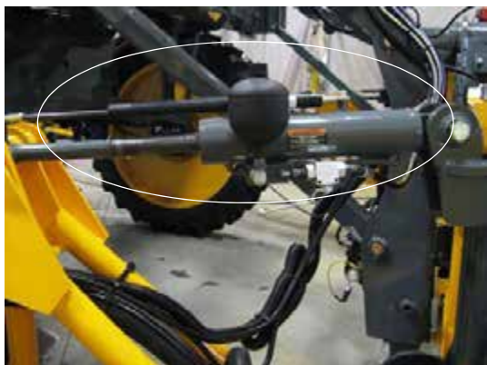
Цилиндры выравнивания - стандартный вид
