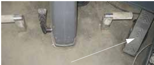
Педаль уменьшения скорости (расположена внизу справа от рулевой колонки) - стандартный вид
