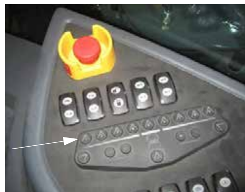
Переключатели клапана подачи раствора в штангу (расположен на боковой панели) - Стандартный вид
