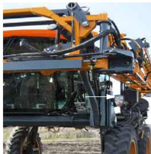
Главные фары (расположенные на каждой стороне кабины) - Стандартный вид
