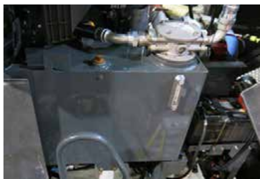
Бак масла для гидросистем (расположен на левой стороне машины, откройте капот для доступа) - стандартный вид
