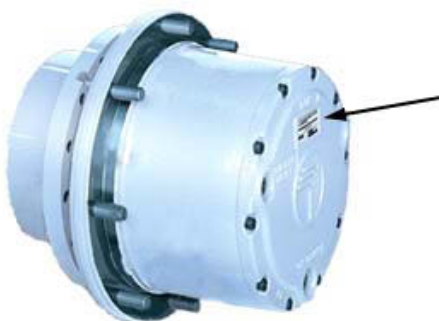
Идентификационная табличка ступицы колеса - стандартный вид
