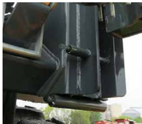
Стопорный штифт - стандартный вид * Показано сцепленное положение
