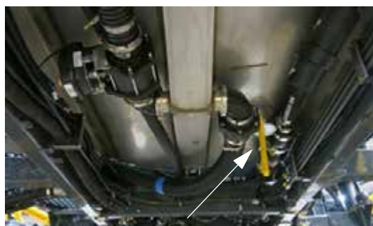
Вентиль отстойника - стандартный вид
