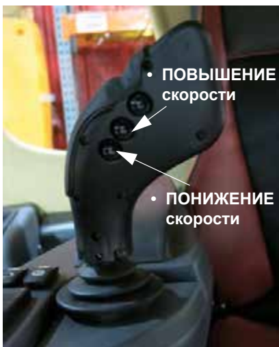
Переключатели Shift Up и Shift Down (расположены на обратной стороне ручки управления гидростатической передачей) - стандартный вид
