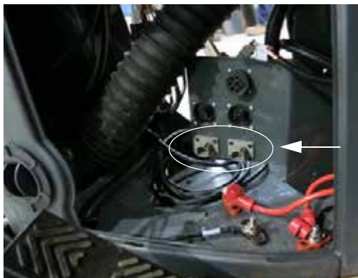
4-контактные разъемы питания (2 шт.) (находятся в середине боковой панели - для доступа необходимо снять переднюю панель) - Стандартный вид
