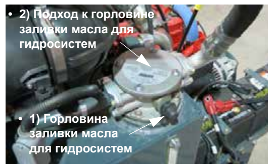
Варианты заливки масла для гидросистем - стандартный вид
