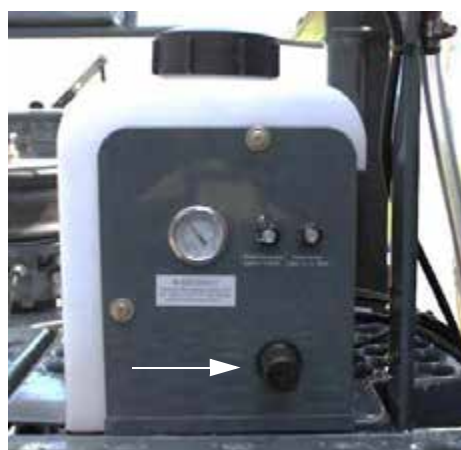
Указатель давления пены (расположен на стороне Бака индикатора пены) - стандартный вид
