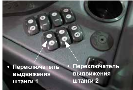
Переключатели выдвижения штанг (расположены на боковой панели) - Стандартный вид
