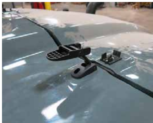
Зашелка капота (2) (расположен с обеих сторон верхнего капота) - стандартный вид
