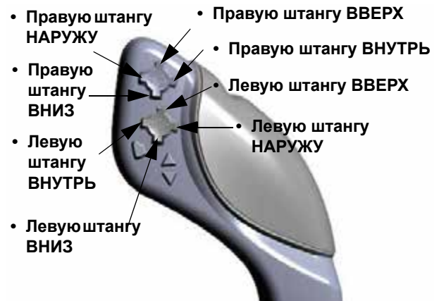
Ориентация переключателей выдвигания левой и правой штанг – стандартный вид
