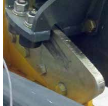
Placa de fricción (situada en las esquinas inferiores entre el travesaño fijo y el travesaño de giro) -Vista típica
