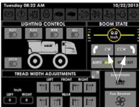
Botones de control de giro (CW/CCW) (ubicados en la página de controles auxiliares)
