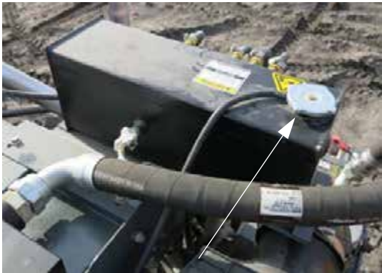
Tapa del radiador (situada en el compartimiento del motor) -Vista típica
