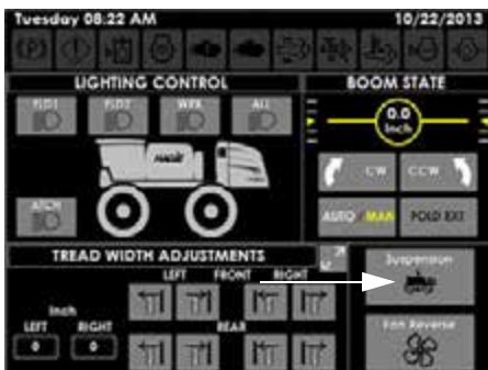
Botón de la suspensión (ubicado en la página de controles auxiliares de la pantalla de la máquina)
