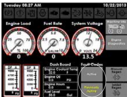
Botones de códigos de fallas (ubicados en la página de diagnóstico de la máquina)
