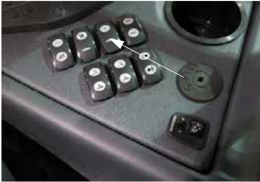
Interruptor de la válvula de agitación (ubicados en la consola lateral) -Vista típica
