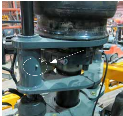
Engrasador tipo Zerk de torre de cojinetes (situado en las patas delanteras y traseras) -Vista típica
