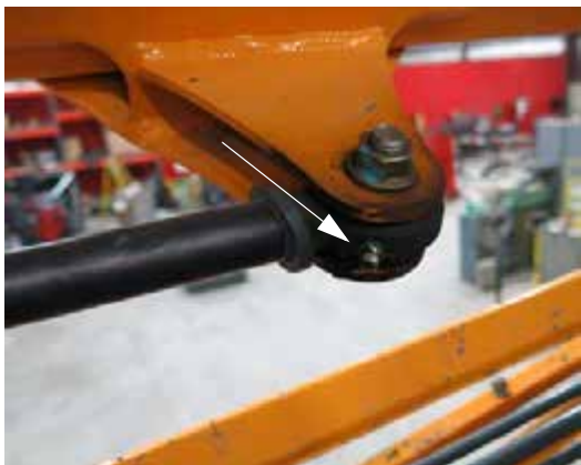
Extremo de la varilla del cilindro de desenganche del brazo -Vista típica
