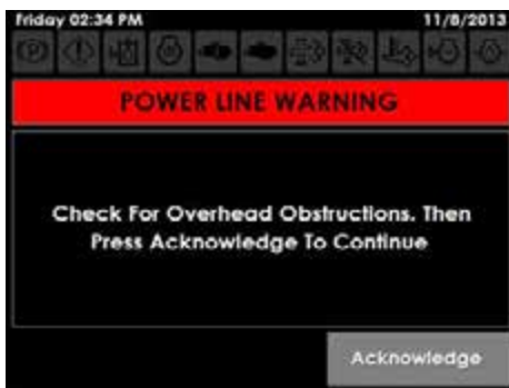
Mensaje de advertencia de línea de alta tensión (en la pantalla de la máquina)
