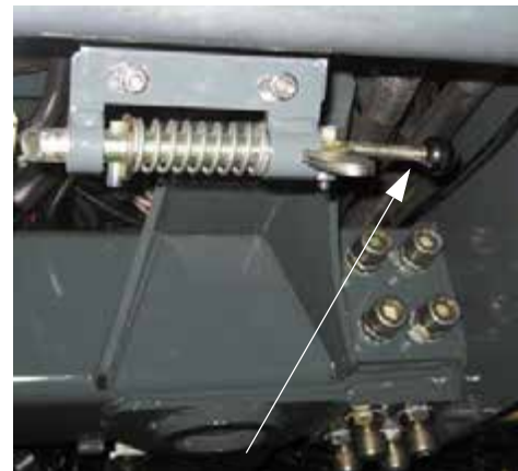
Palanca de desbloqueo del conjunto de llenado delantero (ubicada debajo del extremo delantero de la máquina) -Vista típica
