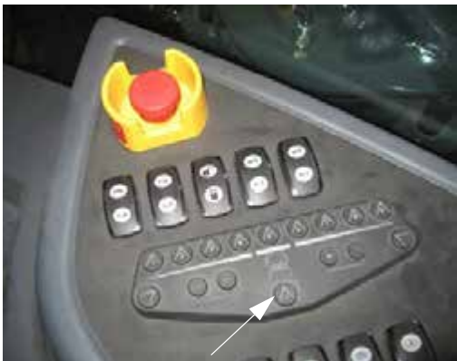
Interruptor de la boquilla trasera (ubicado en el lado de la consola) -Vista típica
