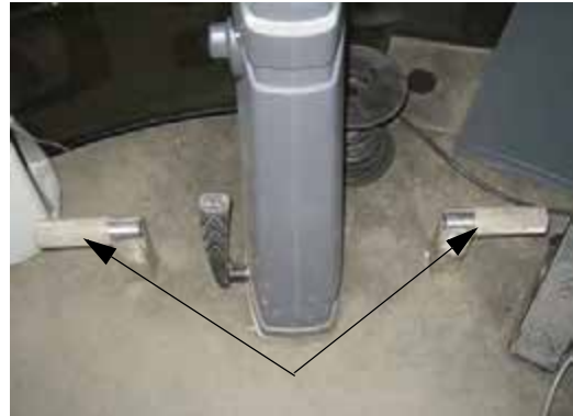
Estrabos para el pie del operador (ubicados a cada lado de la columna de dirección) -Vista típica
