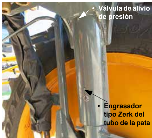
Válvula de alivio de presión y engrasador tipo Zerk del tubo de la pata (ubicados en las patas delanteras y traseras) -Vista típica
