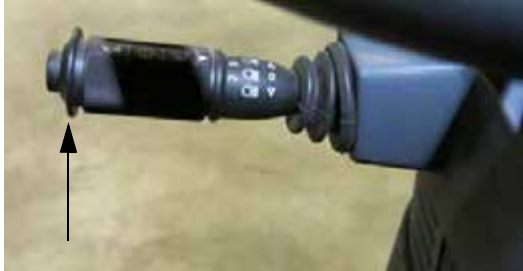
Interruptor del lavaparabrisas (ubicado al final de la palanca de la direccional) -Vista típica
