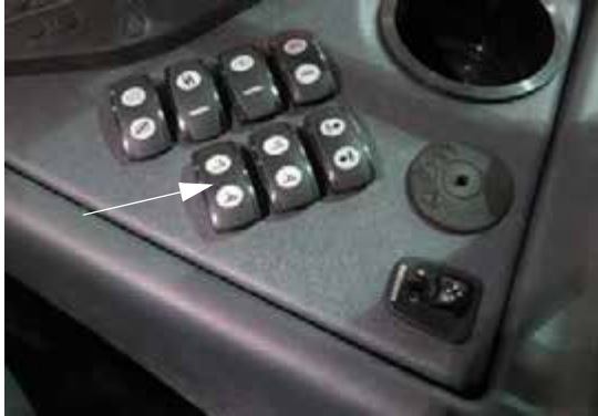
Interruptor de extensión del brazo * Brazos de aspersión de 90 pies (ubicado en la consola lateral) -Vista típica
