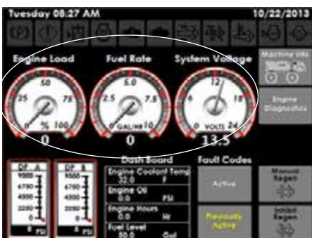
Instrumentos del sistema (ubicados en la página de diagnóstico de la máquina)
