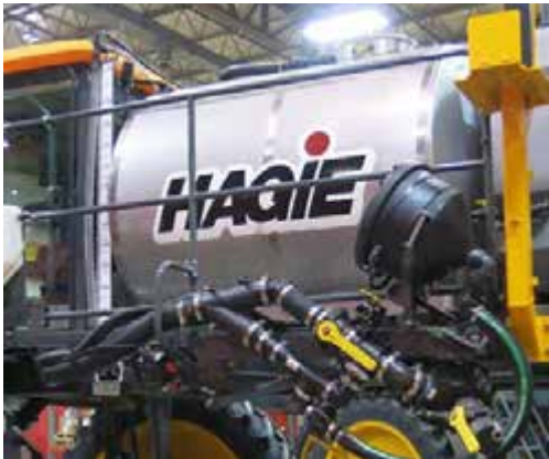
Tanque de solución -Vista típica
