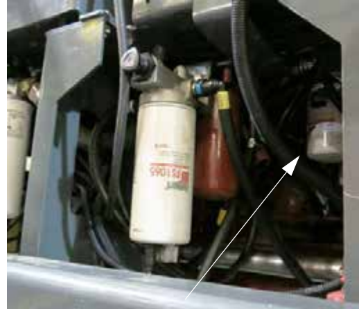
Filtro de aceite del motor (situado a lo largo del lado izquierdo de la máquina) -Vista típica
