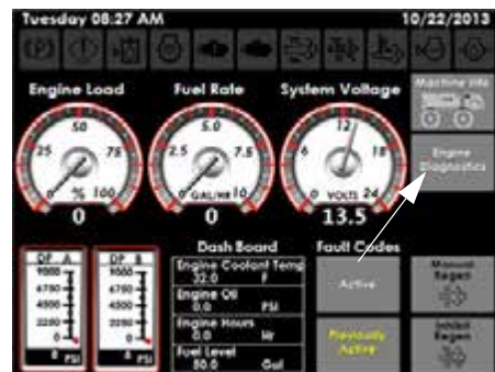
Botón de diagnóstico del motor (ubicado en la página de diagnóstico de la máquina)
