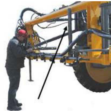
Soporte para el brazo en posición de desplazamiento -Vista típica
