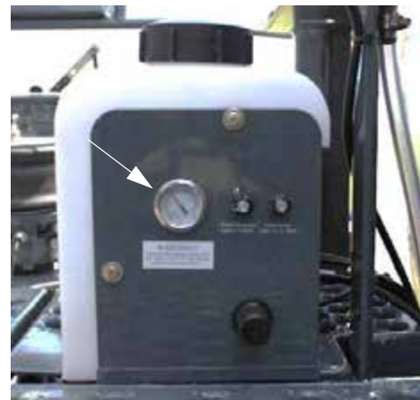
Manómetro de espuma (ubicado en la parte lateral del tanque del marcador de espuma, montado en el lado derecho de la máquina) -Vista típica
