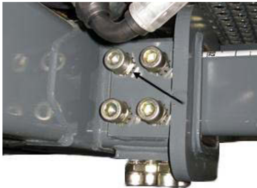
Contratuerca (ubicada en cada perno de fijación de ajuste de la distancia entre neumáticos) -Vista típica
