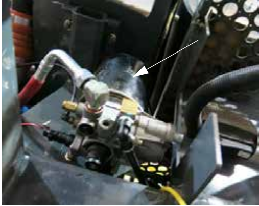
Secador de aire (situado debajo de la parte derecha de la máquina) -Vista típica
