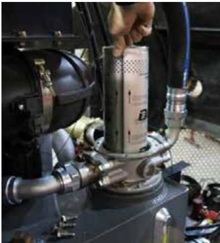
Filtro de retorno (ubicado dentro de la carcasa del filtro) -Vista típica
