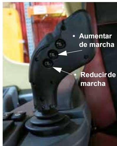
Interruptores para aumentar la marcha/reducir la marcha (ubicados en la parte posterior de la manilla de control de la transmisión hidrostática) -Vista típica.
