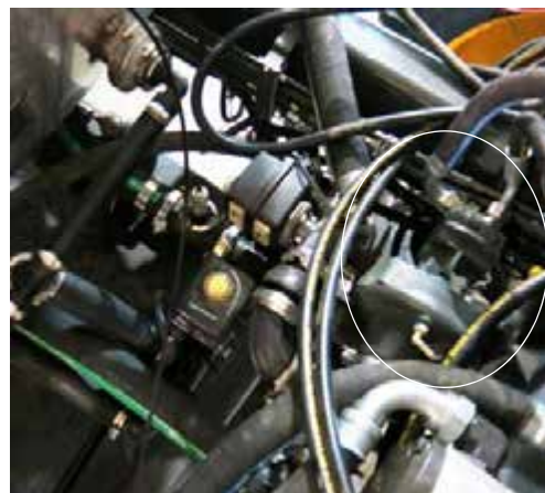
Bomba de solución (ubicada cerca del centro de la máquina) -Vista típica
