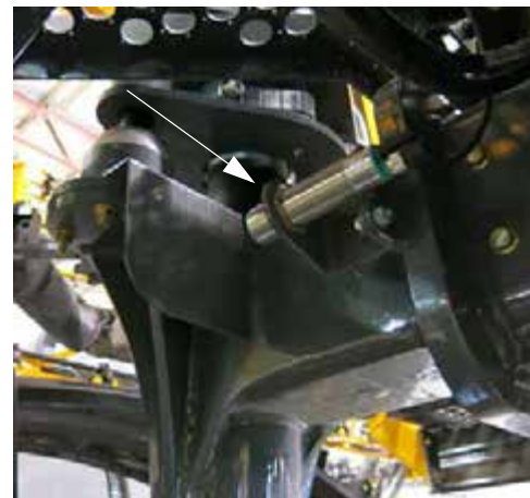
Sensor electrónico del ajuste de la distancia entre neumáticos (patas traseras) -Vista típica
