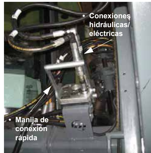
Conjunto del acoplador múltiple hidráulico/eléctrico - (si está instalado) (ubicado en la parte delantera izquierda de la máquina)
