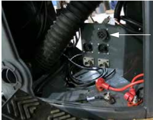
Puerto de diagnóstico del motor (ubicado dentro de la consola lateral, retire el panel frontal para su acceso) -Vista típica
