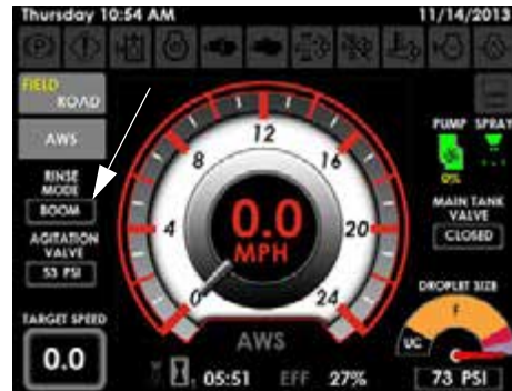
Indicador del modo de lavado (ubicado en la página principal de la pantalla de la máquina – modo de campo)
