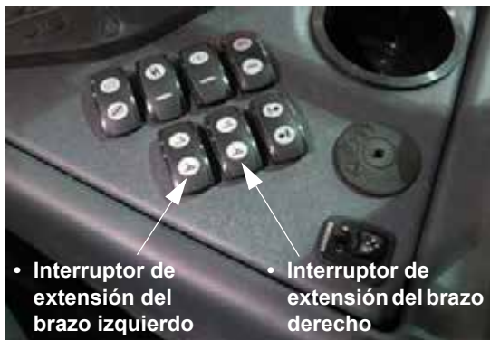
Interruptores de extensión del brazo izquierdo y derecho (ubicados en la consola lateral)
