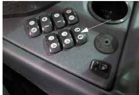
Interruptor del marcador de espuma (ubicado en la consola lateral) -Vista típica
