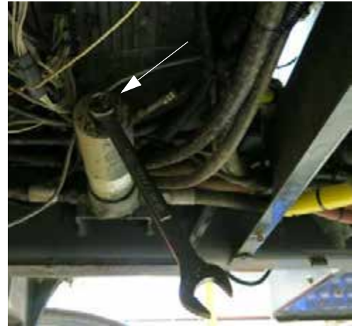
Carcasa del filtro de presión (ubicado debajo del lado derecho de la máquina; mueva hacia abajo el protector metálico para acceder) -Vista típica
