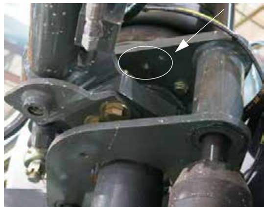
Engrasador tipo Zerk del collar (situado debajo de la placa de montaje de cada bolsa de aire) -Vista típica
