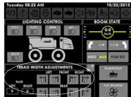
Indicadores/botones de ajuste de la distancia entre neumáticos (ubicados en la página de controles auxiliares)
