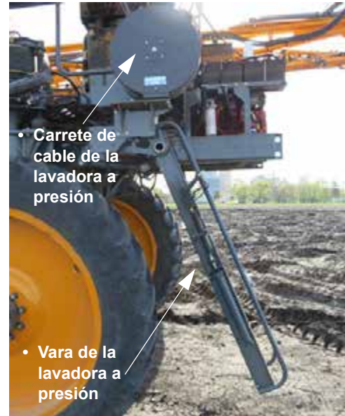
Conjunto del carrete de la manguera/vara de la lavadora a presión (ubicado cerca de la escalera en el lado izquierdo de la máquina) -Vista típica
