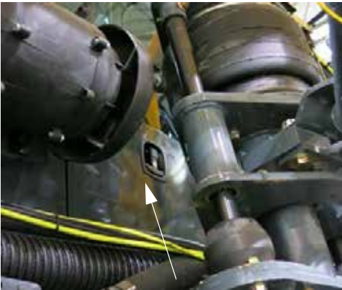
Panel de servicio exterior (situado en el lado derecho de la cabina) -Vista típica
