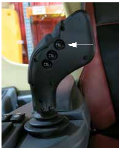
Interruptor de aspersión maestro (ubicado en la parte trasera de la manilla del control de la transmisión hidrostática) -Vista típica
