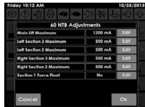
Pantalla de ajustes de la barra de herramienta de nitrógeno de 60 pies -Vista típica
