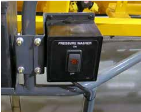
Interruptor de la lavadora a presión (ubicado junto al pasamanos en el lado izquierdo de la máquina) -Vista típica
