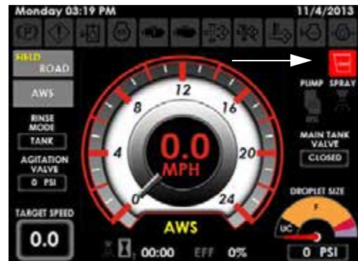
Indicador de presión de aire insuficiente en la cabina (ubicado en la página de inicio de la pantalla de la máquina - modo de carretera o campo)
