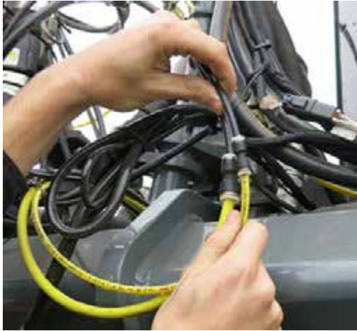
Conexión del marcador de espuma (situada en la parte delantera derecha de la máquina) -Vista típica
