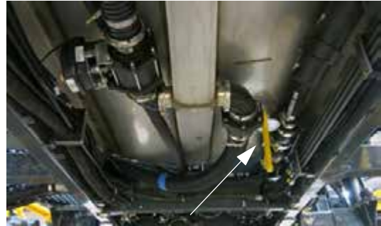
Válvula de sumidero -Vista típica
