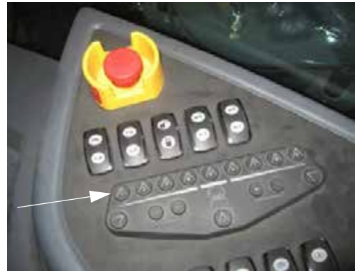
Interruptores de válvulas para mezcla en el brazo (ubicados en el lado de la consola) -Vista típica
