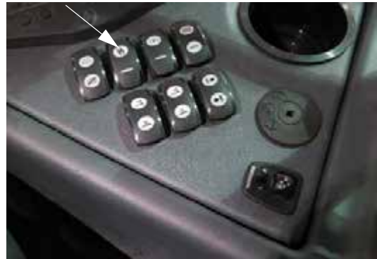
Interruptor de la bomba de la mezcla (ubicado en la consola lateral) -Vista típica
