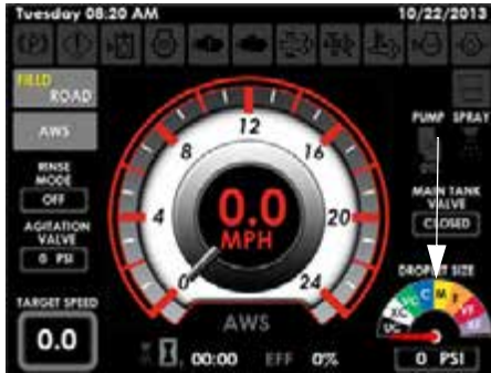
Indicador de tamaño de gota (ubicado en la página principal de la pantalla de la máquina - modo de campo)
