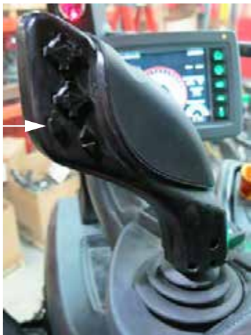
Interruptor de manejo de la hilera final (ubicado en la manilla de control de la transmisión hidrostática) -Vista típica
