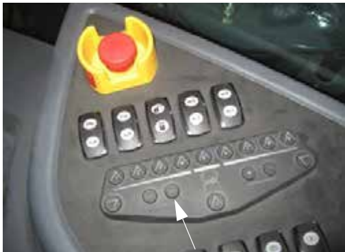
Interruptor manual (“MAN”) de control de tasa (ubicado en la consola lateral)
