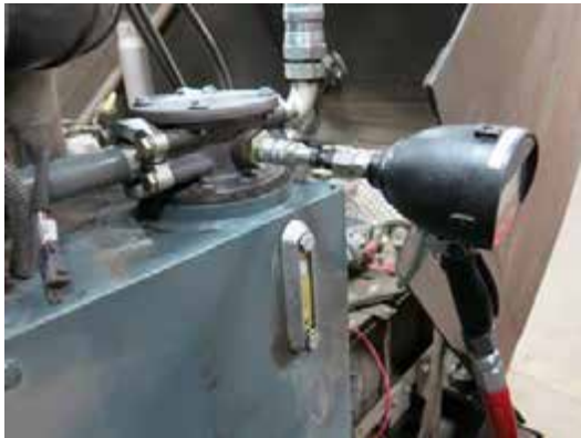
Llenar el depósito a través de la boca de llenado de aceite hidráulico -Vista típica
