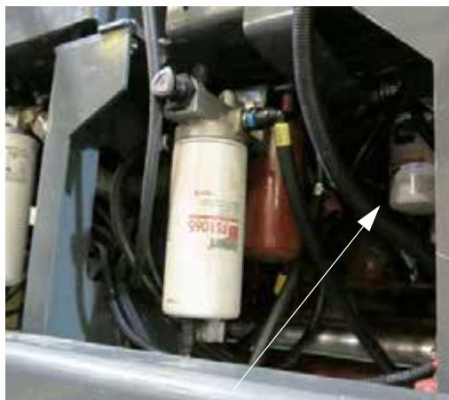
Motorolajszűrő (a gép bal oldala mentén van elhelyezve) – Tipikus nézet
