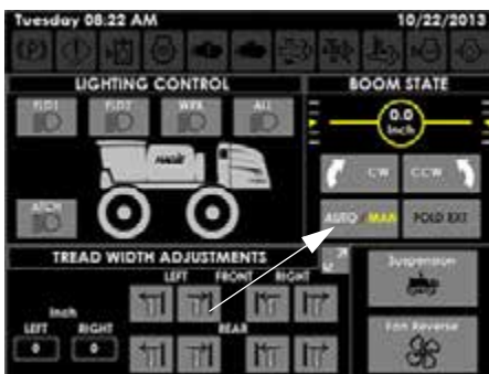
Gém állapot gomb - Automatikus/kézi (jobb kéz felőli oldalt a munkagép képernyőjének segédvezérlések oldalán)
