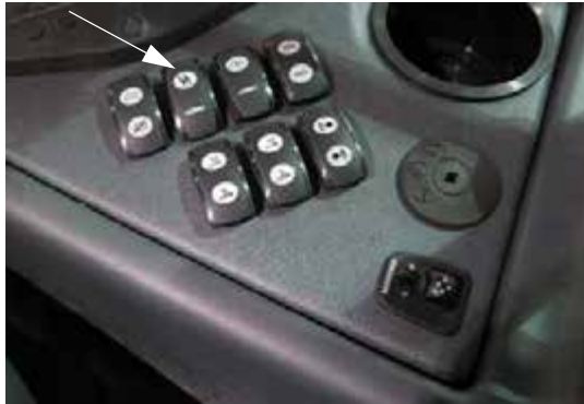
Permetlé szivattyú kapcsoló (oldalsó vezérlőpulton) – Tipikus nézet
