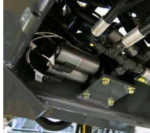
Elosztószelep (a gép alján) – Tipikus nézet
