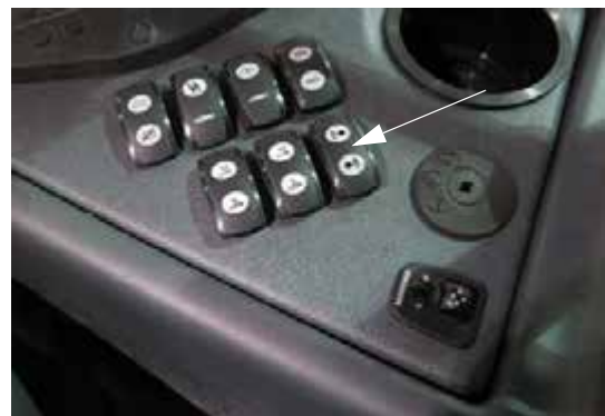
Habzás jelző kapcsoló (oldalsó vezérlőpulton) – Tipikus nézet
