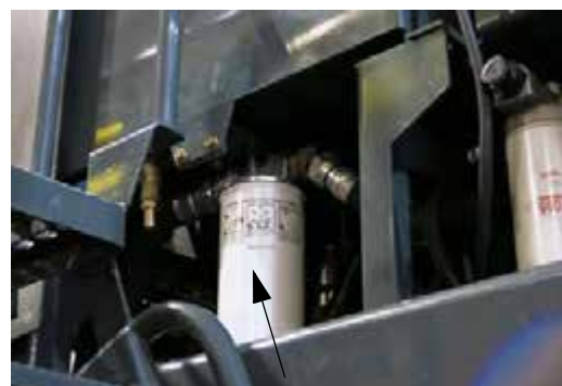
Tartály leeresztő szűrője (a gép bal oldalánál van elhelyezve) – Tipikus nézet
