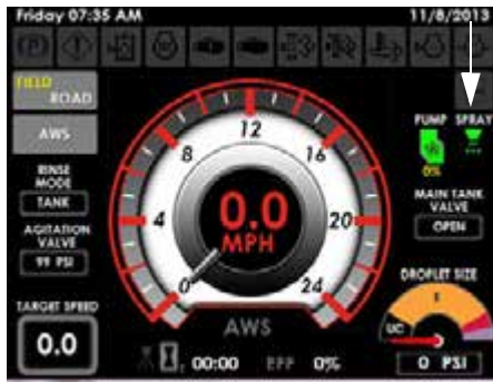
Elsődleges permetező kijelző (a gépezet kijelzőjének kezdő oldalán a felső jobb kéz felőli oldalt – Mezei üzemmód)
