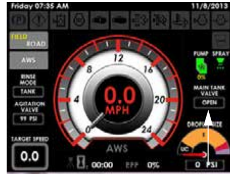
Főtartály szelep állapot kijelző (a gépezet kijelzőjének kezdő oldalán a jobb kéz felőli oldalt – Mezei üzemmód)
