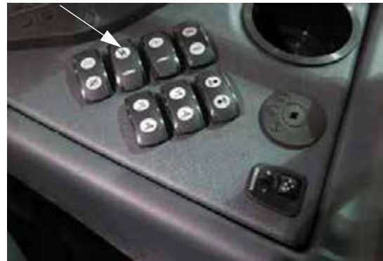
Permetlé szivattyú kapcsolója (oldalsó vezérlőpulton) – Tipikus nézet
