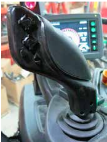
Hidrosztatikus hajtás vezérlőkarja (oldalsó vezérlőpulton) – Tipikus nézet
