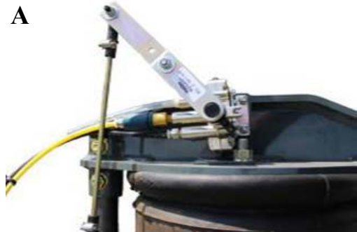
A Gyorsűrítő szelep (egy-egy szelep van elhelyezve minden egyes lábánál) – Tipikus nézet
