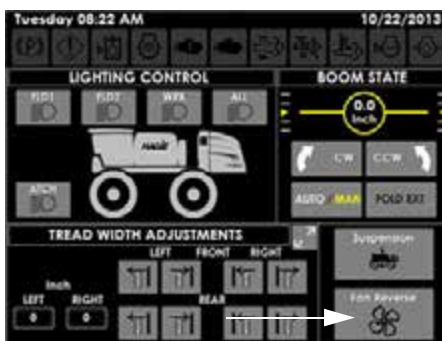
Változtatható forgásirányú ventilátor gomb (a Segédvezérlések oldalán)
