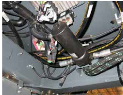
Nyomás szűrő (a gép jobb oldalán – a fém lemez levételével férhet hozzá) – Tipikus nézet
