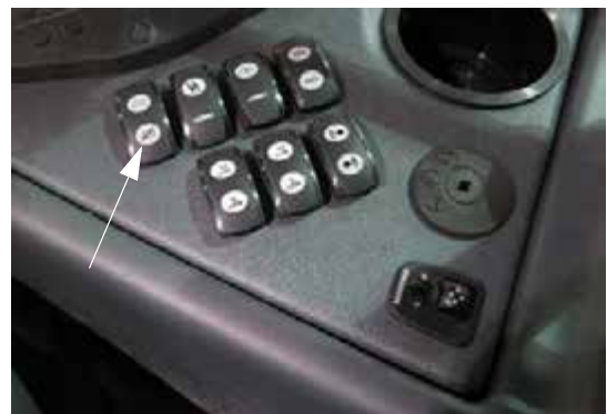
Főtartály szelep kapcsolója (oldalsó vezérlőpulton) - Tipikus nézet
