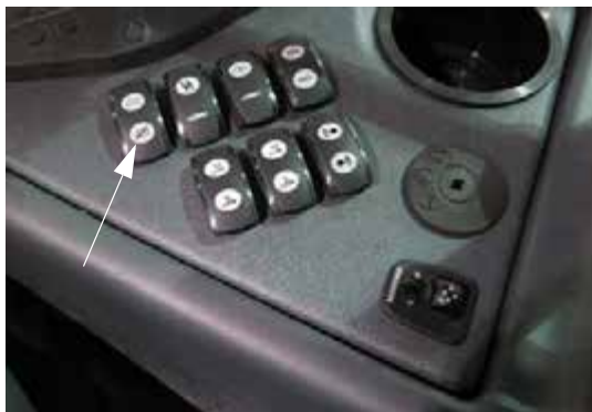
Főtartály szelep kapcsoló (oldalsó vezérlőpulton) – Tipikus nézet
