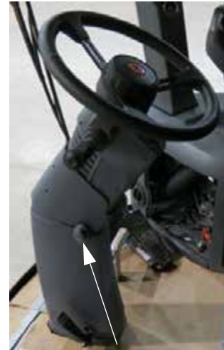
Kormánykerék dőlésszög állító gomb (a kormányoszlop balkéz felőli oldalán) – Tipikus nézet
