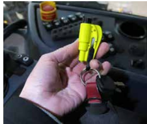
Vészhelyzeti üvegtörő eszköz (A kulcscsomóján található) -Tipikus nézet
