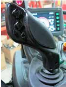
Hidrosztatikus hajtás vezérlőkar – Tipikus nézet
