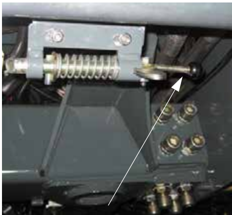
Elülső töltő kioldó kar (a gép elülső vége alatt van elhelyezve) – Tipikus nézet
