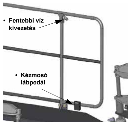
Fentebbi víz kivezetés/Kézmosó láb pedál (a gép bal oldalán, a lépcső korlát mentén) – Tipikus nézet
