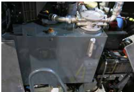
Hidraulika olaj tartály (a gép bal oldalánál van elhelyezve – a hozzáféréshez nyissa ki a motorháztetőt) – Tipikus nézet
