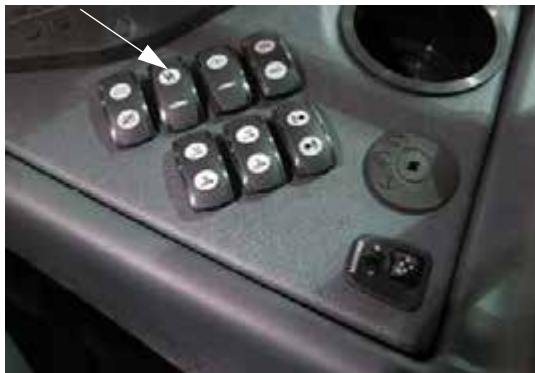
Permetlé szivattyú kapcsoló (oldalsó vezérlőpult) – Tipikus nézet
