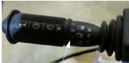
Ablaktörlő sebesség (az irányjelző kapcsolón) – Tipikus nézet
