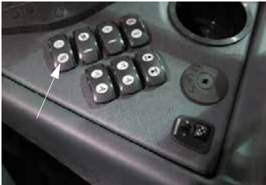
Főtartály szelep kapcsolója (oldalsó vezérlőpulton) – Tipikus nézet
