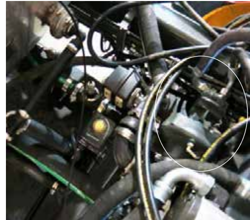
Permetlé szivattyú (közel a gépezet közepéhez) – Tipikus nézet
