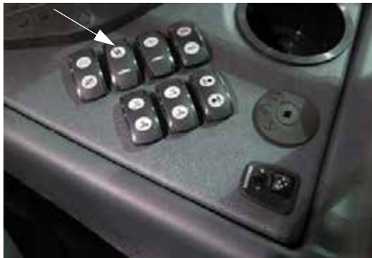
Permetlé szivattyú kapcsolója (oldalsó vezérlőpulton) – Tipikus nézet
