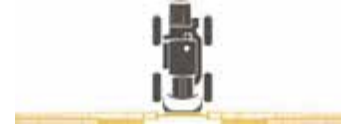
70-es permetezési szélesség behajtott gémparkokkal a 120/132-es szerelvények esetén
