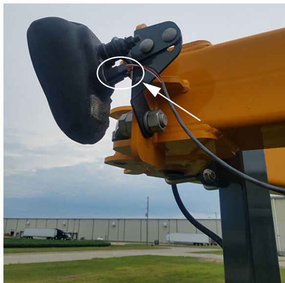
Fényszóró vezetékköteg csatlakozódugó - Szerelék nézet (A fényszóró szerelvény hátoldalán található) - Tipikus nézet
