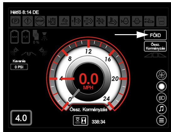
Mezei/Közúti üzemmód kapcsoló (munkagép képernyőjén - Nyitólap)
