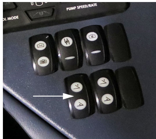
Spínač predlžovacích prvkov výložníka/ NTB (Nachádza sa na bočnej konzole) - Typický pohľad
