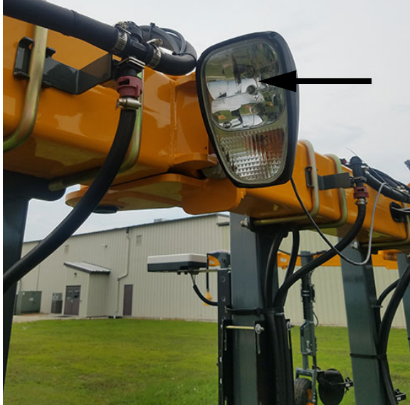
Cestné prevádzkové svetlo (2) (Namontované na každej strane lišty nástrojov) - Typický pohľad
