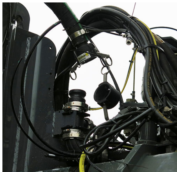
Pripojenie roztoku (Nachádza sa na prednej pravej strane stroja) - Typický pohľad
