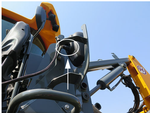
Konektor káblového zväzku predných svetlometov - Pohľad na stroj (Nachádza sa na zadnej strane zostavy predného svetlometu) - Typický pohľad
