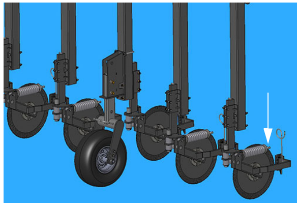
Nastavovacia matica (Nachádza sa na konci každej pružiny kotúčového krájadla) - Typický pohľad
