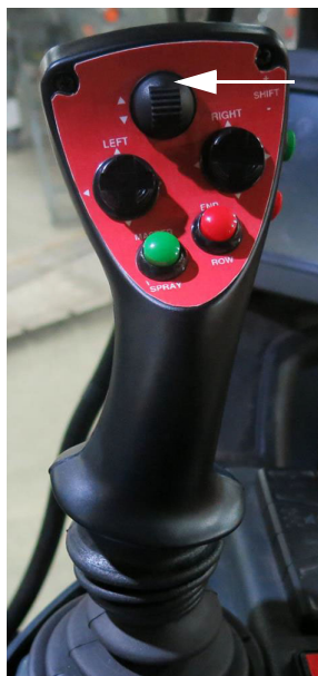
Spínač priečnika - HORE (Nachádza sa na radiacej páke hydrostatického pohonu) - Typický pohľad
