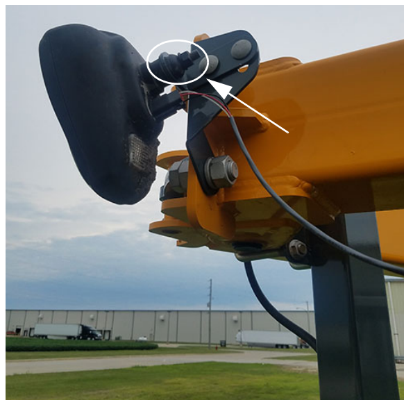
Montážna skrutka predného svetlometu (Nachádza sa na zadnej strane zostavy predného svetlometu) - Typický pohľad
