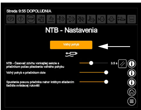
Tlačidlo Voľný pohyb (Nachádza sa na stránke Pomocné ovládacie prvky displeja stroja)
