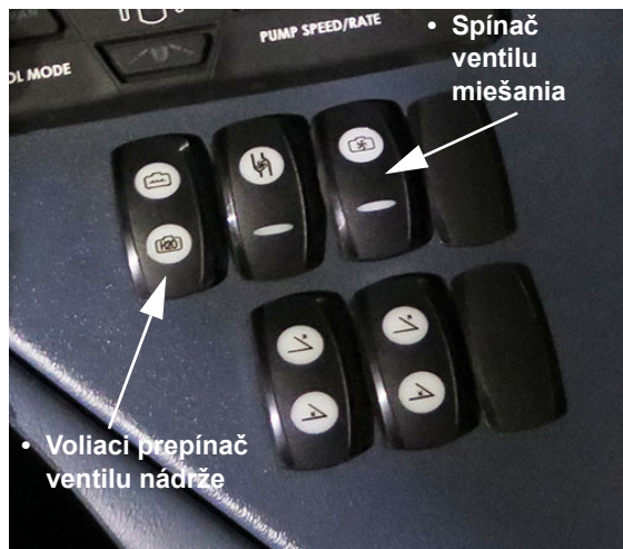
Voliaci prepínač ventilu nádrže a spínač ventilu miešania (Nachádza sa na bočnej konzole) - Typický pohľad
