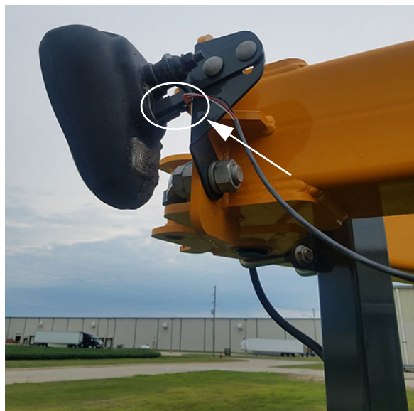
Konektor káblového zväzku predných svetlometov - Pohľad na prídavné zariadenie (Nachádza sa na zadnej strane zostavy predného svetlometu) - Typický pohľad
