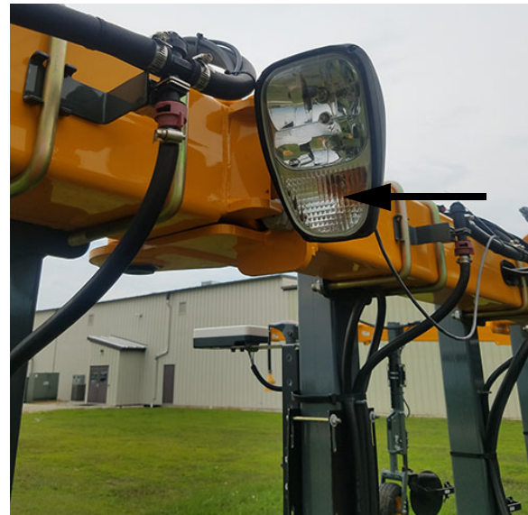
Výstražné svetlá (2) (Namontované na každej strane lišty nástrojov) - Typický pohľad
