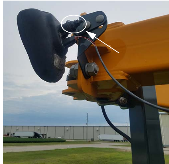
Fényszóró rögzítőcsavarok (A fényszóró szerelvény hátoldalán található) -Typical View
