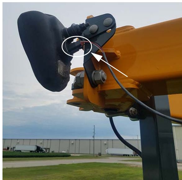
Fényszóró vezetékköteg csatlakozódugó - Szerelék nézet (A fényszóró szerelvény hátlapján található) - Tipikus nézet
