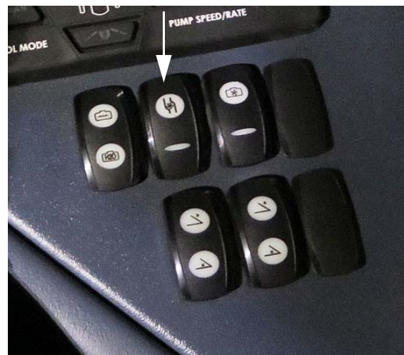
Permetlé szivattyú kapcsolója (oldalsó vezérlőpulton) - Tipikus nézet
