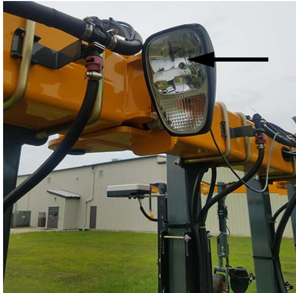
Közúti fényszóró (2) (A szerszámtartó rudazat két oldalára van szerelve) - Tipikus nézet
