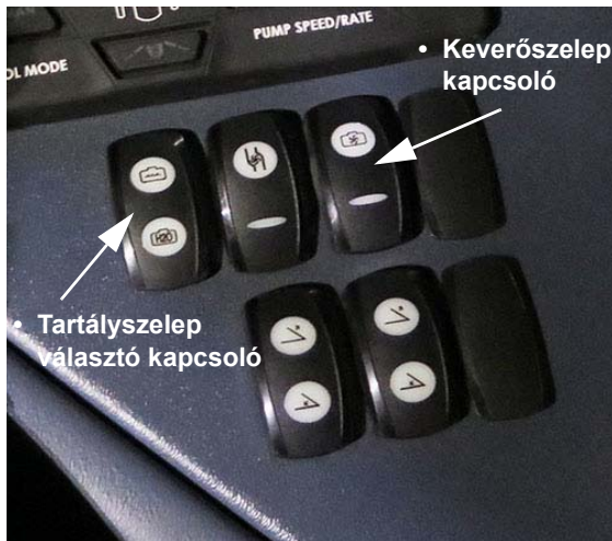
Tartályszelep választó és Keverőszelep kapcsoló (oldalsó vezérlőpulton) - Tipikus nézet
