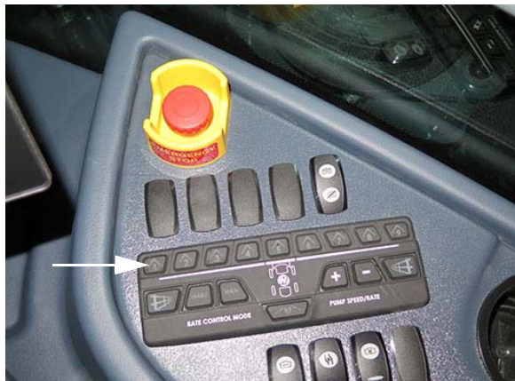
Gép permetlé szelep kapcsolók (oldalsó vezérlőpulton) - Tipikus nézet
