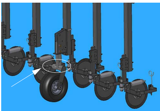
Emelő fogantyú (kaliber kerék felett) - Tipikus nézet
