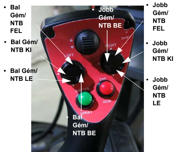
Bal és jobb gém/NTB kapcsolók (a hidrostatikus vezérlést irányító karon) - Tipikus nézet
