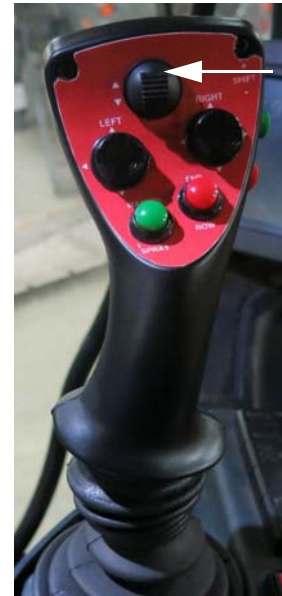
Támasztómű kapcsolója - FEL (a hidrostatikus vezérlést irányító karon) - Tipikus nézet
