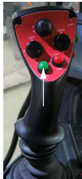
Elsődleges permetező kapcsoló (vezérlést irányító kar) - Tipikus nézet
