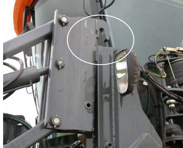
Szerelvény leválasztása a tartócsapról - Tipikus nézet
