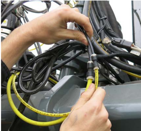
Habjelölő csatlakoztatása (elől a munkagép jobb oldalán) - Tipikus nézet
