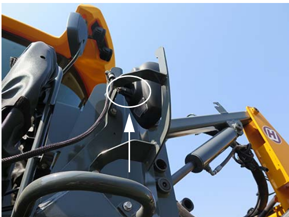
Fényszóró vezetékköteg csatlakozódugó - Gép nézet (A fényszóró szerelvény hátlapján található) - Tipikus nézet
