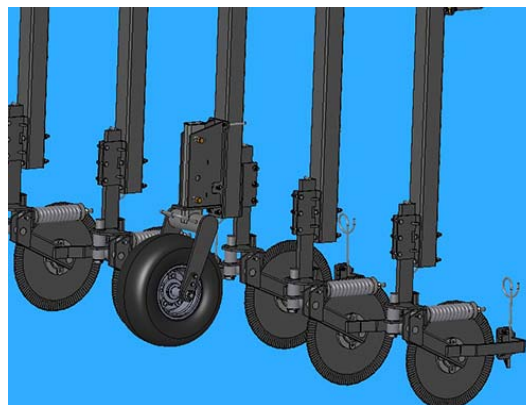
Kaliber kerék (mérőkerék) (a mezei helyzetet mutatja) - Tipikus nézet
