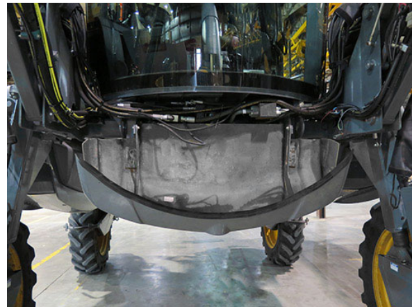
Tapa de cierre delantera (se muestra la posición bajada) -Vista típica
