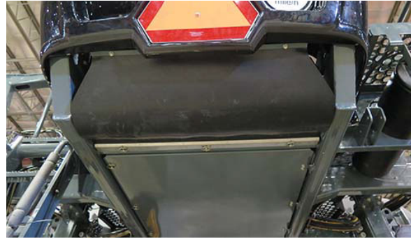
Instalación de cortina de escobillas -Vista típica
