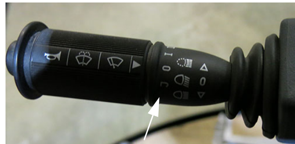
Velocidades del limpiaparabrisas (ubicadas en la palanca de luces direccionales) -Vista típica
