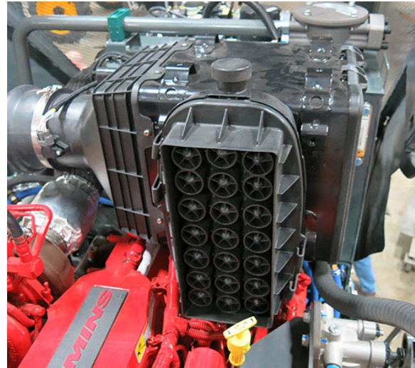
Filtro de admisión de aire del motor filtro (ubicado a lo largo de la plataforma en el lado izquierdo de la máquina - abra el capó para tener acceso) -Vista típica
