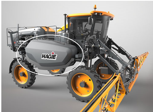
Tanque de solución -Vista típica
