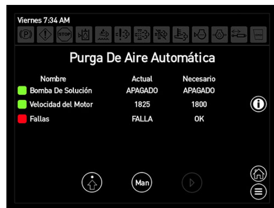
Pantalla Purga de aire (automática)
