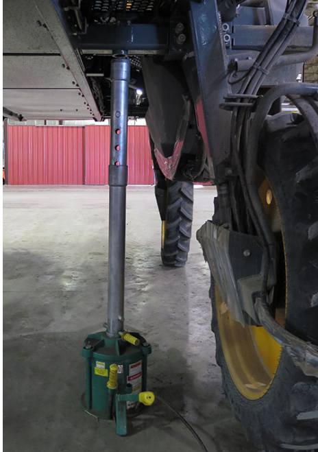
Alinee el gato con el anillo de guía del punto de elevación -Vista típica
