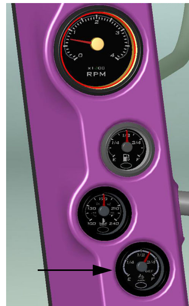
Medidor del DEF (ubicado en el poste A de la cabina) -Vista típica
