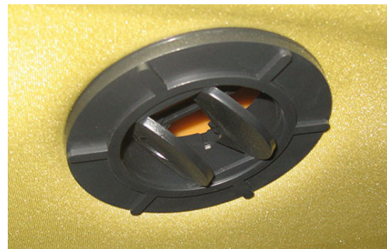
Conducto de ventilación de cabina -Vista típica
