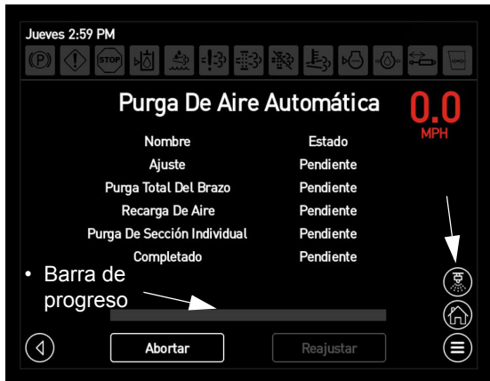
Pantalla Purga de aire automática – Ciclo automático
