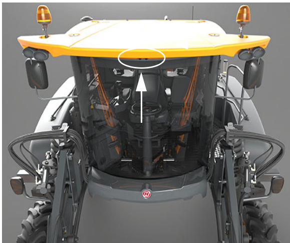
Boquilla de pulverización del líquido del lavaparabrisas (ubicada cerca de la parte superior de la cabina exterior) -Vista típica
