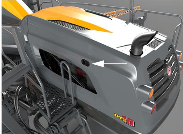
Visor del depósito de aceite hidráulico (ubicado cerca de la parte trasera izquierda de la máquina) -Vista típica
