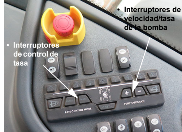
Interruptores de control de tasa y velocidad/tasa de la bomba (ubicados en la consola lateral) - Vista típica
