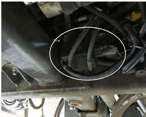
Colector de válvulas (ubicado en la parte inferior de la máquina) -Vista típica
