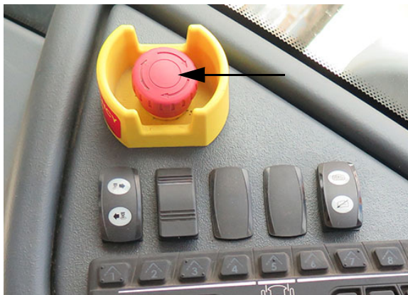
Interruptor de parada de emergencia (ubicado en la consola lateral) -Vista típica
