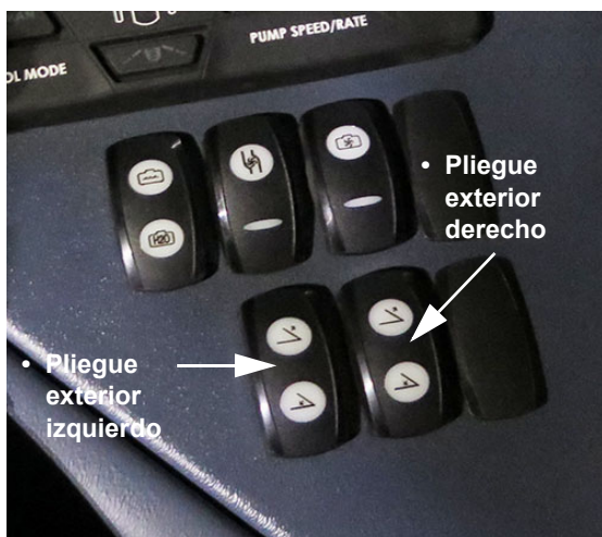
Interruptores de extensión del brazo – Izquierdo/derecho (ubicados en la consola lateral) - Vista típica
