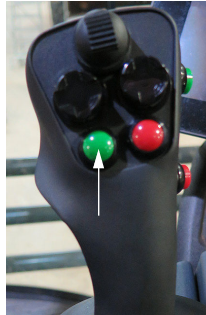
Interruptor de aspersión principal (ubicado en la parte posterior de la manilla de control de la transmisión hidrostática)
