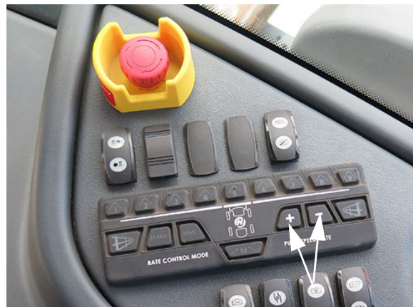
Interruptores de tasa/velocidad de la bomba (ubicados en la consola lateral) -Vista típica
