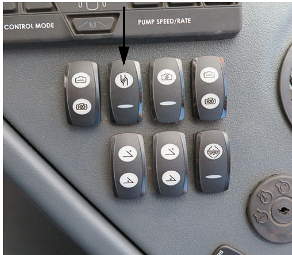
Interruptor de la bomba de solución (ubicado en el lateral de la consola lateral) -Vista típica
