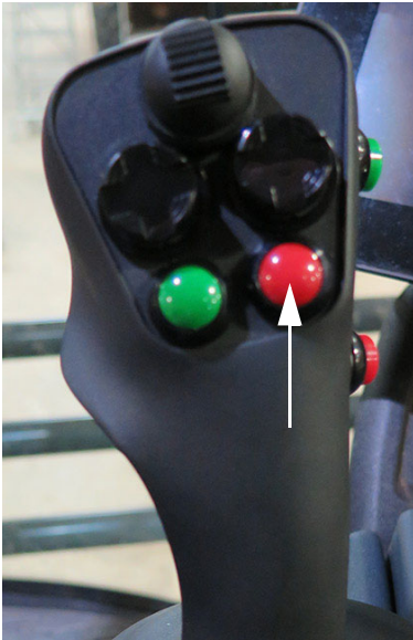
Interruptor de manejo de la última hilera (ubicado en la manilla de control de la transmisión hidrostática) -Vista típica
