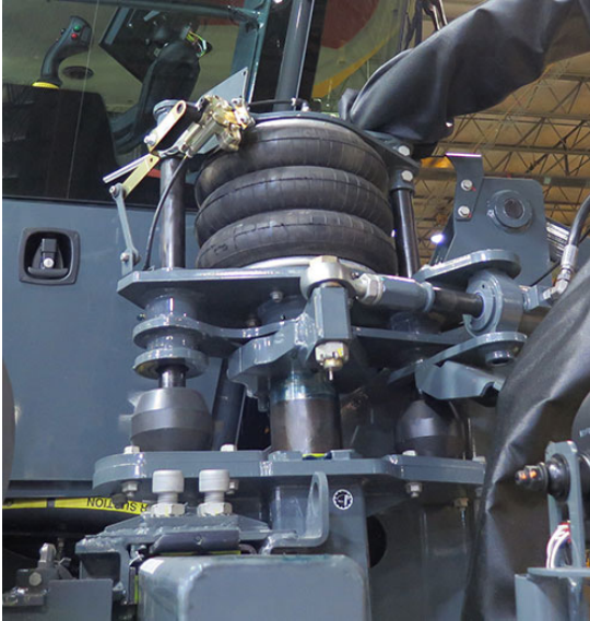
Bolsa de aire (ubicada en cada pata) -Vista típica
