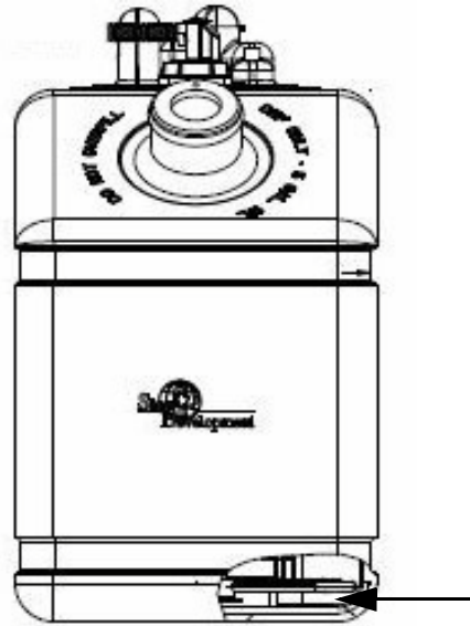
Tamiz de succión de DEF (ubicado cerca del fondo del depósito de DEF) -Vista típica
