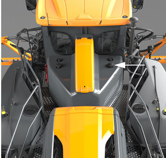
Tapa de llenado de combustible (ubicada en la parte superior del módulo de enjuague de combustible) -Vista típica
