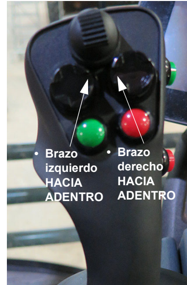
Interruptores de los brazos izquierdo y derecho (ubicados en la manilla de control de la transmisión hidrostática) - Vista típica
