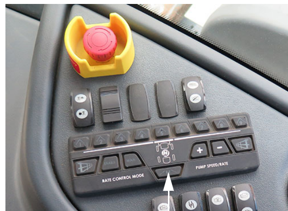
Interruptor de las boquillas traseras (ubicado en la consola lateral) -Vista típica
