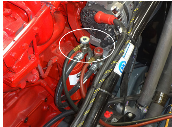
Puertos de carga del sistema de aire acondicionado (ubicados en el lado derecho del motor) -Vista típica
