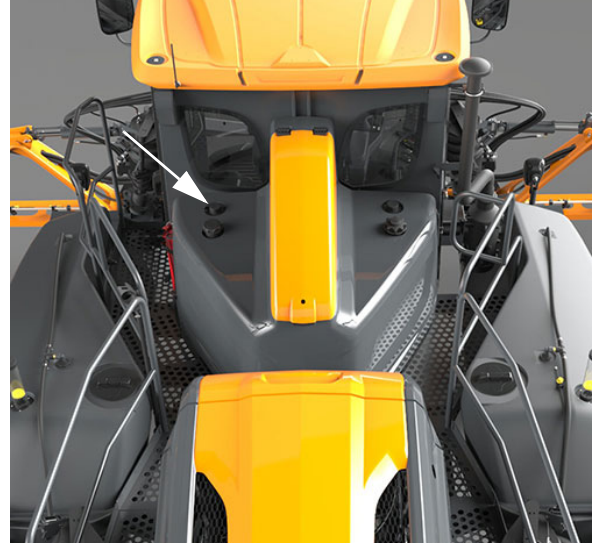
Punto de llenado del depósito del marcador de espuma (ubicado en el lado anterior izquierdo del módulo de lavado de combustible - "FRM") -Vista típica
