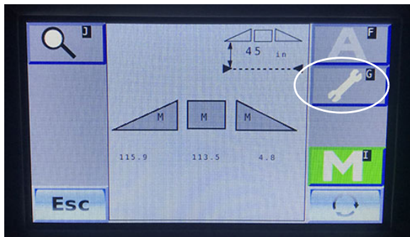
Botón Ajustes (ubicado en la “Pantalla de ejecución” principal) - Vista típica
