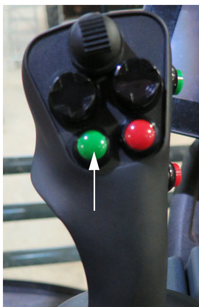
Interruptor de aspersión principal (ubicado en la manilla de control de la transmisión hidrostática) - Vista típica
