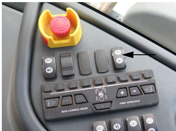
Interruptor de lavado de los tanques (ubicado en la consola lateral) - Vista típica
