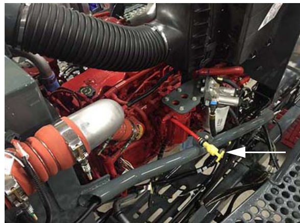
Varilla de nivel de aceite del motor (ubicada en el lado izquierdo del motor a través de la abertura de acceso para servicio)
