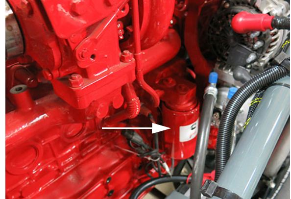
Filtro de aceite del motor (ubicado en la parte izquierda de la abertura de acceso de paso al motor) -Vista típica
