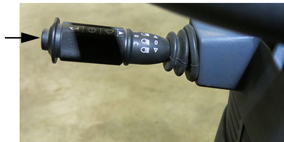
Botón de la bocina (ubicado en el extremo final de la palanca de luces direccionales) -Vista típica
