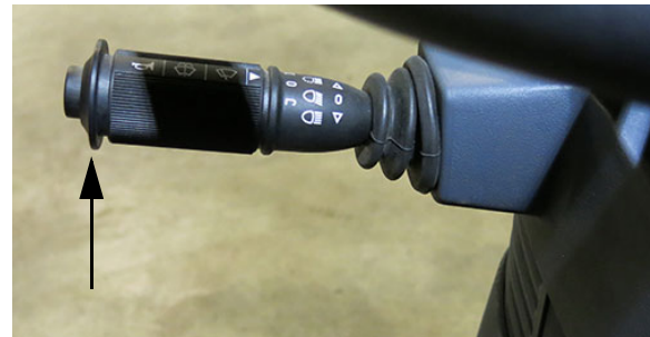
Botón del lavapabrisas (ubicado en el extremo final de la palanca de luces direccionales) -Vista típica
