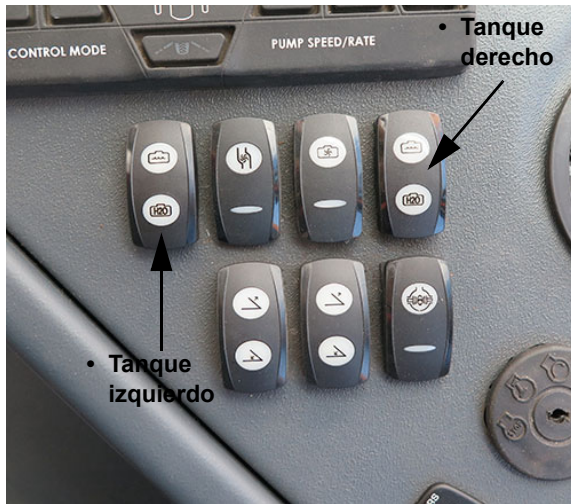
Interruptores selectores de las válvulas de los tanques (izquierdo/derecho) (ubicados en la consola lateral) -Vista típica
