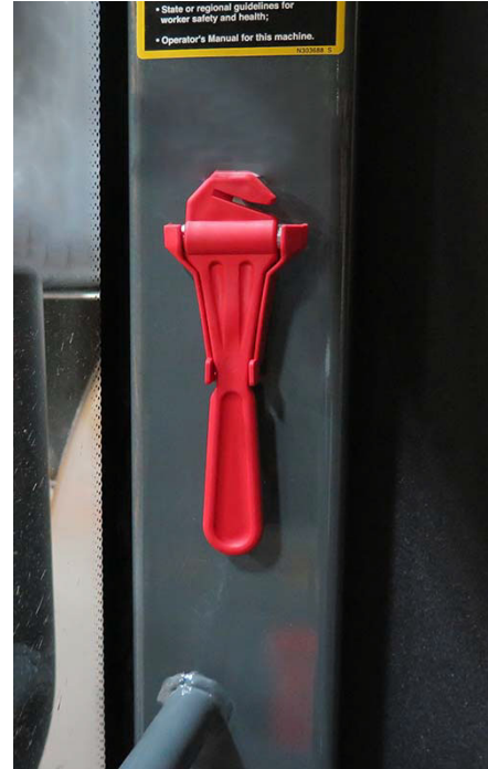
Herramienta de salida de emergencia (ubicada en la parte trasera derecha de la cabina) -Vista típica
