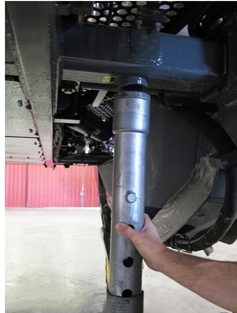
Inserte el gato en el anillo de guía del punto de elevación -Vista típica
