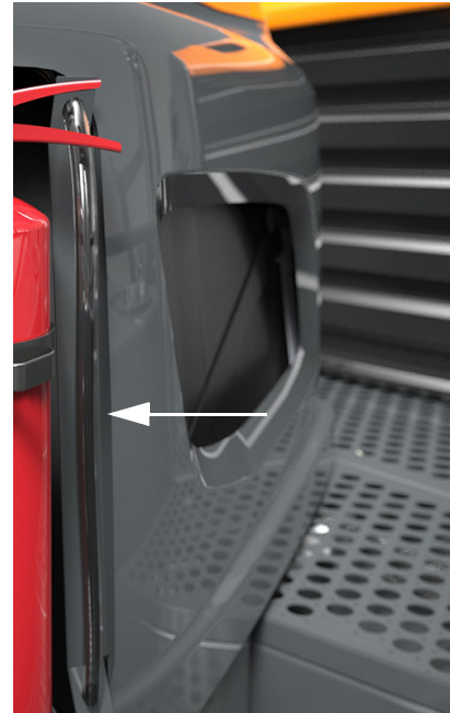
Visor del tanque de lavado (ubicado a un lado del tanque de lavado) -Vista típica
