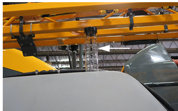
Visor del tanque de solución (2) (ubicado en la parte superior de cada tanque de solución) -Vista típica
