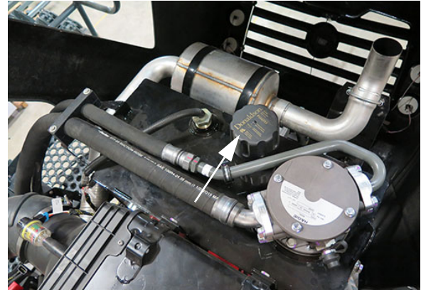
Tapón del tanque con respiradero (ubicado en la parte superior del depósito de aceite hidráulico - abra el capó para tener acceso) -Vista típica
