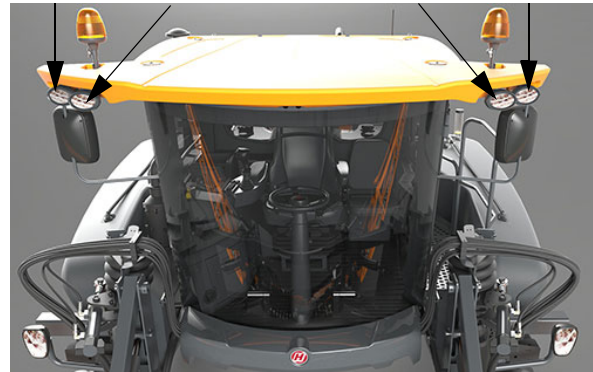
Luces de campo (ubicadas en la parte delantera de la cabina) -Vista típica
