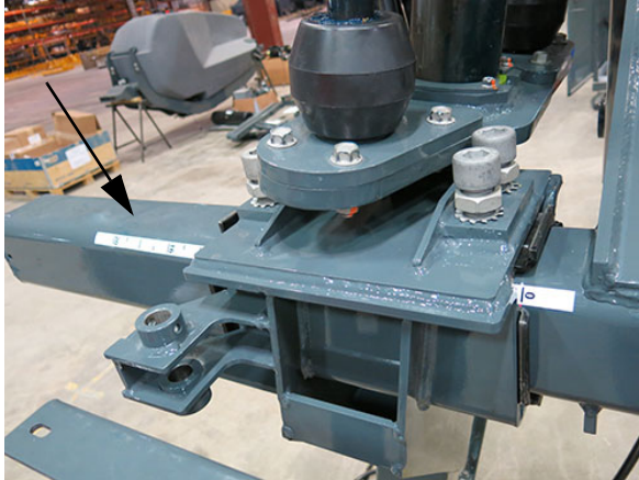
Corredera deslizante de ajuste de la distancia entre neumáticos (ubicada en cada pata) - Vista típica
