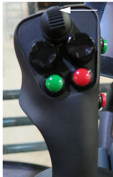
Interruptor del travesaño – HACIA ARRIBA (ubicado en la manilla de control de la transmisión hidrostática) - Vista típica
