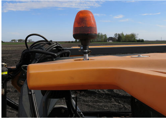
Faro giratorio (ubicado en la parte delantera del techo de la cabina) -Vista típica
