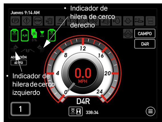
Indicadores de hilera de cerco – izquierdo/derecho (ubicados en la página principal de la pantalla de la máquina – modo de campo)
