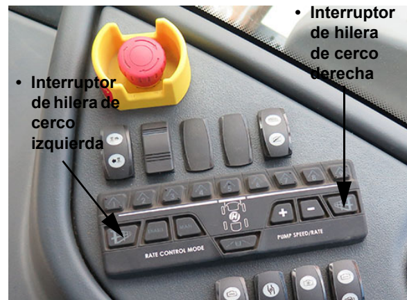
Interruptores de hilera de cerco - derecha e izquierda (ubicados en la consola lateral) -Vista típica
