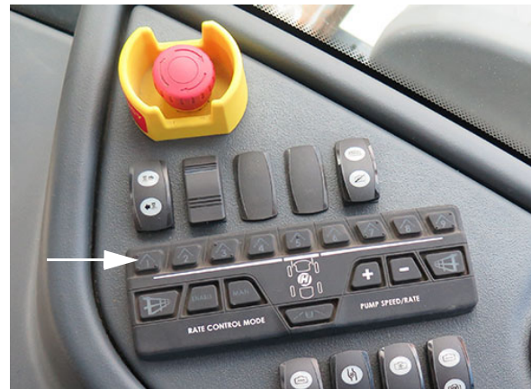
Interruptores de la válvula de solución del brazo (ubicados en la consola lateral) -Vista típica
