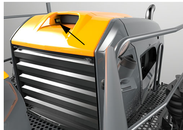
Interruptor del actuador del capó (ubicado delante del capó por encima de la rejilla del radiador) -Vista típica
