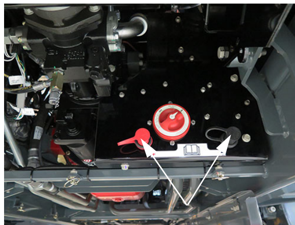
Bornes de carga auxiliar de la batería (ubicados en la parte posterior del chasis principal) -Vista típica
