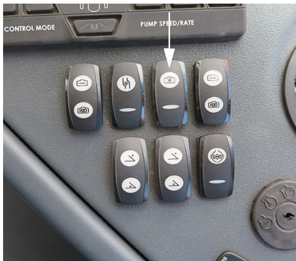
Interruptor de válvula de agitación (ubicado en la consola lateral) -Vista típica
