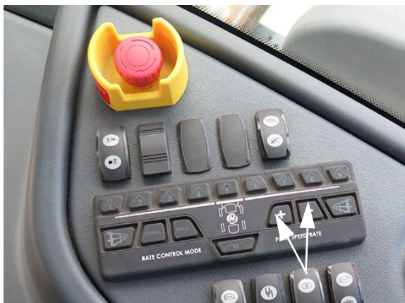
Interruptores de velocidad/tasa de la bomba (ubicados en la consola lateral) -Vista lateral
