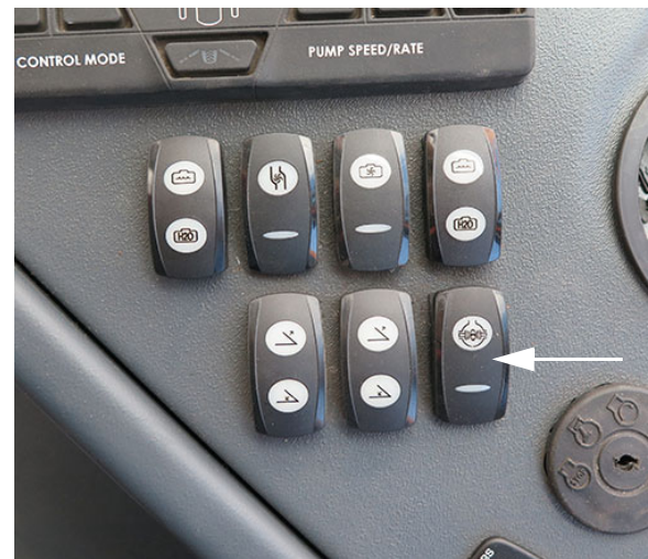
Interruptor de la válvula de tracción (ubicado en la consola lateral) -Vista típica
