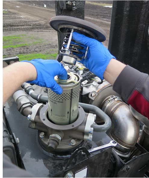
Filtro de retorno (ubicado dentro de la carcasa del filtro) -Vista típica
