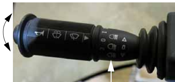
Luces altas (ubicadas en la palanca de las luces direccionales) -Vista típica
