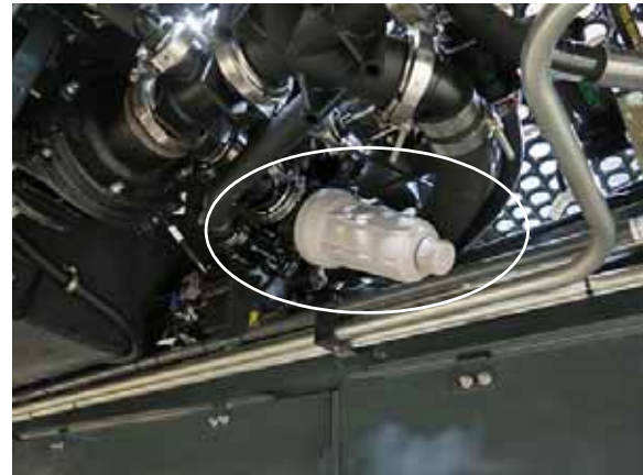
Tamiz de la tubería de solución (ubicado debajo del centro de la máquina) -Vista típica
