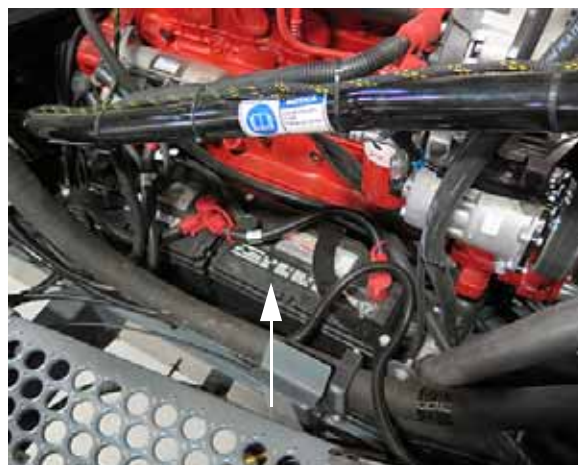
Baterías (ubicadas en el lado posterior derecho de la máquina) - Vista típica
