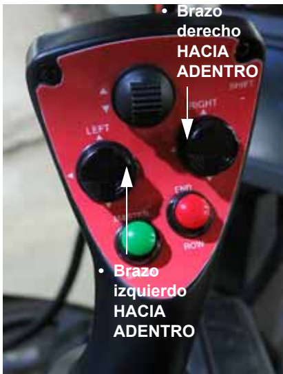
Interruptores de los brazos izquierdo y derecho (ubicados en la manilla de control de la transmisión hidrostática) - Vista típica
