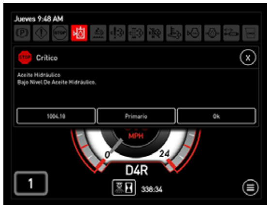
Mensaje de advertencia de bajo nivel de aceite hidráulico (en la pantalla de la máquina)
