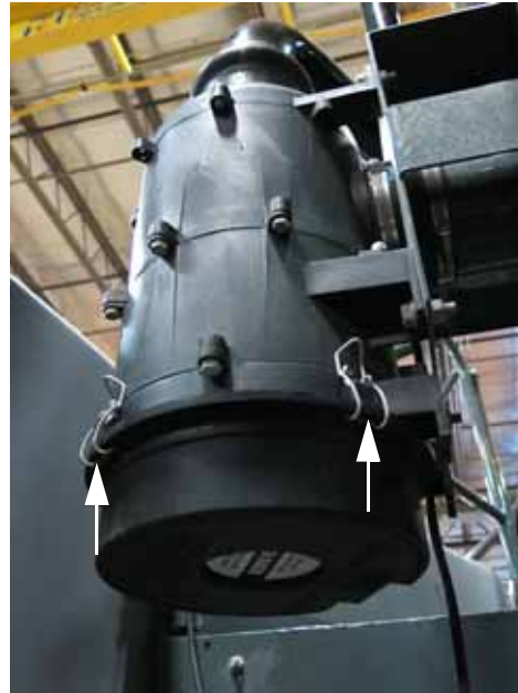
Retenes del filtro -Vista típica
