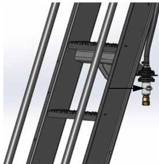
Válvula del lavado de manos (escalera) - Vista típica
