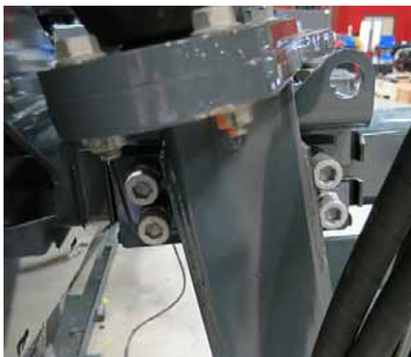
Pernos de fijación del ajuste de la distancia entre neumáticos - superior/lateral (ubicados en cada pata) -Vista típica
