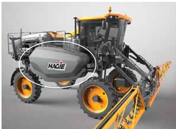
Tanque de solución -Vista típica
