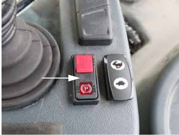
Interruptor del freno de estacionamiento (ubicado cerca de la manilla de control de la transmisión hidrostática) -Vista típica
