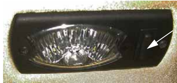
Interruptor de luz interior de trabajo -Vista típica
