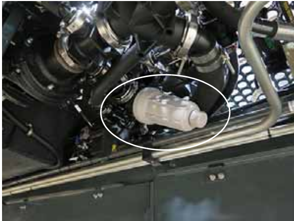
Tamiz de la línea de solución (ubicado debajo del centro de la máquina) -Vista típica
