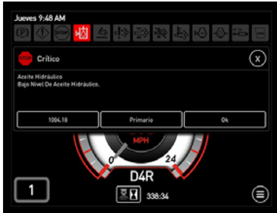
Mensaje de advertencia: Bajo nivel de aceite hidráulico (ubicado en la pantalla de la máquina)
