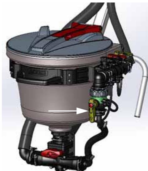
Válvula de venturi (ubicada en el lateral del tanque eductor) - Vista típica
