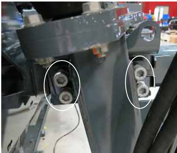
Pernos de los cojinetes de ajuste de la distancia entre neumáticos (ubicados en cada pata) - Vista típica
