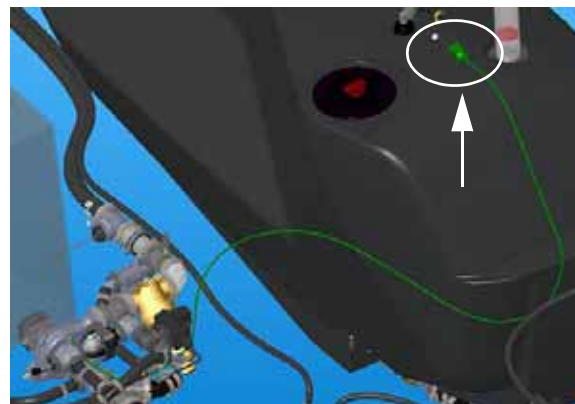
Línea de ventilación/válvula de retención de la bomba de solución -Vista típica
