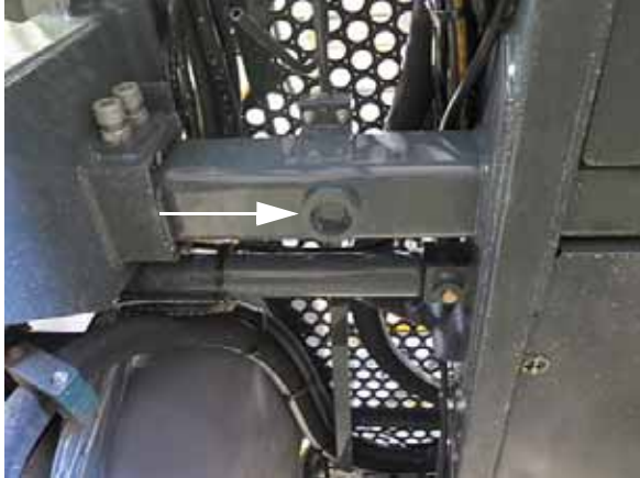
Anillo de contención del punto de elevación (ubicado en el bastidor cerca de cada pata) -Vista típica
