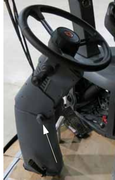
Botón de ajuste de inclinación de la columna de dirección (ubicado en el lado izquierdo de la columna de dirección) -Vista típica
