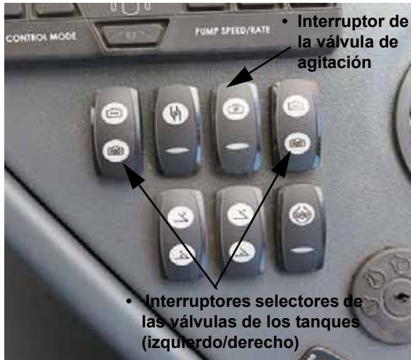
Interruptores selectores de las válvulas de los tanques/Interruptor de la válvula de agitación (ubicados en la consola lateral) - Vista típica
