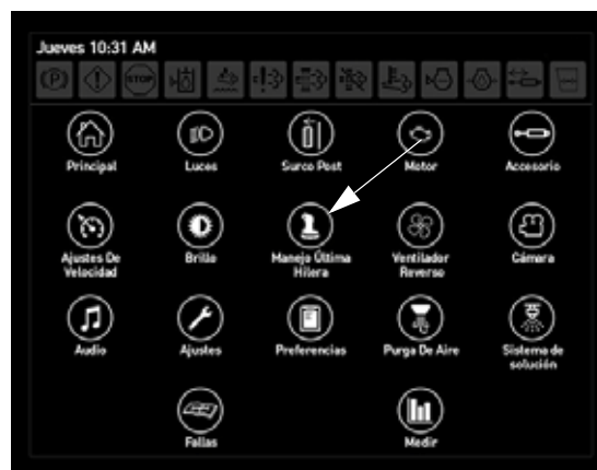
Botón Manejo de la última hilera (ubicado en la página del menú principal)
