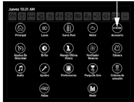
Botón Accesorio (ubicado en la página del menú principal de la pantalla de la máquina)
