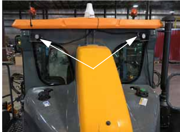
Luces de aspersión nocturna (2) (ubicadas en la parte trasera de la cabina) -Vista típica
