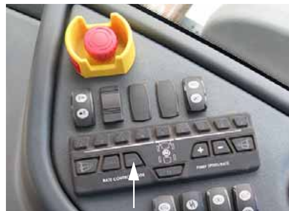
Interruptor manual (“MAN”) de control de tasa (ubicado en la consola lateral) -Vista típica
