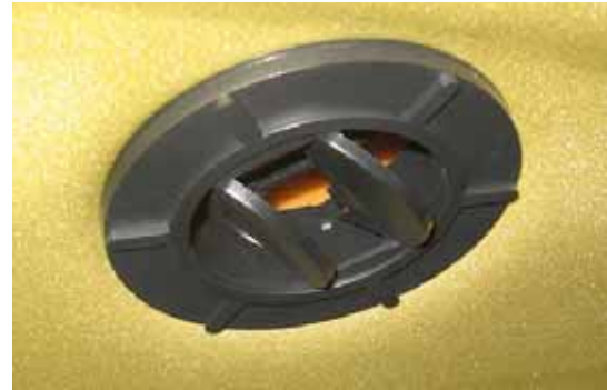
Conducto de ventilación de cabina -Vista típica
