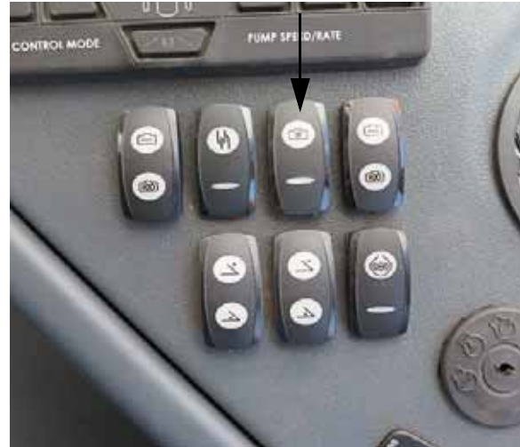
Interruptor de la válvula de agitación (ubicado en la consola lateral) -Vista típica
