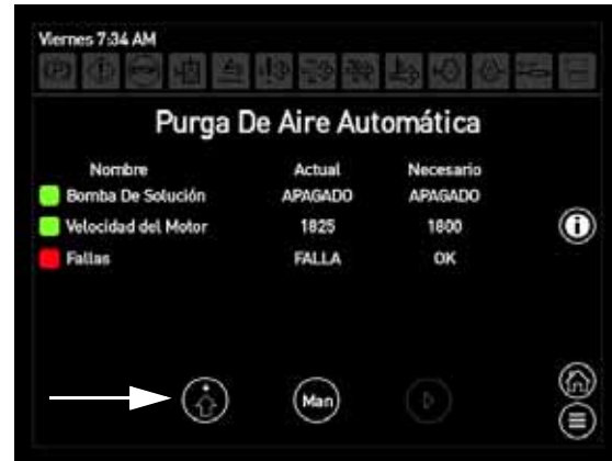
Botón Ajustes (ubicado en la pantalla Purga de aire automática)
