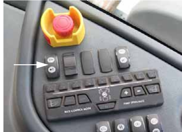
Interruptor del marcador de espuma (ubicado en la consola lateral) -Vista típica
