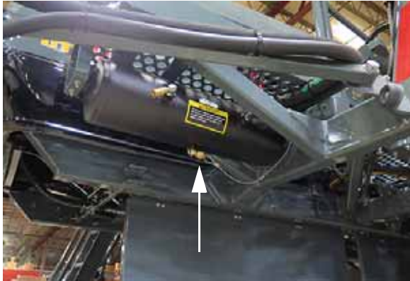
Válvula de drenaje del tanque (principal) (ubicada debajo de la plataforma en el lado trasero derecho de la máquina) * Hale HACIA ABAJO para abrir -Vista típica
