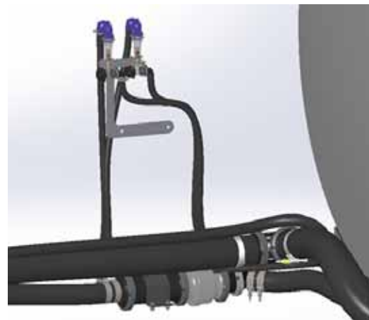
Indicadores de flujo (ubicados en el lado exterior derecho de la cabina) -Vista típica
