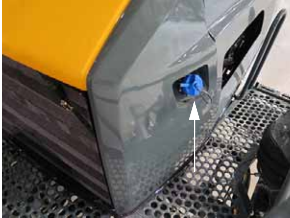
Tapa de llenado de DEF (ubicada cerca del fondo del depósito de DEF) -Vista típica
