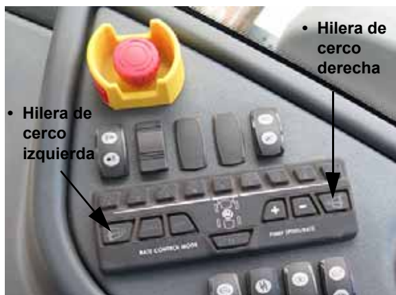
Interruptores de hilera de cerco - Izquierda/derecha (ubicados en la consola lateral) -Vista típica
