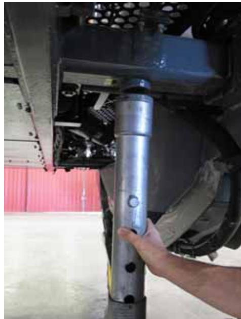
Inserte el gato en el anillo de guía del punto de elevación -Vista típica
