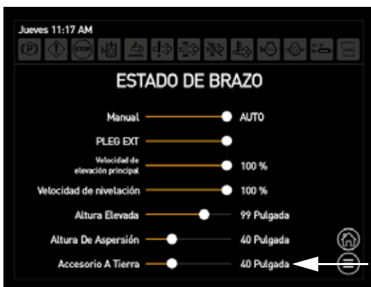
Altura desde el accesorio al piso (ubicada en la pantalla Estado del brazo)
