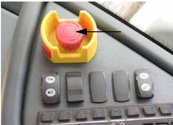
Interruptor de parada de emergencia (ubicado en la consola lateral) -Vista típica
