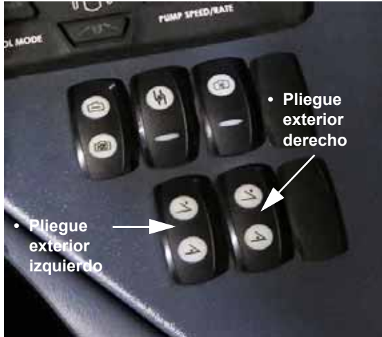
Interruptores de extensión del brazo – Izquierdo/derecho (ubicados en la consola lateral) - Vista típica
