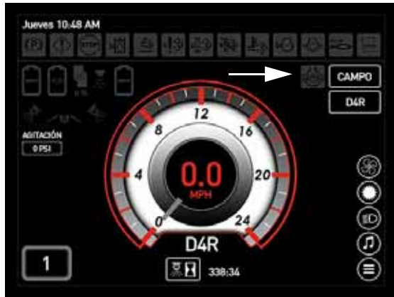
Indicador de válvula de tracción (ubicado en la página principal de la pantalla de la máquina – modo de carretera y campo) -Vista típica
