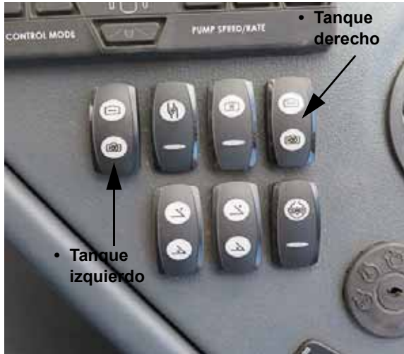
Interruptores selectores de las válvulas de los tanques (izquierdo/derecho) (ubicados en la consola lateral) -Vista típica
