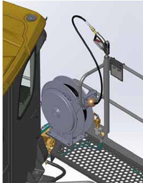
Vara y carrete de manguera de la lavadora a presión (ubicados detrás del lado derecho de la cabina) - Vista típica
