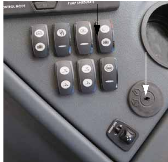
Interruptor de encendido (ubicado en la consola lateral) -Vista típica
