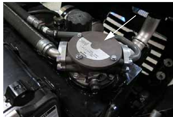
Carcasa del filtro de retorno (ubicada en la parte superior del depósito de aceite hidráulico - abra el capó para tener acceso) -Vista típica
