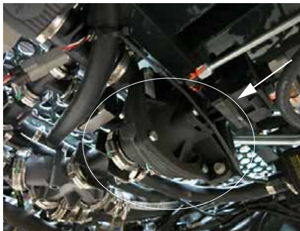
Bomba de solución (ubicada debajo del centro de la máquina) -Vista típica
