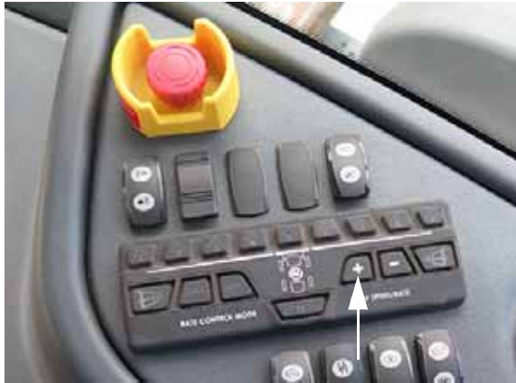
Interruptor de tasa/velocidad de la bomba “+” (ubicado en la consola lateral) -Vista típica
