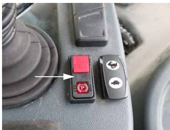
Interruptor del freno de estacionamiento (ubicado cerca de la manilla de control de la transmisión hidrostática)
