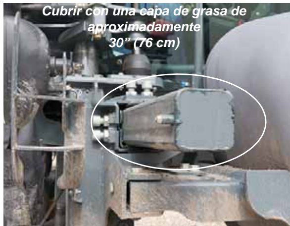
Corredera deslizante de los cojinetes de ajuste de la distancia entre neumáticos (4) (ubicada en cada pata) - Vista típica
