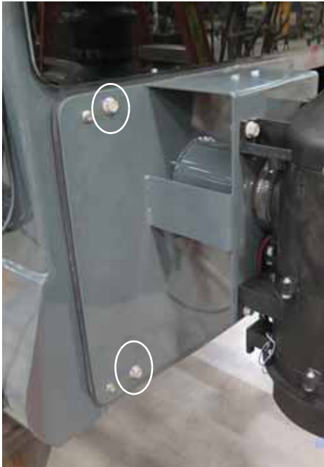
Pernos de montaje (4) (Dos ubicados a cada lado del tablero de acceso del lado derecho de la cabina) -Vista típica
