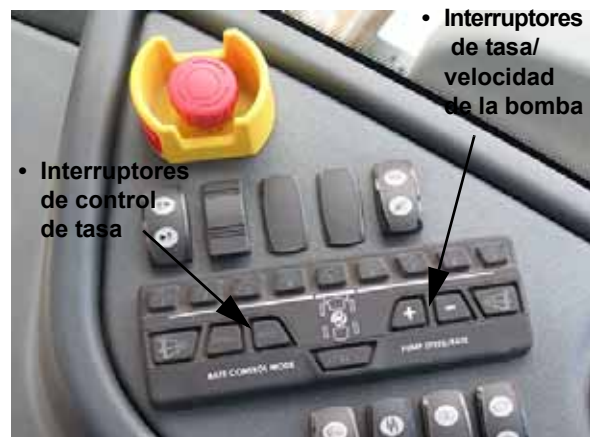
Interruptores de control de tasa de tasa/ velocidad de la bomba (ubicados en la consola lateral) -Vista típica
