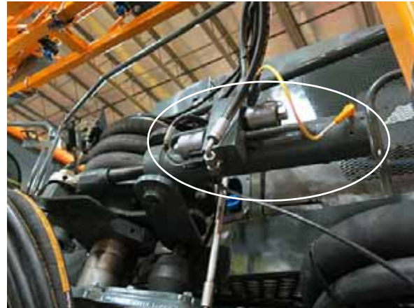
Cilindro de dirección (ubicado en las patas traseras) -Vista típica
