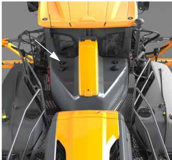
Punto de llenado del depósito del marcador de espuma (ubicado en el lado anterior izquierdo del módulo de lavado de combustible - "FRM") -Vista típica
