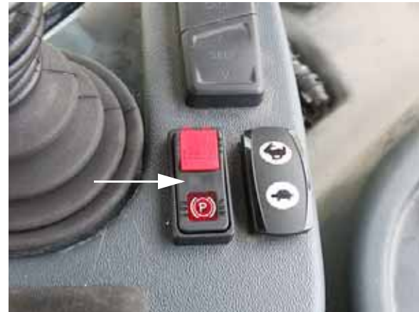
Interruptor del freno de estacionamiento (ubicado cerca la manilla de control de la transmisión hidrostática) -Vista típica
