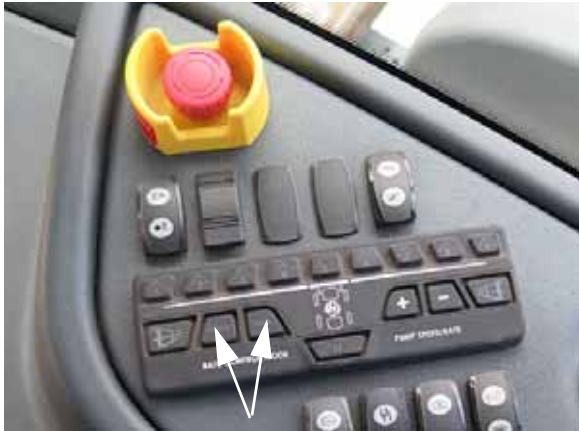
Interruptores de control de tasa (ubicados en la consola lateral) -Vista típica
