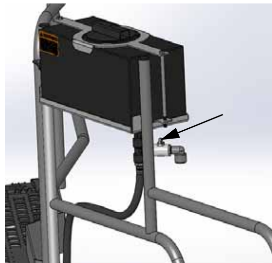
Válvula del lavado de manos (pasamanos del lado izquierdo de la plataforma) - Vista típica
