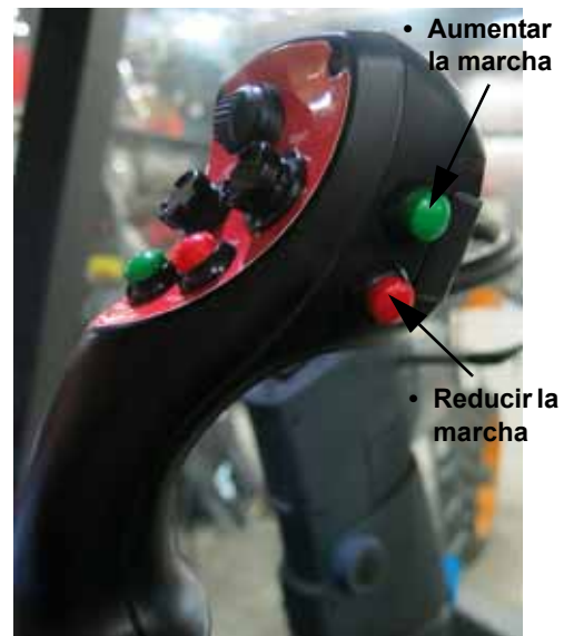
Interruptores para aumentar la marcha/reducir la marcha (ubicados a un lado de la manilla de control de la transmisión hidrostática) -Vista típica
