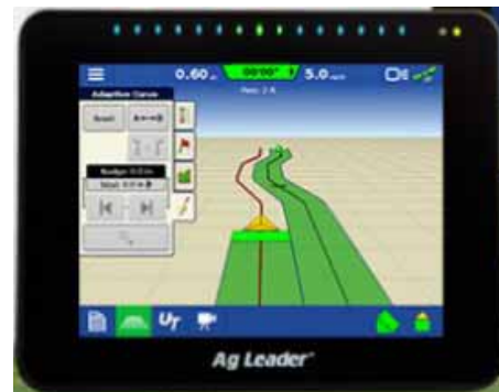
Consola del sistema de aspersión -Vista típica
