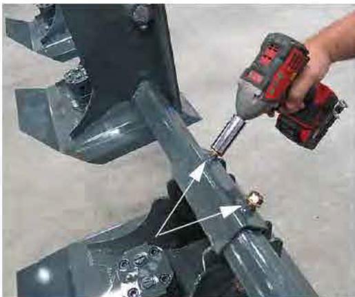
Parafusos de cabeça de cortador
