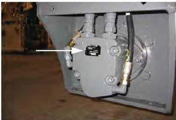
Placa de identificação do motor (c/sensor) da roda traseira direita -Vista típica
