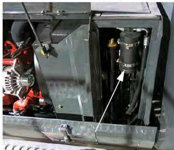
Receptor/Secador do sistema de A/C
