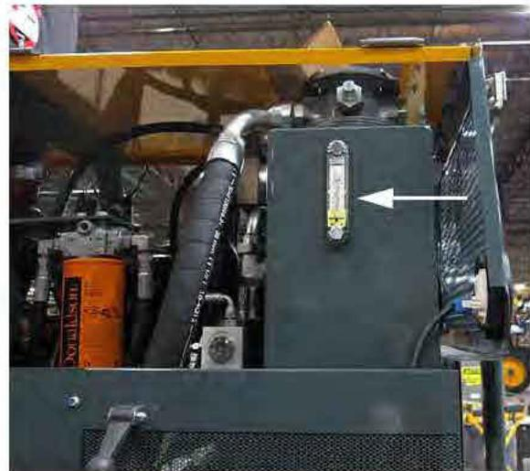
Medidor com visor do reservatório de óleo hidráulico (localizado no reservatório de óleo hidráulico)
