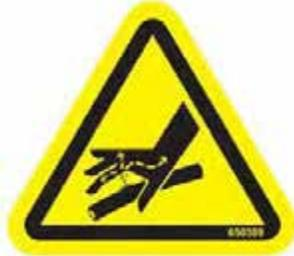
FLUIDO PRESSURIZADO. NÃO USE O DEDO OU A MÃO PARA VERIFICAR SE HÁ VAZAMENTOS DE ÓLEO. DESLIGUE O MOTOR E LIBERE A PRESSÃO ANTES DE VERIFICAR OU REPARAR UM VAZAMENTO. O ÓLEO SOB ALTA PRESSÃO PODE FACILMENTE PERFURAR A PELE, RESULTANDO EM FERIMENTOS GRAVES, GANGRENA OU MORTE. SE FERIDO, PROCURE ASSISTÊNCIA MÉDICA IMEDIATAMENTE.
