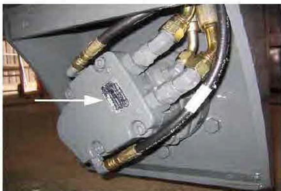
Placa de identificação do motor da roda traseira esquerda e dianteira -Vista típica
