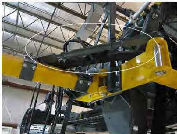
Instalação da barra com catraca
