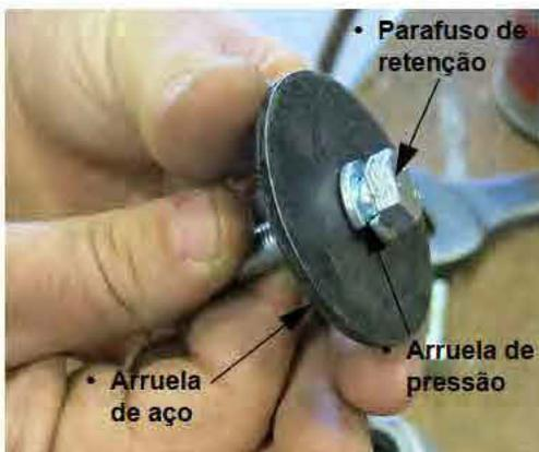
Conjunto parafuso/arruela da lâmina do cortador
