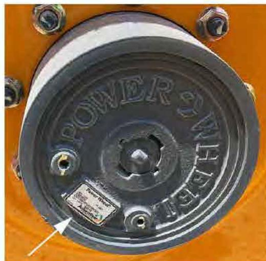
Placa de identificação do cubo de roda planetário -Vista típica
