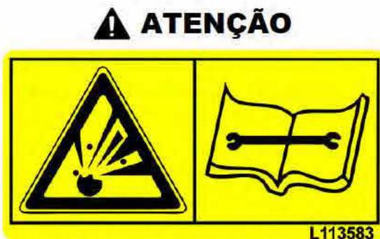
Todas as suspensões a ar podem explodir, causando ferimentos graves ou fatais a você ou a outras pessoas. Não exceda 100 PSI (6,9 bar). Mantenha as mãos e as partes do corpo distantes do percurso da suspensão.
