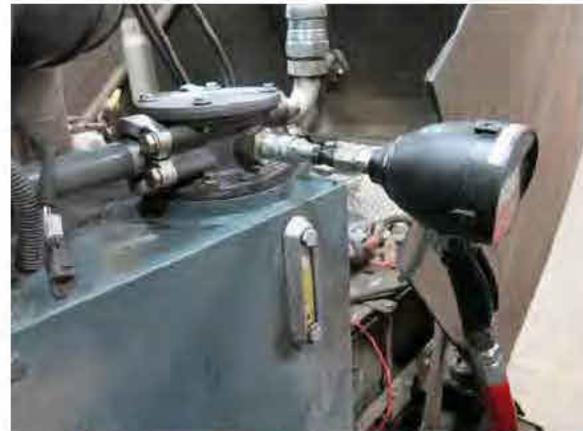
Abastecendo o tanque pela porta de abastecimento de óleo hidráulico
