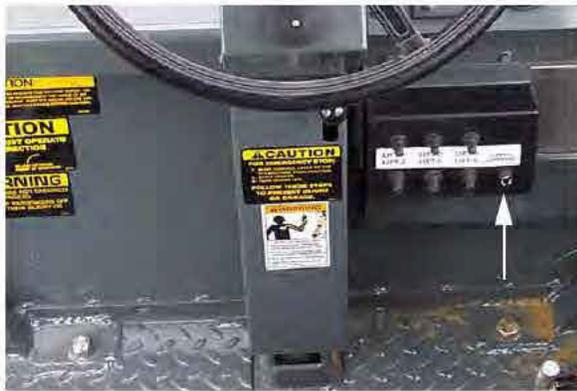
Fusível do comando de profundidade (Localizado no painel da chave do comando de profundidade, perto da dianteira da estação do operador)
