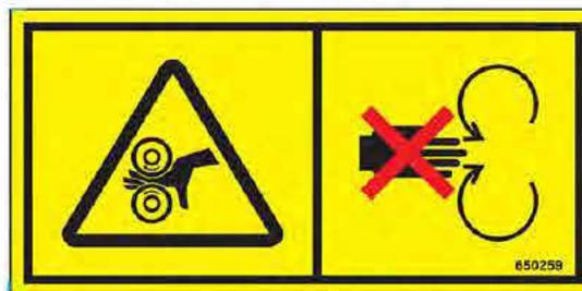
RISCO DE FERIMENTOS DE PNEUS GIRANDO. JAMAIS COLOQUE OS DEDOS OU AS MÃOS PERTO DOS PNEUS DO SACADOR QUÁDRUPLO EM MOVIMENTO, NEM DESALOJE UM OBJETO ENCRAVADO DOS PNEUS EM MOVIMENTO OU NEM EXECUTE A MANUTENÇÃO PERTO DE PNEUS EM MOVIMENTO.
