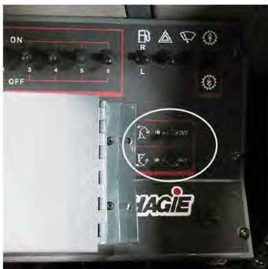
Chaves do estabilizador hidráulico retrátil
