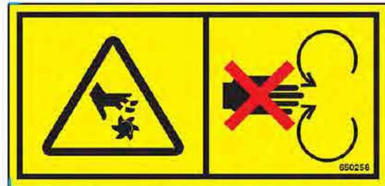
CUIDADO DECEPAÇÃO DOS DEDOS OU MÃOS. JAMAIS COLOQUE OS DEDOS OU AS MÃOS PERTO DA LÂMINA DE UM CORTADOR EM MOVIMENTO, NEM TENDE PARAR A LÂMINA DE UM CORTADOR EM MOVIMENTO OU EXECUTAR A MANUTENÇÃO PERTO DE UMA LÂMINA EM MOVIMENTO.
