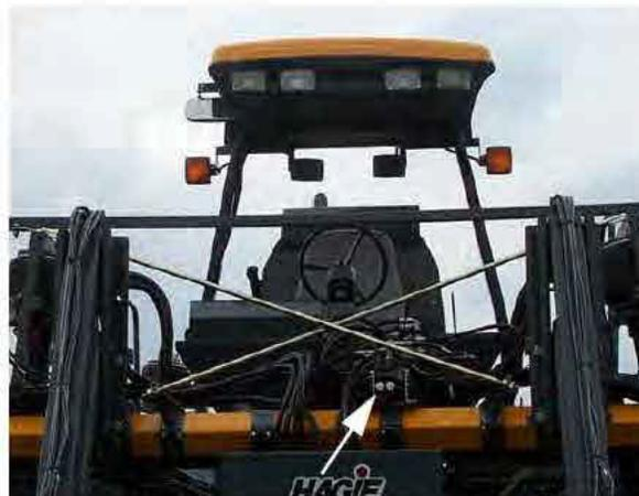
Válvula da retração hidráulica
