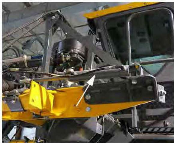
Cilindro da retração hidráulica
