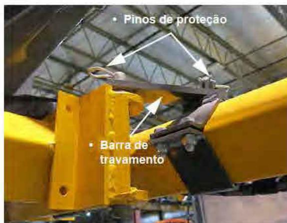
Conjunto pino de proteção/barra de travamento (Localizado entre o estabilizador e a barra de ferramenta central)
