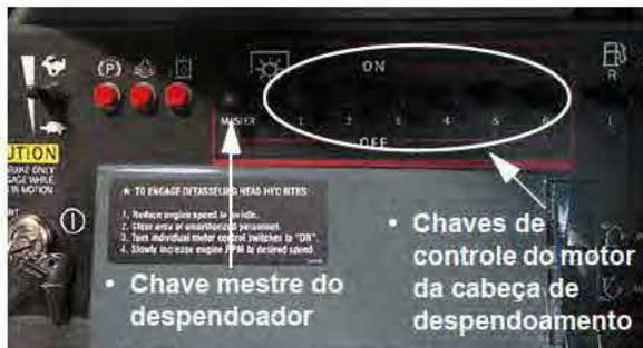
Chaves mestre do despendoador e do controle do motor de cabeça de despendoamento (Localizadas no console lateral)
