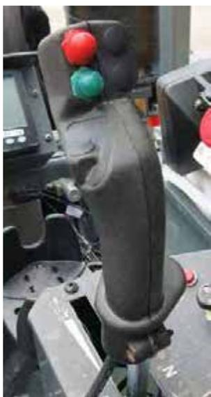
Alavanca de controle da transmissão hidrostática (Localizada no console lateral)
