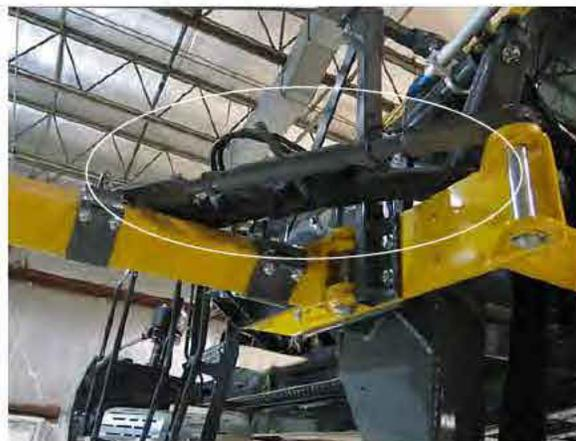
6. Reinstale os pinos de proteção (que foram removidos na etapa 1) nos parafusos de montagem da barra com catraca.
