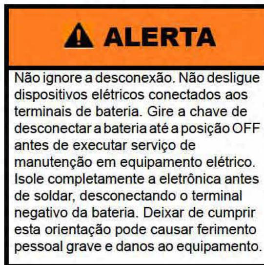
O seu trator está equipado com uma chave de desconectar a bateria (localizada no chassi traseiro). A chave de desconectar a bateria desacopla a bateria, desse modo, cortando toda a potência elétrica para o motor.
