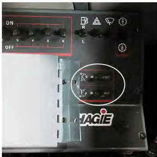
Chaves do estabilizador hidráulico retrátil
