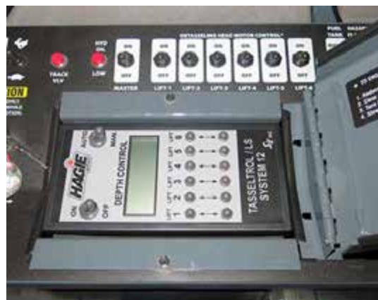
Panou de comandă Tasselrol/ LS System 12 (pe consola laterală - ridicați capacul pentru acces) - Vedere tipică
