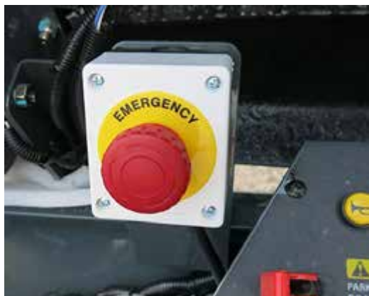
Comutator E-Stop (lângă consola laterală) - Vedere tipică
