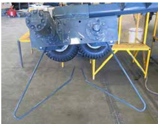
Instalare ghidaj de tulpini - Vedere tipică
