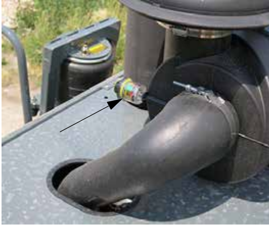
Filter Minder (lângă carcasa filtrului pentru admisia de aer a motorului) - Vedere tipică
