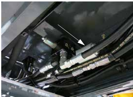
Filtru încorporat de presiune înaltă (sub utilaj - glisați capacul sitei afară pentru acces) - Vedere tipică
