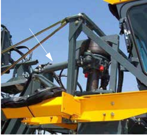
Cilindri de direcție (pe brațele de direcție față și componentele sudate ale picioarelor exterioare) - Vedere tipică
