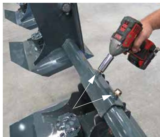
Șuruburi cap de tăiere (pe fiecare tub de montare a capului de tăiere) - Vedere tipică
