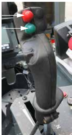
Comutatoare Toate sus/jos (pe maneta de comandă a transmisiei hidrostactice) - Vedere tipică
