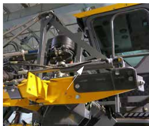
Cilindru de pliere hidraulică (atașat la consolă și bara pentru unelte centrală) - Vedere tipică
