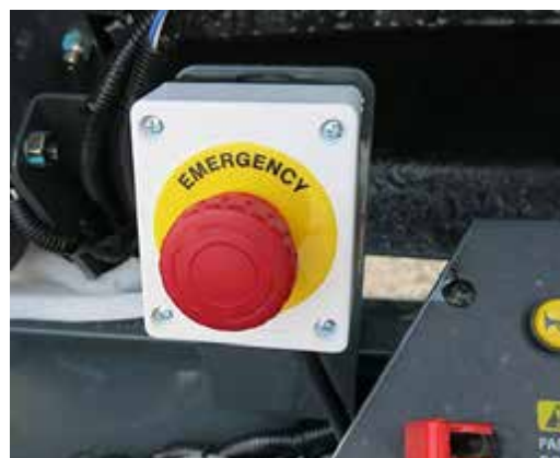
Comutator E-Stop (lângă consola laterală) - Vedere tipică
