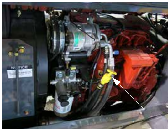
Joja pentru ulei de motor (pe partea stângă a motorului - deschideți capota pentru accesare) - Vedere tipică
