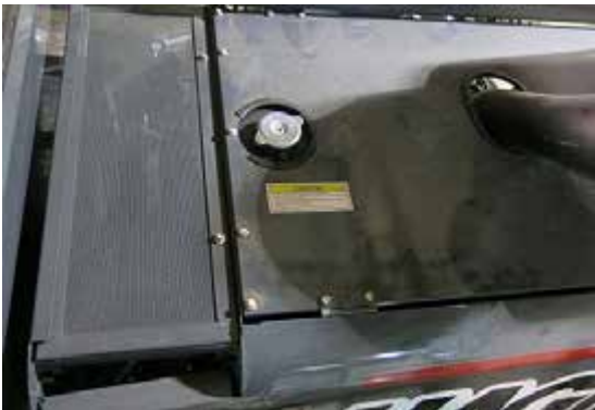
Capac radiator (în spatele stației operatorului) - Vedere tipică
