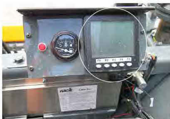
Monitor do motor (Localizado perto da dianteira da estação do operador) -Vista típica
