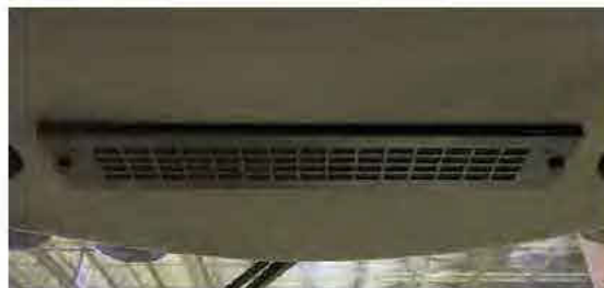
Filtros de ar renovado da cabine (Localizados no teto da cabine) -Vista típica
