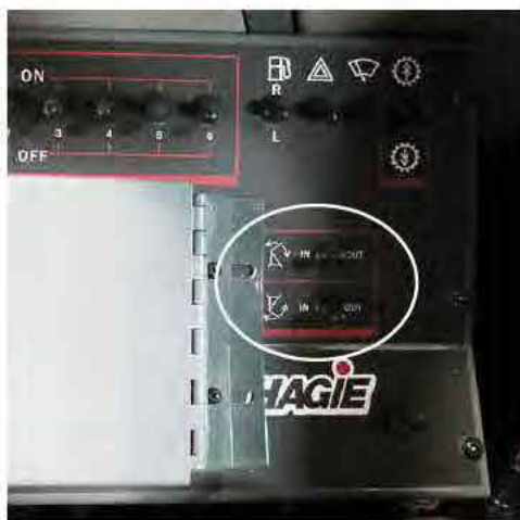
Chaves da retração hidráulica do estabilizador (Localizada no console lateral) -Vista típica
