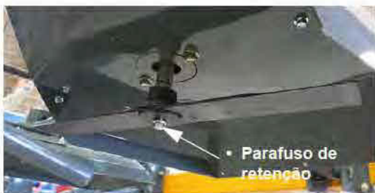
Conjunto da lâmina do cortador (Montado no lado inferior da cabeça do cortador) -Vista típica
