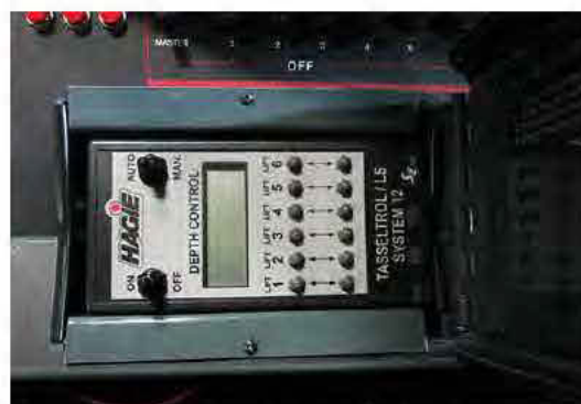
O painel de controle do Tasselrol/LS System 12 (Localizado no console lateral - levante a tampa para acessar) -Vista típica
