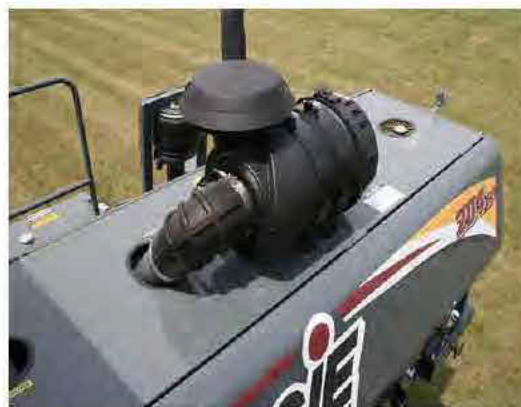
Filtro de entrada de ar do motor (Localizado perto da traseira do trator - remova a tampa do limpador de ar para acessar) -Vista típica
