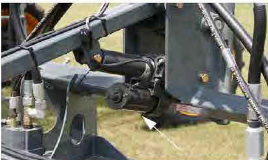
Atuador do comando de profundidade (Localizado no tubo da cabeça de suspensão da barra de ferramenta) -Vista típica
