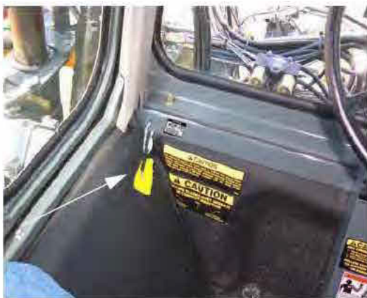
Ferramenta para saída de emergência (Localizada perto do lado esquerdo da cabine) -Vista típica
