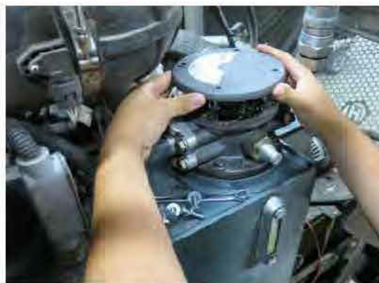
Abastecendo o tanque pelo compartimento do filtro de retorno hidráulico
