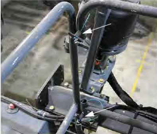
Pinos do corrimão (Localizados no lado de cima e embaixo da extensão do corrimão) -Vista típica
