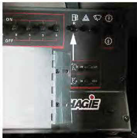
Chave seletora do tanque de combustível (Localizadas no console lateral) -Vista típica
