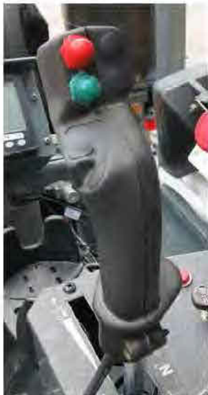
Alavanca do controle da transmissão hidrostática (Localizado no console lateral) -Vista típica
