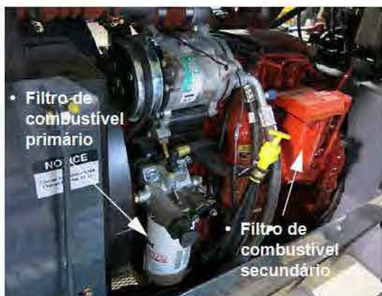
Filtros de combustível primário e secundário (Localizados no lado esquerdo motor - abra o capô para acessar) -Vista típica
