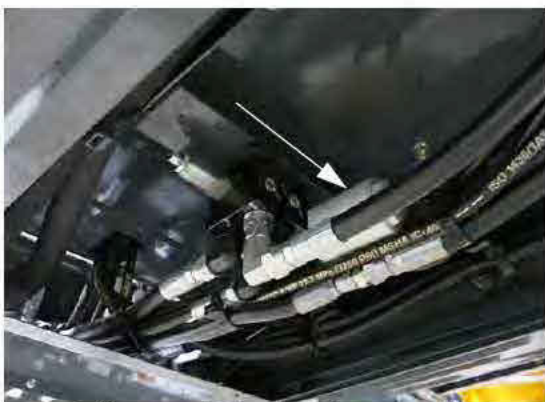
Filtro em linha de alta pressão (localizado abaixo da máquina -abaixe o painel de tela para obter acesso) -Vista típica
