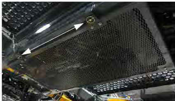
Pinos de fixação de painel de tela (localizados no painel frontal da tela) -Vista típica
