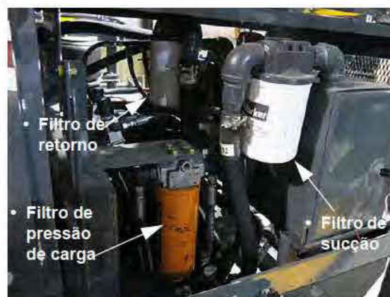
Filtros de sucção, de pressão de carga e de retorno (Localizados perto do lado traseiro esquerdo do trator - abra o capô para acessar) -Vista típica
