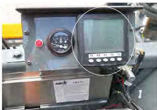
Visor do monitor de motor (Localizado perto da dianteira da estação do operador) -Vista típica
