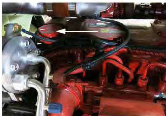
Porta de enchimento do óleo do motor (Localizada perto do lado esquerdo do motor - abra o capô para acessar) -Vista típica
