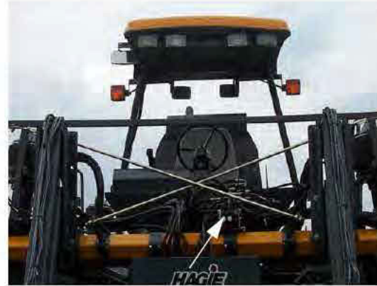
Válvula da retração hidráulica (Localizada na barra de ferramenta central) -Vista típica
