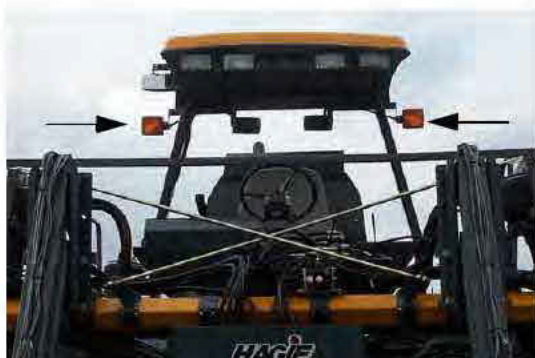
Faróis para estrada (Localizados em cada lado da estação do operador) -Vista típica
