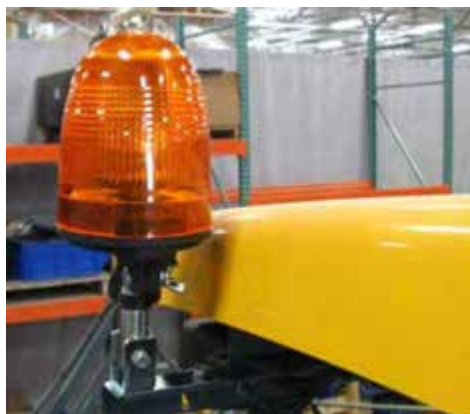
Sinalizador luminoso giratório (Localizado no lado esquerdo da estação do operador) -Vista típica
