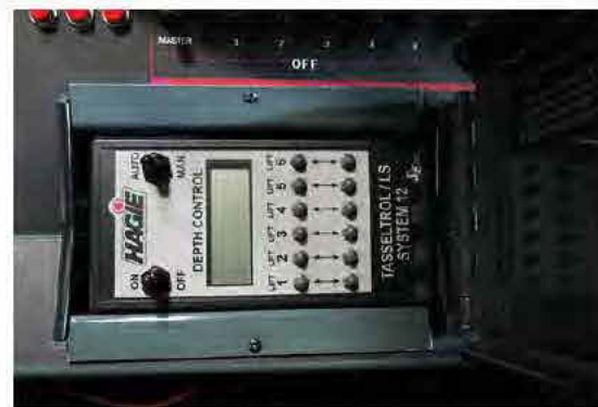
Painel de controle do Tasselrol/LS System 12 (Localizado no console lateral - levante a tampa para acessar) -Vista típica
