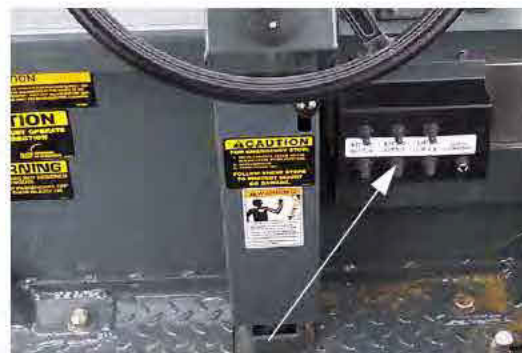
Chaves de comando de profundidade (Localizadas perto da dianteira da estação do operador) -Vista típica
