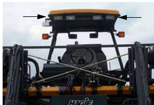
Projecteurs de travail (situés à l'avant et à l'arrière du poste de conduite) - Vue typique
