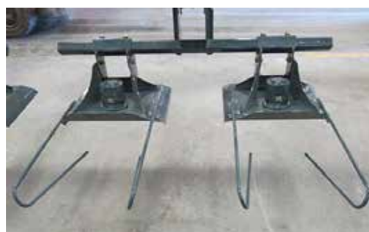
Installation des guides de végétation - Vue typique
