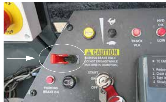
Bouton de frein de stationnement (situé sur le montant droit) - Vue typique
