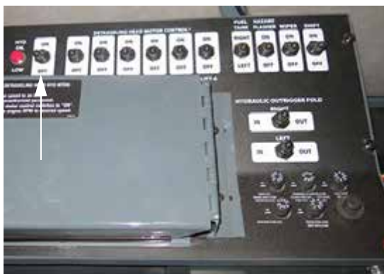
Interrupteur général de l'enjambeur de castration du maïs (situé sur le montant droit) - Vue typique
