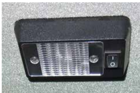
Plafonnier (situé au plafond de la cabine) - Vue typique
