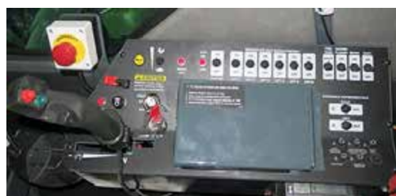
Accès au disjoncteur (situé sous le montant droit - retirer la manette de commande de l'entraînement hydrostatique et les vis en haut du panneau pour y accéder) - Vue typique
