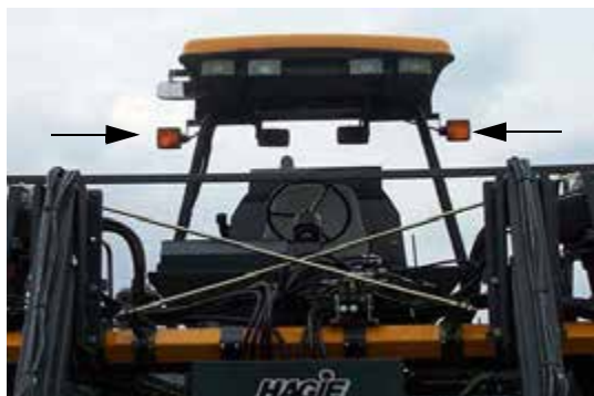
Feux de route (situé à l'avant et à l'arrière du poste de conduite) - Vue typique
