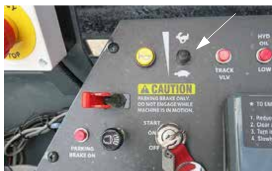
Bouton d'accélération (situé sur le montant droit) - Vue typique
