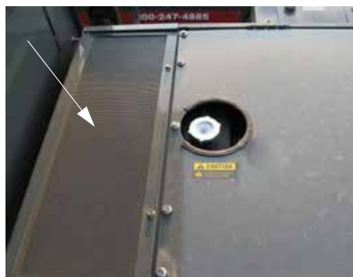
Écran de la calandre du haut (enlever les deux vis du panneau du radiateur et le panneau pour y accéder) - Vue typique
