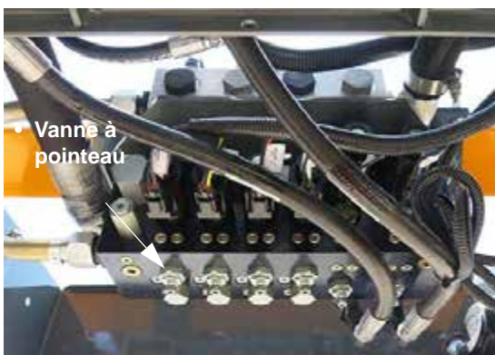
Distributeur du moteur - Vue typique
