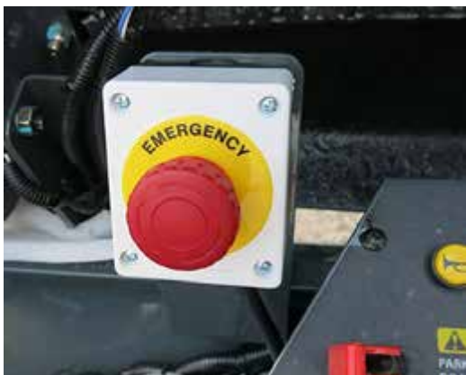
Bouton d'arrêt d'urgence (situé près du montant droit) - Vue typique
