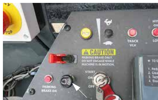
Bouton des projecteurs de travail (situé sur le montant droit) - Vue typique
