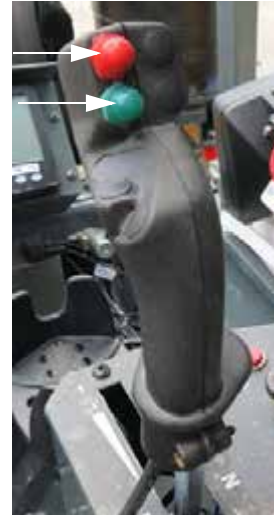
Boutons « Tous montés / abaissés » (situés sur le levier de commande de l'entraînement hydrostatique) - Vue typique
