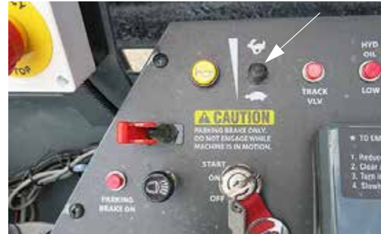
Bouton d'accélération (situé sur le montant droit) - Vue typique
