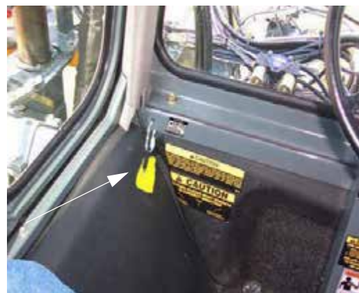
Outil d'évacuation d'urgence (situé près du côté gauche de la cabine) - Vue typique
