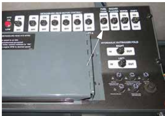
Bouton de sélection du réservoir de carburant (situé sur le montant droit) - Vue typique
