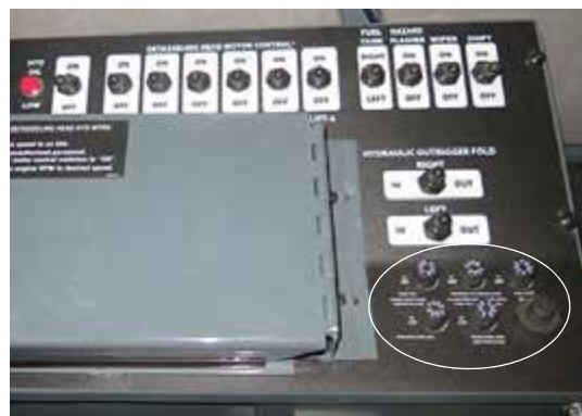
Fusibles (situés sur le montant droit) - Vue typique
