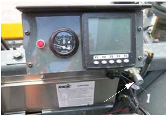
Bouton du distributeur de traction - Avant (situé à l'avant du poste de conduite) - Vue typique
