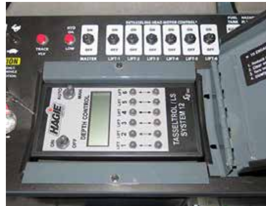
Console de commande Tasseltrol/LS System 12 (situé sur le montant droit - soulever le rabat pour y accéder) - Vue typique
