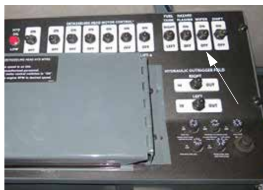
Bouton de l'essuie-glace du pare-brise (situé sur le montant droit) - Vue typique
