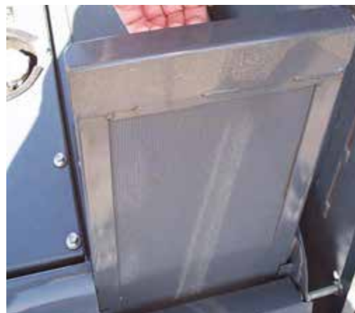
Écran de la calandre latérale (le faire glisser hors du logement du radiateur pour l'enlever) - Vue typique
