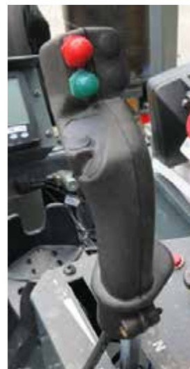
Manette de commande de l'entraînement hydrostatique (située sur le montant droit) - Vue typique
