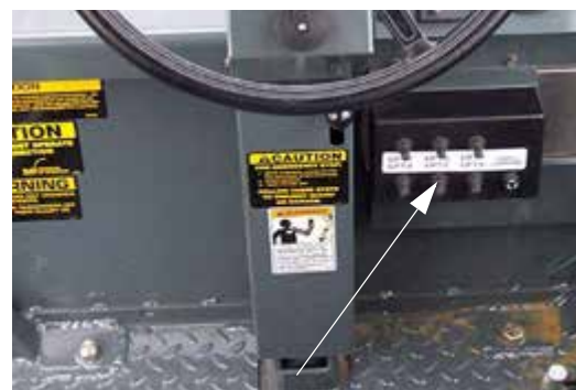
Boutons de contrôle de la profondeur (situés à l'avant du poste de conduite) - Vue typique
