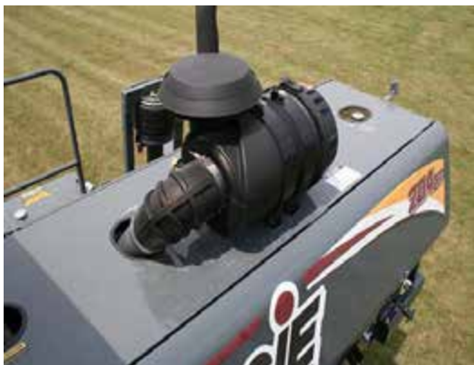
Filtre d'admission d'air du moteur (situé vers l'arrière de la machine – déposer le couvercle de l'extrémité du filtre à air pour y accéder) - Vue typique
