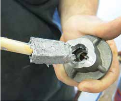
Application du lubrifiant antigrippage - Vue typique
