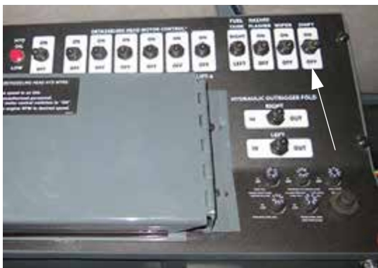
Bouton de changement de vitesse (situé sur le montant droit) - Vue typique
