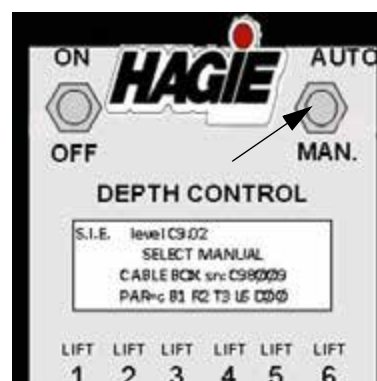
Bouton « Auto / Man. » (situé sur la console de commande Tasseltrö)
