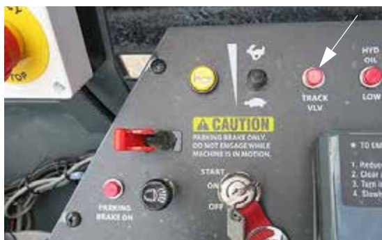
Voyant lumineux du distributeur de traction (situé près du montant droit)
