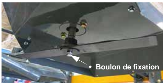
Assemblage d'une lame de coupe (monté sur le côté inférieur d'une tête de coupe) - Vue typique
