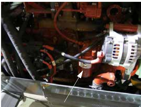
Jauge de niveau d'huile moteur (située sur le côté gauche du moteur - ouvrir le capot du moteur pour y accéder) - Vue typique
