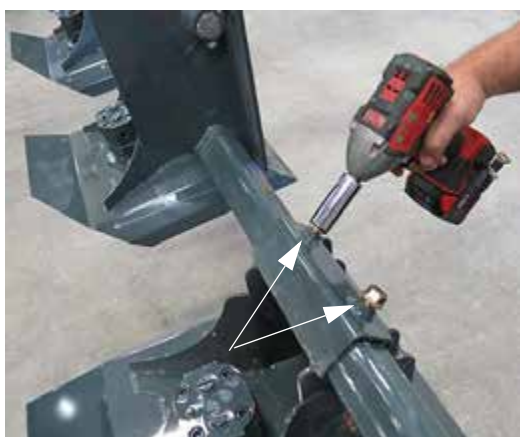
Boulons des têtes de coupe (situés sur chaque tube de support des têtes de relevage) - Vue typique
