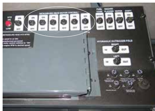
Interrupteurs de commande de moteurs de têtes de castration du maïs (situé sur le montant droit) - Vue typique
