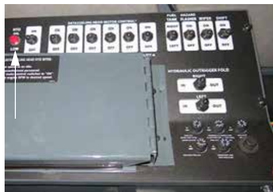
Voyant lumineux de niveau d'huile hydraulique insuffisant (situé sur le montant droit) - Vue typique
