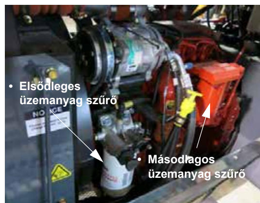
Elsődleges és másodlagos üzemanyag szűrők (A motor bal kéz felőli oldalán van elhelyezve - a hozzáféréshez nyissa fel a motorháztetőt) - Tipikus nézet
