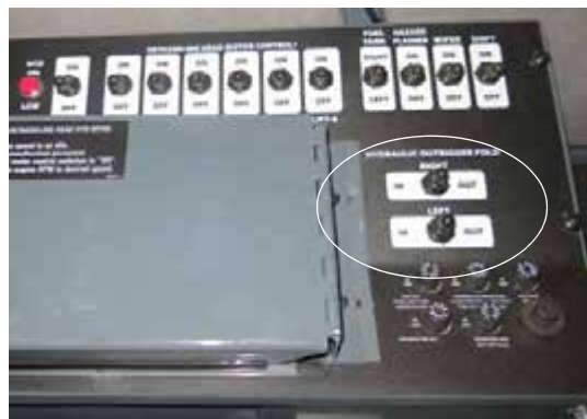
Hidraulikus szerelvényhordó kapcsoló (oldalsó vezérlőpulton) - Tipikus nézet
