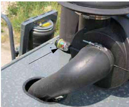
Filter Minder (a motor levegőbeszívó szűrő ház közelében van elhelyezve) - Tipikus nézet
