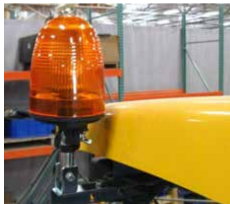
Körforgós jelzőfény (megkülönböztető jelzés a kezelőállás bal oldalán) - Tipikus nézet
