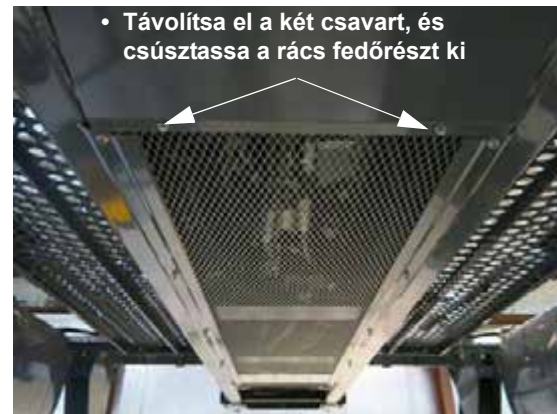
Rács fedőrész (a gép alján helyezkedik el) - Tipikus nézet * A gép hátulja felőli nézet
