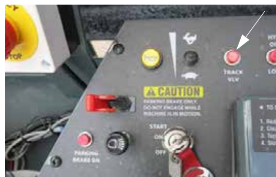
Vontatószelep kijelző (oldalsó vezérlőpulton) - Tipikus nézet
