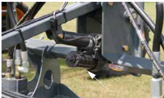
Mélység vezérlőt működtető szerkezet (Az emelhető szerszámtartó rudazat [eszközsor] csőfején) - Tipikus nézet
