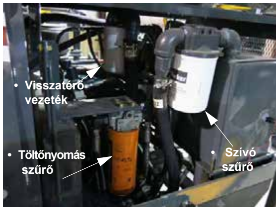
Szívó, töltőnyomás és visszatérő vezeték szűrő (A gép bal, hátsó oldalán helyezkedik el - a hozzáféréshez nyissa ki a motorháztetőt) - Tipikus nézet
