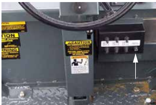
Mélységvezérlő biztosíték (A mélységvezérlő kapcsoló Panelen van elhelyezve, a kezelő állás elülső részének közelében) - Tipikus nézet
