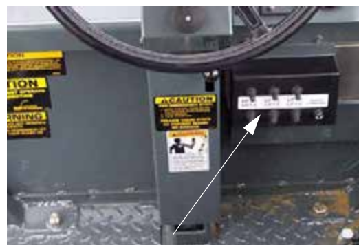
Mélységvezérlő kapcsolók (a kezelőállás elejénél) - Tipikus nézet
