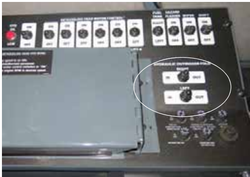
Hidraulikus szerelvényhordó kapcsoló (oldalsó vezérlőpulton) - Tipikus nézet
