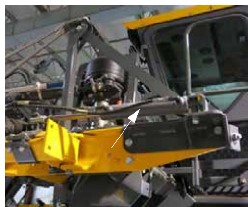
Hidraulikus hajtású henger (a szerelvényhordó gémkarhoz, és a központi szerszámtartó rúdhhoz van csatlakoztatva) - Tipikus nézet
