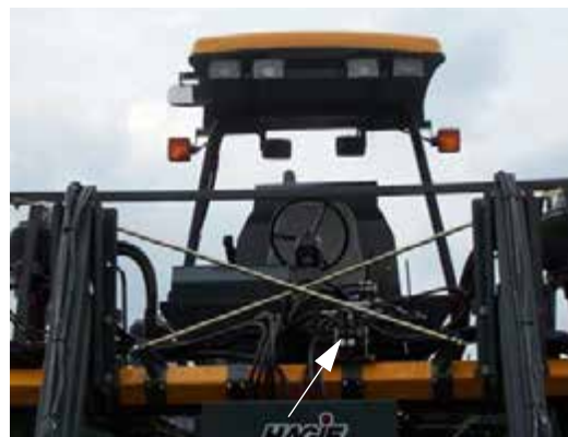
Hidraulikus összehajtó szelep (a központi szerszámtartó rudazaton van elhelyezve) - Tipikus nézet
