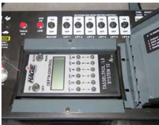
Tasselrol/LS rendszer 12 vezérlőpanel (oldalsó vezérlőpulton - hozzáféréshez hajtsa fel a védlapot) - Tipikus nézet
