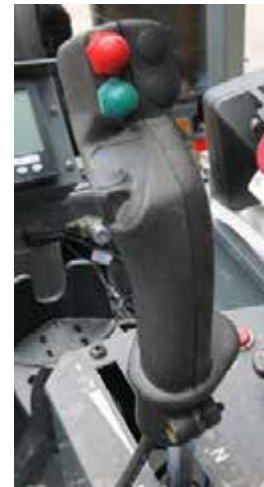
Hidrosztatikus hajtás vezérlőkarja (oldalsó vezérlőpulton) - Tipikus nézet
