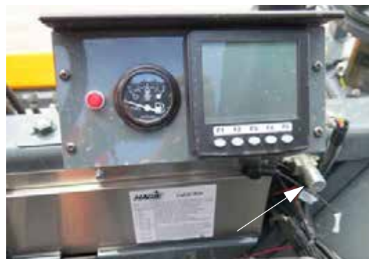
Vontatószelep kapcsoló - Elülső (a kezelőállás elejénél) - Tipikus nézet
