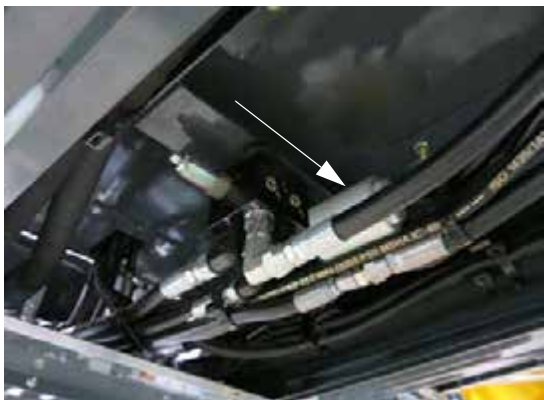
Nagy nyomású, párhuzamos elhelyezkedésű szűrő (a gép alatt helyezkedik el - a rács fedőrészt ki kell csúsztatni a hozzáféréshez) - Tipikus nézet
