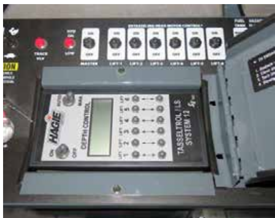
Tasselrol/LS System 12 vezérlőpult (oldalsó vezérlőpulton - hozzáféréshez hajtsa fel a védlapot) - Tipikus nézet
