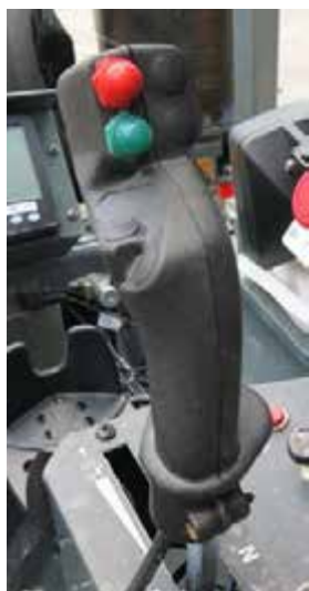
Hidrosztatikus hajtás vezérlőkarja (oldalsó vezérlőpulton) - Tipikus nézet
