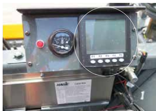
CANtrak motorfelügyelet (a kezelőállás elejénél) - Tipikus nézet
