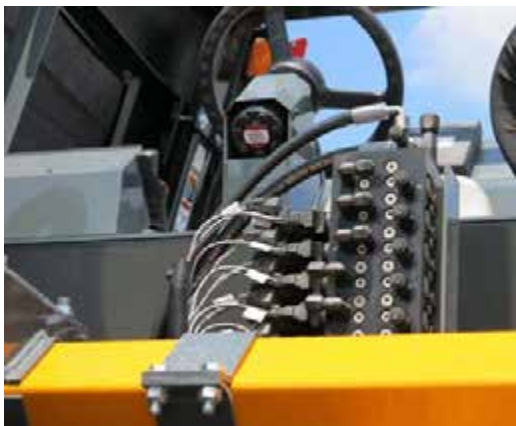
Elektrohidraulikus szelepek (A szerszámtartó rudazat elülső részén helyezkedik el) - Tipikus nézet
