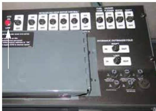
Alacsony hidraulikaolaj kijelzés (oldalsó vezérlőpulton) - Tipikus nézet
