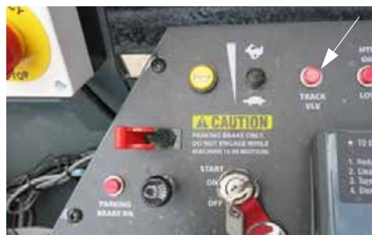
Vontatószelep kijelző (oldalsó vezérlőpulton) - Tipikus nézet
