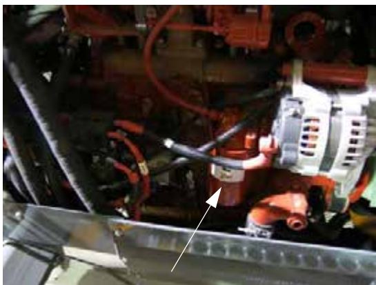
Motorolaj szűrő (A motor jobb oldalán helyezkedik el - a hozzáféréshez nyissa ki a motorháztetőt) - Tipikus nézet
