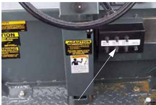
Mélységvezérlő kapcsolók (a kezelőállás elejénél) - Tipikus nézet
