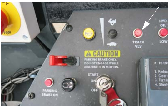
牵引阀指示灯 (位于侧控制台上) - 典型视图
