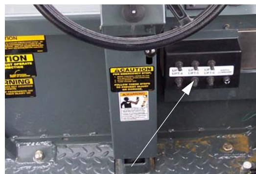
深度命令开关 (位于操作员工作站前端的附近) - 典型视图
