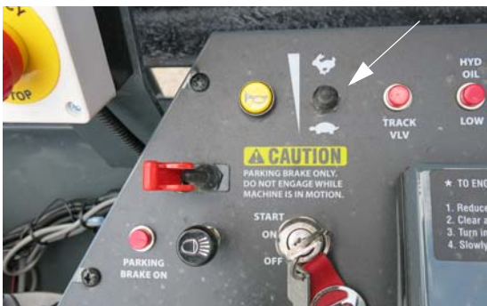
油门开关 (位于侧控制台上) - 典型视图
