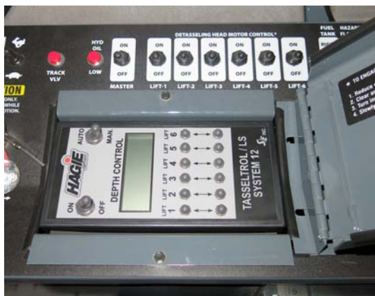
Tasseltrol/LS System 12 控制面板 (位于侧控制台上 - 提起盖子进入) - 典型视图
