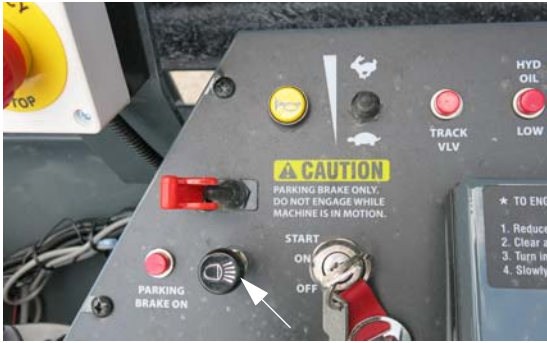
工作灯开关 (位于侧控制台上) - 典型视图
