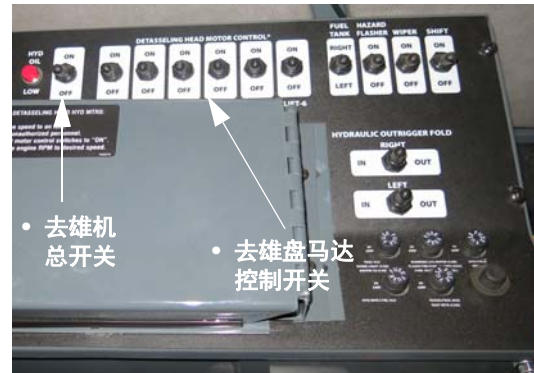
去雄机总开关和去雄盘马达控制开关 (位于侧控制台上) - 典型视图
