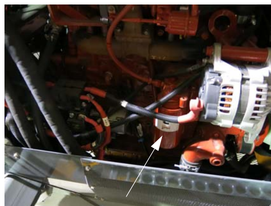
发动机油过滤器 (位于发动机的右手侧 - 打开 护罩可以够着) - 典型视图
