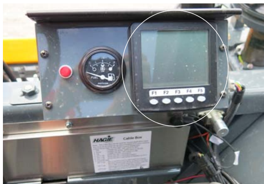
CANtrak 发动机监控器 (位于操作员工作站前端的附近) - 典型视图
