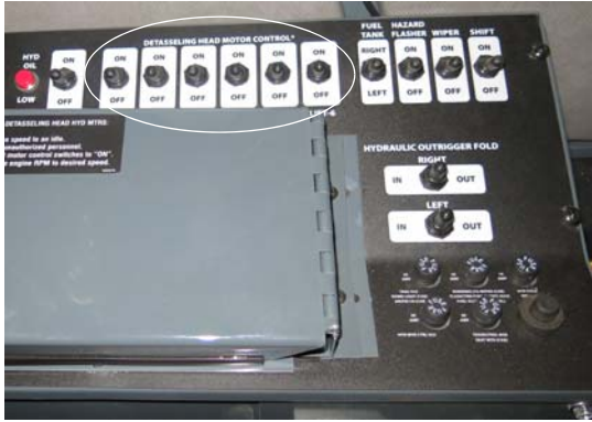
去雄盘马达控制开关 (位于侧控制台上) - 典型视图
