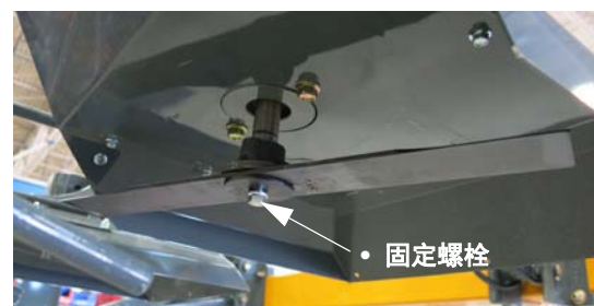
切刀总成 (安装在刀盘的底部) - 典型视图
