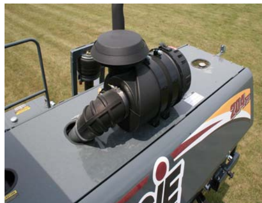
发动机进气过滤器 (位于机器后侧附近 – 拆除空气净化器端盖后可以够着) - 典型视图
