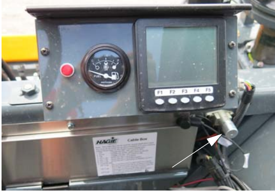
牵引阀开关 - 前端 (位于操作员工作站前端的附近) - 典型视图
