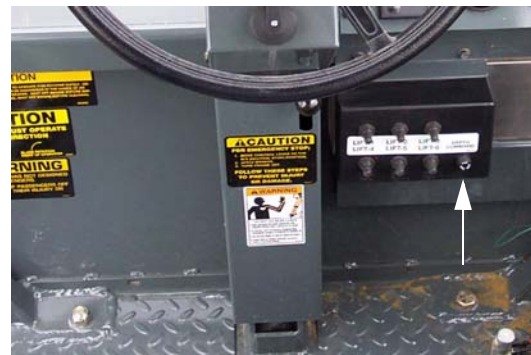
深度命令熔丝 (位于操作员工作站前端附近的 深度命令开关面板上) - 典型视图
