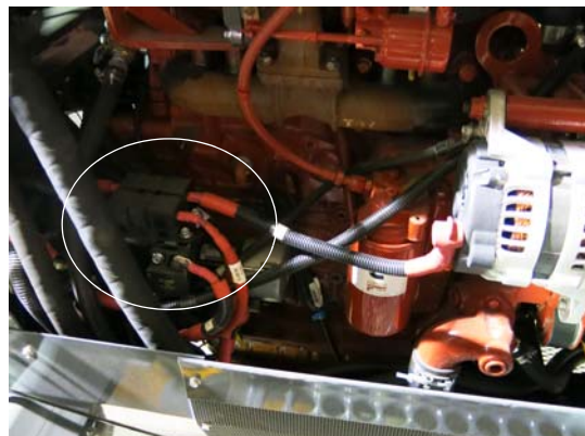
线束断路器和熔丝 （位于发动机的左手侧） - 典型视图
