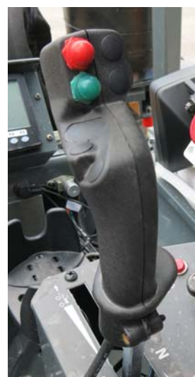
静液压驱动控制柄 (位于侧控制台上) - 典型视图
