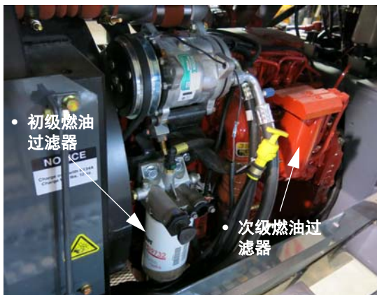
初级和次级燃油过滤器 （位于发动机的左手侧 - 打开 护罩可以够着） - 典型视图
