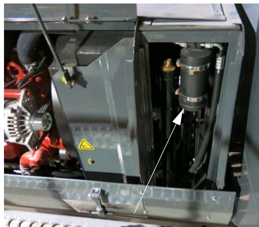
A/C 系统接收器/干燥器 (位于驾驶室后侧的散热器附近 – 拆除散热器护屏可以够着) - 典型视图
