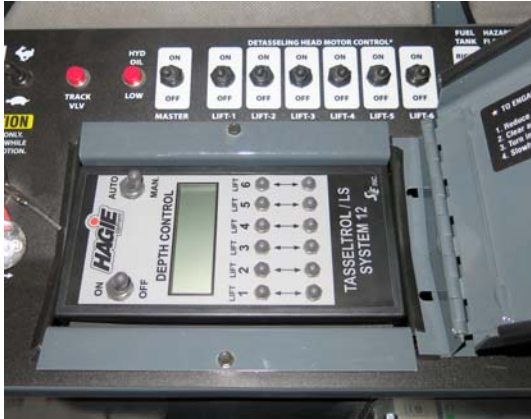
Tasselrol/LS 系统 12 控制面板 (位于侧控制台上 - 提起盖板可以够着) - 典型视图
