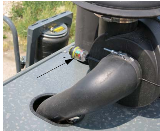
Filter Minder (位于发动机进气过滤器壳的附近) - 典型视图
