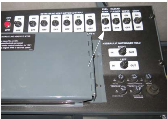
燃油箱选择器开关 (位于侧控制台上) - 典型视图
