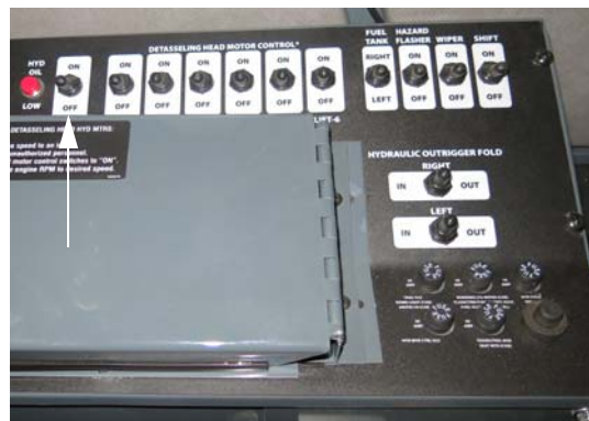
去雄机总开关 (位于侧控制台上) - 典型视图
