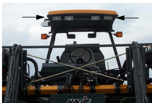
工作灯 (位于操作员工作站的前后端) - 典型视图
