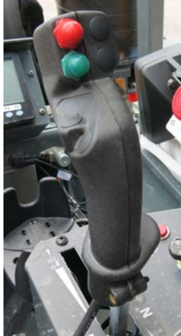
静液压驱动控制柄 (位于侧控制台上) - 典型视图
