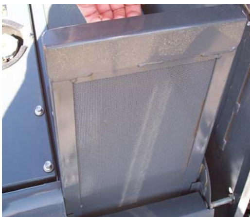
侧栅屏 (滑出散热器壳, 并卸下) - 典型视图
