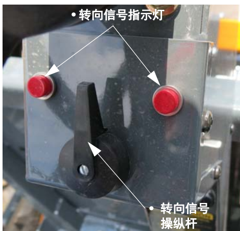
转向信号操纵杆和指示灯 (位于转向柱上) - 典型视图
