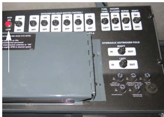
低液压油指示灯 (位于侧控制台上) - 典型视图
