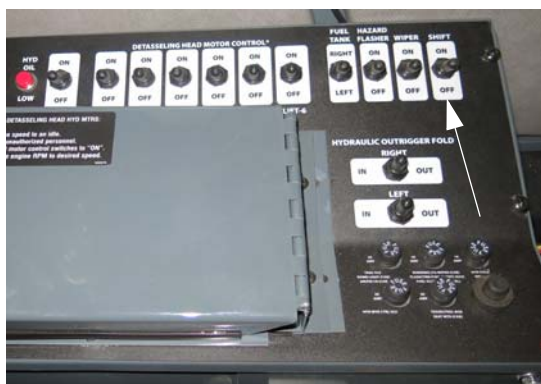
换档开关 (位于侧控制台上) - 典型视图
