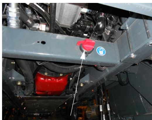
电池断开开关 (位于后机架上) - 典型视图
