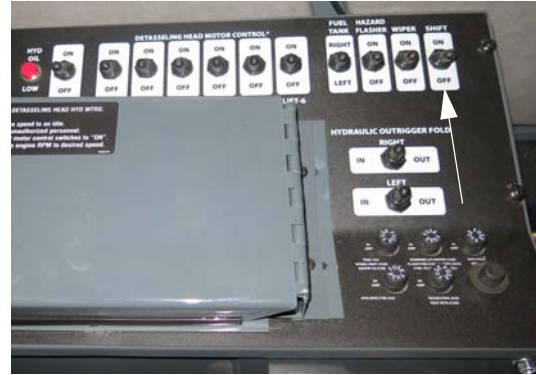
换档开关 (位于侧控制台上) - 典型视图
