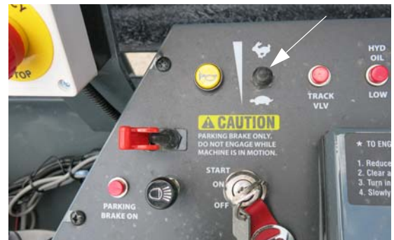
油门开关 (位于侧控制台上) - 典型视图
