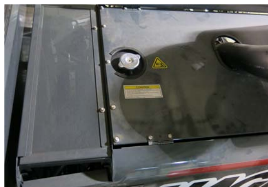
散热器盖 (位于操作员工作站的后侧) - 典型视图
