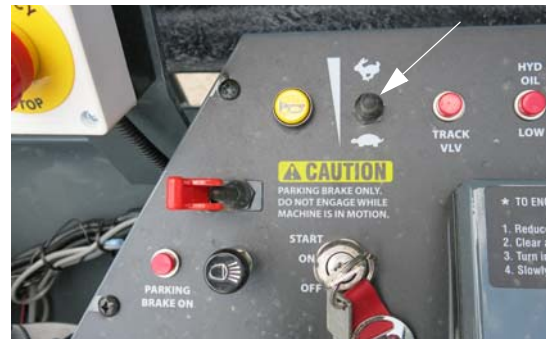
油门开关 (位于侧控制台上) - 典型视图
