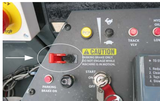
驻车制动器开关 （位于侧控制台上） - 典型视图
