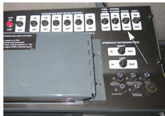
风挡刮水器开关 (位于侧控制台上) - 典型视图
