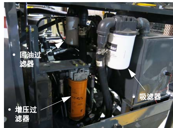
吸滤器、增压过滤器和回油过滤器 （位于机器左后侧的附近 - 打开 护罩可以够着） - 典型视图
