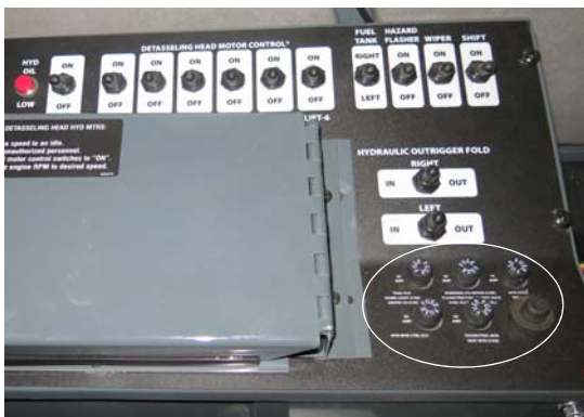
熔丝 (位于侧控制台上) - 典型视图
