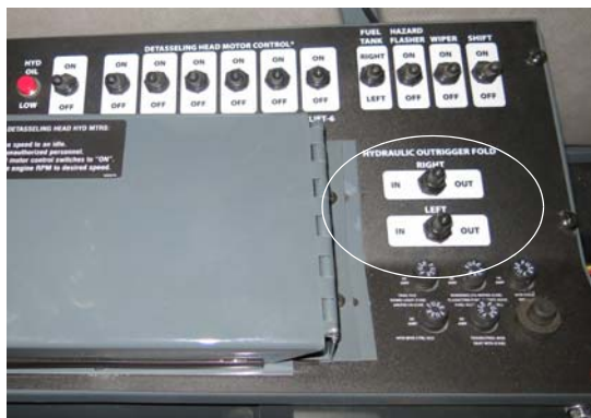
液压悬臂梁折叠开关 (位于侧控制台上) - 典型视图
