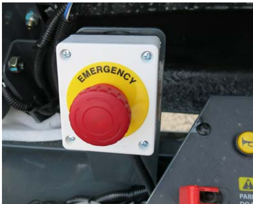
紧急停止开关 (位于侧控制台附近) - 典型视图
