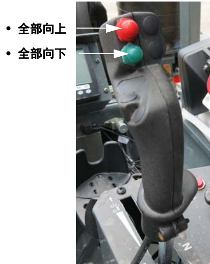
全部向上/向下开关 (位于静液压驱动控制柄上) - 典型视图
