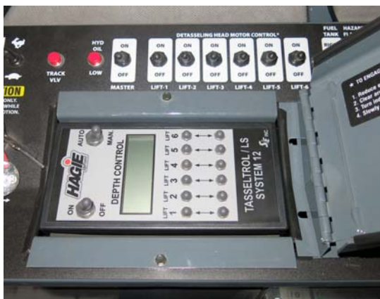
Tasselrol/LS System 12 控制面板 (位于侧控制台上- 提起盖板 可以够着) - 典型视图
