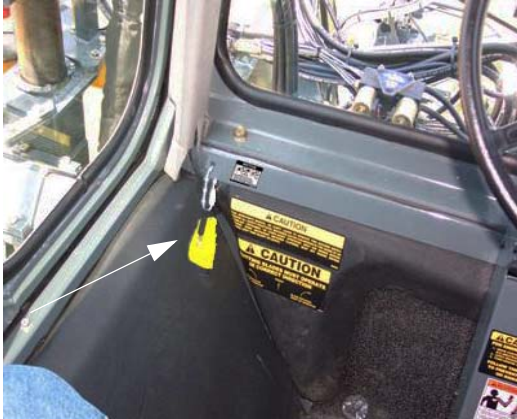
紧急出口工具 (位于驾驶室左手侧的附近) - 典型视图
