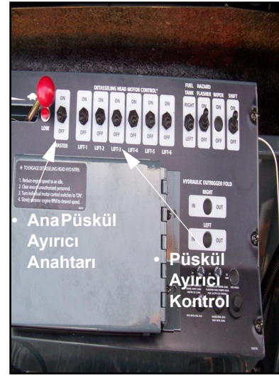
Ana Püskül Ayırıcı Anahtarı ve Püskül Ayırıcı Kontrol Anahtarları (Yan konsolda yer alır) -Genel Görünüm
