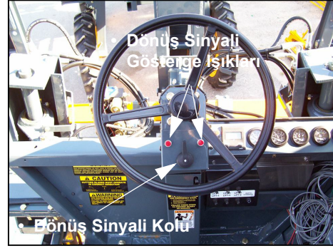
Dönüş Sinyali Kolu ve Gösterge Işıkları (Direksiyon sütununun üstünde yer alır) -Genel Görünüm
