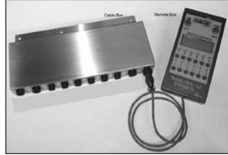
Tasselrol Kontrol Paneli (Yan konsolun kenarında yer alır)
