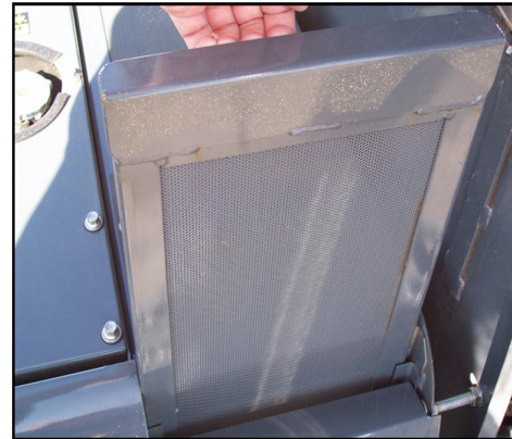
Yan ızgara Eleği (Sökmek için radyatör muhafazasından çekin) -Genel Görünüm
