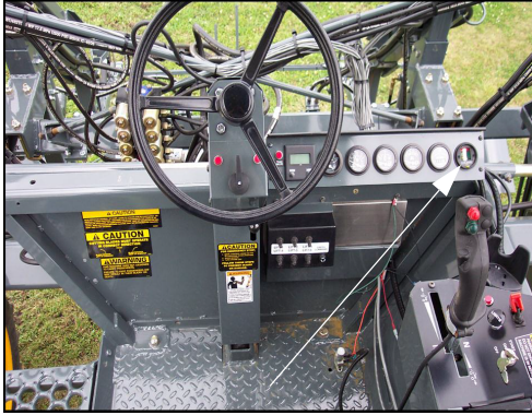
Filter Minder (Operatör istasyonunun yanında yer alır) -Genel Görünüm
