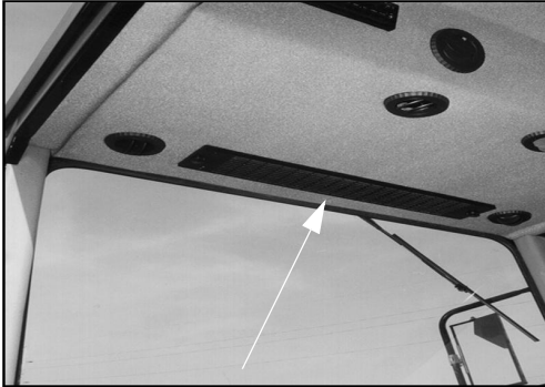
Temiz Hava Kabin Filtresi (Kabin tavan döşemesinin üstünde yer alır) -Genel Görünüm
