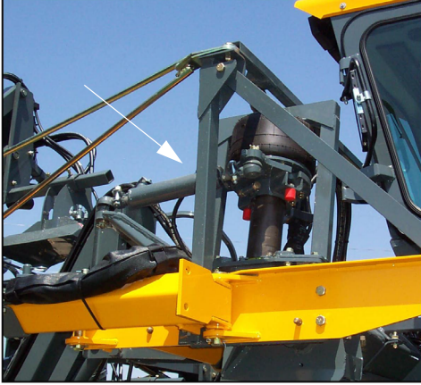
Direksiyon Silindirleri (Her iki ön direksiyon koluna ve dış ayak kaynak yerlerine montelidir) -Genel Görünüm
