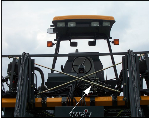
Hidrolik Katlama Valfi (Merkez araç çubuğunda yer alır) -Genel Görünüm
