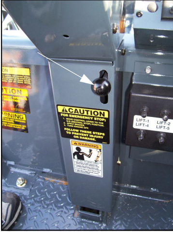
Direksiyon Sütunu Eğme Kilidi Kolu (Direksiyon sütununun ortasında yer alır) -Genel Görünüm
