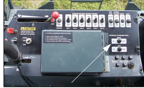
Sağ/Sol Hidrolik Sabitleme Ayağı Katlama Valfi Anahtarları (Yan konsolda yer alır) -Genel Görünüm
