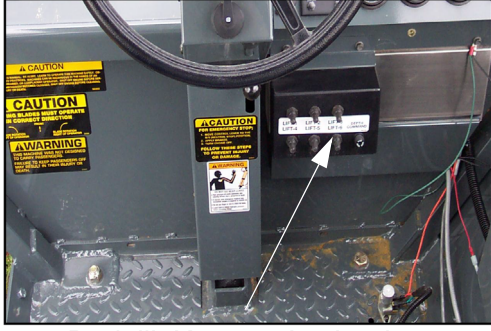
Derinlik Komutu Anahtarları (Operatör istasyonunun yanında yer alır) -Genel Görünüm
