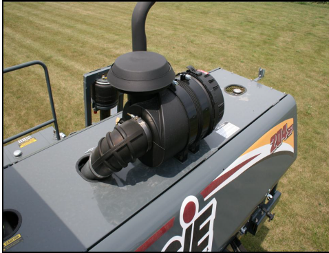
Motor Hava Girişi Filtresi (Ulaşmak için hava temizleyici ucu kapağını çıkartın) -Genel Görünüm
