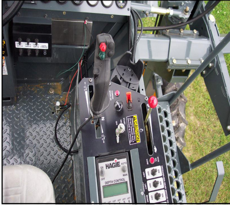
İş Farları Düğmesi (Yan konsolda yer alır) -Genel Görünüm
