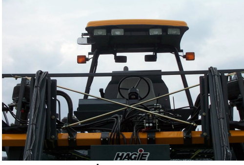
İş Farları (Tentenin veya kabinin önünde ve arkasında yer alır) -Genel Görünüm
