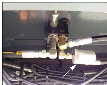
Filtru în linie de 90 microni (Arătat cu carcasa ecranului scoasă) –Vedere tipică
