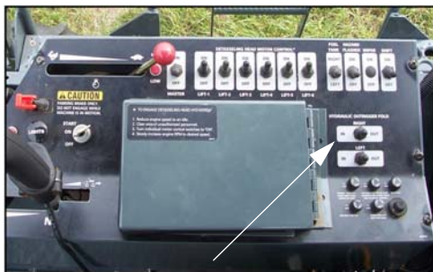
Comutatoarele supapei hidraulice de plisare a lonjeronului dreapta/stânga (Aflate pe consola laterală) –Vedere tipică
