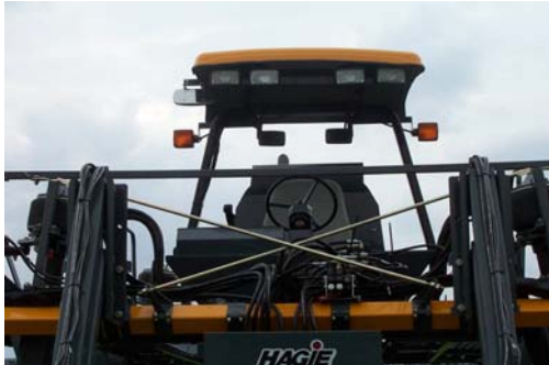
Lumini de lucru (Aflate pe fața sau spatele apărătorului sau cabinei) –Vedere tipică
