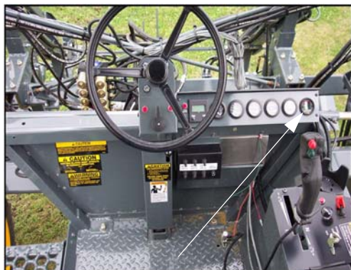
Monitor filtru (Aflat lângă stația operatorului) –Vedere tipică
