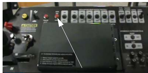
Indicatorul de nivel scăzut de ulei hidraulic (Aflat pe consola laterală) –Vedere tipică
