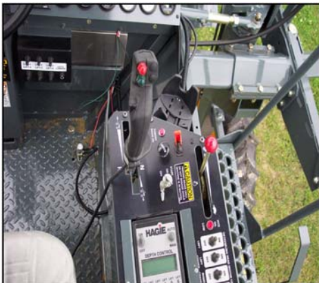
Comutator lumini de lucru (Aflat pe consola laterală) –Vedere tipică
