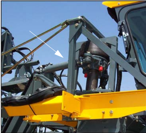
Cilindrii hidraulici (montați pe sudurile ambelor brațe și picioare externe de direcție) –Vedere tipică
