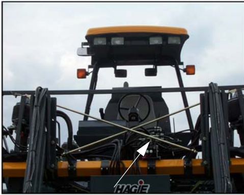
Supapa de plisare hidraulică (Aflată pe bara centrală a uneltei) –Vedere tipică
