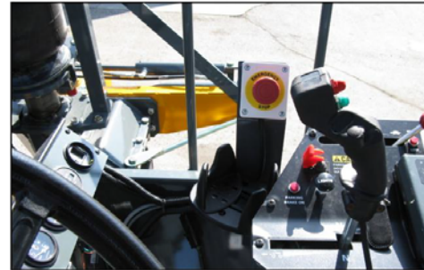
Comutator E-Stop (Aflat lângă consola laterală) –Vedere tipică
