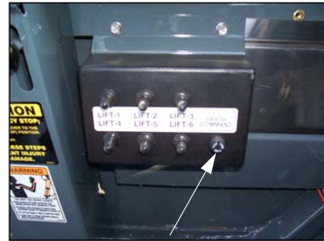
Siguranța pentru comanda adâncimii (Aflată pe panoul comutatorului de ridicare) –Vedere tipică
