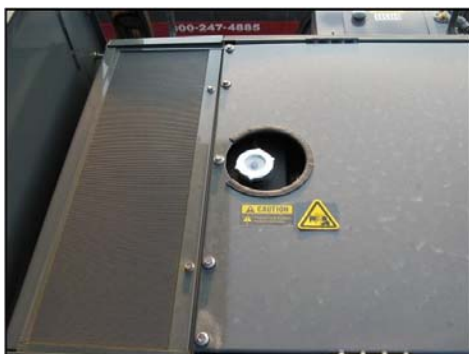
Capac radiator (Aflat în spatele stației operatorului) –Vedere tipică
