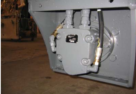
Motorul roții din dreapta spate (cu senzor)
