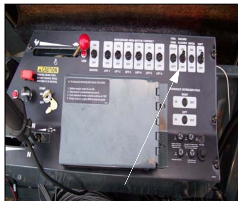
Comutator lumini intermitente pericol (Aflat pe consola din) –Vedere tipică
