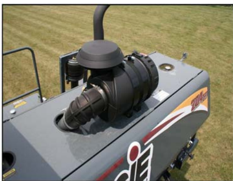
Filtru admisie aer în motor (Scoateți capacul filtrului de aer pentru acces) –Vedere tipică
