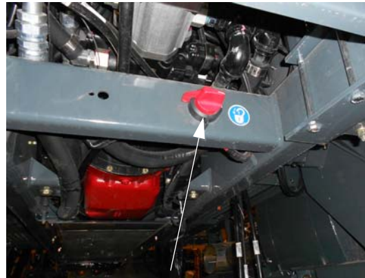
Comutator deconectare baterie (Aflat pe șasiul spate) –Vedere tipică
