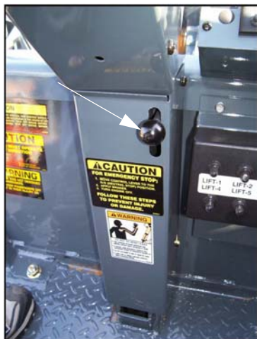
Maneta de blocare a înclinării coloanei de direcție (Aflată în centrul coloanei de direcție) –Vedere tipică
