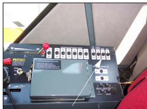
Comutator ștergător de parbriz (Aflat pe consola laterală) –Vedere tipică
